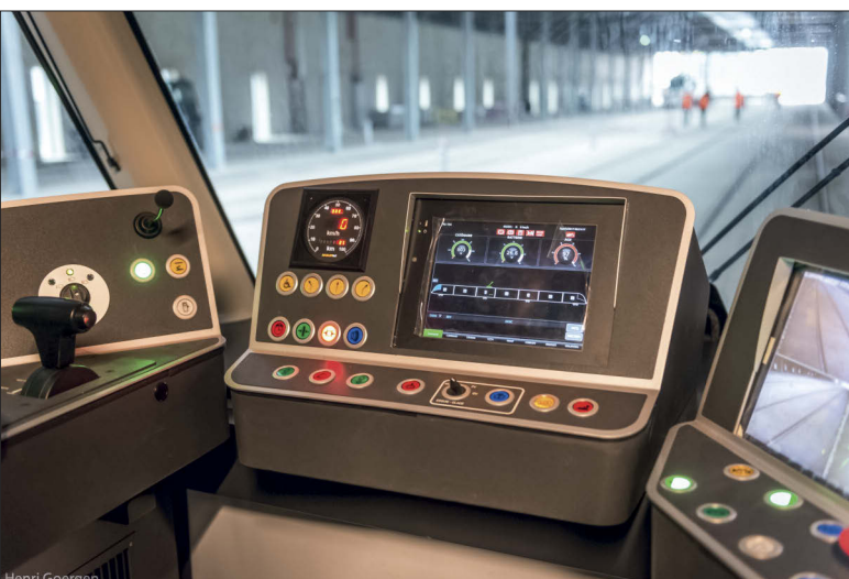
Einen modernen und ergonomisch gestalteten Arbeitsplatz erwartet den Fahrer: Links der Sollwertgeber zum Fahren und Bremsen, in der Mitte ein Funktions-Monitor, recht ein ebensolcher für die Kamerabilder
