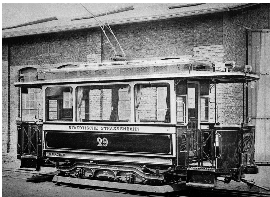
Triebwagen der Erstlieferungen für M. Gladbach und Rheydt im Ursprungszustand mit offenen Plattformen, ein Weyer-Produkt aus dem Jahre 1900
