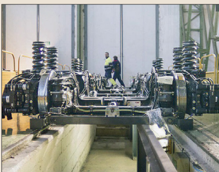
Fertig für den Einbau: Eines der zweiachsigen Drehgestelle mit je einem Fahrmotor pro Rad
