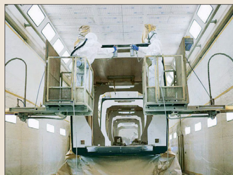
Urbos-Modelle in der Lackiererei: Die Mitarbeiter tragen die vorgeschriebenen Sicherheitsmasken
