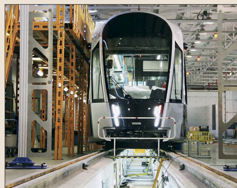
Zu den letzten Arbeiten bei der Urbos-Montage zählt der Einbau des Fahrerstandes
