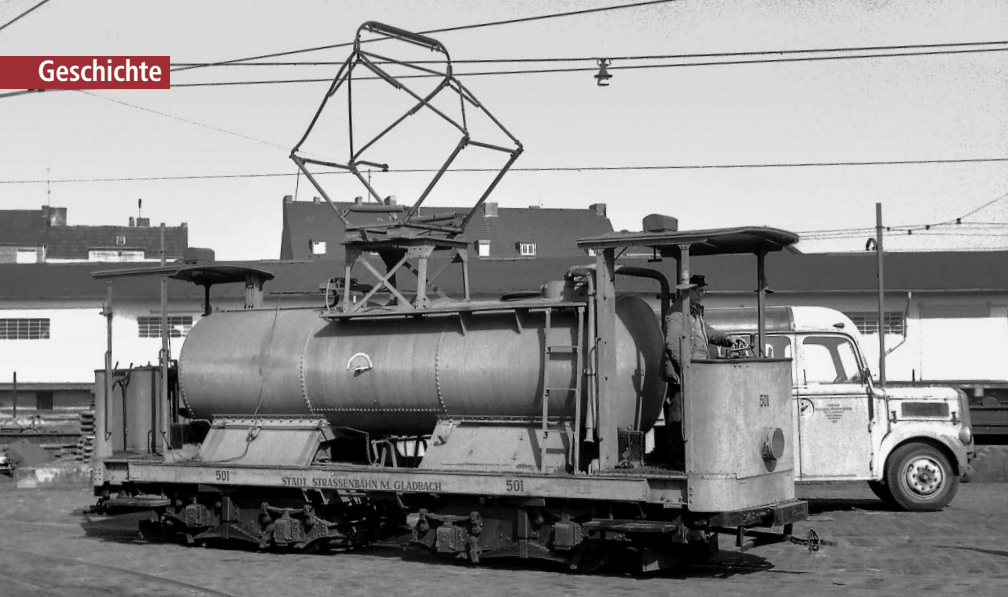
Als Beispiel für die als solche beschafften Dienstwagen der Mönchengladbacher Straßenbahn ein Bild des urigen vierachsigen Sprengwagens 501 (vermutlich ex Düsseldorf)
