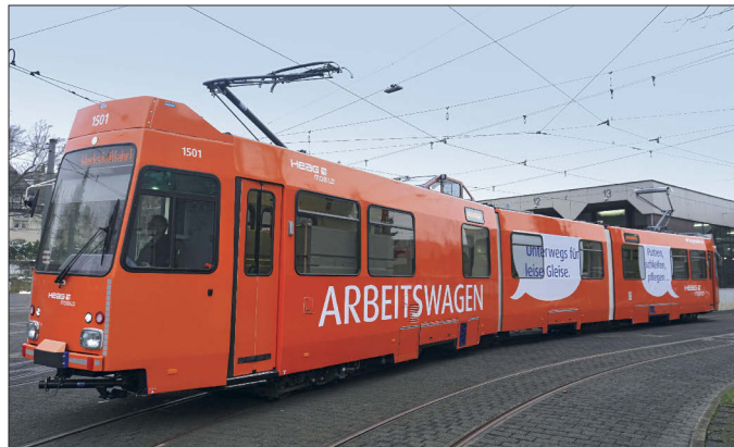
Darmstadt: Der neue Multifunktions-Arbeitswagen 1501, der aus dem vormals Augsburger M8C bei IFTEC in Leipzig entstanden ist HEAG MOBILO
