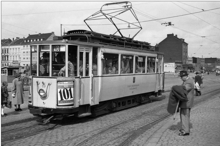
Die wegen ihrer elektrischen Ausrüstung „Charleroi-Wagen“ genannten Zweiachser von 1913 besaßen einen vierfenstrigen Wagenkasten
