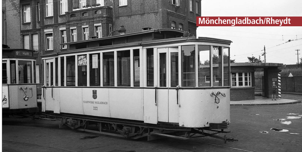
Die Beiwagenvariante der Verwandlungswagen stand nach Umbau in vollständig geschlossene Wagen noch bis in die 1950er-Jahre im Einsatz
