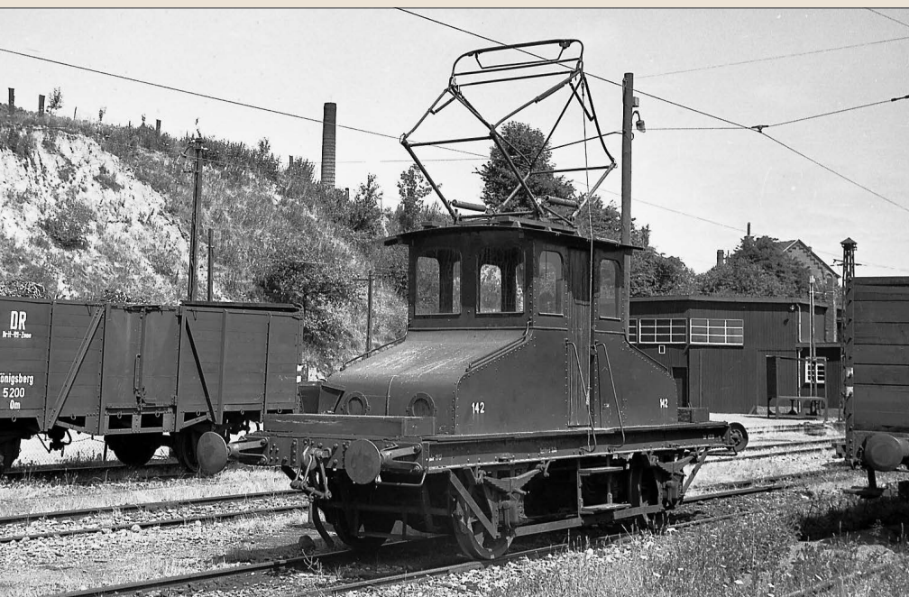
Eine Rheydter Besonderheit waren die beiden elektrischen Normalspurlokomotiven für den Verschub der zur Verladung auf meterspurige Rollwagen vorgesehenen Güterwagen. Die E-Lok 142 entstand 1913 im Eigenbau
