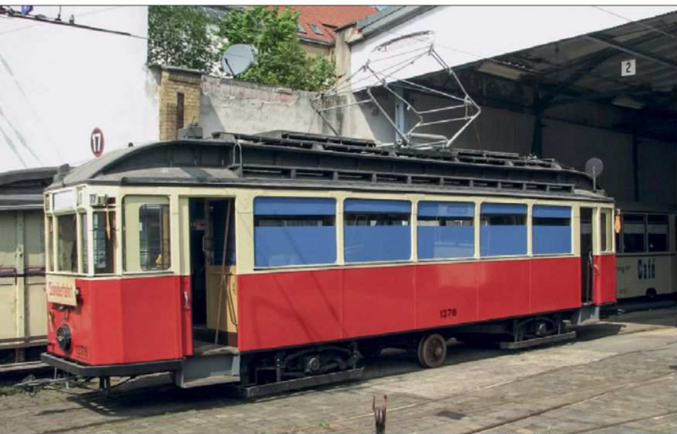
Von den Leipziger Dreiachsern ist im dortigen Straßenbahnmuseum Triebwagen 1378 erhalten. Der Wagen wurde im Kriegszustand mit Verdunklung restauriert. Auf dem Foto ist der Radschutzkasten der Mittelachse zu Wartungszwecken demontiert
