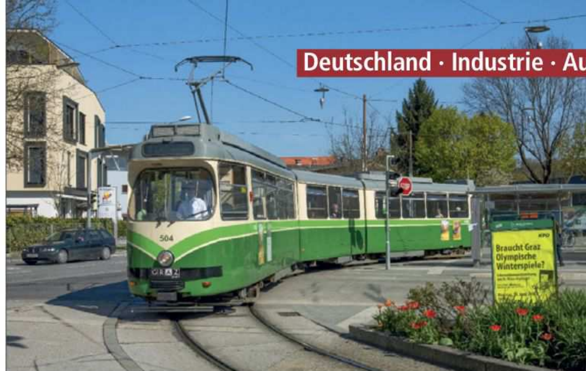
Graz: Der erste antriebstechnisch modernisierte Wagen Typ „Mannheim“ Tw 504 am 19. April in Graz-Andritz. Der Einbau eines Niederflurmittelteils soll folgen
