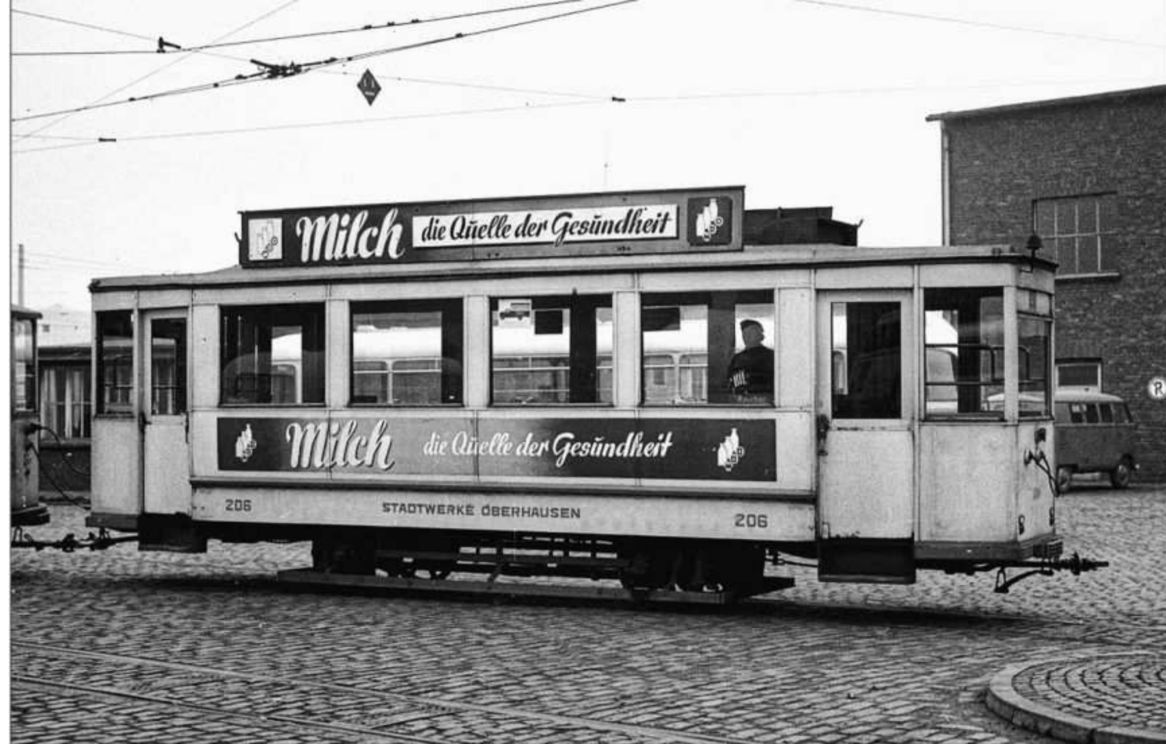
Lang und hochbeinig waren die 1939 von der BOGESTRA übernommenen Beiwagen von 1912. Im Umbauzustand von 1948 ist Wagen 206 im Jahre 1958 im Betriebshof fotografiert worden GERD LEIMBACH, SLG. VDVA
