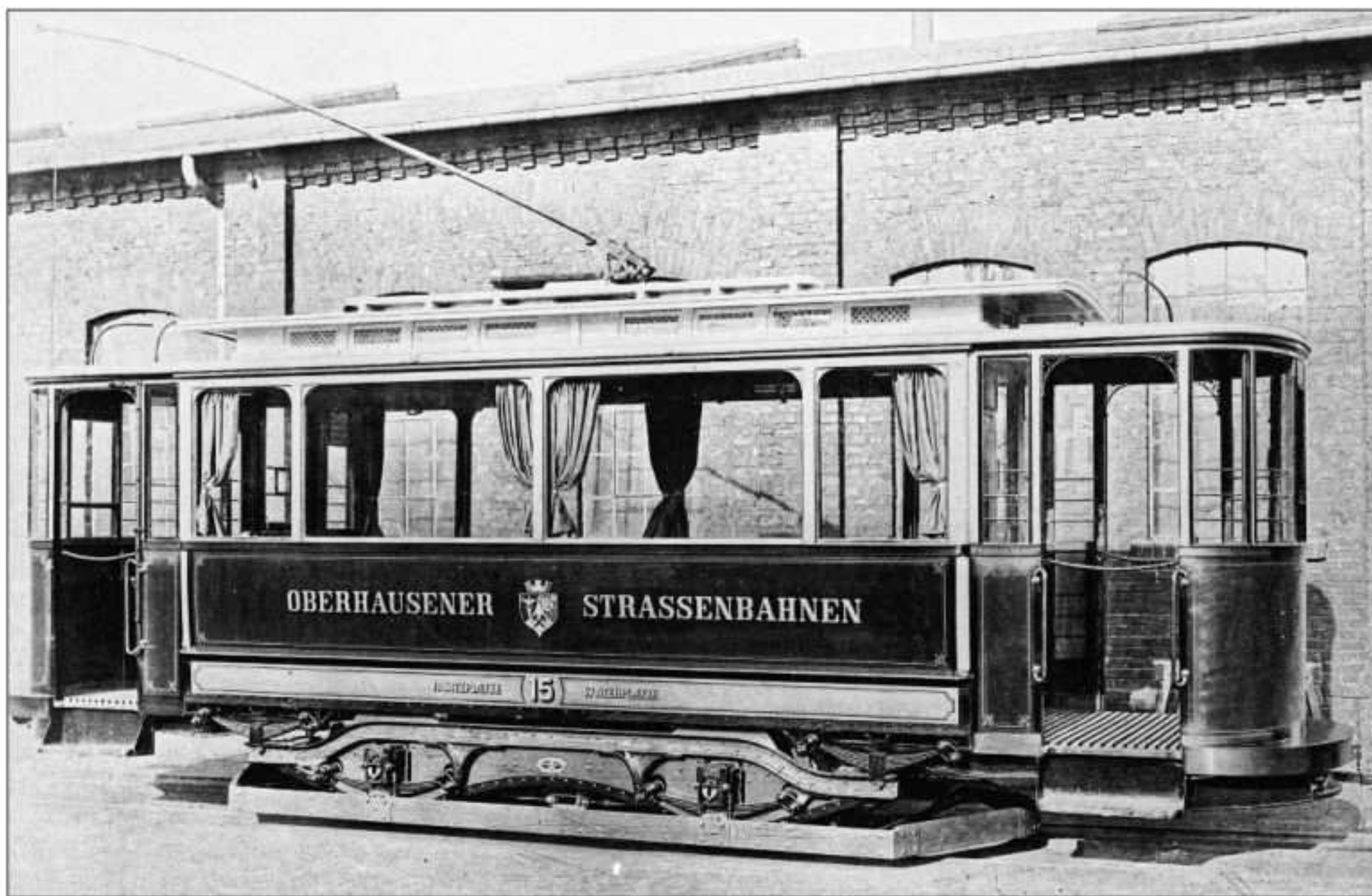
Seitenansicht des 1899 gelieferten Triebwagens 15, aufgenommen noch im Werk von Herbrand und mit einem in Oberhausen nicht verwendeten Rollenstromabnehmer ausgestattet
