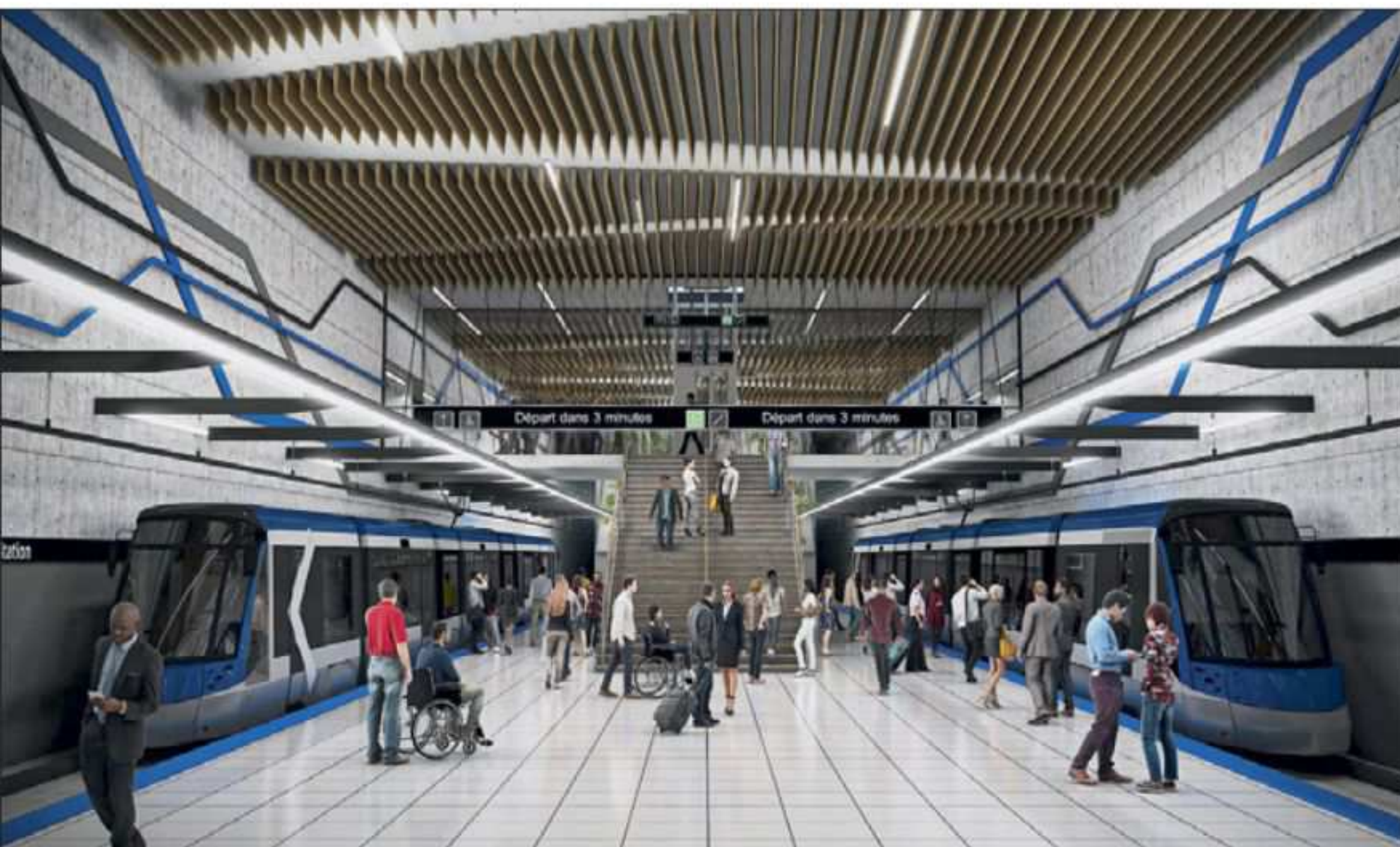
Québec: So stellen sich die Planer des neuen Stadtbahnsystems die innerstädtischen Stationen vor, es sind U-Bahn-ähnliche Tiefstationen mit Mittelbahnsteig vorgesehen
