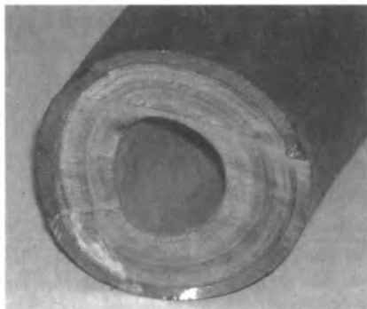
Рис. 128. Слой накипи, образовавшийся внутри трубы теплообменника
