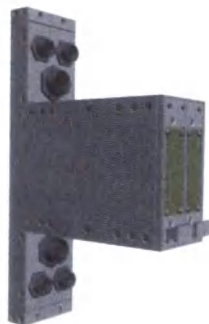
Рис. 263. Блок управления краном машиниста
