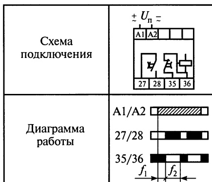
Рис. 91. Реле РСВ-15-3
