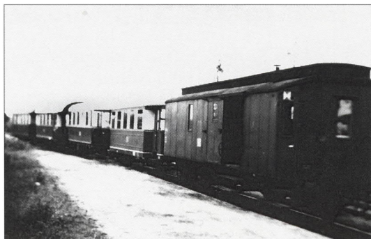
Nach Aussonderung der alten Länderbahn-Personenwagen sind ersatzweise Triebwagen-Beiwagen als Zugverband mit einer Kleindiesellok zum Einsatz gekommen. Im Bild ist der abfahrtsbereite Zug mit einem preußischen Nebenbahn-Gepäckwagen in Rövershagen Klb 1967 zu sehen.
