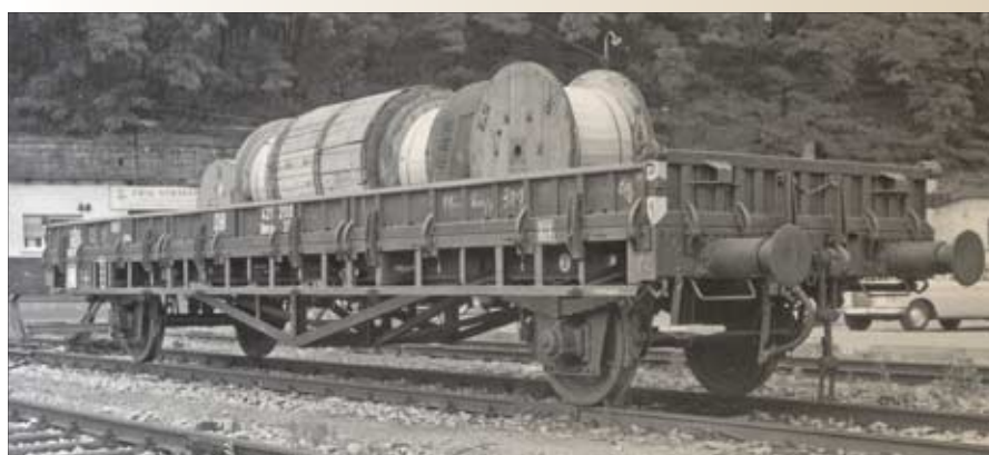
Der Rmrso 31 431 200 mit wenigen Klappenverstärkungen und Rollenlagerradsätzen 1964 in Stuttgart. Foto: Fritz Willke, Slg. Klaus Heidt
