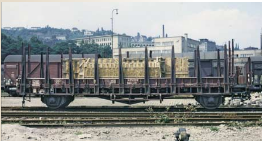
Der Rms 31 425 350 mit Handbremsbühne, Klappen mit weitem Abstand der Verstärkungen und Pressblechungen in den 60er-Jahren in Stuttgart. Foto: Fritz Willke, Slg. Klaus Heidt
