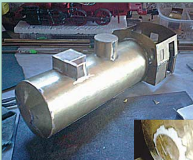
Der Kesseldeckel wurde verspachtelt, damit Naht und Übergang zur planen Mittelplatte nicht mehr zu sehen sind. Ebenfalls aus Messing wurden vorderer Pufferträger, Umlauf, Leitern und Laternen gebaut. Charakteristisch für eine Dampfspeicherlok: der Stutzen vorn am Kessel.
