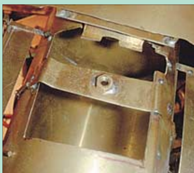
Im Führerhausboden mussten zwei kräftige Profile eingelötet werden. Zwischen diesen Profilen und der Unterkante des Kessels blieb noch ein Spalt, in den später der hölzerne Fußboden eingebaut wurde.
