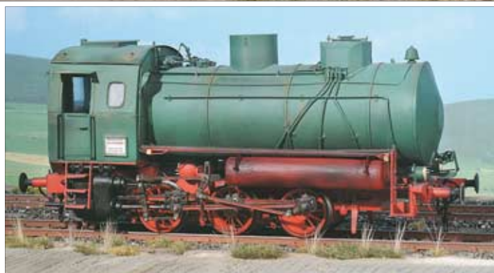
Die rechte Seite der Lok trägt den großen Luftbehälter.
