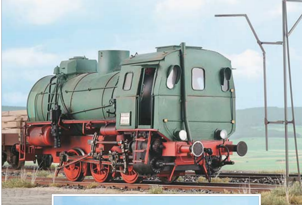
Der „Auspuff“ der Dampfspeicherlok liegt auf der Rückseite des Führerhauses.
