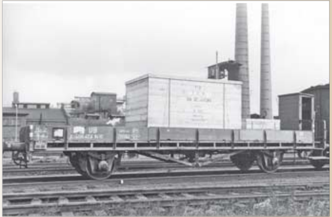
Der Ro 10 409 474 mit Bremserhaus und ohne Rungentaschen im Oktober 1957 im Rbf Hamburg Süd. Foto: Hollnagel
