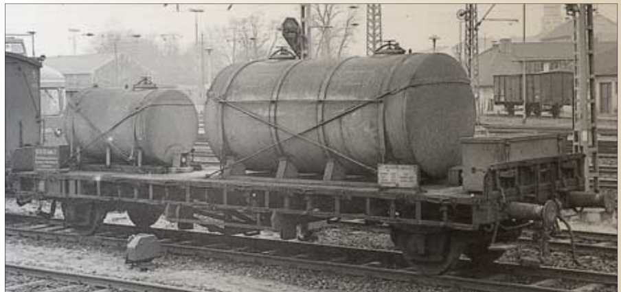
Heizöltanks transportiert der Rmms 56 mit der Nummer 455 963, gesehen im Jahr 1963 in Nürnberg. Zur Sicherung der leichten Tanks genügen erstaunlich dünne Drähte ... Foto: Heinz Künneth
