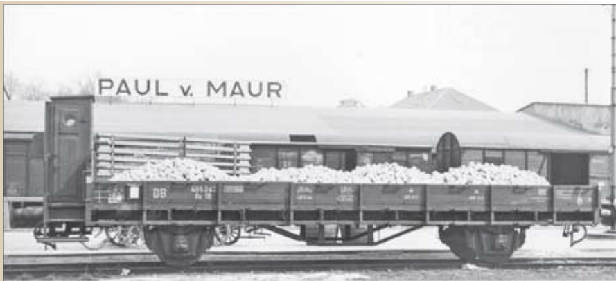
Der Ro 18 405 242 in den 50er-Jahren in Stuttgart fotografiert. Wie alle österreichischen Austauschbauwagen hatte er keine Druckluftbremse.
