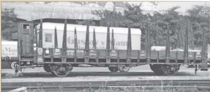
Zwei Austauschbauwagen in den 50er-Jahren fotografiert: Oben der R 20 402 984 mit Bremsenhaus, unten der Rr 20 403 703 mit Druckluftbremse. Fotos: Fritz Willke, Slg. Klaus Heidt
