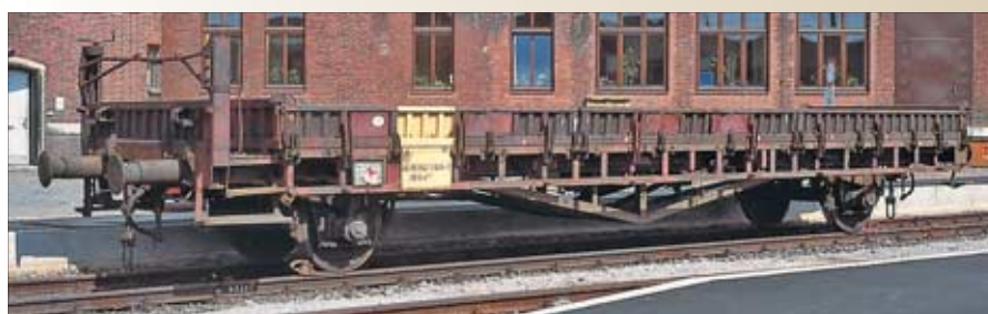
Der U-x 150 942 1 846 mit Handbremsbühne und der ursprünglichen Klappenform im Mai 1988 im Gbf Hamburg Sternschanze. Foto: Stefan Carstens
