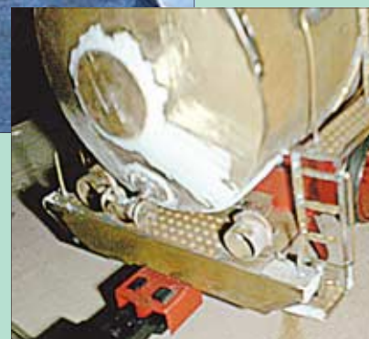
Der Kesseldeckel wurde verspachtelt, damit Naht und Übergang zur planen Mittelplatte nicht mehr zu sehen sind. Ebenfalls aus Messing wurden vorderer Pufferträger, Umlauf, Leitern und Laternen gebaut. Charakteristisch für eine Dampfspeicherlok: der Stutzen vorn am Kessel.
