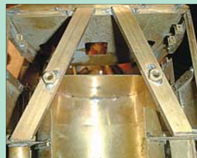
Eine Quertraverse mit aufgelöteter Mutter bildet den vorderen Anschraubpunkt für das Fahrwerk.
