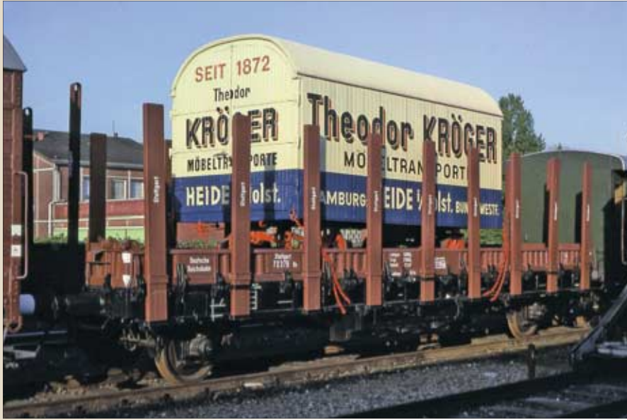
Der Museumswagen Rs Stuttgart 72 379 am 18. Mai 1989 in Glückstadt. Enger Abstand der Verstärkungsrippen und Holzrungen entsprechen der Ursprungsausführung, die Rollenlager-radsätze sind hingegen eine „DB-Zutat“. Foto: Stefan Carstens
