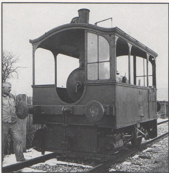
Bild 82: Ehemalige Trambahnlokomotive, von Krauss in München-Sendling 1891 gebaut (Fabrik-Nr. 2433). Lokomotiven solchen Typs wurden der LEB angeboten. Das Foto zeigt eine solche Maschine um 1930 im Dienst der Kunstmühlenwerke Beckh/Aichach. Foto: E. Schörner
