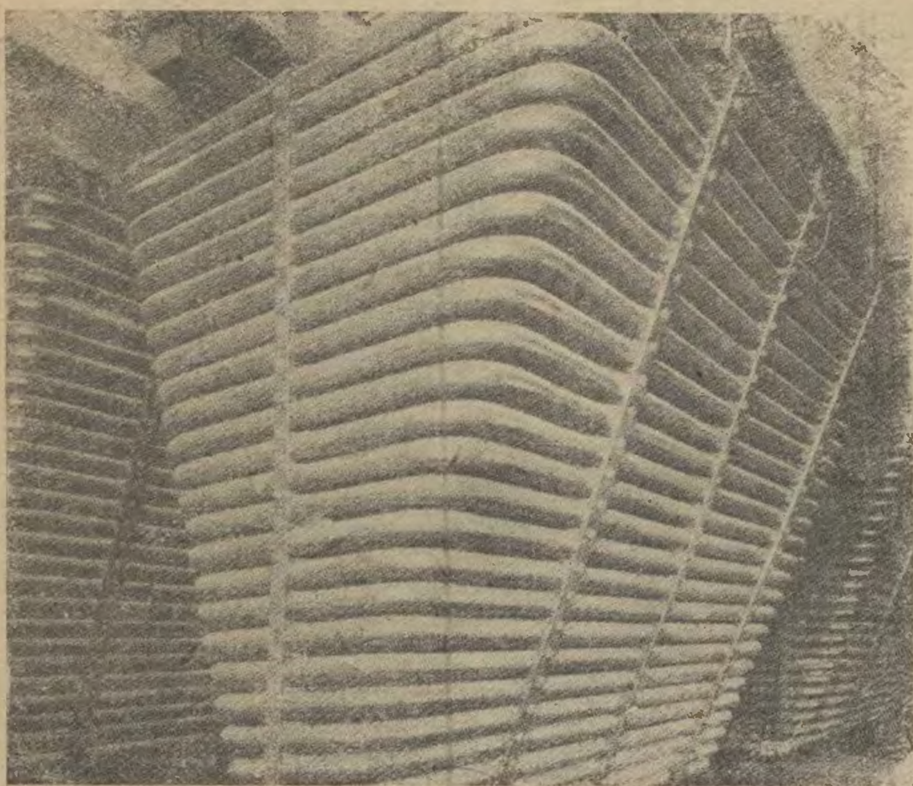
Фиг. 10. Батареи для сушки песка паром.
