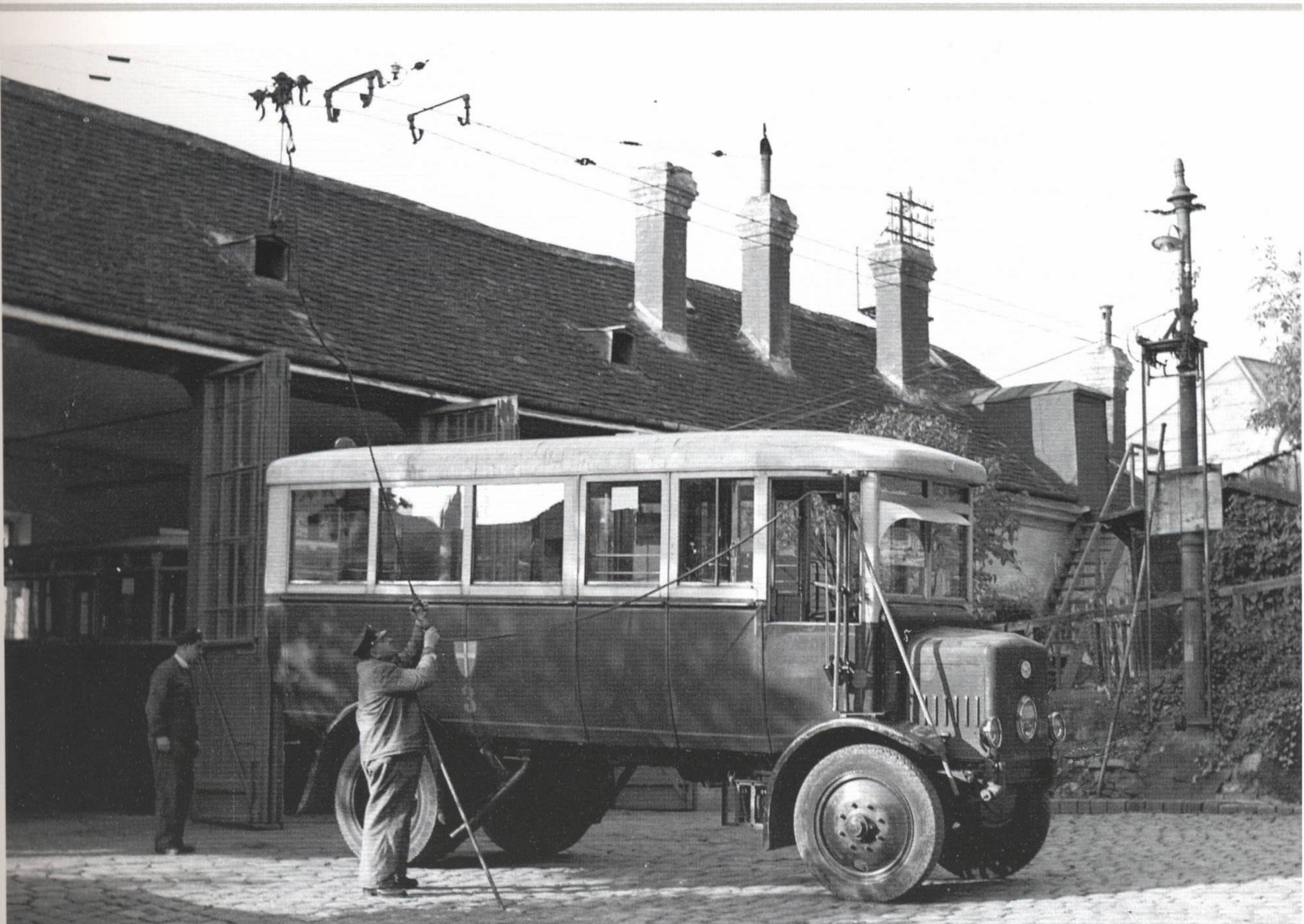
Der Kontaktwagen wird am Motorwagen Nr. 3 angebracht
