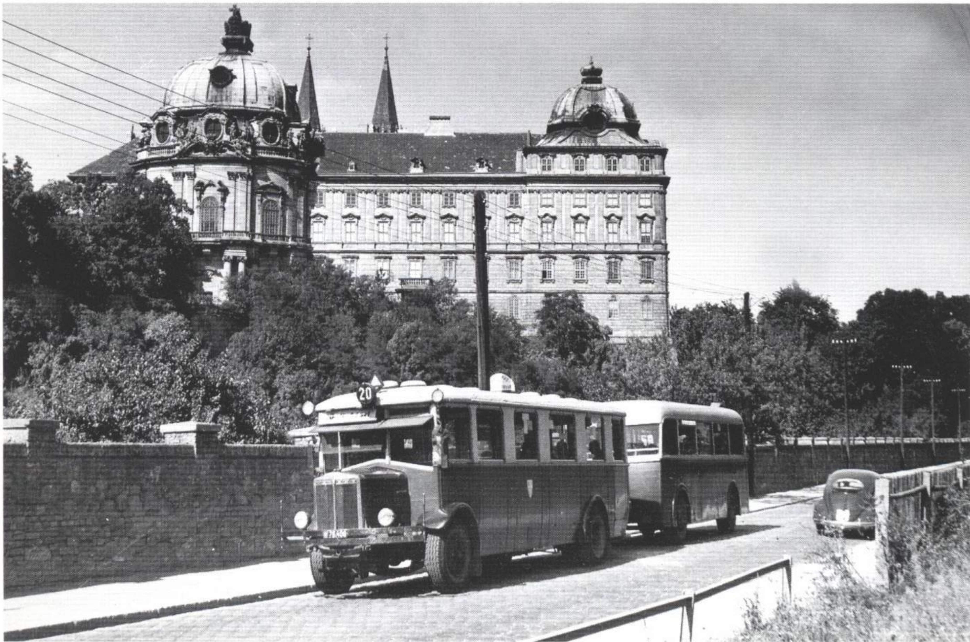
Ein Fross-Büssing-Bus der Type WIVO-D fährt mit einem OA-I - Anhänger auf der Buslinie 20 am Stift Klosterneuburg vorbei. Wiener Linien
