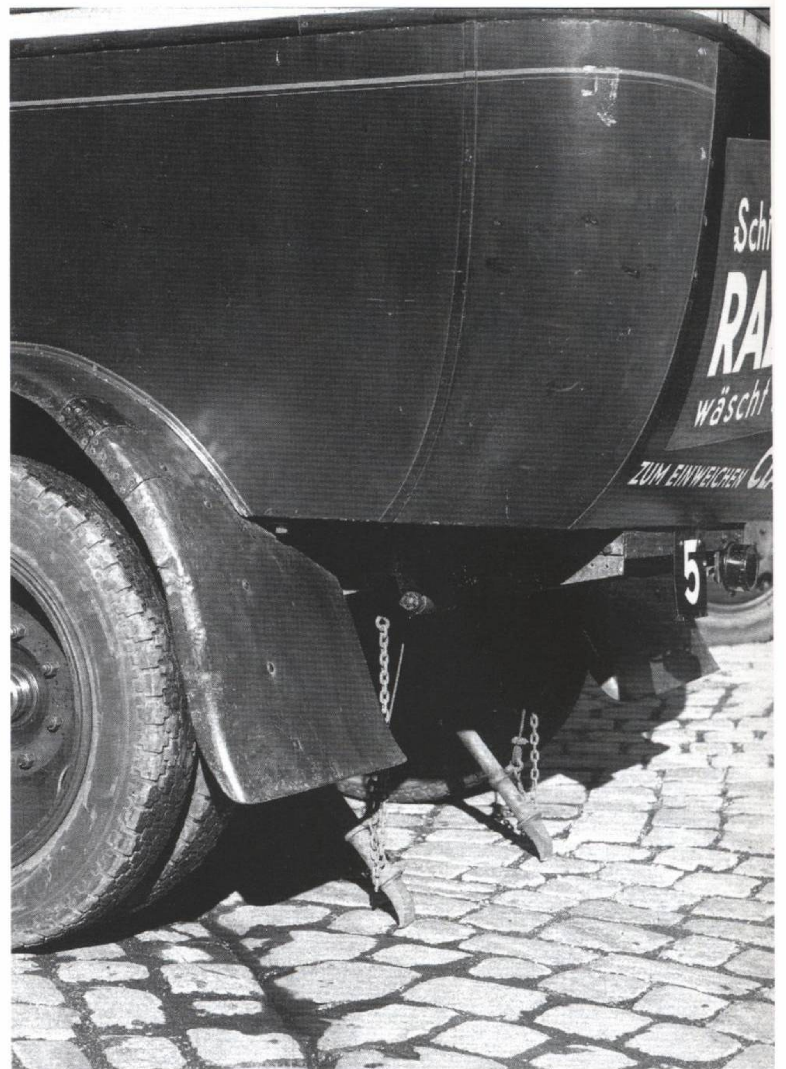
Auf diesen Bildern des Wagens Nr. 5 sieht man die Funktion der „Bergstütze“: Links in der Betriebsstellung (angehoben) und rechts abgesenkt, um ein Zurückrollen des Wagens zu vermeiden.
