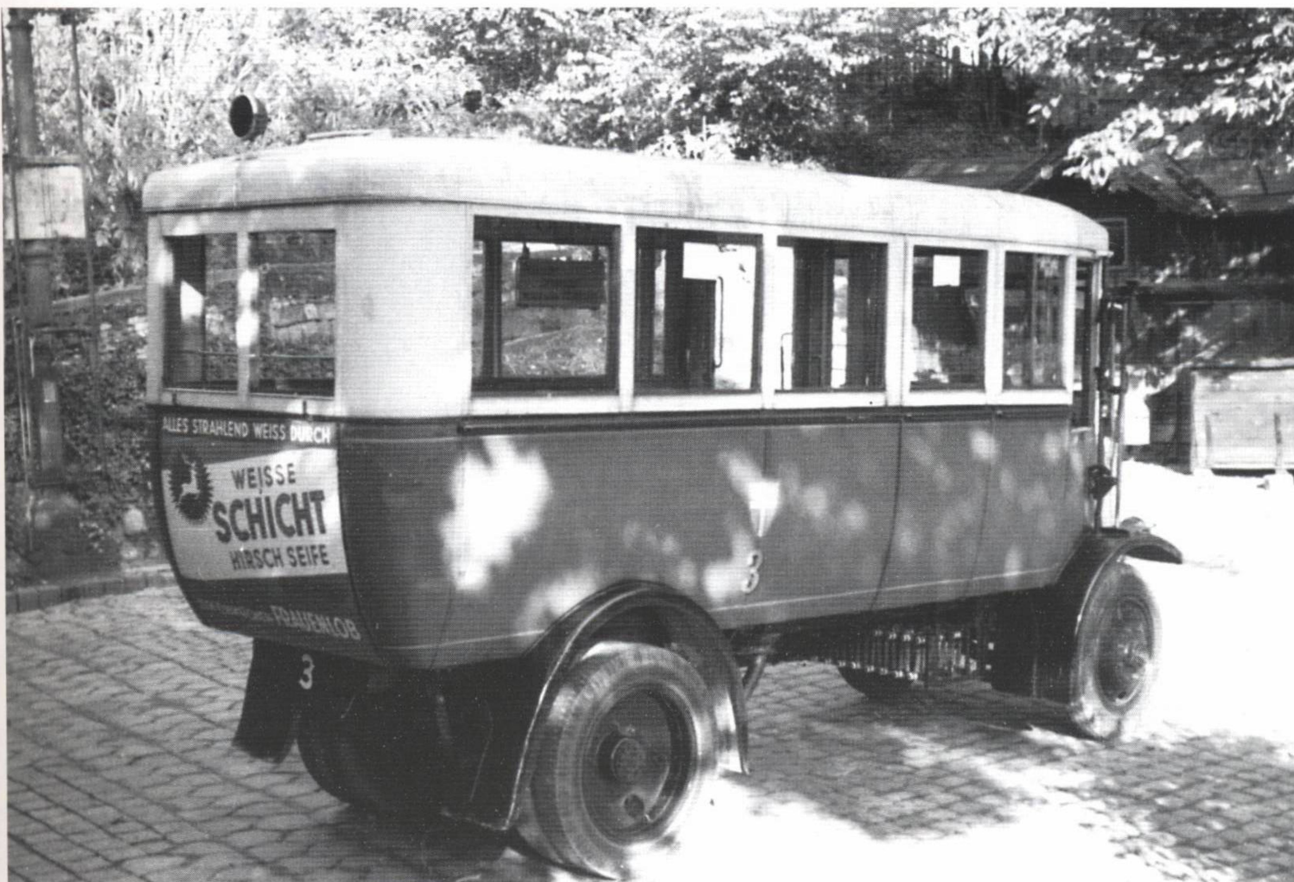
Am Wagen Nr. 3 ist am Dach das neue „Stopplicht“ zu sehen. Man erkennt auf diesem Bild auch sehr gut die unter dem Wagen angebrachten Anfahr- und Bremswiderstände.
