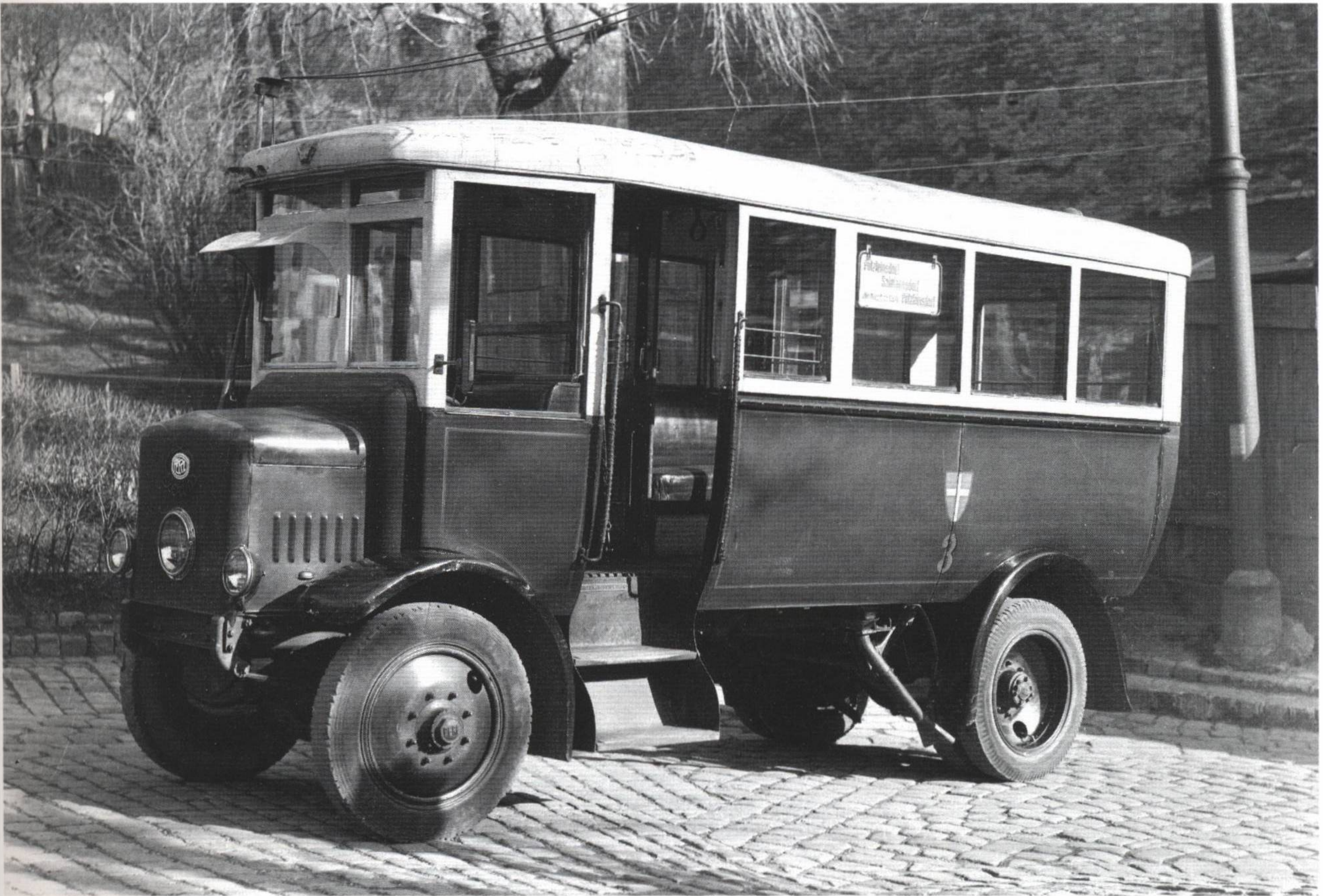
Die letzte Neuanschaffung: Der im Jahr 1929 gelieferte Wagen 3 der Automobilfabrik Perl A.G. in Atzgersdorf steht in der Remise in der Pötzleinsdorfer Straße: 30 PS-Motor, Kraftübertragung über Schneckengetriebe und Differential. Deutlich ist auch die Sandstreu- vorrichtung zu sehen, die normalerweise nur bei Straßenbahnen üblich ist.
