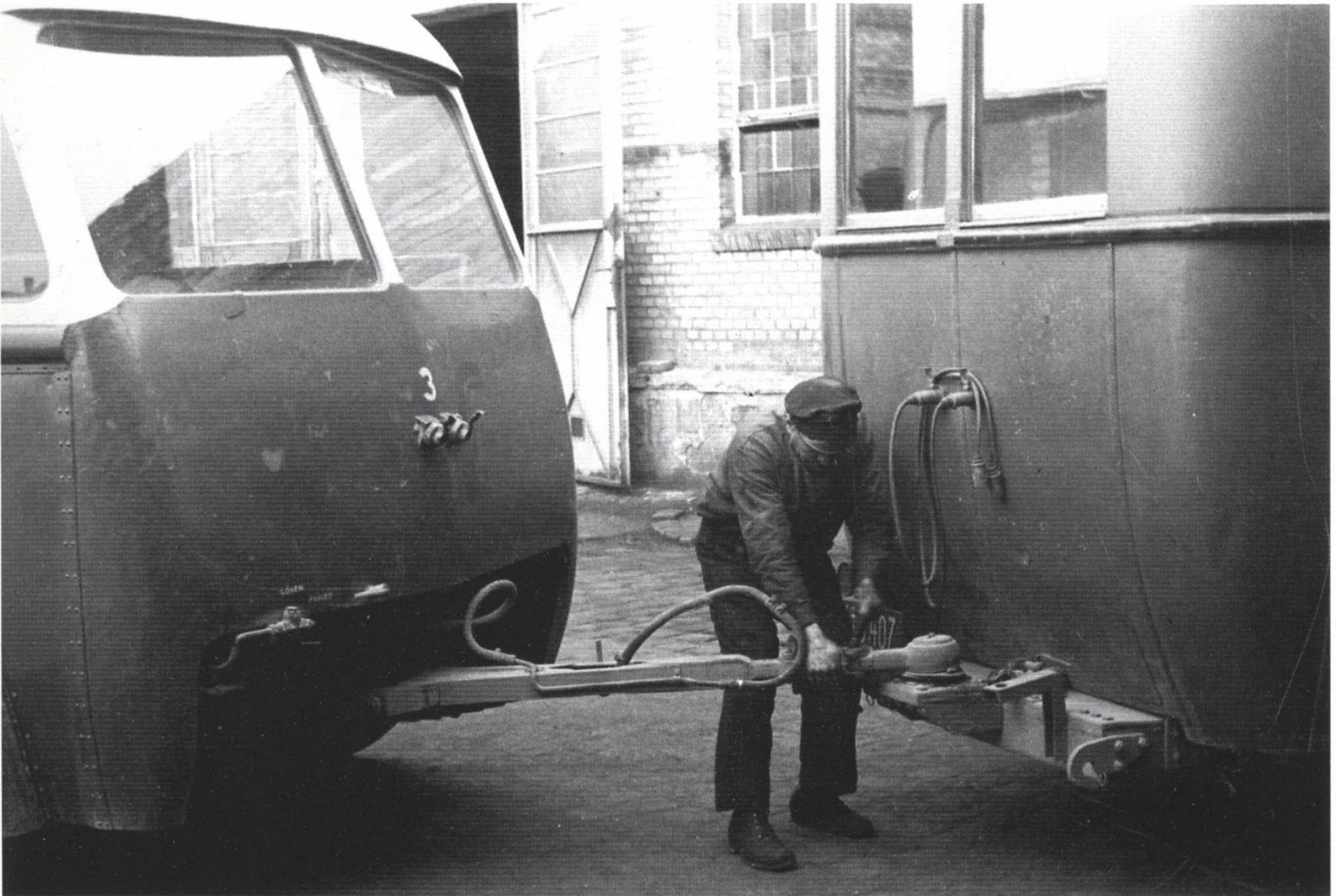
Kupplungsvorrichtung der Wiener Anhänger. Im Bild wird der OM 1-5 - Anhänger Nr. 3 an einen Fross-Büssing „W IV O“-Bus angekuppelt.
