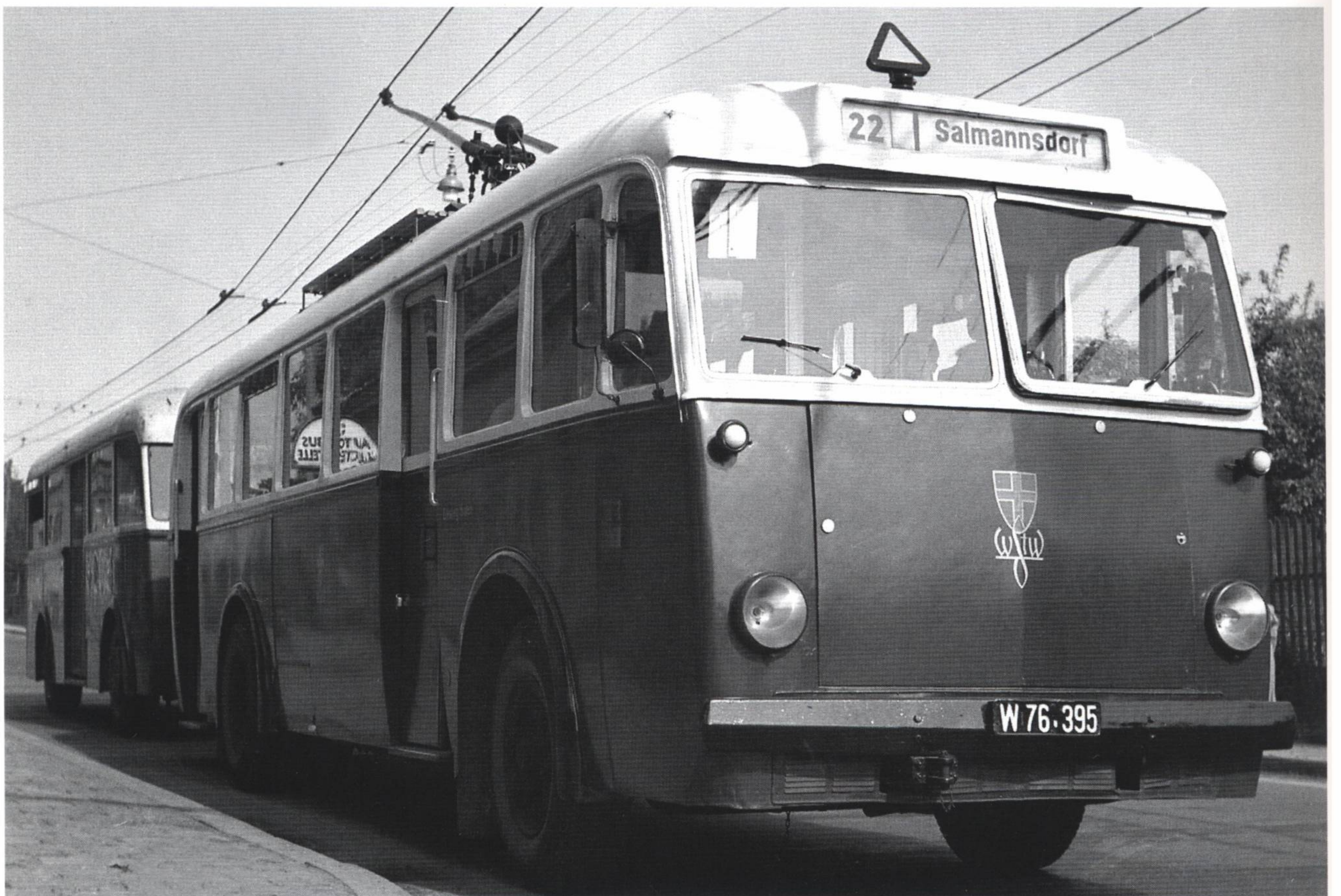
Motorwagen W 76.395 mit OA-I - Anhänger in der Krottenbachstraße. Am Dach des Motorwagens ist das „Anhängerdreieck“, das bis in die 1960er-Jahre an jedem Bus oder LKW mit Anhänger sichtbar sein mußte.
