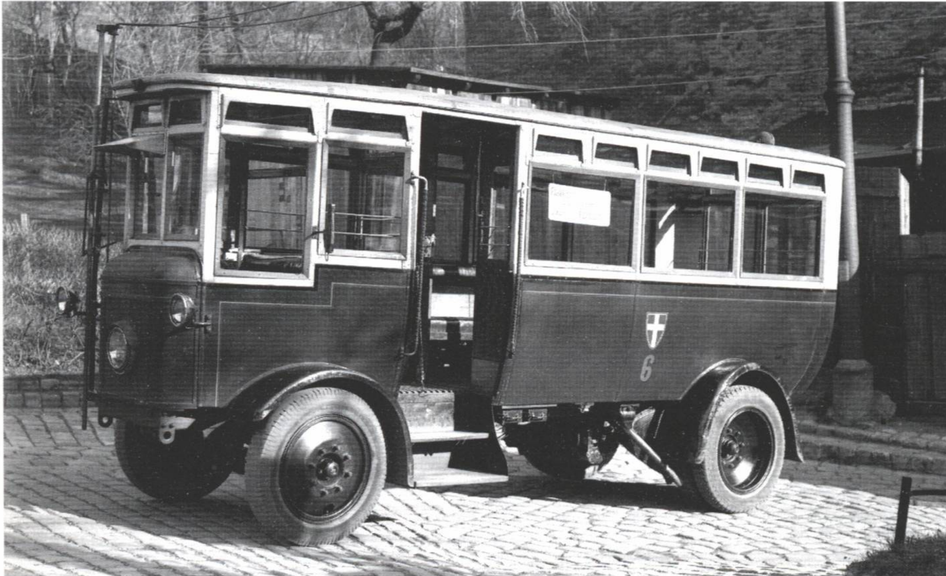
Auf die 1922 von der Österreichischen Daimler-Motoren-Gesellschaft gelieferten neuen Unter- gestelle montierte man vorerst die alten „M-É-S“-Wagenkästen. 1927 wurden diese durch neue Lohner-Aufbauten ersetzt.
