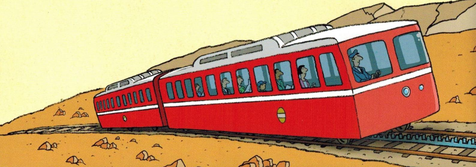
Фуникулёр поднимается на вершину горы и спускается вниз при помощи каната.
