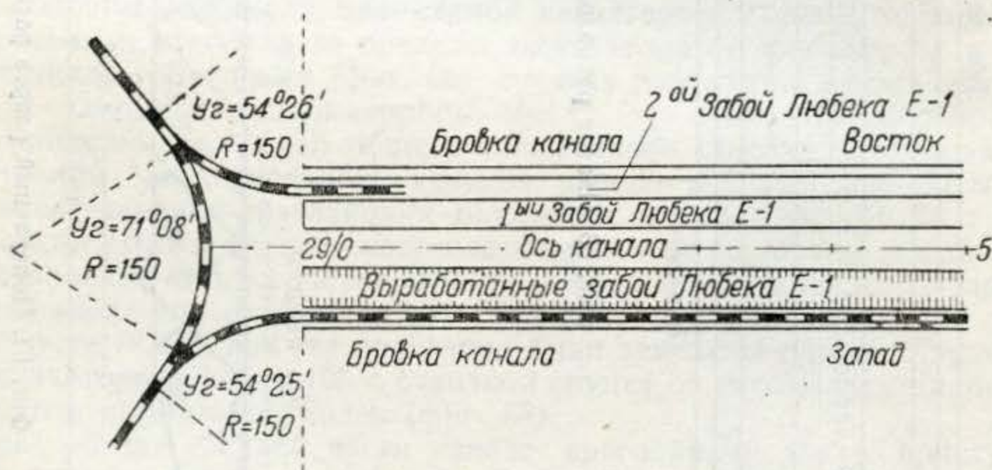
Фиг. 69. Схема перехода экскаватора Любек Е-1 с западной на восточную сторону.
