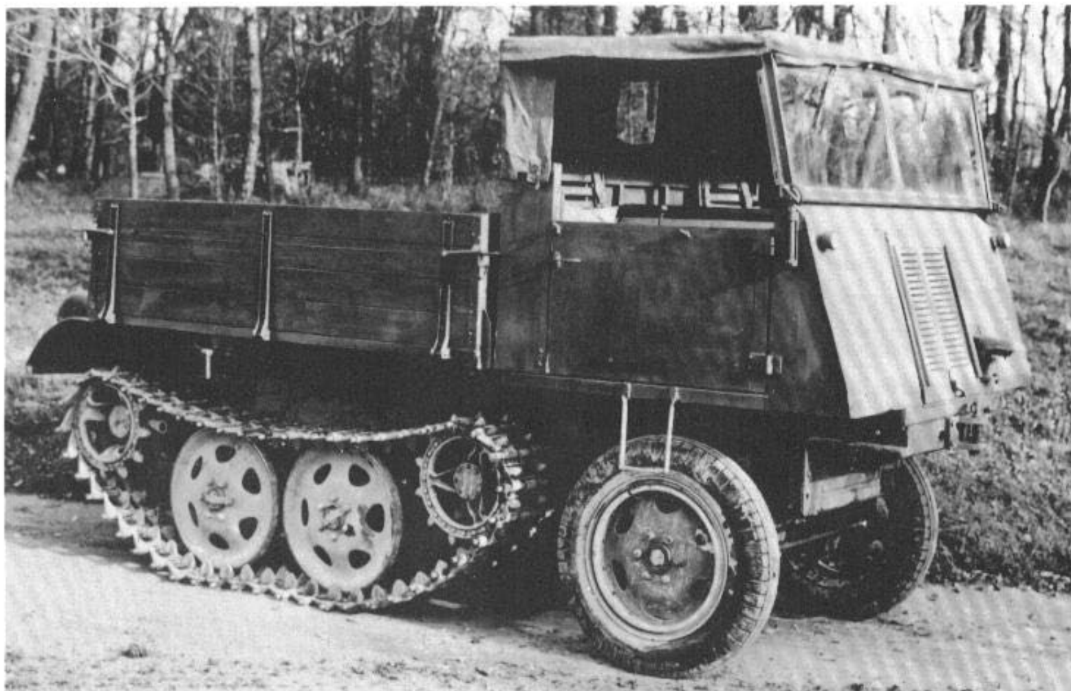
Aus Bauteilen des »Raupenschleppers Ost« baute die Klöckner-Humboldt-Deutz AG unmittelbar nach Kriegsende den Typ »RS 1500-Waldschlepper« der Fahrzeugserie 9314-16. Eines der letzten Halbkettenfahrzeuge.
