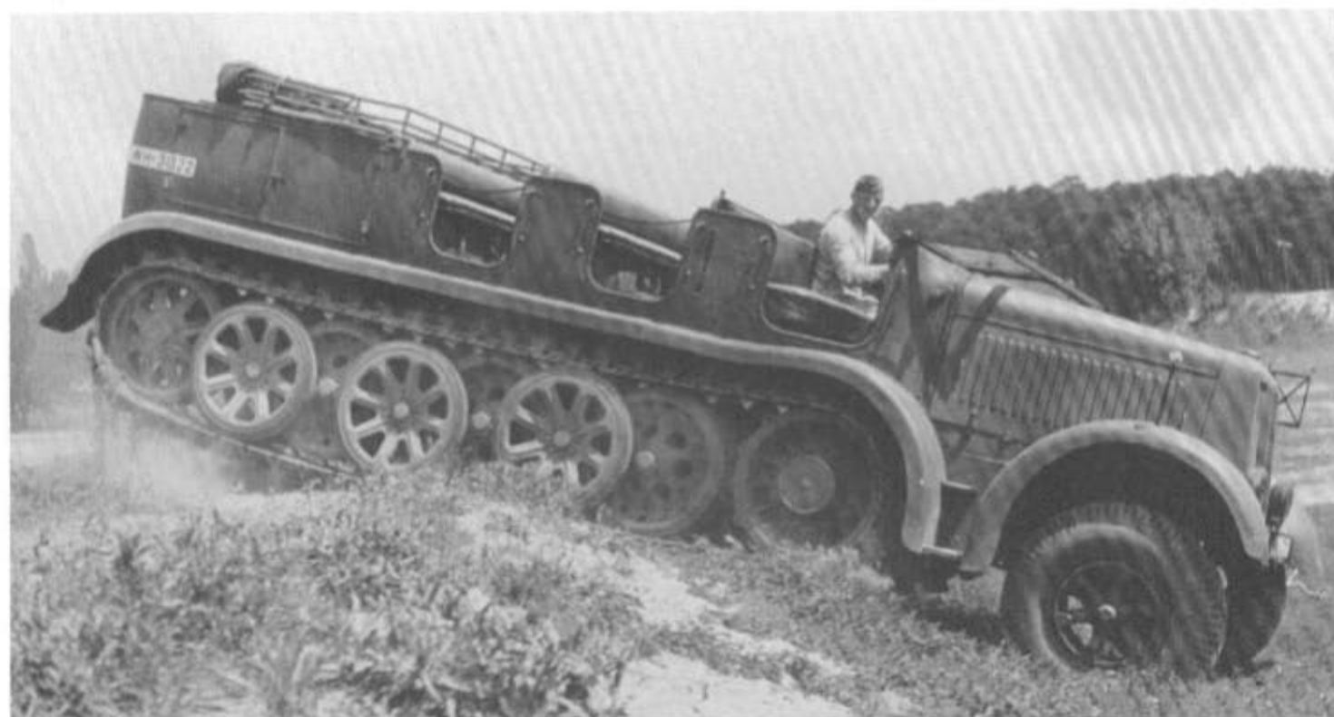
Der von 1938 bis 1939 gebaute Produktionstyp »DB 9« bei Versuchsfahrten im Gelände. Das Lichtraumprofil dieser Fahrzeuge konnte durch Umlegen der Windschutzscheibe beträchtlich verringert werden. ➡
