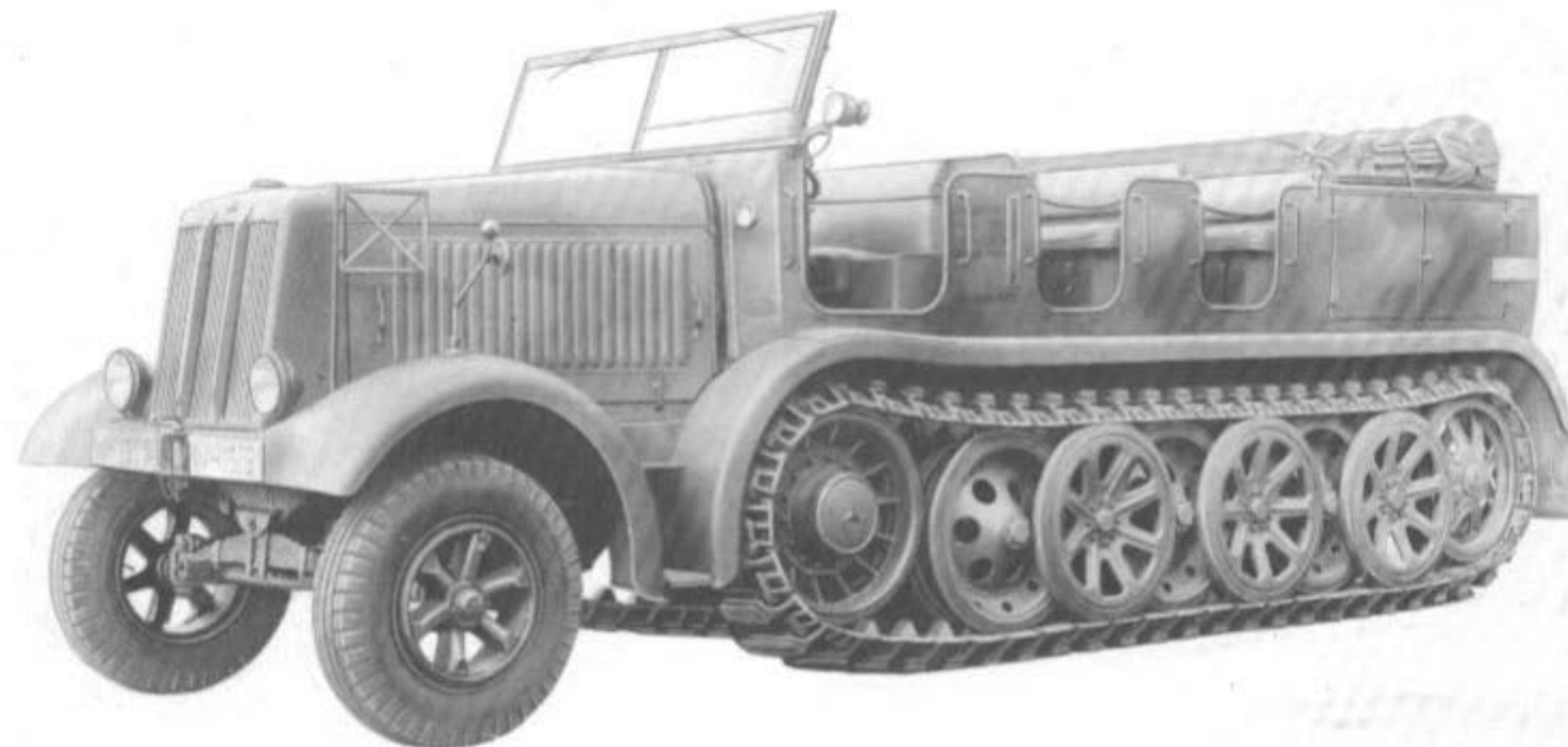
Der Typ »DB s 8« folgte 1936 und war noch immer mit dem Maybach »DSO 8« Motor ausgerüstet. Das Fahrzeug hatte nunmehr die mit den anderen Zugmaschinen-Typen einheitliche Form der Kühlerblende.
