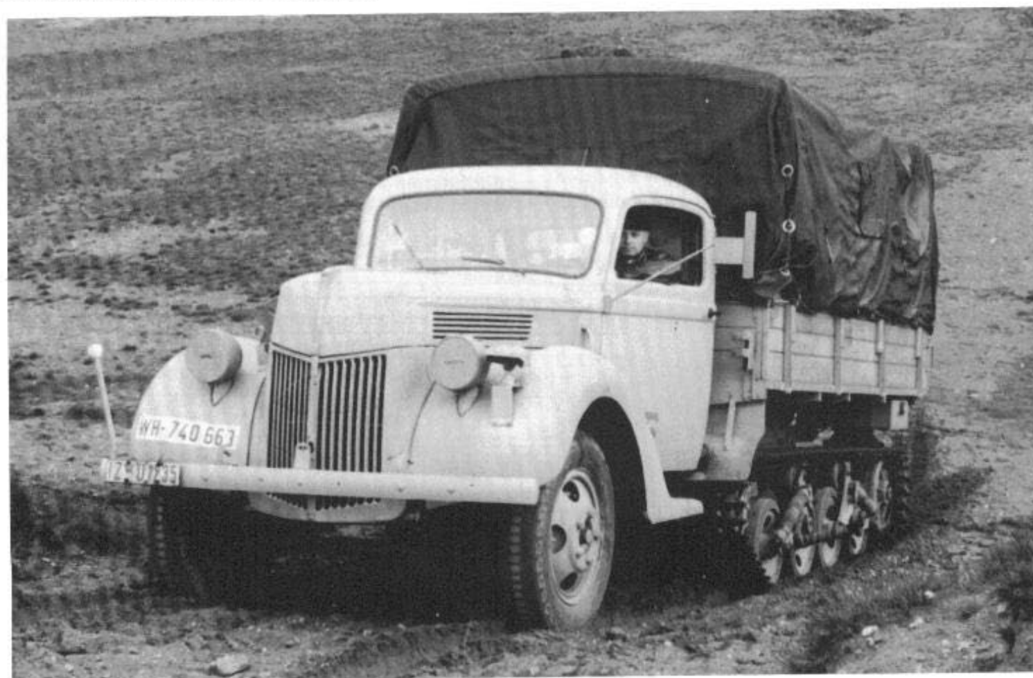
Die Produktionsausführung des am meisten gebauten »Gleisketten-Lastkraftwagens 2t« (Sd. Kfz. 3). Ford stellte ca. 14000 dieser Fahrzeuge her.
