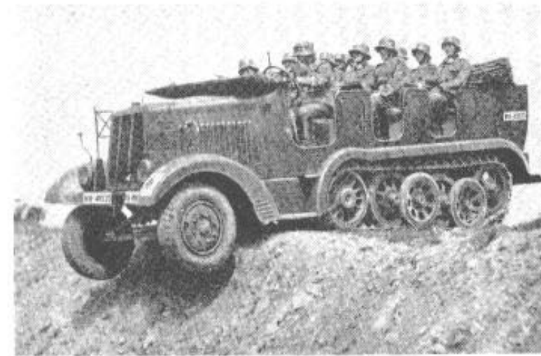
Der mittlere Zugkraftwagen 5t (Sd. Kfz. 6) wurde von Büssing-NAG als Typ »BN I 5« in den Jahren 1934 bis 1935 gebaut. Ein Maybach »NL 35« Motor war eingebaut.
