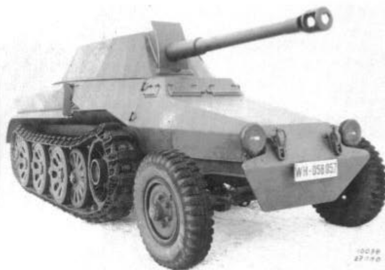
Einzelheiten des Fahrgestelles sowie die vorderen Einstiegöffnungen sind in diesem Bild gut zu erkennen. Büssing-NAG Bezeichnung des Fahrgestelles »BN 10 H«.
