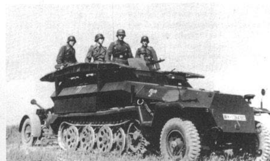
Der mittlere Pionier-Panzerwagen (Sd. Kfz. 251/7) erschien wiederum in zwei Ausführungen. Am Fahrzeug angehängt ist eine 2,8 cm schwere Panzerbüchse 41.
