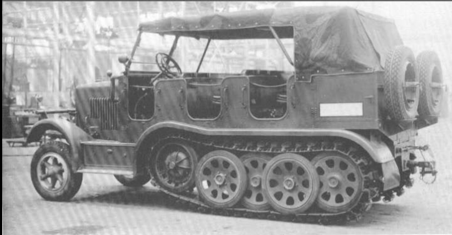
Zugkraftwagen 5 t (Sd. Kfz. 6) – Typ KM I 4, früher leichter, geländegängiger Zugkraftwagen (Vs. Kfz. 616) (1934).
