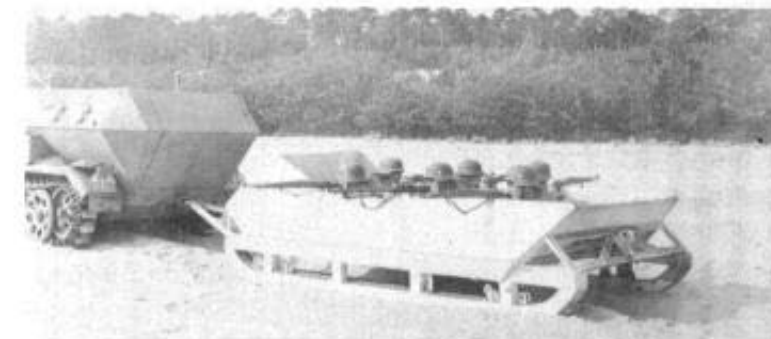
Leichte Anhängeschlitten nach russischem Vorbild wurden von mittleren Schützenpanzerwagen gezogen. Zugfahrzeug ist ein Fahrzeug der Ausführung A (Sichtklappen an den hinteren Seitenwänden).
