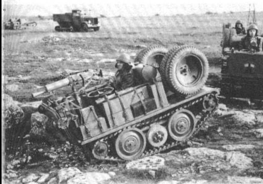
Das gleiche Fahrzeug bei der Verwendung als Vollkettenfahrzeug. Bezeichnend für diese Ausführung sind Laufräder größeren Durchmessers.
