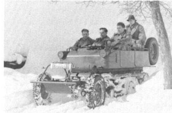
Bei einem anderen Prototyp wurde der Aufbau etwas verändert und die Scheinwerfer nunmehr an der Stirnseite angebracht. Auch wurden Versuche mit breiteren und schneegängigeren Ketten unternommen.
