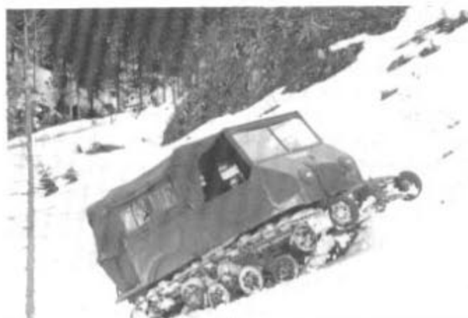
Die ungepanzerter Ausführung des Fahrzeuges »RR 7« lief als »Instandsetzungskraftwagen« mit einer Nutzlast von 1,5t.
