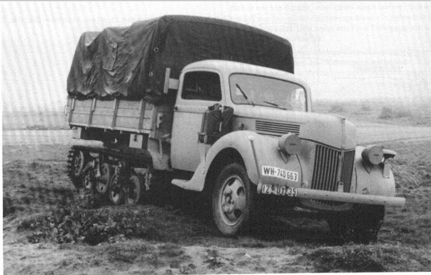
Die Produktionsausführung des am meisten gebauten »Gleisketten-Lastkraftwagens 2t« (Sd. Kfz. 3). Ford stellte ca. 14000 dieser Fahrzeuge her.
