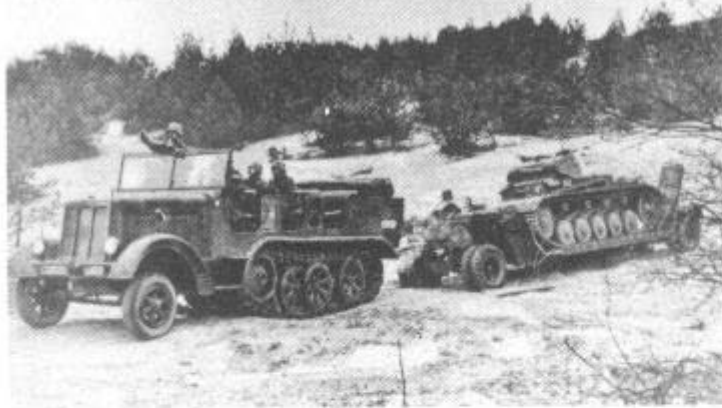
Zum Panzerbergedienst eingesetzte Zgkw. 8t zogen den Tiefladeanhänger für Panzerkampfwagen (Sd. Anh. 115) (Oben)
