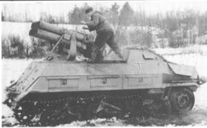
Der »15cm Panzerwerfer 43« (Sd. Kfz. 4/1) verwendete das Opel »Maultier« Fahrgestell der ursprünglichen Ausführung. Die Panzerblechstärke betrug 8mm. 300 dieser Fahrzeuge wurden gebaut.
