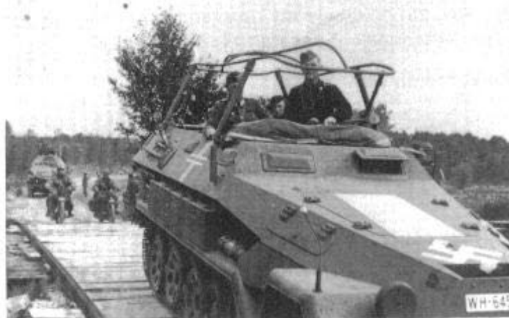
Der mittlere Pionier-Panzerwagen (Sd. Kfz. 251/7) erschien wiederum in zwei Ausführungen. Am Fahrzeug angehängt ist eine 2,8 cm schwere Panzerbüchse 41.
