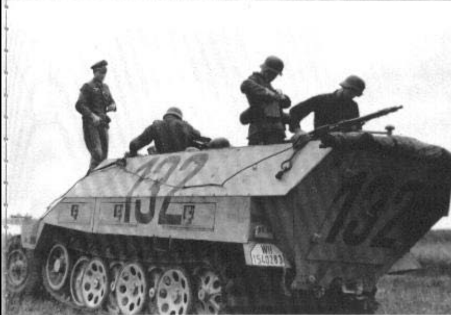
Leichte Anhängeschlitten nach russischem Vorbild wurden von mittleren Schützenpanzerwagen gezogen. Zugfahrzeug ist ein Fahrzeug der Ausführung A (Sichtklappen an den hinteren Seitenwänden).
