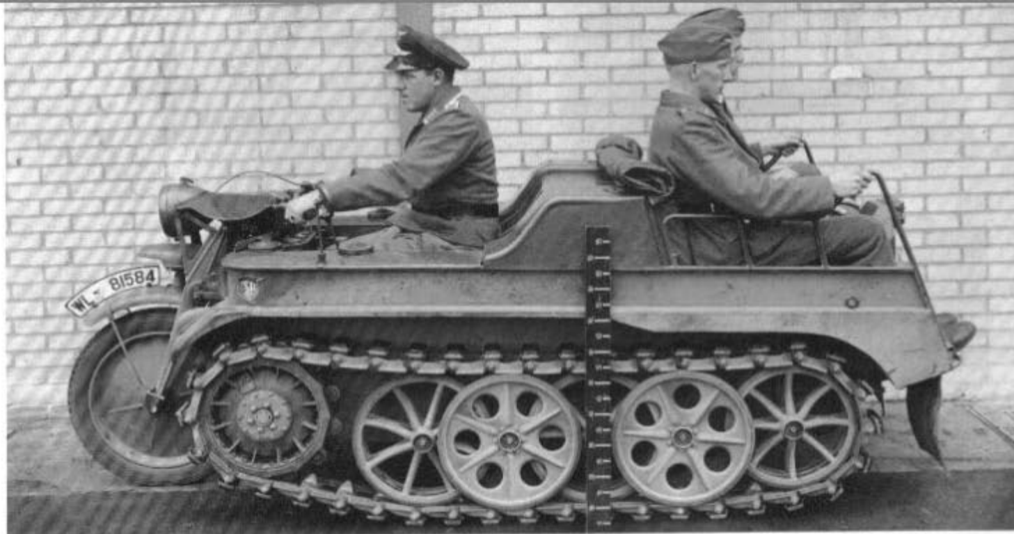
Kleines Kettenkrafttrad (Sd. Kfz. 2). Hier ein Fahrzeug der O-Serie, ausgeliefert an die Luftwaffe. Besatzung auf- gesessen.
