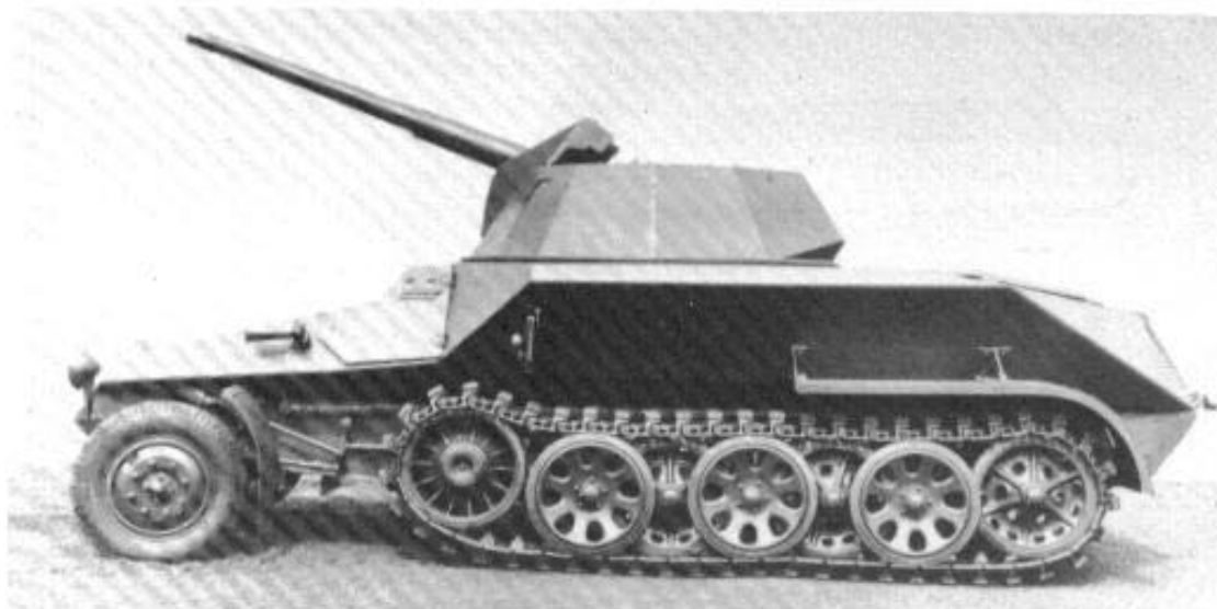
Bereits 1934 wurde Rheinmetall aufgefordert, in Zusammenarbeit mit Büssing-NAG die »7,5cm Selbstfahrlafette L/40,8« in erster Ausführung zu schaffen. Bild zeigt die Seitenansicht des Fahrzeuges mit der Kanone im Drehturm.
