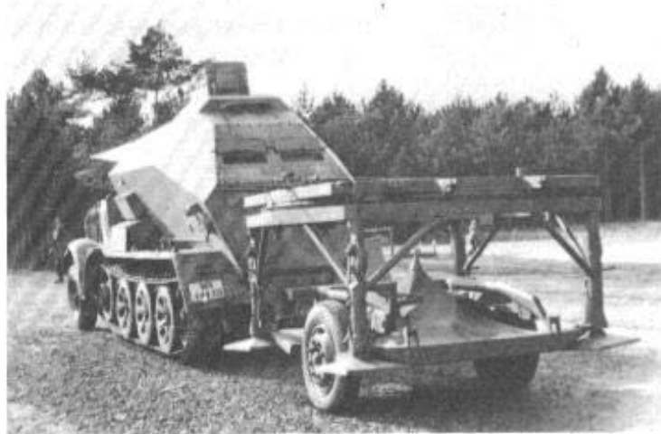
Ein Sd. Kfz. 7 als Feuerleitfahrzeug für »V-2« Raketen-Einheiten. Hinten am Fahrzeug die Abschußplatte für die Rakete.
