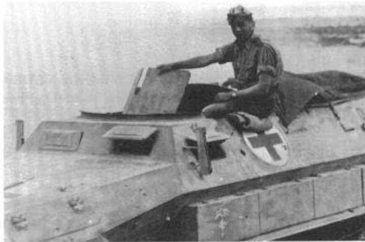
Fahrzeuge der Ausf. A wurden später in mittlere Krankenpanzerwagen (Sd. Kfz. 251/8) umgebaut. Bild zeigt eines dieser Fahrzeuge im Einsatz in Nordafrika.
