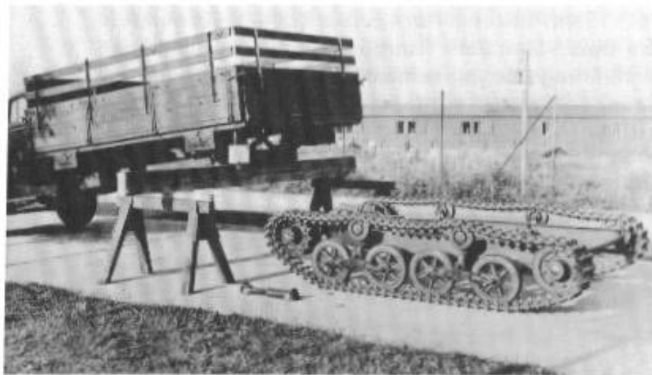
Bild zeigt das Opel-Laufwerk fertig zum Unterbau an einem Opel-Blitz Lastkraftwagen.
