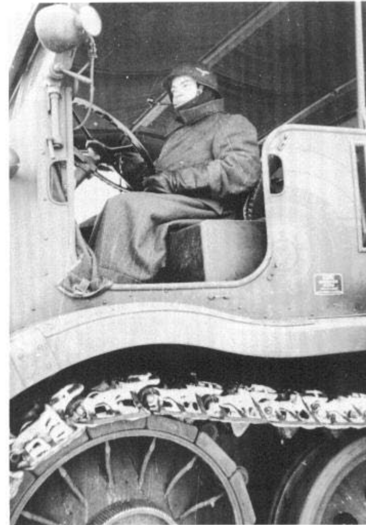
Das Fahrzeug »DB 9« beim Ziehen schwerer Geschütze. Diese Fahrzeuge besaßen neben einer ausgezeichneten Zugleistung auch eine ausreichende Geländegängigkeit.
