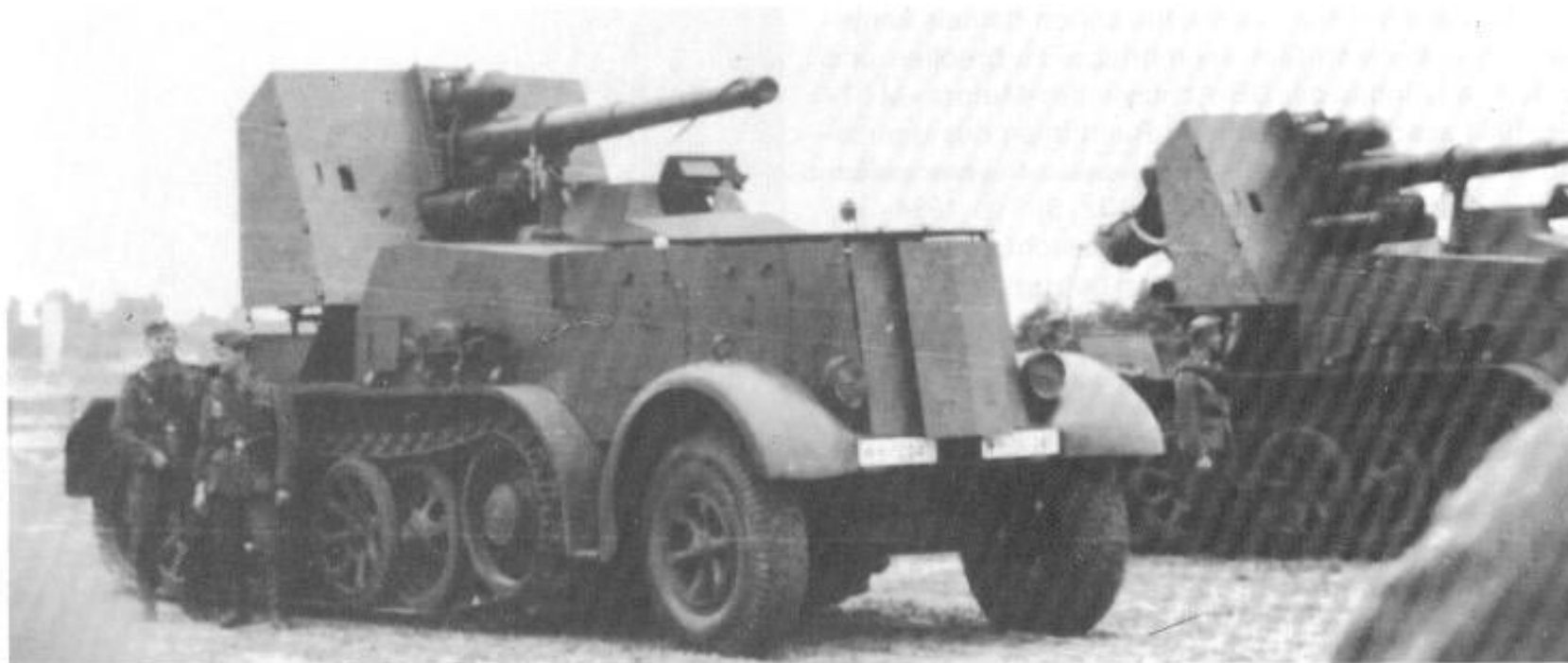
Als einzige Abart des 12t-Zgkw wurde der Aufbau einer 8,8cm Flak 18 bekannt (1940).
