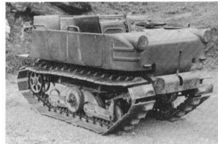
Bei einem anderen Prototyp wurde der Aufbau etwas verändert und die Scheinwerfer nunmehr an der Stirnseite angebracht. Auch wurden Versuche mit breiteren und schneegängigeren Ketten unternommen.
