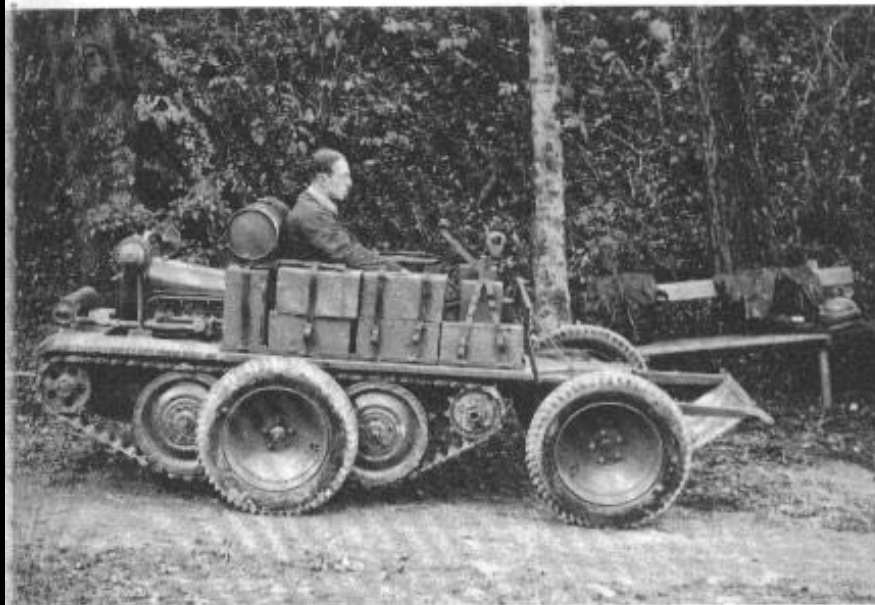
Das von Steyr-Daimler-Puch für das österreichische Heer entwickelte Räder-Raupenfahrzeug »ADMK«. Bild zeigt das Vorserienfahrzeug bei Räderbetrieb.
