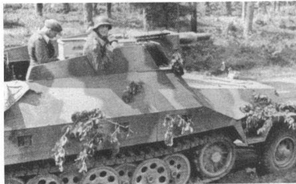
In der Abschlussausführung war die Seitenpanzerung für die Hauptbewaffnung seitlich weit zurückgezogen um die Besatzung besser zu schützen.
