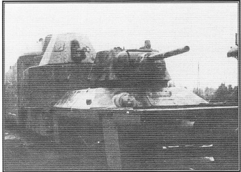
Panzertriebwagen 16 z Panzerjägerwagenem wykonanym z czołgu T-34(!), Skarżysko nad Kamienną we wrześniu 1944 roku. A Panzertriebwagen 16 with attached Panzerjägerwagen made of a captured T-34 tank(!), seen at Skarżysko nad Kamienną station in Poland in September 1944. [prof. dr Wolfgang Sawodny via Militaria No. 20 Panzerzüge vol. 1]
