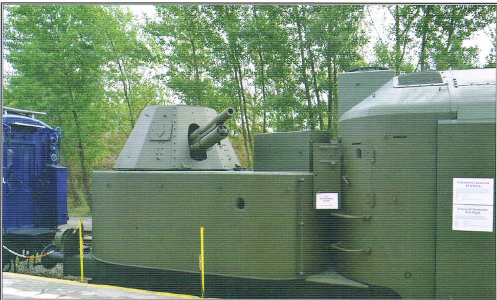
Panzertriebwagen 16 w Muzeum Kolejnictwa w Warszawie, wrzesień 2015 roku. Wieża z armatą 7,62 cm Fk 295/1(r) kalibru 76,2 mm, drzwi wejściowe.
