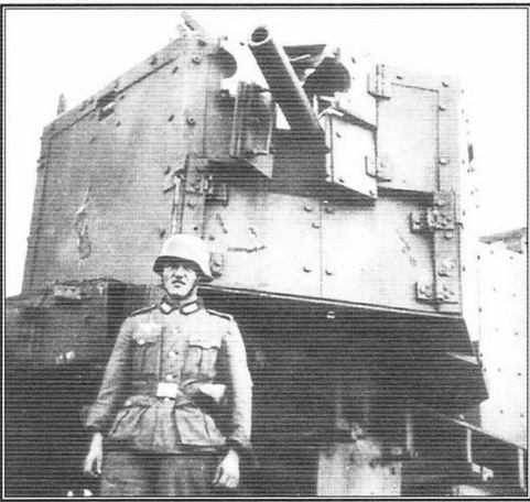
Wagon artyleryjski pociągu pancernego nr 3 uzbrojony w armatę kalibru 75 mm w obrotowej odkrytej wieży, wrzesień 1939 roku. An artillery wagon armed with an 75mm calibre gun mounted in open-topped turret of the Kampfzug 3 seen in September 1939. [prof. dr Wolfgang Sawodny via Militaria No. 20 Panzerzüge vol. 1]
