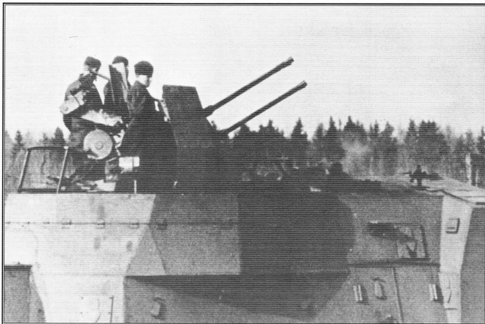
Pociąg pancerny typu BP-44 , front wschodni, 1944 rok. Na pierwszym planie wagon artyleryjski Geschütz-wagen uzbrojony w haubicę 10,5 cm leFH 18/40 i działko przeciwlotnicze 2 cm Flakvierling 38 .
