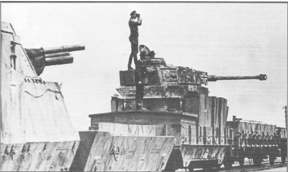
Pociąg pancerny typu BP-42 nr 66, lipiec 1944 roku. Unieruchomiony czołg PzKpfw IV Sd Kfz 161/1 Ausf. H umieszczony na platformie kole- jowej. A Panzerzug 66 type BP-42 seen in July 1944. The disabled PzKpfw IV Sd Kfz 161/1 Ausf. H tank mounted on the flatcar. [CAW 8135]
