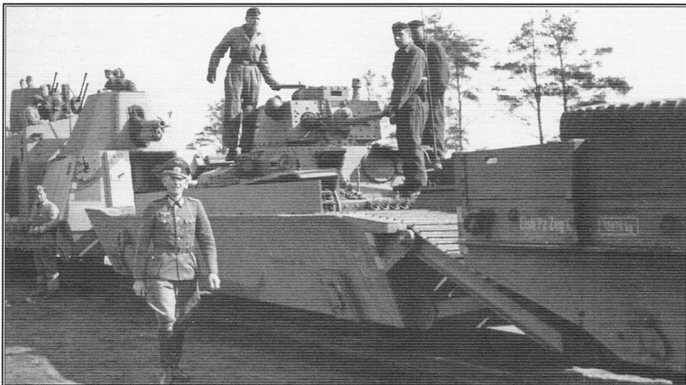
Pociąg pancerny typu BP-42 Panzerzug 63. Na pierwszym planie Panzerträgerwagen z czołgiem PzKpfw 38(t) Ausf. G, dalej wagon artyleryjski – Geschützswagen. Widoczna zmodyfikowana platforma, przystosowana do sprzęgu z Panzerträgerwagenem.
