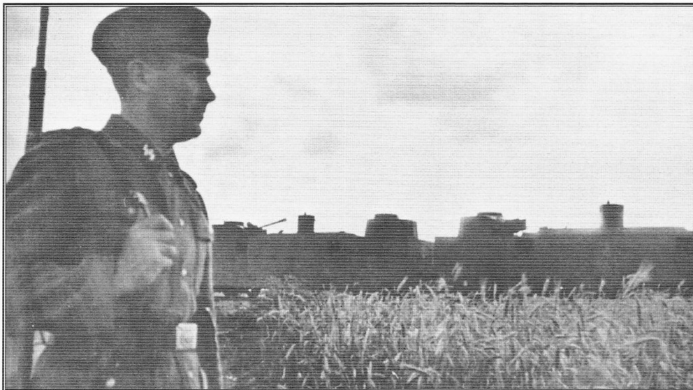
Pociąg pancerny nr 28, front wschodni, 1943 rok. Widoczne sowieckie dwa wagony artyleryjskie typu PL-35 uzbrojone w armaty 7,62 cm FK 295/1(r) i armaty przeciwlotnicze 3,7 cm Flak 36(?).
