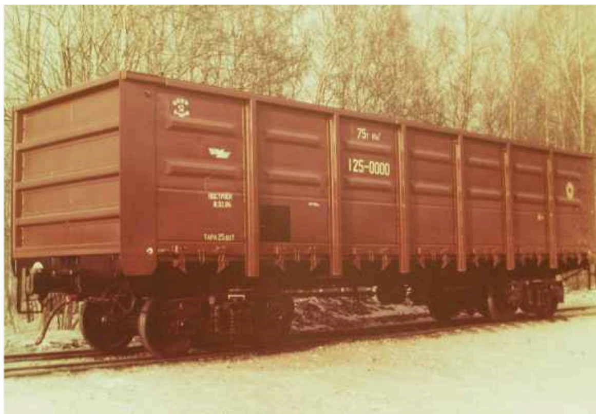
4-Х ОСНЫЙ ЦЕЛЬНОМЕТАЛЛИЧЕСКИЙ ПОЛУВАГОН МОДЕЛИ 12-125 ГРУЗОПОДЪЕМНОСТЬЮ 75 Т. 1986 Г.
