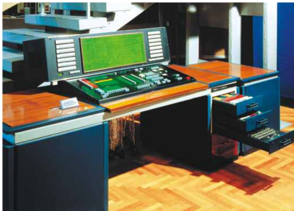
ПУЛЬТ УПРАВЛЕНИЯ ЗАПРАВКОЙ КОСМИЧЕСКОГО КОРАБЛЯ "БУРАН" ЖИДКИМ ВОДОРОДОМ
