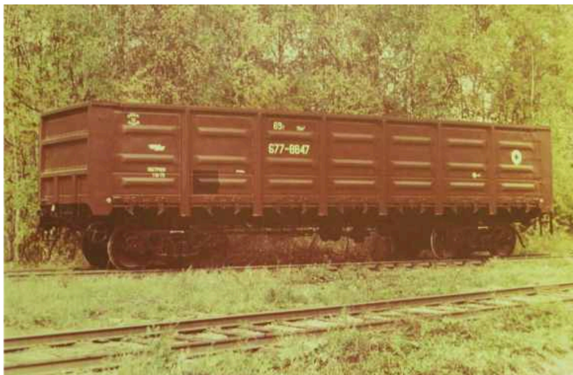
4-ОСНЫЙ ЦЕЛЬНОМЕТАЛЛИЧЕСКИЙ ПОЛУВАГОН МОДЕЛИ 12-119 С ТОРЦЕВЫМИ СТЕНАМИ И ЛЮКАМИ В ПОЛУ, ГРУЗОПОДЪЕМНОСТЬЮ 69 Т. 1986 Г.
