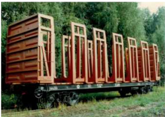
ВАГОН ДЛЯ ПЕРЕВОЗКИ ЛЕСОМАТЕРИАЛОВ МОДЕЛЬ 13-198
