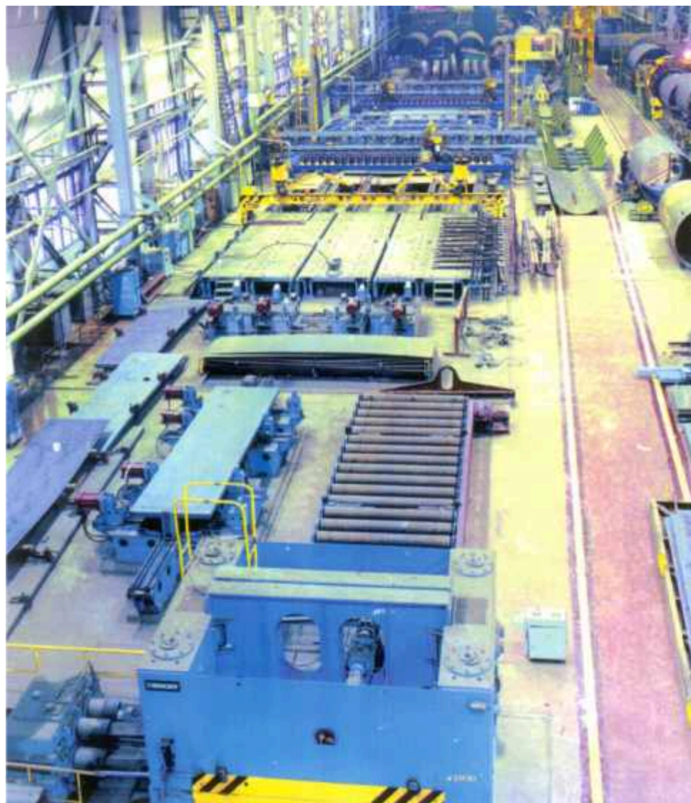
ЛИНИЯ СБОРКИ И АВТОМАТИЧЕСКОЙ СВАРКИ ЛИСТОВЫХ ПОЛОТНИЩ КОТЛОВ ЖЕЛЕЗНОДОРОЖНЫХ ЦИСТЕРН
