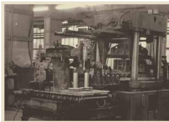
МЕХАНИЗИРОВАННАЯ СТЕРЖНЕВАЯ ТРЕХПОЗИЦИОННАЯ МАШИНА НА БАЗЕ 2857 ДЛЯ ИЗГОТОВЛЕНИЯ КРУПНЫХ СТЕРЖНЕЙ. ИЗГОТОВЛЕНА В 1972 Г.
