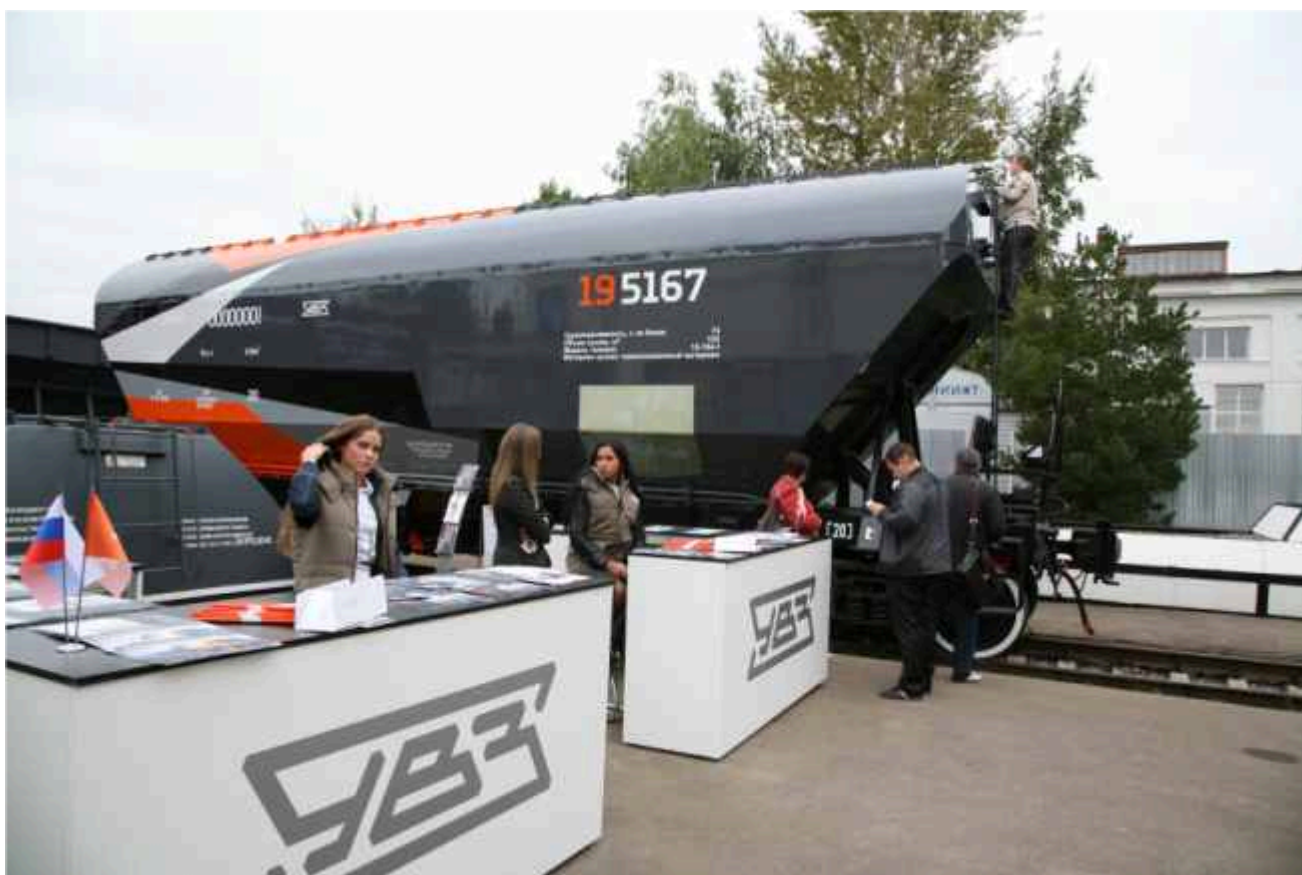
ВАГОН-ХОППЕР С КУЗОВОМ ИЗ КОМПОЗИЦИОННЫХ МАТЕРИАЛОВ. 2013 Г.
