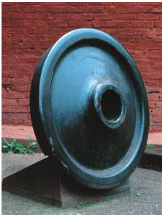
ЧУГУННОЕ ВАГОННОЕ КОЛЕСО ГРИФИНА, ОТЛИТОЕ В 1946 Г.
