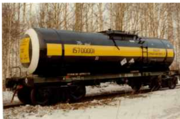
ЦИСТЕРНА ДЛЯ ПЕРЕВОЗКИ СЕРНОЙ КИСЛОТЫ МОДЕЛЬ 15-157
