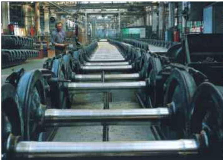
КОНВЕЙЕРНАЯ ЛИНИЯ ОБЩЕЙ СБОРКИ ТЕЛЕЖЕК. 1980-Е ГГ.
