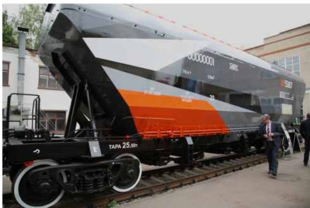
ВАГОН-ХОППЕР С КУЗОВОМ ИЗ КОМПОЗИЦИОННЫХ МАТЕРИАЛОВ. 2013 Г.
