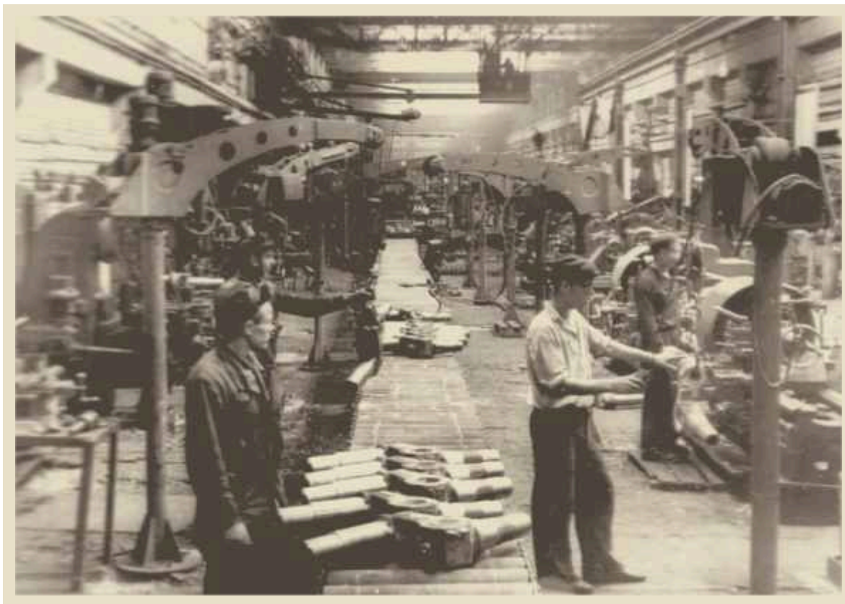
ПОТОЧНАЯ ЛИНИЯ ОБРАБОТКИ БАЛАНСИРОВ ТАНКА Т-54. 1949 Г.
