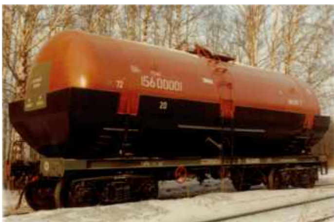
ЦИСТЕРНА ДЛЯ ПЕРЕВОЗКИ МАЗУТА МОДЕЛЬ 15-156
