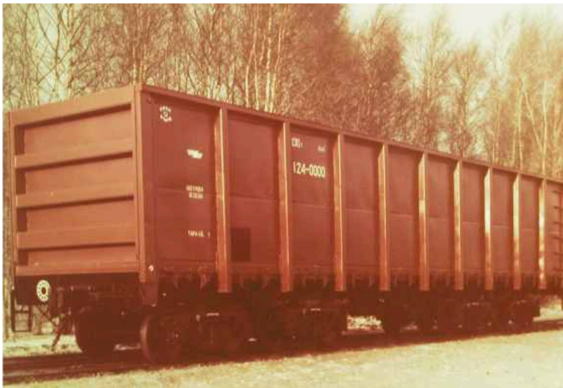
8-ОСНЫЙ ЦЕЛЬНОМЕТАЛЛИЧЕСКИЙ ПОЛУВАГОН МОДЕЛИ 12-124 ГРУЗОПОДЪЕМНОСТЬЮ 130 Т. 1986 Г.
