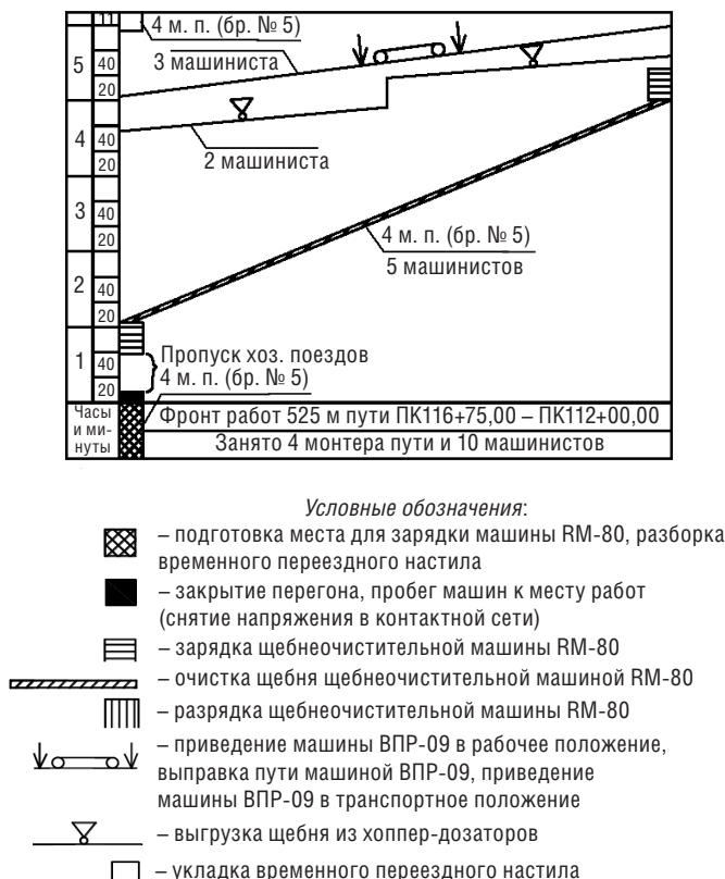
Рис. 6.1. Пример графика производства работ в «окно» (основные работы по очистке балласта)
