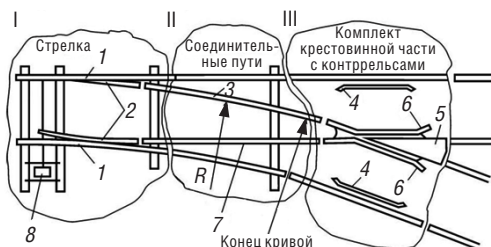
Рис. 4.9. Одиночный обыкновенный стрелочный перевод (схема):
