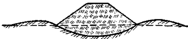
Рис. 1.28. Оседание основания насыпи с выпиранием грунта за ее откосами
