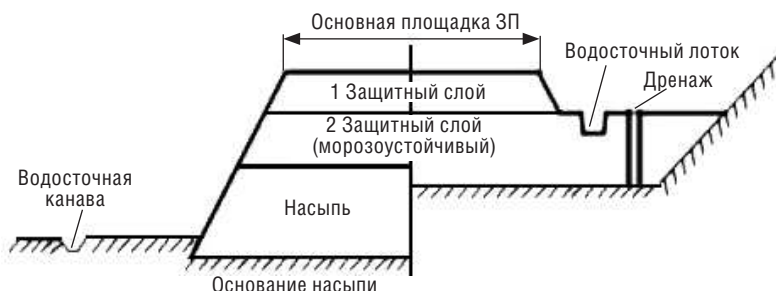
Рис. 1.4. Основные элементы земляного полотна на высокоскоростных магистралях
