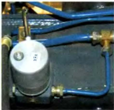
Рис. 8.6. Установка сигнализатора давления на активной тележке
