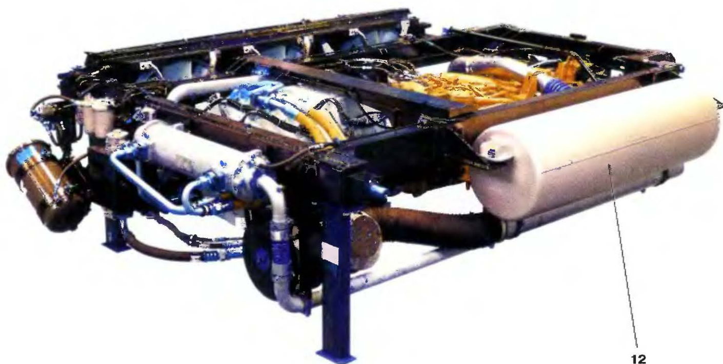
Рис. 4.2. Силовой модуль POWERPACK. Вид со стороны глушителя и водомасляного теплообменника масла гидропередачи: 12 — глушитель
