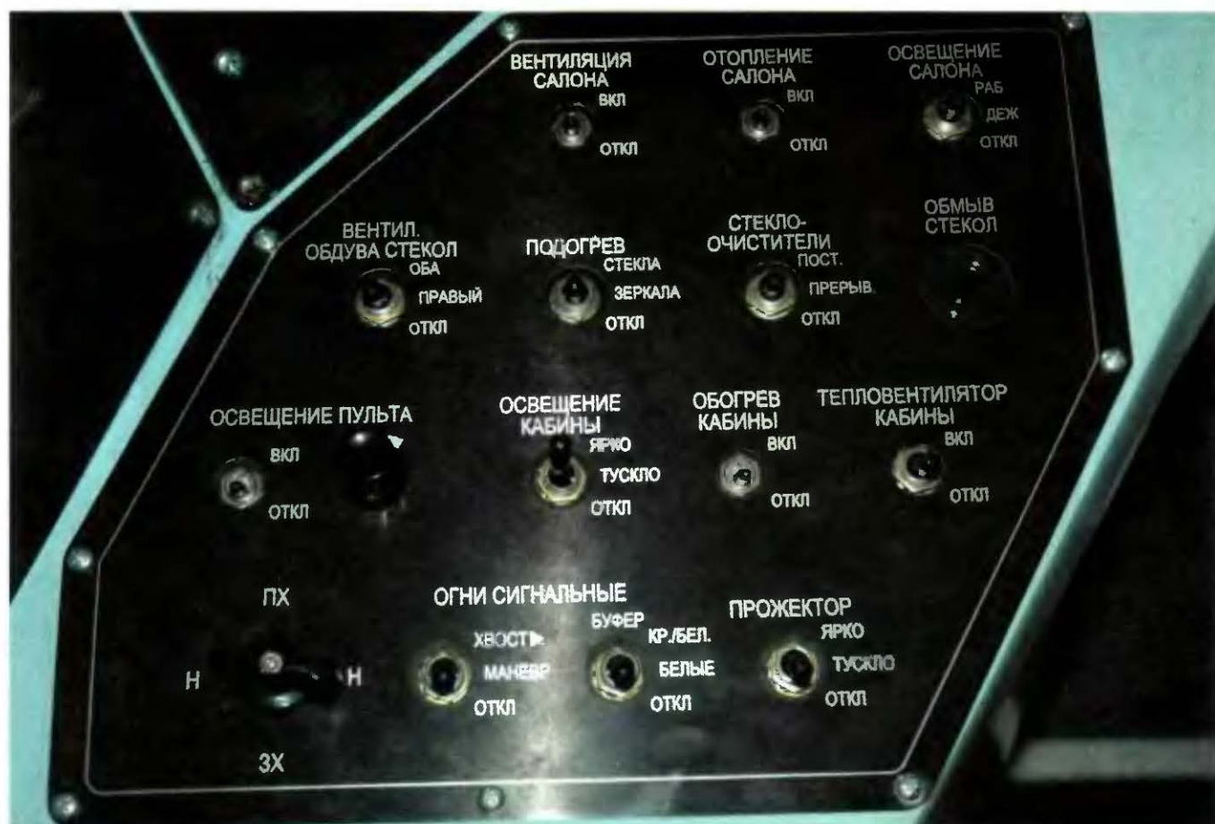
Рис. 9.2. РА-1. Панель управления № 1
