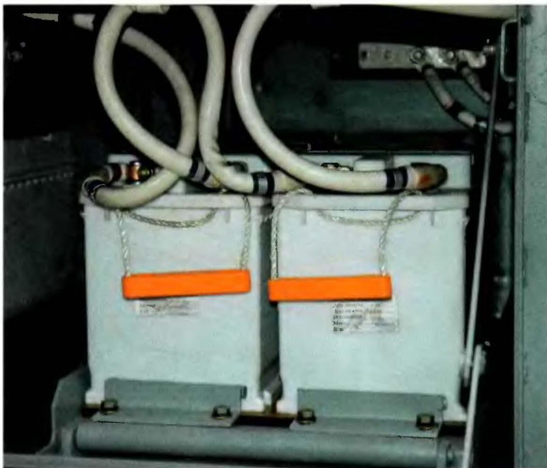
Рис. 10.1. Установка аккумуляторных батарей в подвагонном ящике РА-1
