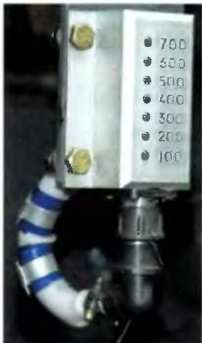
Рис. 4.7. Индикатор уровня топлива на светодиодах
