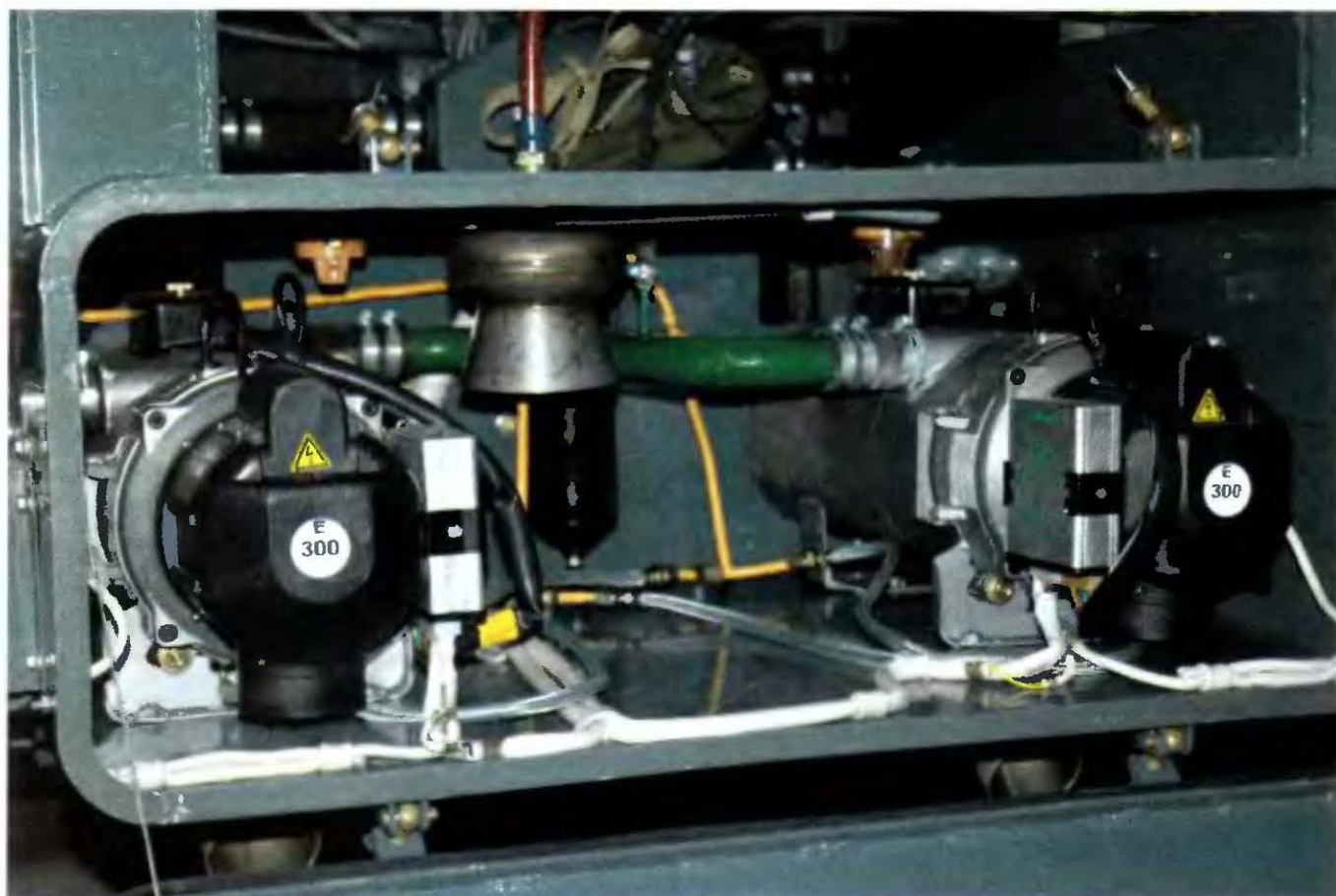
Рис. 11.1. Установка жидкостных отопителей в подвагонном ящике РА-1
