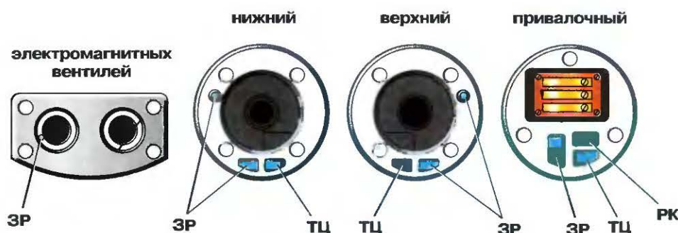
Рис. 7.16. Электропневматический распределитель усл. № 305-3:
