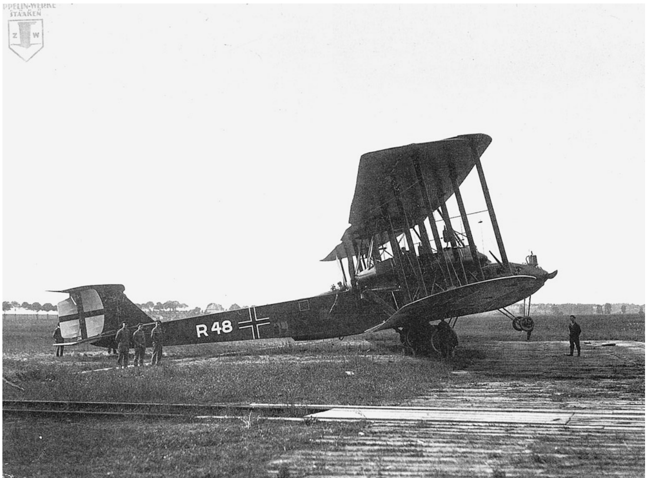
Abb. 3.14 Fernbomber vom Typ R XIVa der Zeppelin-Werke Staaken, 1918. Dieses Riesenflugzeug mit 47 m Spannweite wurde von fünf 191 kW (260 PS) starken Maybach-MB-IVa-Motoren angetrieben, die direkt, d. h. ohne Getriebe, auf die Holzpropeller wirkten Abflugmasse max. 11.460 kg; Höchstgeschwindigkeit 130 km/h; Stei-
