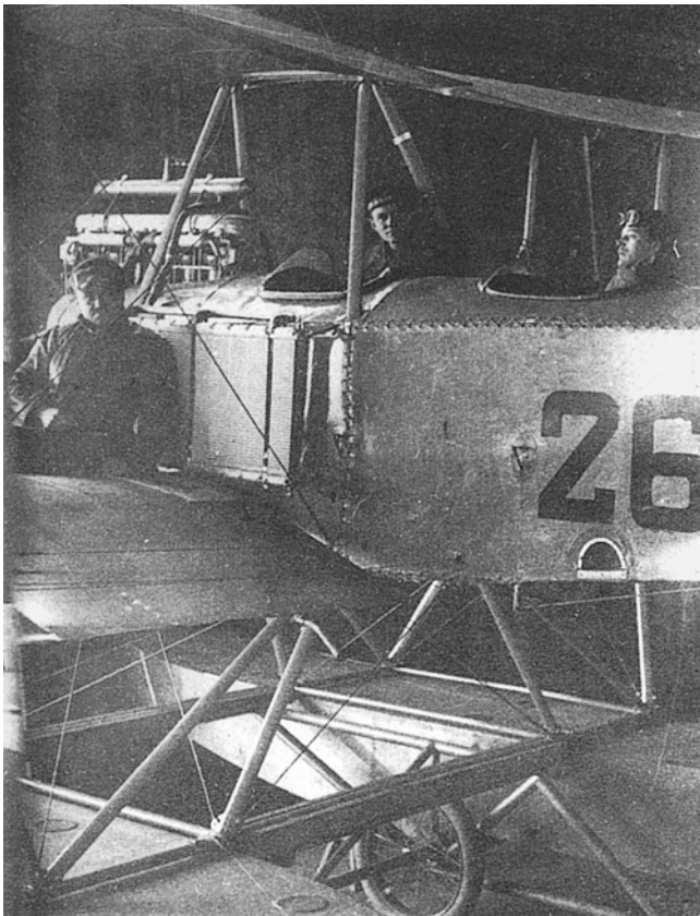
Abb. 3.23 Zweisitziges Aufklärungsflugzeug mit Maybach-DW-Motor, der eigens für den zweiten »Kaiserpreis«-Wettbewerb entwickelt worden war. Nach Kriegausbruch baute man die Motoren dieses Typs in Marine-Flugzeuge ein
