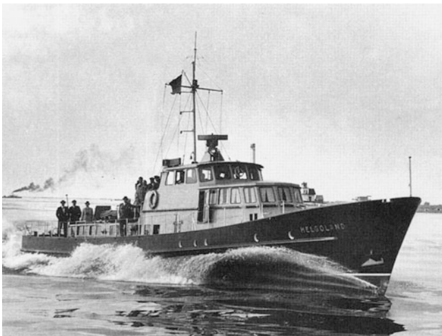
Abb. 13.22 Im Sommer 1954 stellten die Oberzolldirektionen Hamburg und Kiel zwei schnelle Streifenboote in Dienst. Diese von der Schiffswerft Theodor Buschmann im Querspannen-System gebauten Boote hatten zwei Maybach-MD-655-S-Motoren (je 1.103 kW/1.500 PS) und Maybach-KS-12-Schiffsgetriebe
