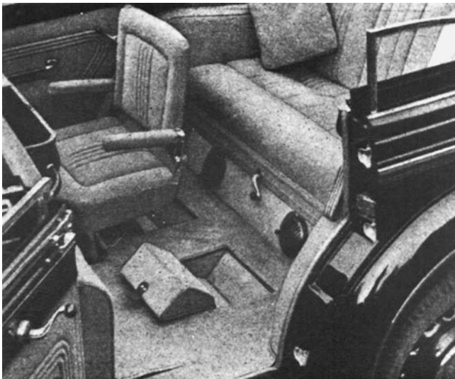
Abb. 28.6 Mit Stoff ausgeschlagenes Interieur, ausfahrbare hintere Sitzbank mit Kurbel und Heizungsrosetten, Schlummerkissen, versenkbare Fußrasten und ungewohnt luxuriöse Klappnotsitze. Maybach DS 7 um 1933, Karosserie Gläser
