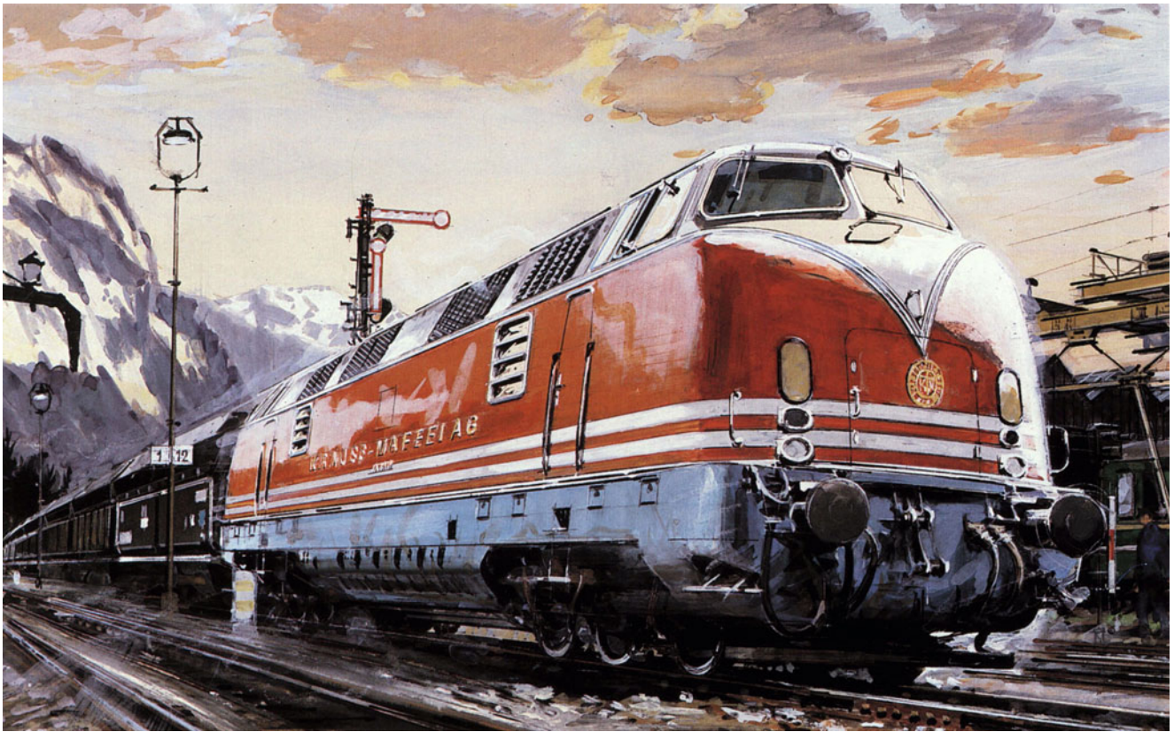
Tafel 25.3 Die sechssachsige ML 3000 C'C' wurde von Krauss-Maffei – auf eigene Kosten – gebaut. Die Leistung wurde durch zwei ladeluft-gekühlte Maybach-MD-655-Motoren auf 2.200 kW (3.000 PS) angehoben. Nach gründlicher Erprobung auf Steigungsstrecken im Schwarzwald kaufte die Bundesbahn die Lokomotive V 300 (später: V 230) an und setzte dieses Unikat zur Beförderung schwerer Erzzüge ein
