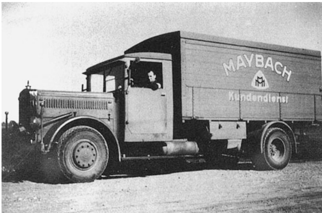
Abb. 20.14 Werkstatt- und Ersatzteilwagen (Faun mit Maybach-FD-88-Fahrzeug-Dieselmotor) des Maybach-Motorenbau-Kundendienstes im Zweiten Weltkrieg
