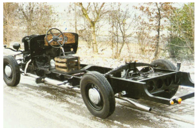
Abb. 33.3 Erste Probefahrt des Fahrwerks mit Sitzkiste und provisorischer Instrumententafel im Februar 1996. Gut zu sehen die obere Hinterachs-Querfeder, die sich über je eine Schraubenfeder pro Seite gegen die schwingende Halbachse abstützt. (Eingelenk-)Schwing- oder Pendelachsen haben den Nachteil der Radsturzveränderung (X-Beine, Reifenverschleiß, eingeschränkte Kurvenstabilität)
