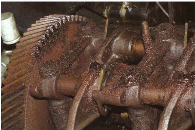
Abb. 33.2 Des Restaurators helle Freude: ein von Rost, Metallabrieb und verschlissenen Teilen gezeichneter Motor, hier die Partie um das Antriebsrad der oben liegenden Nockenwelle mit Schwinghebeln und Schwinghebelwellenlagerung.
