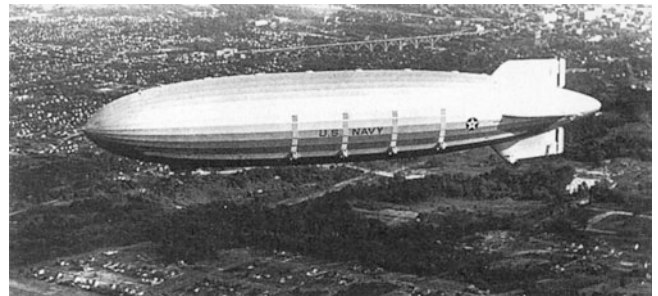
Abb. 9.40 Da die amerikanischen Militärs am Luftschiff Interesse zeigten, wurden unter der Systemberatung von LZ-Ingenieuren die Luftschiffe »Akron« und »Macon« in den USA gebaut. Als Antrieb dienten je acht Maybach-VL-2-Motoren. Da diese Luftschiffe das inerte Helium anstelle des brennbaren Wasserstoffes als Auftriebsgas hatten, konnten die Motoren im Inneren des Schiffes installiert werden, was den Luftwiderstand verminderte. Die beiden von der US-Navy betriebenen Luftschiffe verunglückten 1933 bzw. 1935 infolge von Bedienungsfehlern
