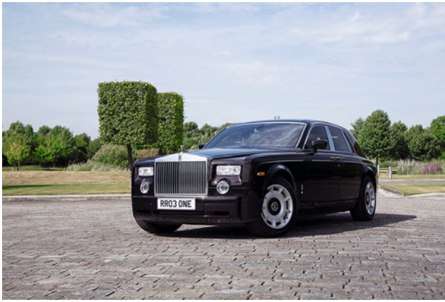
Abb. 29.17 An seinem tempelartigen Kühlergrill, gekrönt von Göttin Emily, ist ein Rolls-Royce seit Jahrzehnten als solcher zu erkennen. Zusammen mit einer massigen, nicht unbedingt schönen Karosserie und Rädern im Turbinendesign knüpfte der »Phantom« VII an die eindrucksvollen Vorgänger aus den 1980er und 1990er Jahren an. Besonderheiten sind die hinten angeschlagenen Fondtüren und die Leichtmetall-Space-Frame-Karosserie (aus Dingolfing). 2003 Rolls-Royce »Phantom« VII, V12 Sauger, 6.745 cm 3 , 460 PS/339 kW (BMW)
