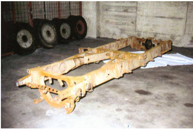
Abb. 33.1 Vom Schicksal schwer gezeichnet: von Rost zernagter Tiefbett-Kastenrahmen eines Maybach SW 38. Auffallend sind die stark dimensionierten Längsträger, die an den Waggonbau erinnern. Der Rahmen liegt mit der Oberseite auf dem Boden, das Heck mit dem Bügel für die Querfederaufnahme zeigt zum Betrachter (siehe auch Abb. 33.3)
