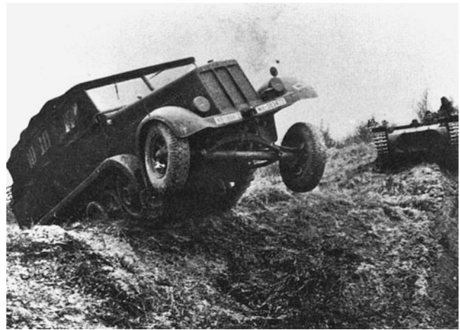
Abb. 20.2 12-Tonnen-Halbketten-Zugmaschine, Bauart Daimler-Benz (DB 10) mit Maybach-Motor HL 85, im schweren Gelände auf der »Panzerwiese« am Gehrenberg bei Markdorf. Das Bild vermittelt einen Eindruck von den Betriebsbedingungen militärischer Fahrzeuge
