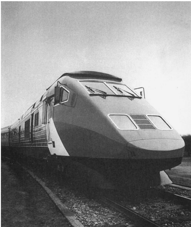
Abb. 14.12 In Ländern, deren Bahnstrecken noch nicht elektrifiziert sind, kommen weiterhin Dieseltriebzüge zum Einsatz: Triebzug der Koreanischen Staatsbahn, angetrieben von zwei 1.570 kW (2.135 PS) starken MTU-Motoren
