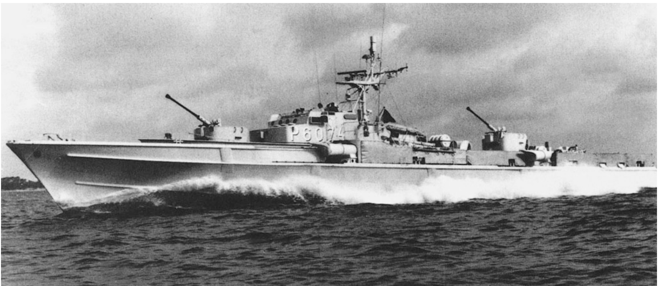
Abb. 13.34 Deutsches Schnellboot »Bussard« mit MD-872-16-Zylinder-Motoren und KS-41-/20-Getrieben von Maybach
