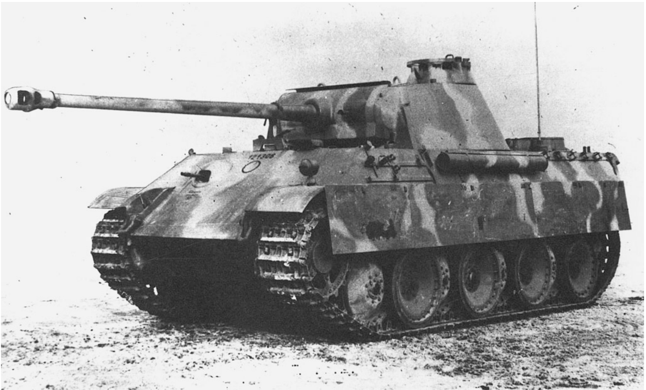
Abb. 11.32 Mittlerer Panzer »Panther« mit Maybach-HL-230-Motor und ZF-Getriebe AK 7. Das AK-7-Getriebe (sieben Vorwärtsgänge, ein Rückwärtsgang) war im Gegensatz zum Olvar-Getriebe des »Tiger« ein reines Handschaltgetriebe. Der »Panther« wurde als direktes Gegenstück zum russischen T-34 von MAN entwickelt und ging Ende
