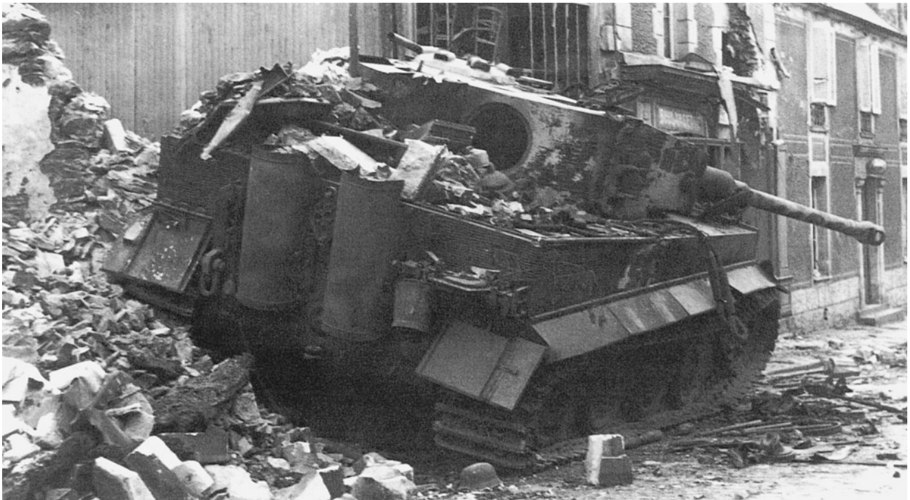
Abb. 11.51 Ein zum Wrack geschossener »Tiger«, aufgenommen am 13. Juni 1944 in Villers-Bocage/Frankreich. Die beiden halb runden Schürzen am Heck des Fahrzeugs dienen als Schutz vor Beschädigungen und Verbrennungen an den Auspuffrohren, die wegen des vorwiegend auf der Vollastkennlinie gefahrenen Triebwerkes meist rot
