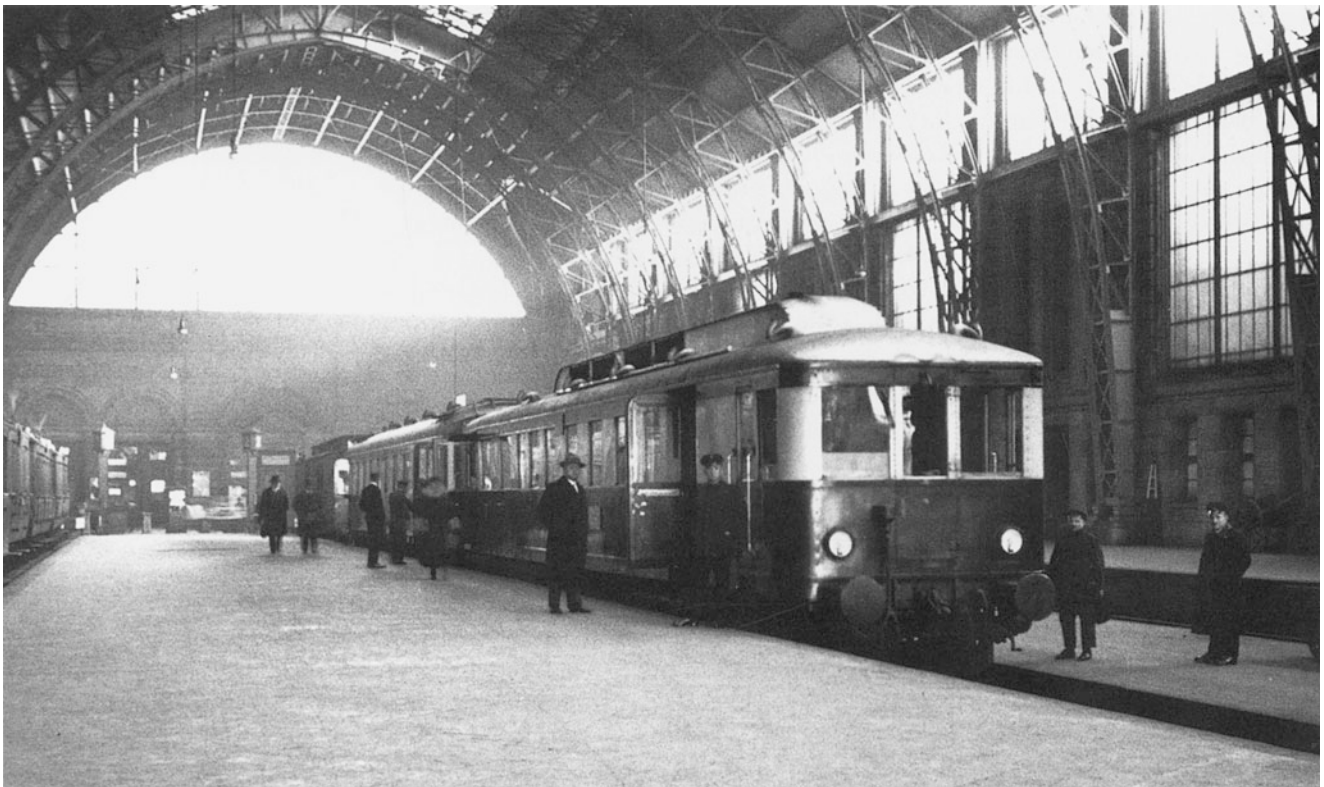
Abb. 9.51 Einer der drei ersten Eiltriebwagen (100 km/h) der Deutschen Reichsbahn mit dieselelektrischem Antrieb. Der zwölfzylindrige Maybach-GO-5-Motor leistete 301 kW (410 PS). Diese Triebwagen (VT 872 bis VT 874), 1932 von der Eva Wismar gebaut, wurden im Städte-Nahverkehr Frankfurt/Main-Wiesbaden eingesetzt
