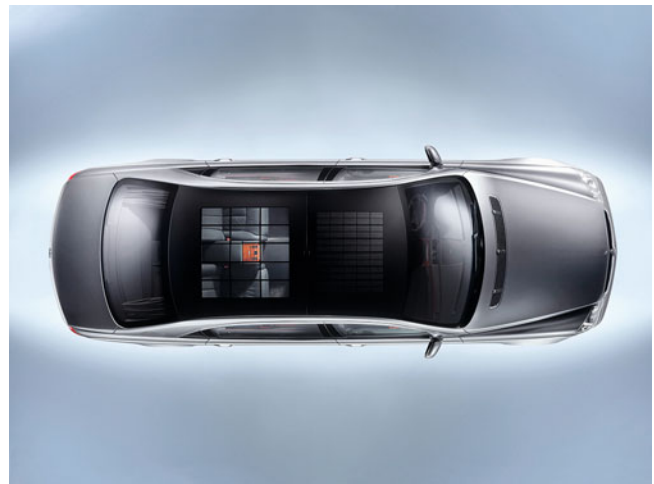
Abb. 29.11 Elektrotransparentes Panoramadach für Typ 62 (Sonderausstattung), äußerlich erkennbar an einer durchgehenden Glasfläche. Unterteilung in eine vordere Glasfläche für 30 Silizium-Solarzellen, die Sonnenlicht in elektrische Energie umwandelt und das Lüftungsgebläse der Frontklimaanlage versorgt. Die hintere Glasfläche, bestehend aus transparenter äußerer Scheibe und innerer Scheibe mit Flüssigkristallfolie, wird bei angelegter Spannung durchsichtig und bleibt ohne Spannung diffus. Ein elektrisch angetriebener Schiebehimmel verschließt oder gibt die Durchsicht frei
