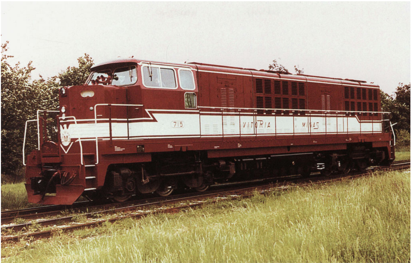
Tafel 25.5 Für den Erztransport aus dem Minengebiet Itabira im brasilianischen Bundesstaat Espirito Santo zur Küstenstadt Vitoria auf einer 570 km langen Strecke mit Meterspur wurden diese Krauss-Maffei-Lokomotive M 4000 C'C' eingesetzt. Antrieb durch zwei Maybach-Motoren MD 870, Voith-Turbogetriebe L 830 ru und Maybach-Achstriebe
