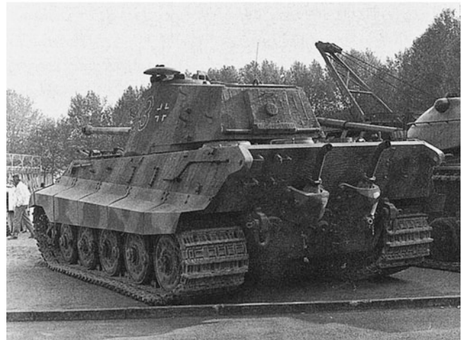
Abb. 20.8 Der schwerste deutsche Panzer (68.000 kg) im Zweiten Weltkrieg war der »Tiger II« (»Königstiger«) mit Antrieb durch Maybach-HL-230-Motor und das Maybach-Olvar-Getriebe. Dieses Fahrzeug wurde im »Musée des Blindés« der École d'application de l'arme blindée et cavalerie in Saumur (Frankreich) mit großem Engagement aller daran Beteiligten restauriert und fahrbereit gemacht. Heute ist dieser »Königstiger« eine der Hauptattraktionen der jährlichen Panzervorführungen in Saumur
