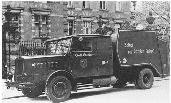
Abb. 9.54 Straßenreinigungsfahrzeug der Stadt Stettin mit Maybach-OS-5-Motor. Die Gasflasche unterhalb des Fahrerhauses zeigt, dass der Wagen wie viele Kommunalfahrzeuge Ende der dreißiger Jahre auf Flüssiggasbetrieb umgestellt worden war
