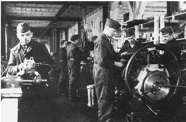
Abb. 20.16 Demontage, Reparatur und Wiedermontage der Motoren und Getriebe in Russland waren fabrikmäßig organisiert und wurden in Taktstraßen durchgeführt
