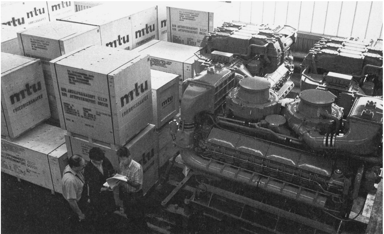
Abb. 14.22 MTU-Großdieselmotoren, fertig zum Versand: links in Kisten verpackt Motoren, die für Industrietraktoren in der damaligen Sowjetunion bestimmt waren; rechts Schiffsmotoren der Baureihe 538 ( 5,38 \text{ dm}^3 Zylindervolumen), die 1949/50 von Karl Maybach und seinen Mitarbeitern entwickelt, im Laufe der Jahrzehnte optimiert und von der MTU noch in den neunziger Jahren verkauft wurden
