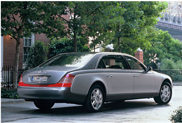
Abb. 29.12 Die Heckklappe mit der die Seitenteile umgreifenden Bördelung wurde von den Maybach-Stilisten als Designelement aufgefasst. Die in Wagenfarbe lackierten Stoßfänger aus Kunststoff schließen fugenlos an die Karosserie-Bepunktung an und können dank nachgelagerter Schaumelemente Karosserierempler bis 4 km/h schadlos überstehen. Das rot eingefärbte, die Rückleuchten verbindende Band oberhalb des Stoßfängers erinnert an japanische Massenautos und wirkt eher peinlich.
