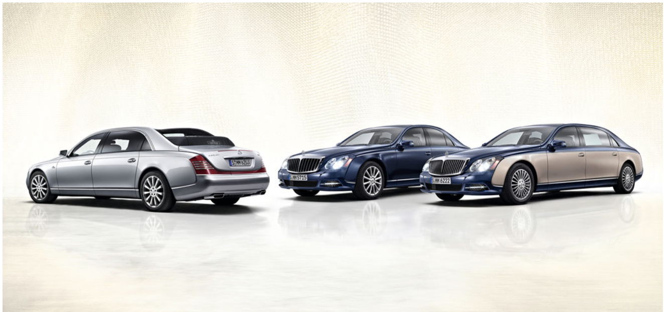
Abb. 29.25 Von links: 62 S Landulet, 57 S, 62. Auffälligstes Merkmal der Modelle ab April 2010 waren die größer dimensionierten, jetzt aufrechter stehenden Kühlergrills, die bei den Modellen 57 und 62 zwanzig feine Längsstäbe, bei 57 S und 62 S zwölf massive Doppellamellen und einen Schattenstab aufwiesen. Weitere Änderungen: vergrößerte, ae-
