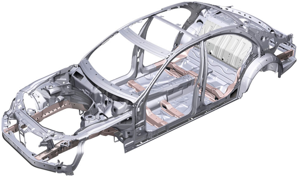
Abb. 29.10 Rohbau des Maybach 57 mit gestaltfester Zelle, abnehmender Steife vorn und hinten und »hartem Rand« (Knautschpatent). Tunnel aus stärkerem Blech mit aufgesetzter Verstärkung, Bodenbleche mit Schwellern verschweißt und mit zusätzlichen Querbrücken aus Alu-Druckguss verschraubt gegen Seitenaufprall und Beanspruchungen um die Längsachse
