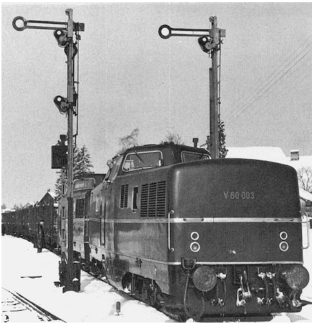
Abb. 13.3 Nach dem Zweiten Weltkrieg begann die Deutsche Bundesbahn zusammen mit der Industrie mit dem Bau von Dieselloks. Mit der vierachsigen V 80 sollte das Diesellokomotiv-Konzept der Bundesbahn – schnelllaufende Motoren, hydraulisch-mechanische Kraftübertragung und Gelenkwellenantrieb – erprobt werden. Diese V 80 war mit dem damals neuen Maybach-Motor MD 650, dem Maybach-Mekydro-Getriebe K 104 und Maybach-Achstrieben ausgerüstet
