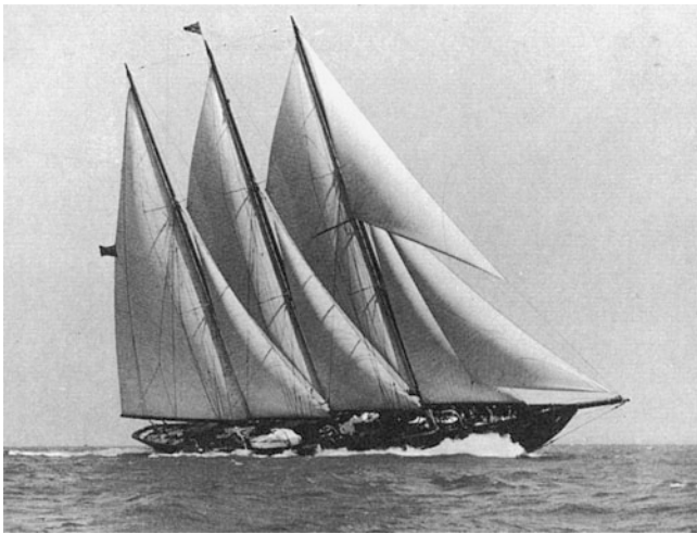
Abb. 13.21 Die von der Werft Camper & Nicholson 1952 gebaute Schonerjacht »Creole« in voller Fahrt. Als Hauptantrieb standen zwei Maybach-MD-655-Motoren von je 882 kW (1.200 PS) mit KS-12-Getrieben zur Verfügung. Zwei MD-215-Motoren mit 150 kW (204 PS) trieben die Bordnetzaggregate an. Eigner war der griechische Reeder Stavros Niarchos
