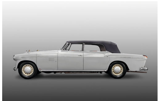
Abb. 34.5 1938 ausgeliefert als Pullman-Limousine SW 38 (3,8-Liter-Motor) für eine Tochtergesellschaft des Thyssen-Konzerns, erhielt der Wagen ab 1950 neben einer Vollrestaurierung einen 4,2-Liter-Motor, der ihn zum SW 42 machte, und eine Pontonkarosserie mit überlangem Vorbau, um noch Platz zu schaffen für das zwischen A-Säule und Radlauf untergebrachte Reserverad. Beide Karosserien stamm(t)en von Spohn.
