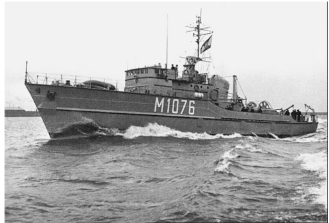
Abb. 13.23 Die Küstenminensuchboote der sogenannten Städteklasse – im Bild die »Paderborn« – waren die ersten Minensuchboote der Bundesmarine, gebaut von 1958 bis 1962. Angetrieben wurden sie von zwei MD-871um-Motoren ( 2 \times 1.580 \text{ kW}/2.150 \text{ PS} ) sowie zwei Maybach-KS-3030-Getrieben. Motoren und Getriebe waren weitgehend unmagnetisch
