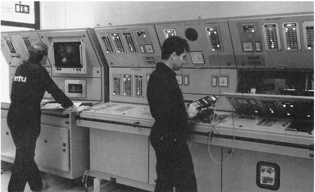
Abb. 14.14 Aus einer Messgruppe des Maybach-Motorenbaus ging bei der MTU eine eigene Produktgruppe hervor, die elektronische Überwachungs- und Steuerungssysteme für Dieselmotoren, Gasturbinen und kombinierte Antriebsanlagen entwickelt und herstellt. Hier überwachen zwei Mitarbeiter einen computersimulierten Prüfablauf an einem Fregatten-Maschinenfahrstand
