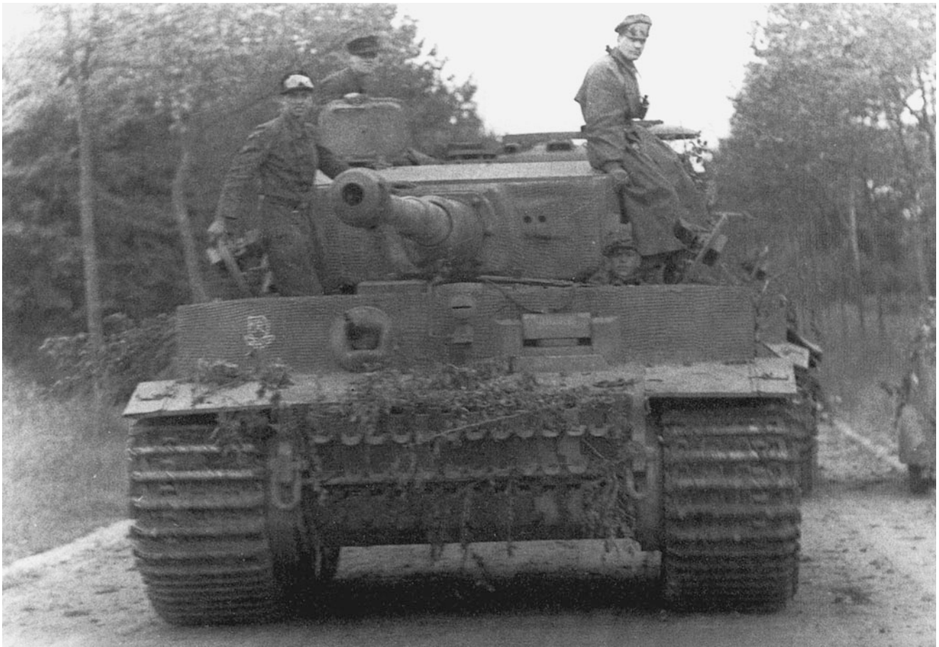
Abb. 11.49 Die imposante Frontsilhouette dieses »Tigers«, Ausführung E (mit HL-230-Motor und Olvar-Getriebe), ebenfalls aufgenommen beim deutschen Rückzug in Frankreich 1944, vermittelt einen Eindruck von der Massigkeit dieses mit rund 57.000 kg zweitschwersten deutschen Panzers
