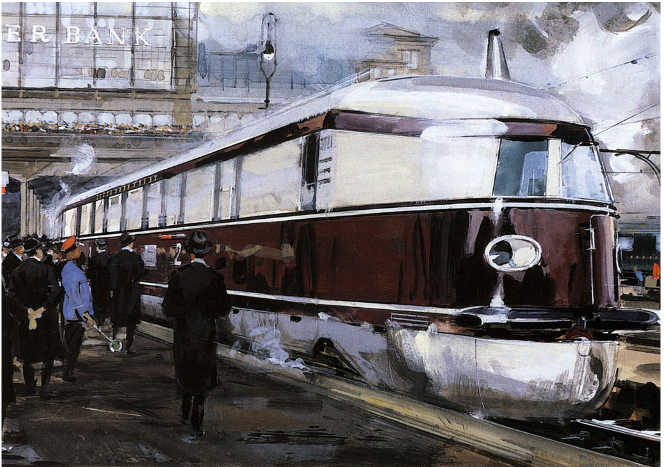
Tafel 6.6 Mit dem fahrplanmäßigen Einsatz des Schnelltriebwagens »Fliegender Hamburger« mit zwei Maybach-GO-5-Dieselmotoren wurde 1933 die Ära des Schienenschnellverkehrs eröffnet. Das Bild zeigt den »Fliegenden Hamburger« kurz vor der Abfahrt aus dem Lehrter Bahnhof in Berlin
