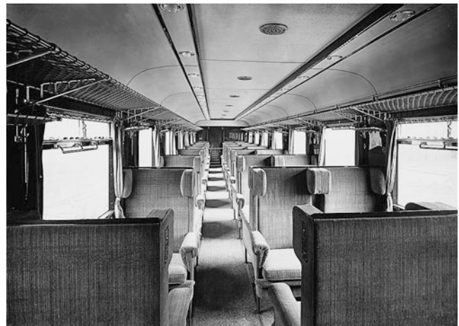
Abb. 24.8 Fahrgastraum der Schnelltriebwagen »Bauart Hamburg« von 1935 mit geräumigen, hell gepolsterten Sitzen für jeweils drei Reisende in einer Reihe beiderseits des Mittelgangs
