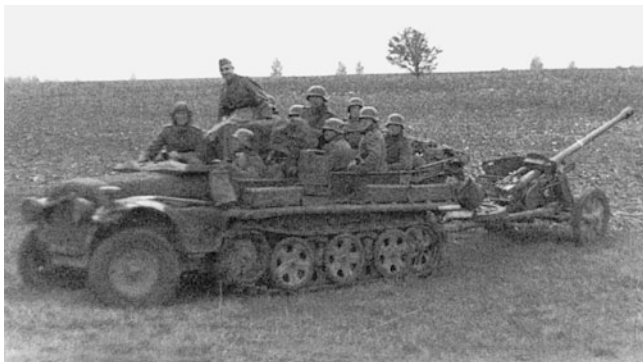
Abb. 10.36 1-Tonnen-Zugkraftwagen (Halbketten-Zugmaschine), Bauart Demag D 7, mit Maybach-HL-42-TRKM-Motor, der aus dem Wagenmotor HL 35 im SW-35-Wagen weiterentwickelt wurde. Seit 1934 lieferte der »Maybach-Motorenbau« Motoren mit den dazugehörigen Getrieben für Halbketten-Zugmaschinen des Heeres, ab 1936 auch für leichte und mittlere Panzer. Grundlage hierfür waren die leistungsstarken Pkw- und Nkw-Motoren von Maybach
