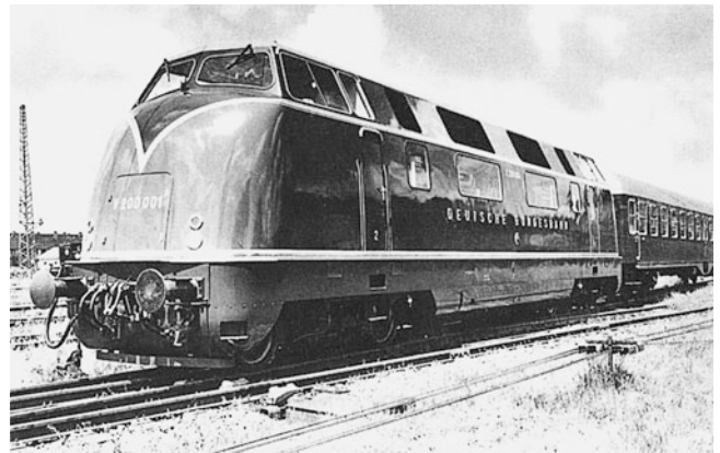
Abb. 13.29 Die Mehrzweck-Diesellok V 200 der Deutschen Bundesbahn wurde in wenigen Jahren zum Vorbild für den Diesellokomotivbau in Europa und Übersee. Die Deutsche Bundesbahn hatte bei der V 200 zwar mit Daimler-Benz, MAN und Maybach alle infrage kommenden Motorenhersteller berücksichtigt, doch mussten die Motoren untereinander austauschbar sein. Dasselbe galt für die Maybach- und Voith-Getriebe. So kam es nicht selten vor, dass eine Lok von Motoren verschiedener Fabrikate angetrieben wurde
