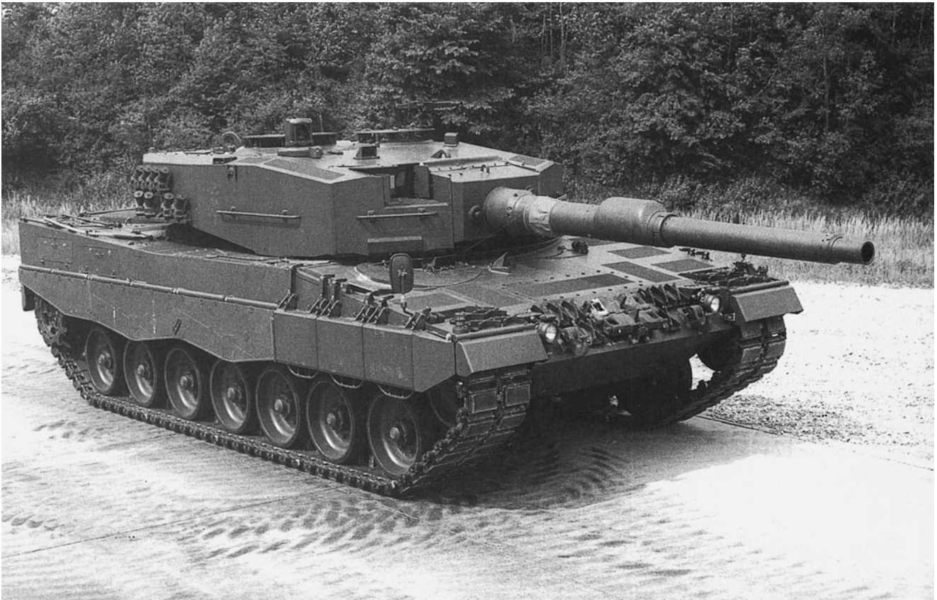
Abb. 14.17 Der deutsche Kampfpanzer »Leopard II« wird von einem MTU-Motor mit 1.100 kW (1.500 PS) angetrieben und ist damit mehr als doppelt so stark motorisiert wie der »Tiger« im Zweiten Weltkrieg. Technische Daten: Mehrstoff-Vorkammer-Dieselmotor in V-Zwölfzylinder-Bauart, Typ MB 873-Ka 501 mit zwei Abgasturboladern; Bohrung \times Hub: 170 mm \times 175 mm, Hubraum 47.642 cm 3 ;
