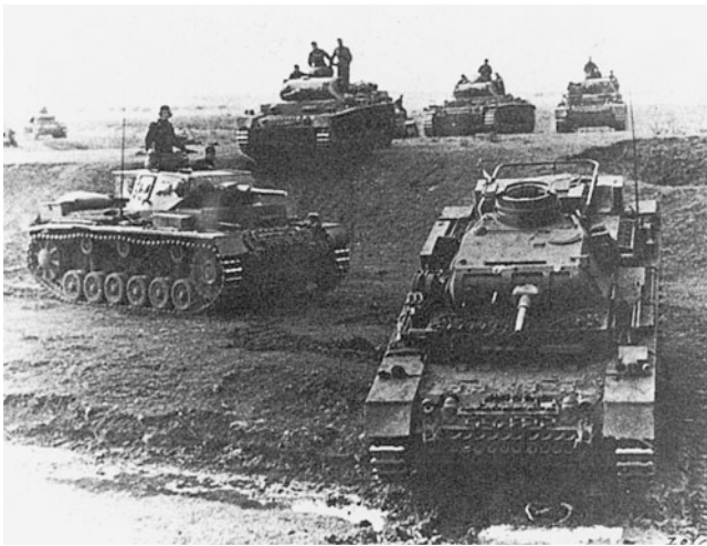
Abb. 11.7 Der Panzer III mit Maybach-HL-120-Motor und Maybach-Variorex-Getriebe war das »Arbeitspferd« der deutschen Panzerwaffe und wurde von 1937 bis Kriegsende gebaut. Gefechtsmasse: rund 20.000 kg, Höchstgeschwindigkeit: 40 km/h, Fahrbereich: rund 160 km, Bewaffnung: eine 3,7-cm-KwK, zwei MG 34; Besatzung: 5 Mann
