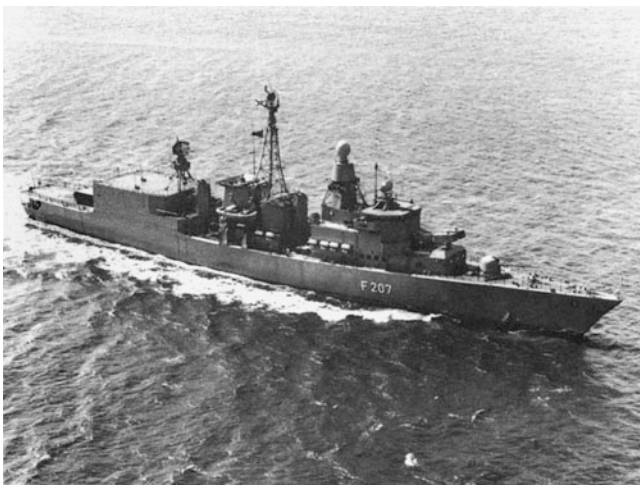
Abb. 14.15 Viele Korvetten und Fregatten sind heute mit kombinierten Antriebsanlagen ausgerüstet, wobei die Dieselmotoren für die Marschfahrt und die Gasturbinen für hohe Geschwindigkeiten eingesetzt werden. Auch die Fregatten F 122 der Deutschen Bundesmarine haben eine solche Antriebsanlage mit zwei MTU-Dieselmotoren und zwei General-Electric-Gasturbinen. Bei zahlreichen Marinefahrzeugen trägt die MTU als Generalunternehmer die Gesamtverantwortung für das Antriebs- und Bordenergiesystem sowie für die elektronische Steuerung und Überwachung der Anlagen
