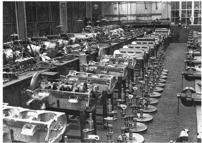
Abb. 18.5 Aufgrund des »Großauftrages« von Trompenburg lief die Serienfertigung von W-2-Motoren an. In das zweite Kurbelgehäuse von vorn ist bereits das Triebwerk mit dem Schwingungsdämpfer montiert. Dieser Schwingungsdämpfer wurde erst nachträglich konstruktiv vorgesehen, als sich gezeigt hatte, dass im mittleren Drehzahlbereich eine Eigenfrequenz der Kurbelwelle lag
