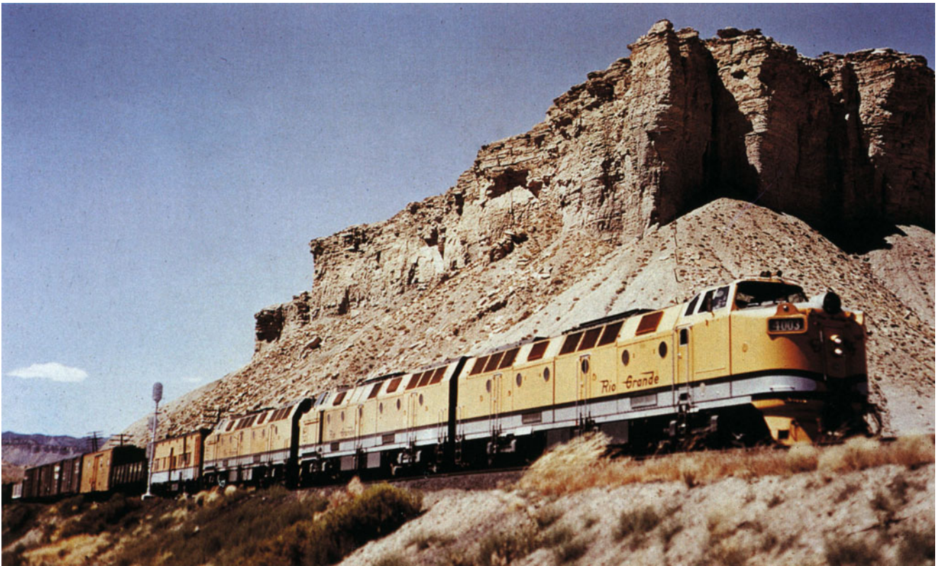
Tafel 25.4 Die sechsachsigen 150-Tonnen-Lokomotiven, Bauart Krauss-Maffei ML 4000 C'C', waren 1961 die größten und leistungsstärksten Diesellokomotiven der Welt (2.941 kW/4.000 PS). Als Antrieb dienten zwei Maybach-MD-870-Motoren, Voith-L-830-ru-Turbogetriebe und Maybach-C-33-V1-Achstrieb. Eingesetzt wurden diese Lokomotiven in den USA für die Traktion schwerer Güterzüge von der Denver and Rio Grande Western Railroad Co. ( Bild ) und von der Southern Pacific Co
