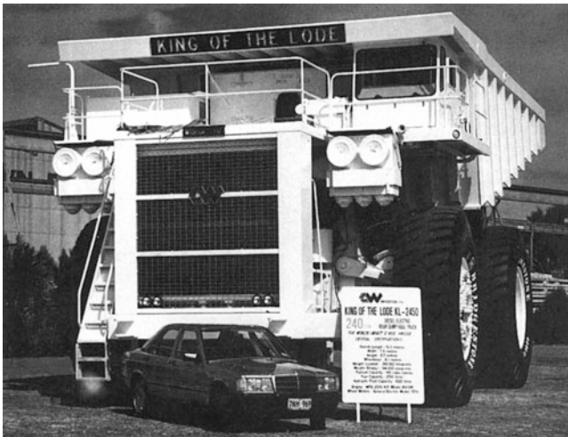
Abb. 14.19 Auch für schwere Muldenkipper eignen sich MTU-Motoren aufgrund ihrer Kompaktheit und hohen Leistung. Dieses Fahrzeug einer australischen Eisenerzmine mit einer Eigenmasse von 150 t und einer Ladekapazität von 240 t hat als Antrieb einen 16-Zylinder-Motor der MTU-Baureihe 396 mit 1.840 kW (2.500 PS)
