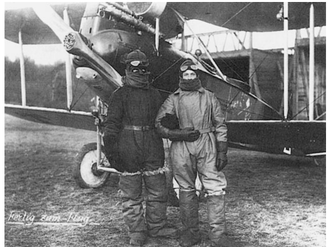
Abb. 3.26 Wegen seiner guten Höhereigenschaften wurde der Mb IVa bevorzugt in Höhereaufklärer wie diesen Rumpler C VII eingebaut. Dieser Flugzeugtyp war einer der besten deutschen Zweisitzer des Ersten Weltkrieges. Er wurde 1917/18 als Fernaufklärer in großen Höhen mit Kamera- und Funkausrüstung eingesetzt
