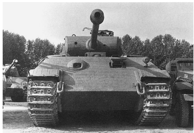
Abb. 20.6 Der Panzerkampfwagen V »Panther« war mit 45.000 kg für deutsche Verhältnisse ein mittlerer Panzer, der in der Form mit seinen schrägen Flächen dem T-34 ähnelte. Als Antrieb diente der HL-230-Motor mit dem mechanischen Schaltgetriebe AK 7 (Zahnradfabrik Friedrichshafen)
