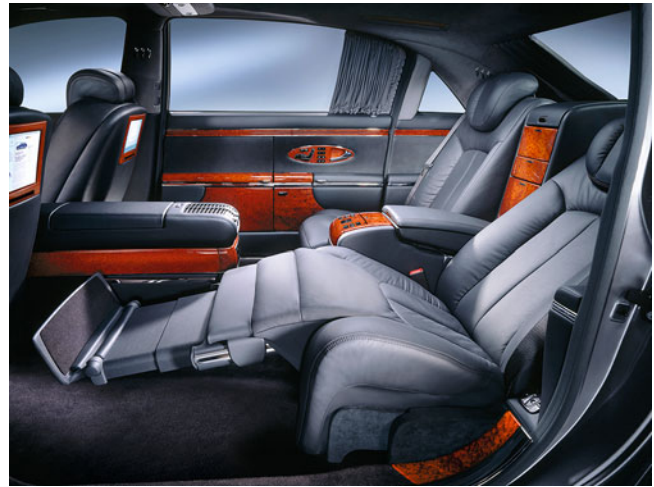
Abb. 29.15 Mit Blick auf die Sessel in der Spitzenklasse moderner Flugzeuge erhielt der Maybach 62 vielfältig verstellbare Fond-Ruhesitze. Bis auf die manuell klappbare Fußstütze (mit weichem Fersenpolster) erfolgen alle Sitzveränderungen elektrisch, wobei Sensoren Hindernisse im Fußraum erkennen, die Bewegungen stoppen und ein Stück zurückfahren. Die mit Leder, Holz und Chrom ausgeschlagenen Türinnenverkleidungen nehmen mehrere Staufächer auf sowie Seitenfenstergardinen, zusammen mit den Heckfenstergardinen so ziemlich die einzigen nostalgischen Attribute im und am ansonsten modernen Maybach
