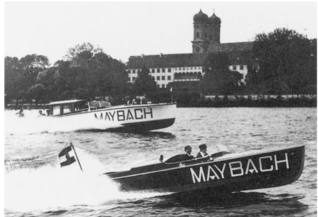
Abb. 9.33 Der Maybach-Motorenbau besaß für Kunden und Gäste zwei Vorführboote, die hier an der Friedrichshafener Uferpromenade mit der Schlosskirche vorbeischießen: im Vordergrund »Donnerwetter« mit einem auf 220 kW (300 PS) leistungsgesteigerten SDS-8-Motor, dahinter »Seeteufel« mit dem Luftschiffmotor VL 1 mit 301 kW (410 PS)
