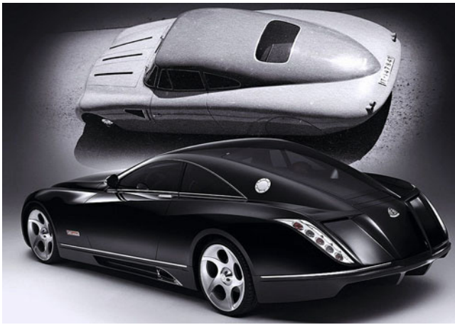
Abb. 29.21 Oben: Reifenversuchswagen 1939 von Fulda mit Stromlinienkarosserie von Dörr & Schreck nach Vorgaben von Koenig-Fachsenfeld. Abfallender Wagenbug, geneigte und seitlich gerundete Frontscheibe, kleiner Kühlluft eintritt, Kühlluft ableitung durch Haubenschlitze und Kotflügelöffnungen. c_w 0,23 (geschätzt), V_{max} ca. 200 km/h (Serienwagen 140 km/h).
