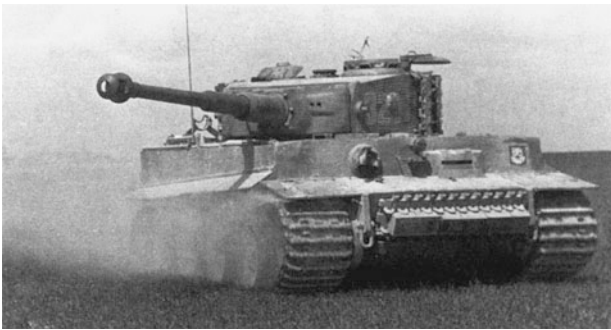
Abb. 11.31 Schwerer Panzer »Tiger« mit HL-230-Motor und Olvar-Getriebe von Maybach. Während die Deutsche Wehrmacht bis 1945 etwa 2.000 »Tiger« erhielt, standen der Roten Armee 43.000 T-34-Panzer zur Verfügung. Gefechtsmasse: 56.900 kg, Höchstgeschwindigkeit: 38 km/h, Fahrbereich: 90 km, Bewaffnung: eine 8,8-cm-KwK 36 L/56, zwei MG; Besatzung: 5 Mann
