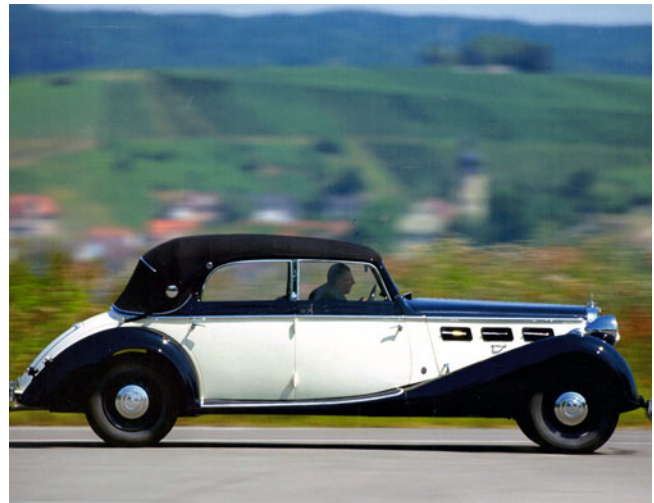
Abb. 33.6 Das Heck des Maybach erinnert ein wenig an den Achtzylinder-Horch 853 (1935–1937) mit ebenfalls unten angelegter Kofferklappe, was das Be- und Entladen nicht eben erleichtert. Zusätzliche Koffer können auf die Gepäckbrücke geschnallt werden, die in eingeklapptem Zustand über Stoßstange und Kennzeichen zu sehen ist
