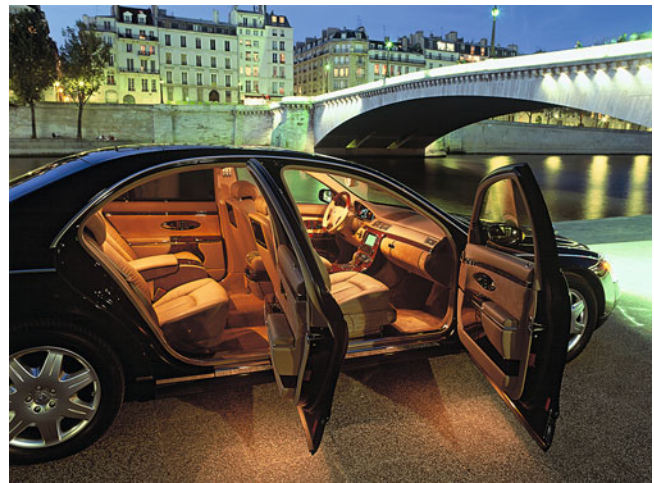
Abb. 29.13 Ein Maybach bei Nacht bietet bei einiger Fantasie Kaminfeuer-Atmosphäre: Vordere Leuchtfläche, Fond- und Fußraumbeleuchtung, Einstiegsleuchte (Typ 62) sowie Deckenfluter an B- und C-Säulen erleichtern Ein- und Ausstieg; darüber hinaus Suchbeleuchtung für Anzeigesymbole, Aufhellung des Mittelkonsolenbereichs und Leuchstreifen zwischen B- und C-Säulen beim 62er ohne Panoramadach
