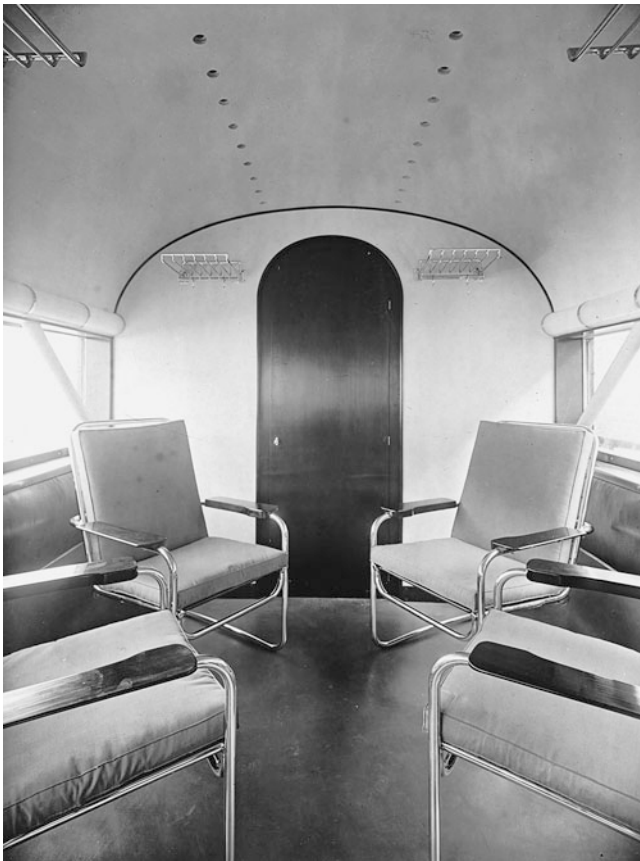
Abb. 24.3 Die Inneneinrichtung des »Schienenzeppelin« von 1930 mit Stahlrohr-Freischwängern sparte Gewicht und entfaltete eine ausgesprochen moderne Wirkung
