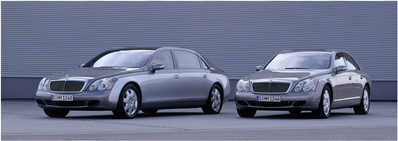
Abb. 29.4 Stand der Dinge 2002: Serienausführung der Maybach-Modelle 57 (rechts) und 62. Maybach- statt Mercedes-Grill, geänderte Scheinwerferunterbringung und Schürzen sowie MM-Logos statt Stuttgarter Sterne an den üblichen Stellen. Auflösung der mächtigen
