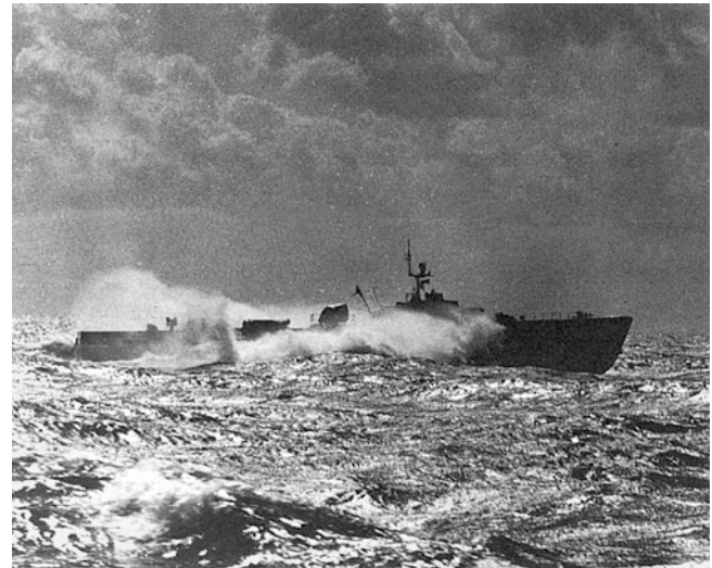
Abb. 21.39 Marinetechnische Spezialanwendungen wurden ab Ende der fünfziger Jahre bevorzugtes Einsatzgebiet für MD-Motoren. Hier ein Schnellboot der Bundesmarine mit MD-870-(16-V-J38-)Motoren bei rauer See
