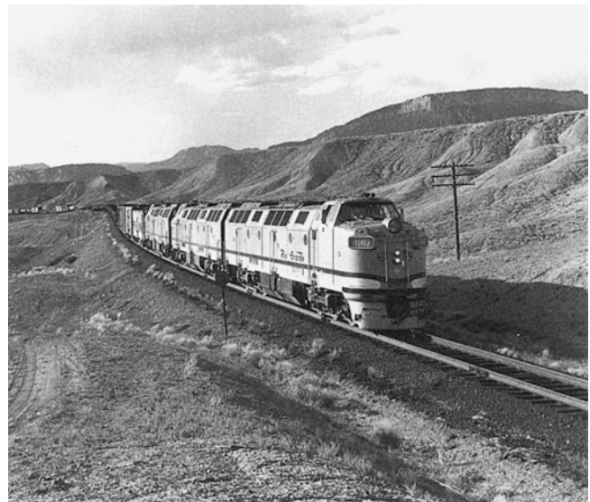
Abb. 13.32 Dieselhydraulische Normalspurlokomotiven, Bauart Krauss-Maffei ML 4000, für die Denver & Rio Grande Western Railroad Company und für die Southern Pacific Company, mit zwei Maybach-MD-870-(16V-538-)Motoren. Diese Loks waren wegen der hohen Ausfallquote anderer Dieselloks beschafft worden. Sie inspirierten die amerikanischen Lokhersteller auch zu einer leichteren Bauweise, konnten sich selbst aber wegen technischer und logistischer Probleme in den USA nicht durchsetzen. Ihre Bedienweise blieb den amerikanischen Lokführern, die an die einfachen Mittelschnellläufer gewöhnt waren, fremd
