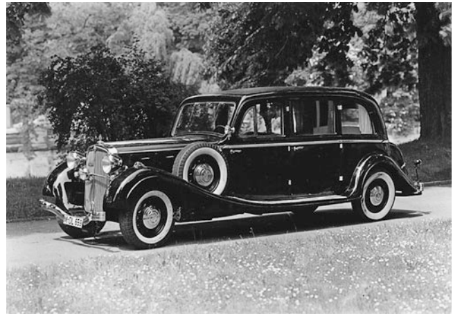
Abb. 28.3 Die wie ein Standardmodell aussehende Pullman-Limousine von Spohn hat in Wirklichkeit ein um 6 cm erhöhtes Dach. Üblich waren in dieser Wagenklasse Heck- und Seitengardinen, die vorderen Ausstellfenster hingegen waren selten anzutreffen. (Bestand Deutsches Museum) 1936 Maybach SW 38, 6 Zylinder, 3.815 cm 3 , 140 PS/103 kW
