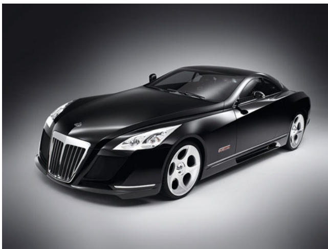
Abb. 29.20 Concept Car Exelero genannter Versuchsträger der Fulda Reifen GmbH auf (geändertem) Maybach-57-Fahrwerk. Auffallend die überlange Motorhaube und die flach angestellte Windschutzscheibe, deren Wurzel um 40 cm gegenüber dem Serienwagen nach hinten verlegt wurde. Für die Hochgeschwindigkeitsversuche musste der Retro-Kühler teilweise abgedeckt werden. Techn. Daten s. Abb. 29.21
