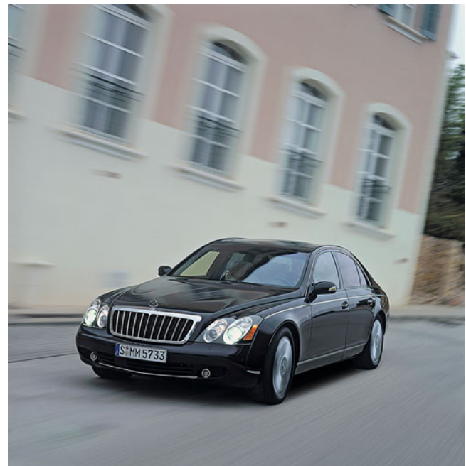
Abb. 29.22 Eine der zweifelhaften Marketingentscheidungen stellten die »sportlichen« Modelle 57 S (Bild) von 2005 und 62 S von 2006 dar. Hier sollten mit auf 612 PS leistungsgesteigerten Motoren und geänderten Ausstattungsmerkmalen die Verkaufszahlen angehoben werden. Erfreulicherweise wurde auf Spoiler verzichtet. 2005 Maybach 57/62 S, V12 Zylinder Biturbo, 5.977 cm 3 , 612 PS/450 kW
