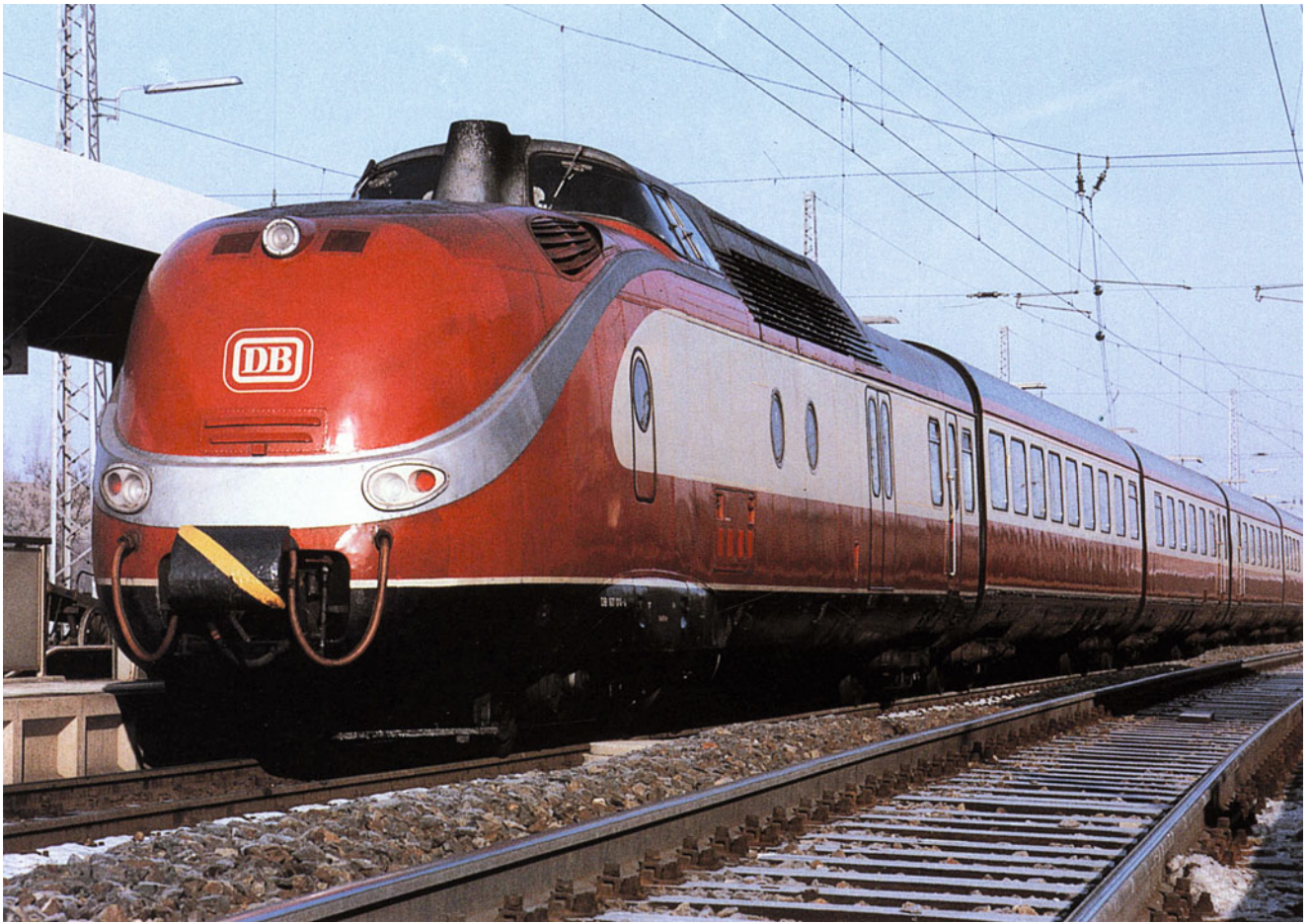
Tafel 15.12 1957 wurden von der Deutschen Bundesbahn neu entwickelte TEE-Züge vom Typ VT 11.5 (später Baureihe 601) in Dienst gestellt. Wie bei den V-200-Lokomotiven mussten die Motoren der Firmen Daimler-Benz, MAN und Maybach gegeneinander austauschbar sein. Jeder Zug hatte zwei 809 kW (1.100 PS) starke Motoren und erreichte eine Höchstgeschwindigkeit von 160 km/h
