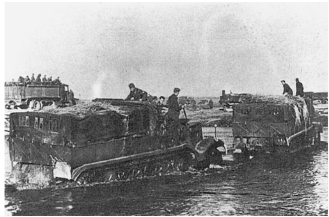
Abb. 11.42 Zwei schwere »Zugkraftwagen« (Sd.Kfz. 9) – es handelt sich um die 18-Tonnen-Halbketten-Zugmaschine mit Maybach-HL-108-Motor (169 kW/230 PS bei 2.600 min -1 ) – beim Durchqueren eines Flusses im Osten
