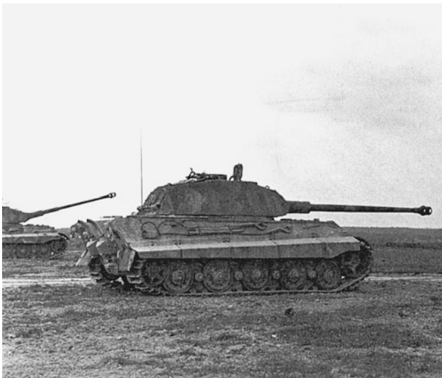
Abb. 11.35 Schwere Panzer »Königtiger« im August 1944 in der Champagne. Die ersten 50 Wagen dieses Typs hatten den nach seinem Mitkonstrukteur benannten stromlinienförmigen, jedoch fertigungstechnisch aufwendigen »Porsche«-Turm mit walzenförmiger Rohrblende (vgl. auch Tafel 15.11)
