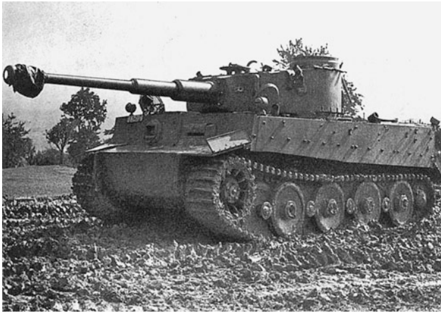
Abb. 20.7 Der schwere Panzerkampfwagen VI »Tiger« (56.900 kg) mit Maybach-HL-230-Motor und Maybach-Olvar-Getriebe wurde innerhalb eines Jahres (vom Auftrag bis zum Prototyp) als Antwort auf den sowjetischen T-34 entwickelt
