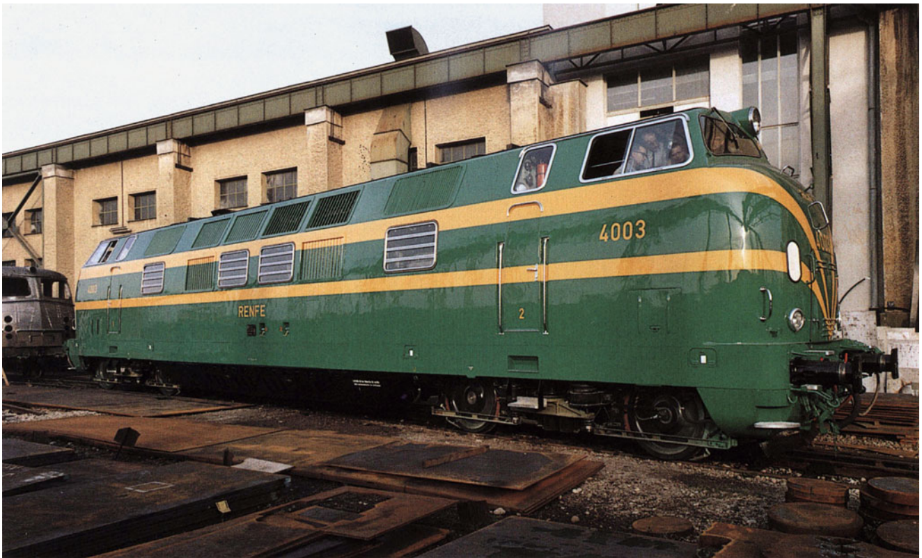
Tafel 25.6 Die Spanische Staatsbahn (RENFE) erteilte 1961 einen Auftrag über 50 Lokomotiven der Bauart Krauss-Maffei M 4000 C'C'. Ihre 2.941 kW (4.000 PS) wurden von zwei Maybach-MD-870-Motoren (16 V 538) dargestellt und durch Maybach-Mekydro-K-184-BT-Getriebe, Maybach-Gelenkwellen und -Achstrieb auf die (Breitspur-)Schiene (1.668 mm) gebracht
