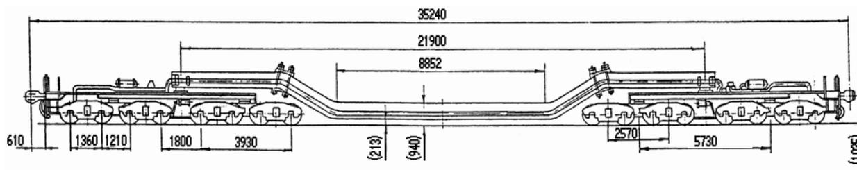
(Размеры в скобках относятся к груженому транспортеру. Длина погрузочной площадки при толщине подкладок 40 мм 9340 мм)
