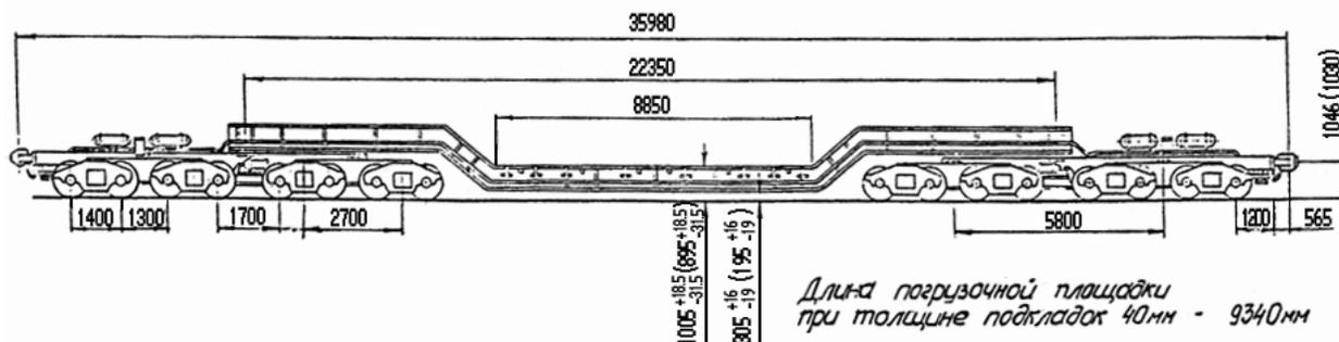
(Размеры в скобках относятся к груженому транспортеру. Длина погрузочной площадки при толщине подкладок 40 мм 9340 мм)
