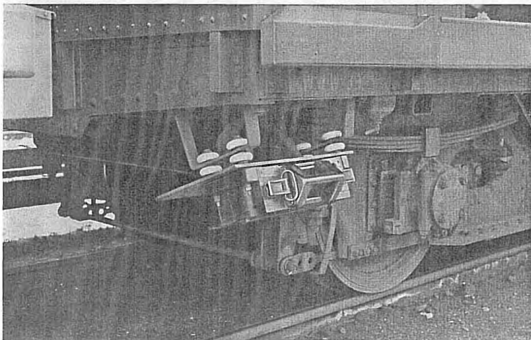
Bild 58. Einbau der Wagenhauptsicherung
