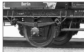
Laufwerk eines geschweißten Kesselwagens aus dem Jahr 1938. Markant sind die nun flacheren, längeren Federpakete und die Federaufhängung in Schaken anstelle von Laschen. (Werkfoto Waggonfabrik Esslingen). Typisch für in den 30er Jahren gebaute Gls-Wagen waren die langen Federpakete, die eine weiche Abfederung sicherstellen sollten. (Foto SC)
