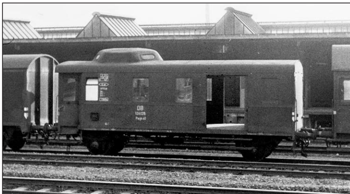
Der in Gütersloh aufgenommene Pwgs 41 124 125 war auch im Oktober 1961 noch weitgehend im Ablieferungszustand. Geändert waren zwischenzeitlich lediglich die Signalstützen und Leitern sowie der hinzugekommene Zettelkasten. (Foto Wolfgang Illenseer)
