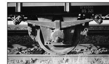
Laufwerk eines geschweißten Kesselwagens aus dem Jahr 1938. Markant sind die nun flacheren, längeren Federpakete und die Federaufhängung in Schaken anstelle von Laschen. (Werkfoto Waggonfabrik Esslingen). Typisch für in den 30er Jahren gebaute Gls-Wagen waren die langen Federpakete, die eine weiche Abfederung sicherstellen sollten. (Foto SC)
