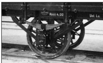
Laufwerke mit Flacheisenachshaltern und geteiltem Gleitlager bayerischer Bauart eines 1905 gebauten Wagens der Pfalzbahn (links) und eines Omk aus dem Jahr 1910. (Werkfotos MAN)
