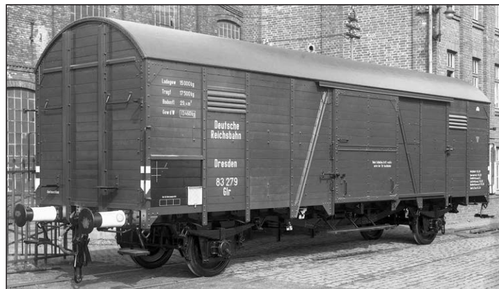
Austauschbauwagen mit den Anschriften der DRB im Ablieferungs- stand: Oben der von der Maschinenfabrik Esslingen gebaute Gr Kassel 85 310 im Juli 1928, unten der von SEAG gebaute Glr Dresden 83 729 am 19. März 1934. (Werkfotos Maschinenfabrik Esslingen, SEAG)
