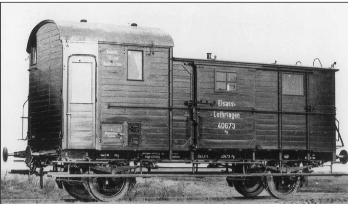
1909 baute die Waggonfabrik Rastatt für die Staatseisenbahn Elsass-Lothringen den dem Blatt IIa 13 der preußischen Normen entsprechenden Pg 40673 noch mit Flacheisenachshaltern. (Foto Slg. H. Hoyer)
