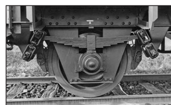
UIC-Doppelschakenlaufwerk eines Offs 59 und eines Vlmms 63. (Fotos Bustorff, Slg. SC) Unten Laufwerke eines Hbis mit Hochleistungsbremse und automatischer Lastabbremse (links im Bild das Wiegeventil) und eines für 160 km/h zugelassenen Hbills-y 307 mit hydraulischen Schlingerdämpfern und Hochleistungsbremsen mit Schnellbremsbeschleunigern und Gleitschutz. (Foto SC)
