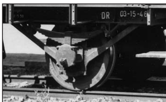
Bereits in den 30er Jahren erhielten viele Länderbahnwagen Radsätze mit ungeteilten Verbandsbauart-Gleitlagern. (Foto Fritz Willke, Slg. Klaus Heidt). Daneben ein Austauschbauart-Laufwerk aus dem Jahr 1928 mit den für die Bauart typischen Sicken in den Achshalterblechen. (Werkfoto Westwaggon)
