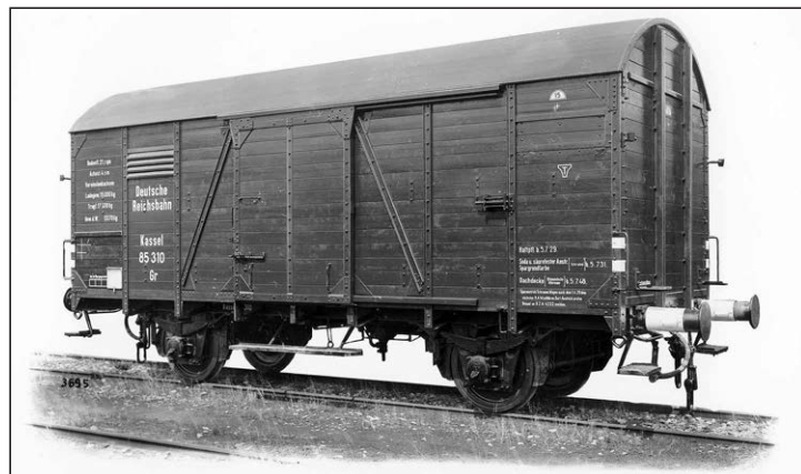
Austauschbauwagen mit den Anschriften der DRB im Ablieferungs- stand: Oben der von der Maschinenfabrik Esslingen gebaute Gr Kassel 85 310 im Juli 1928, unten der von SEAG gebaute Glr Dresden 83 729 am 19. März 1934. (Werkfotos Maschinenfabrik Esslingen, SEAG)
