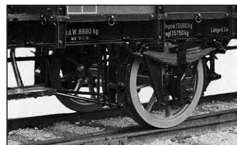
Laufwerke mit Flacheisenachshaltern und geteiltem Gleitlager bayerischer Bauart eines 1905 gebauten Wagens der Pfalzbahn (links) und eines Omk aus dem Jahr 1910. (Werkfotos MAN)
