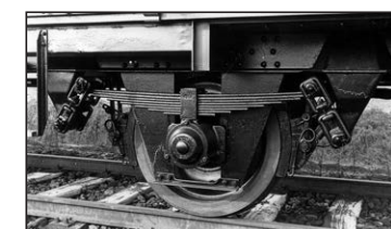
UIC-Doppelschakenlaufwerk eines Offs 59 und eines Vlmms 63. (Fotos Bustorff, Slg. SC) Unten Laufwerke eines Hbis mit Hochleistungsbremse und automatischer Lastabbremse (links im Bild das Wiegeventil) und eines für 160 km/h zugelassenen Hbills-y 307 mit hydraulischen Schlingerdämpfern und Hochleistungsbremsen mit Schnellbremsbeschleunigern und Gleitschutz. (Foto SC)
