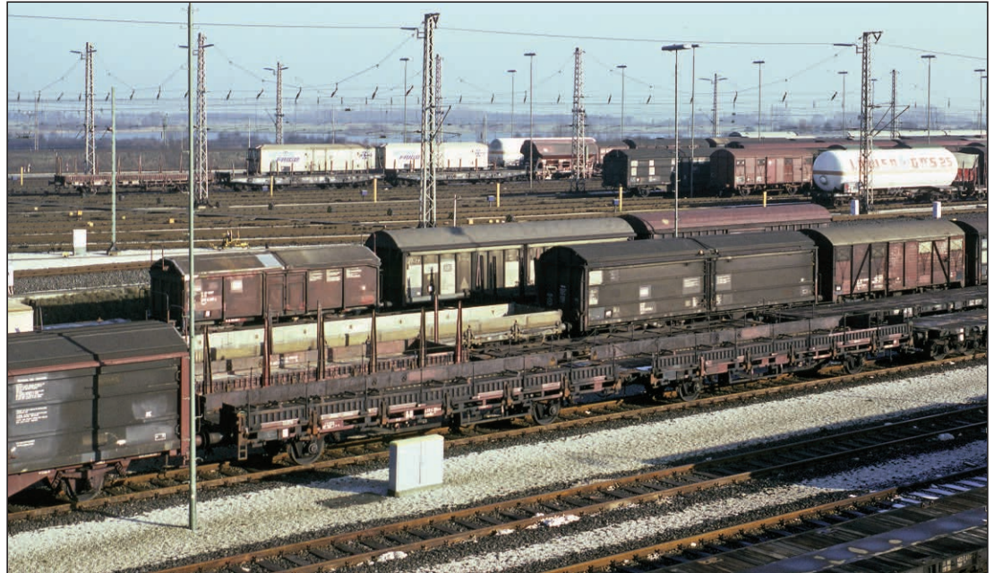
Blick über die Gleise der Waggon Schnellreparatur und eine Einfahrgruppe des Rbf Maschen im Januar 1989. Zwar steht mit dem Laadks 540 433 4055 eine seltenere Bauart im Vordergrund, neben ausländischen G-Wagen überwiegen im Hintergrund aber Schiebewand- und Schiebedachwagen sowie Flachwagen unterschiedlicher Bauarten. (Foto SC)
