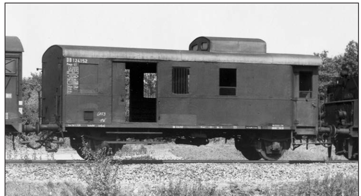
Ebenso wie der links abgebildete Wagen hatte der nach der Zeichnung Fwgä 8.01.201 gebaute Pwgs 41 124 152 noch eine Dampfheizung. Das Foto zeigt ihn im September 1959 bei Fulda. Bis auf den Zettelkasten war der Wagen im Ablieferungszustand. (Foto Joachim Claus)
