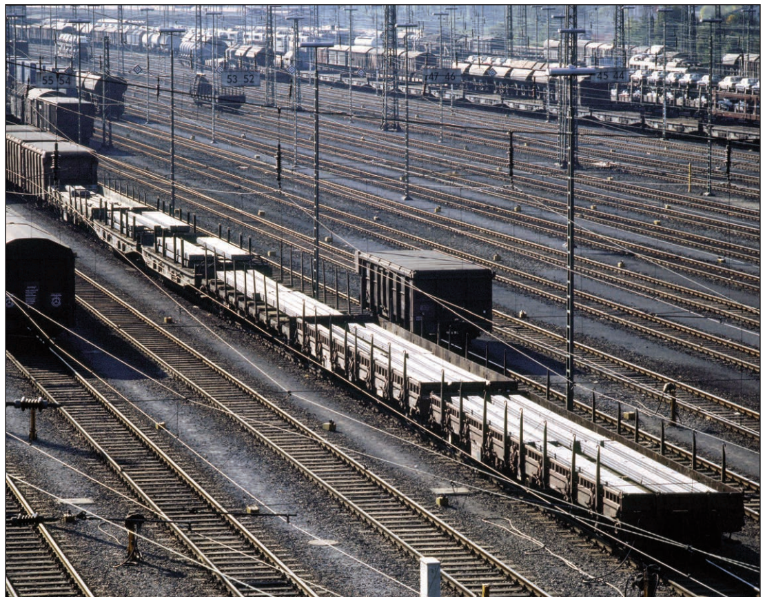
Hagen-Vorhalle, vermutlich im Sommer 1990. Im Vordergrund mit Stabstahl beladene Wagen – zwei (Schweizer) Res, je ein Rs, Samms 709, Samms 710 und Res 687. Dahinter und daneben stehen mehrere Rolldachwagen. Im Bildhintergrund u. a. zahlreiche leere Samms sowie Selbstentlade- und Autotransportwagen. (Foto Ulrich Hesse)
