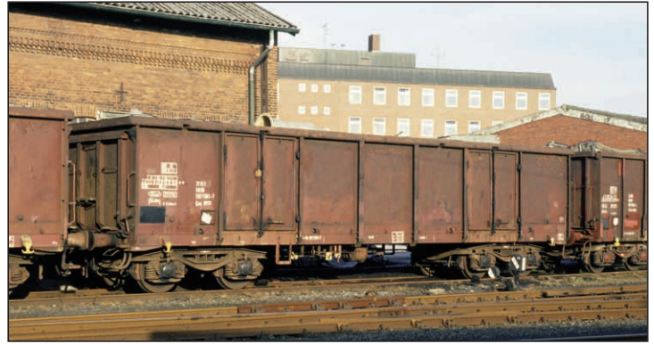
Die 9.-häufigste Bauart waren 3.431 UIC-Standardwagen Eas [5949/71]. Auf dem Foto der im August 1993 im Bahnhof Leer aufgenommene Eas [5971] 597 1561.
