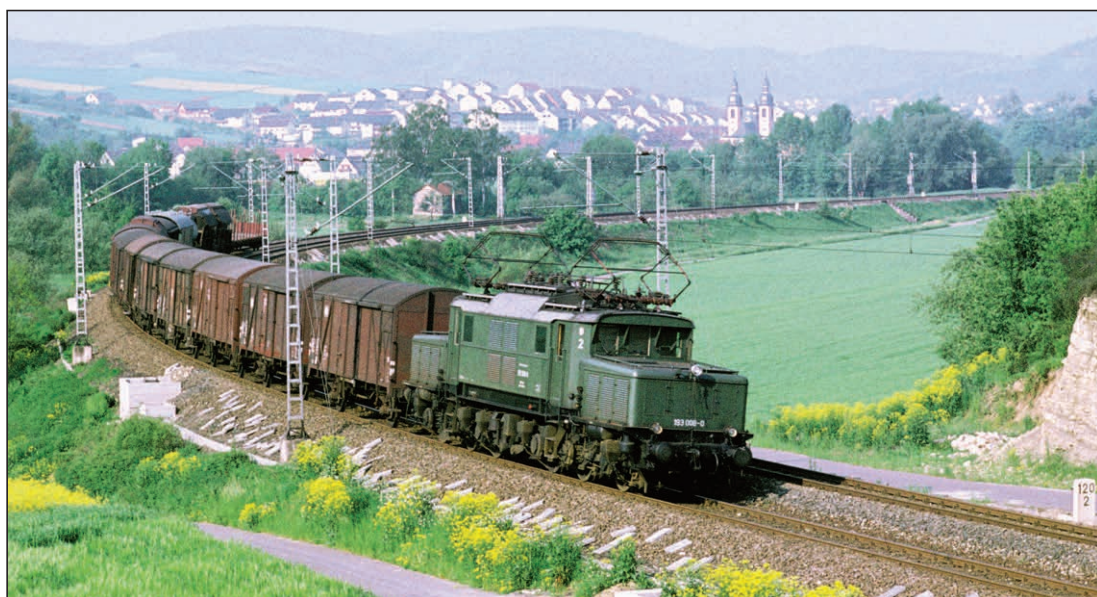
Der von 193 008 gezogene Dg 56200 Kornwestheim–Würzburg, aufgenommen in der Nähe von Gerlachsheim, bestand am 27. Mai 1978 auf dem letzten Abschnitt überwiegend aus G-Wagen. Am Zugschluss liefen eine zu einem Bauzugwagen umgebaute Donnerbüchse, ein Kesselwagen, zwei Tds und ein Rs. (Foto Ulrich Budde)
