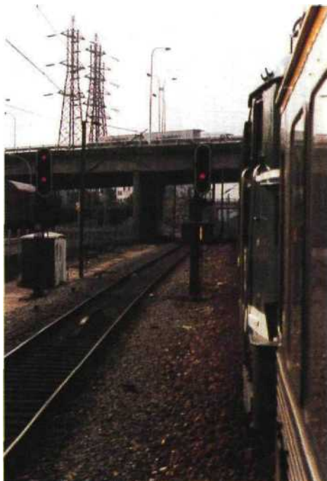
Fig. 1.25 Carré et sémaphore présentés sur deux voies contiguës.
