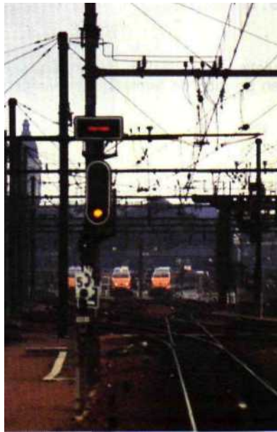
Fig. 5.14 Bande lumineuse jaune horizontale présentée, en complément de l'avertissement, sur le panneau de protection de l'entrée de la gare; elle commande au mécanicien de s'arrêter sur une distance réduite.
