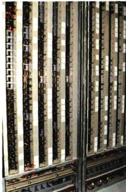
Fig. 13.11 Vue arrière d'un châssis montrant la réalisation du câblage des parties fixes supportant les relais à l'aide de cosses «Paston» et de fils guidés par les ouvertures pratiquées dans les gouttières.
