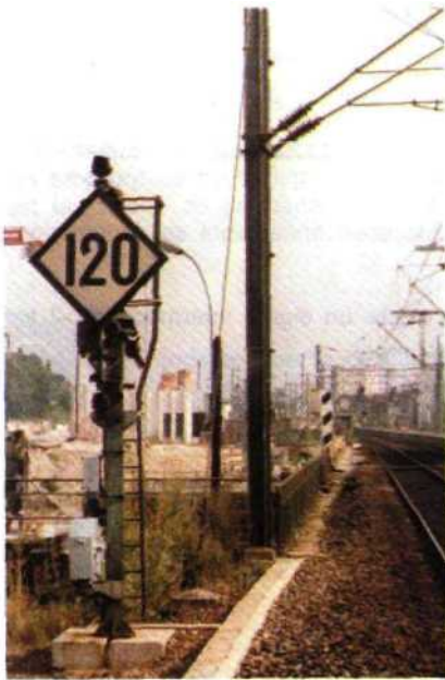
TIV 120 d'annonce mobile mécanique fermé,
