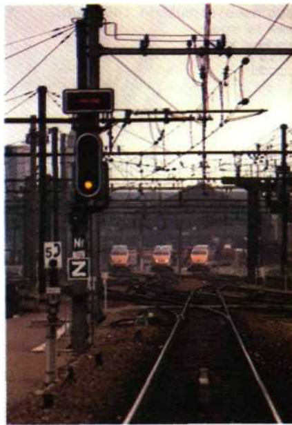
Fig. 1.45 Bande lumineuse jaune horizontale groupée avec le panneau d'entrée d'une gare donnant accès à une voie courte ou partiellement occupée.
