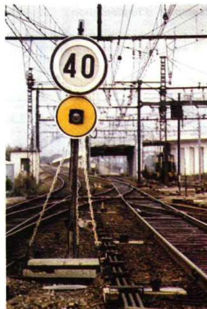
Fig. 1.83 ▶ TIV de chantier à distance complété d'un disque jaune de hauteur normale.
