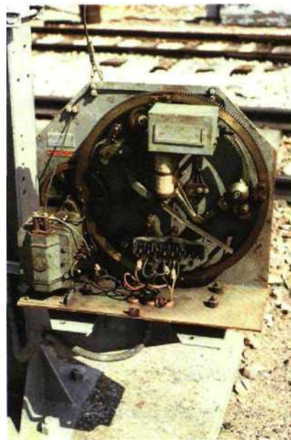
◀ Fig. 5.4 Tableaux indicateurs de vitesse à distance mobiles mécaniques commandés électriquement et complétés par deux voyants blancs clignotant alternativement lorsqu'ils sont présentés, la vitesse-plafond de la ligne étant ici supérieure à 120 km/h. Le premier TIV sur la photo est en position d'ouverture (cible parallèle à la voie). ▶
