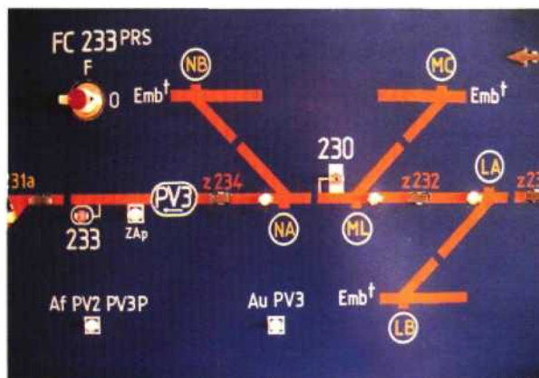
Fig. 13.43 — Contrôle de l'enclenchement d'une autorisation sur le TCO d'un PRS.
