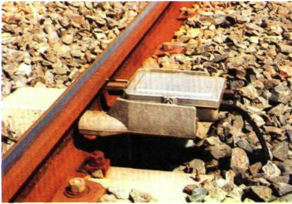
1. Détecteur non orienté type «Cautor» (fabrication Silec).
