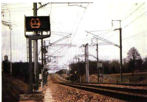
Fig. 1.165 — Signal d'exécution «Coupez courant» mobile lumineux fermé.
