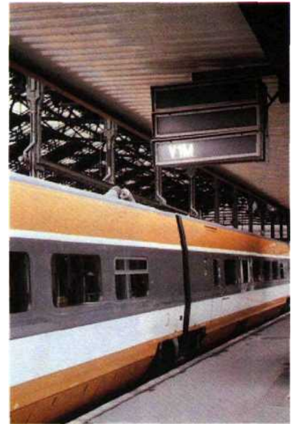
◀ Fig. 1.102 Tableau lumineux de direction indiquant que la direction correspondante est celle de la voie 2.
