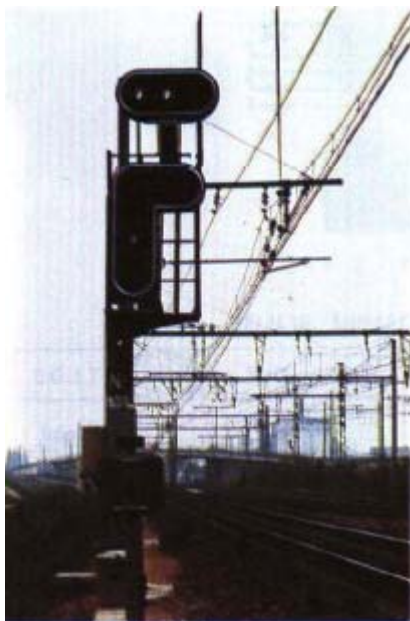
Fig. 5.10 Indicateur de direction groupé avec le signal de protection de la bifurcation; les deux feux blancs allumés indiquent au mécanicien qu'il va prendre la deuxième direction géographique à partir de la gauche.
