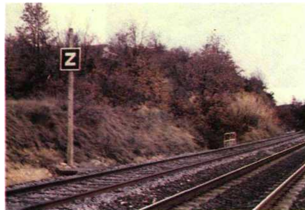
Fig. 1.51 — Pancarte «Z» repérant l'origine de la partie de voie à franchir à vitesse limitée.
