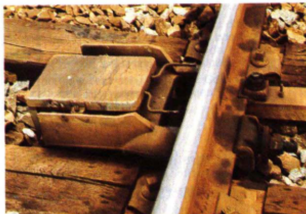
Fig. 3.51 Détecteur électromécanique orienté type «Forfex» (fabrication Silec).
