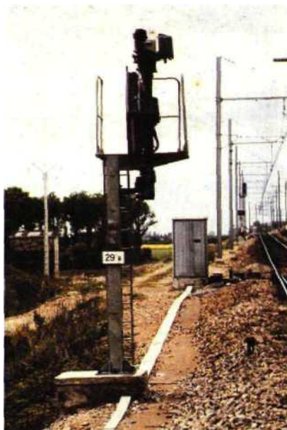
◀ Fig. 1.68 TIV à distance mobile mécanique ouvert.
