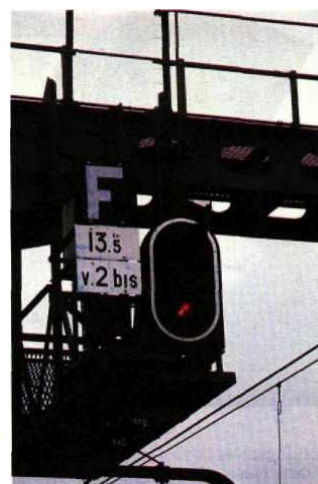
Fig. 1.189 Repérage et identification d'un signal sur potence installé au km 13,5 de la ligne et sur la voie 2 bis.
