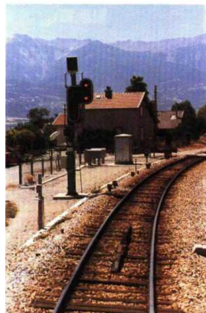
▶ Fig. 1.62 Signal sur mât présentant l'indication de rappel de ralentissement 30.
