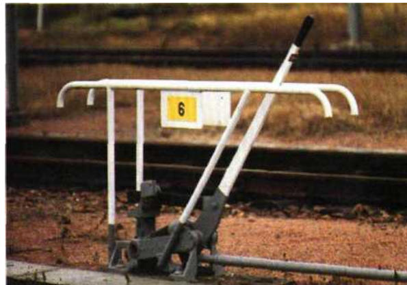
2. vue en détail du levier de commande cadenassable.
