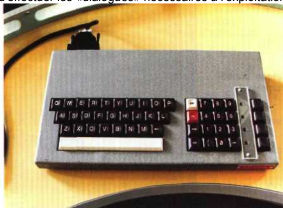
Fig. 15.6 — Vue d'un clavier alphanumérique de commande d'un PRCI. A noter que dans le cas où le PRCI est le seul système informatique installé, les dialogues ne faisant appel qu'aux chiffres, un clavier uniquement numérique peut être mis en œuvre.
