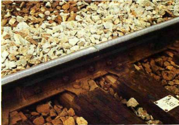
Fig. 3.27 Joint isolant collé.
