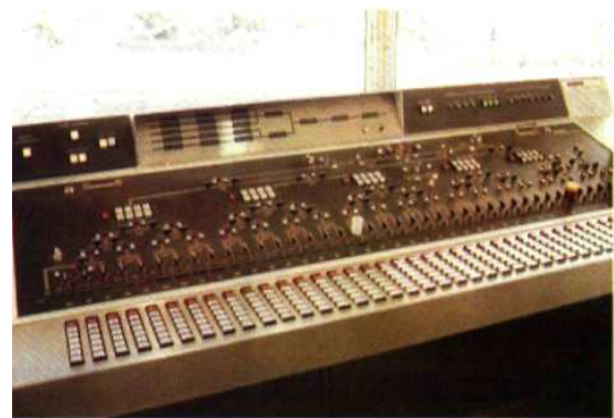
Fig. 16.79 — Table de commande manuelle des aiguillages et des freins (technologie pneumatique).
