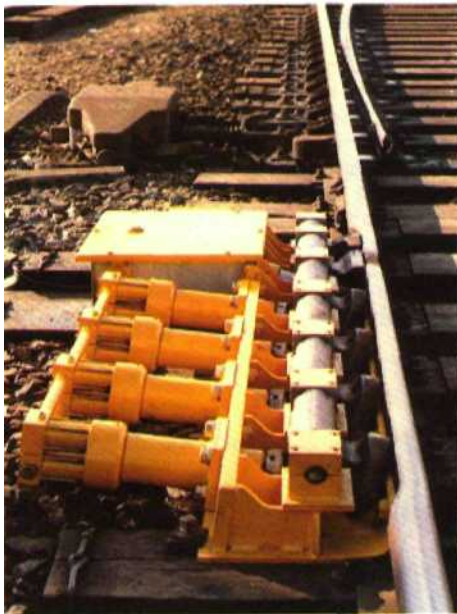
Fig. 16.81 Frein ponctuel de régulation Faiveley.
