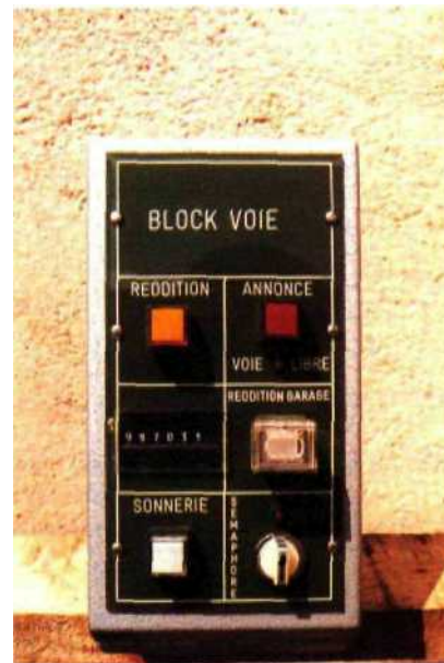
Fig. 8.16 Tableaux de block miniaturisés pour ligne à double voie équipée du BMU: cas du poste Intermédiaire:
