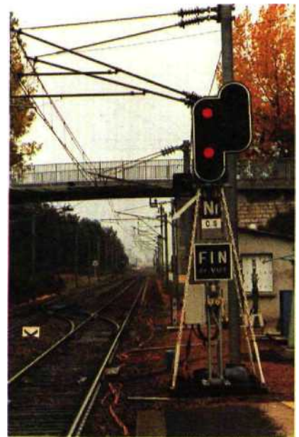
Fig. 1.120 Signalisation de sortie d'une voie unique temporaire:
