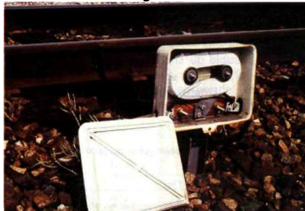
Fig. 3.41 — Self de voie à air (SVa) dans un joint électrique de séparation.
