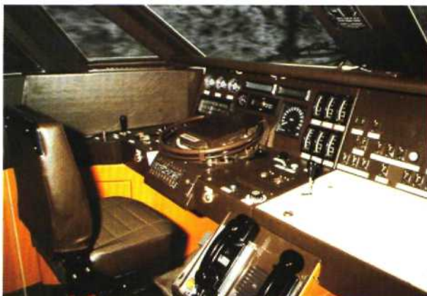
Fig. 19.1 — Pupitre de conduite d'une rame TGV équipée de la signalisation de cabine.
