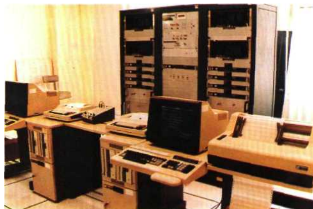
ordinateur pour le traitement centralisé des informations installé au poste d'aiguillage et de régulation (PAR) de la ligne à grande vitesse Paris-Sud-Est.►
