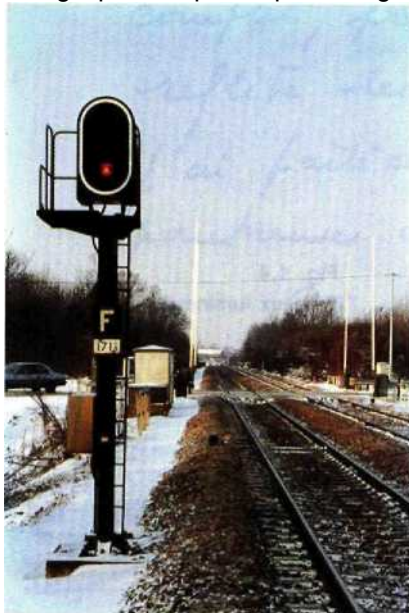
Fig. 1.1 Signal lumineux sur mât normalement implanté à gauche de la voie:
