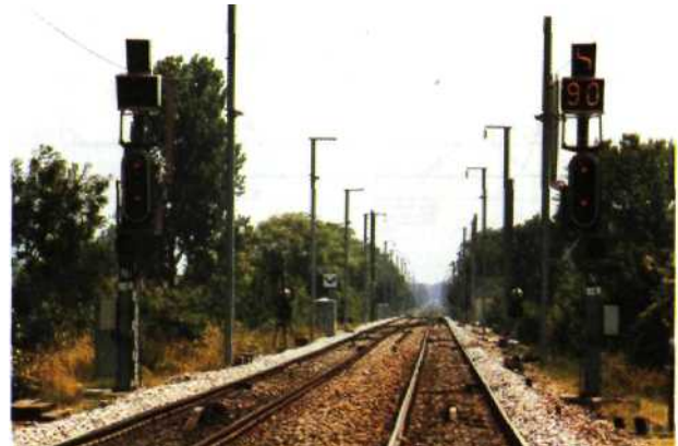
4. Sur la voie de droite, l'itinéraire de sortie de contresens est formé et enclenché, le TIV de rappel pour le franchissement des aiguillages et le tableau de sortie de contresens (TSCS) étant présentés. L'ouverture du signal carré interviendra automatiquement à la libération du canton aval.
