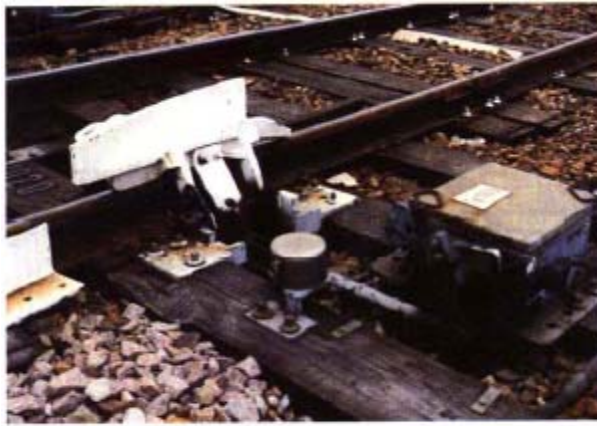
Fig. 4.56 — Contrôle d'un taquet dérailleur manœuvré par moteur électrique.
