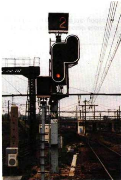
◀ Fig. 1.102 Tableau lumineux de direction indiquant que la direction correspondante est celle de la voie 2.
