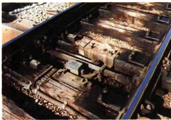
Fig. 4.18 — Aiguillage verrouillé par verrou indépendant — vue du verrou capot enlevé —
