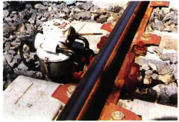
2. détecteur orienté (fabrication Paulvé).
