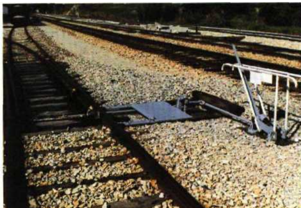
1. vue d'ensemble de l'appareil de vole et de son levier de commande,
