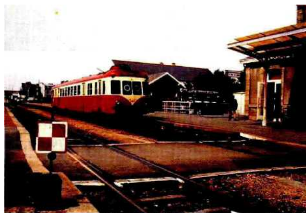
Fig. 1.37 — Signal d'arrêt à main constitué par un jalon d'arrêt à damier rouge et blanc.
