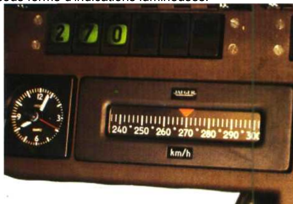
Fig. 19.2 — Indication lumineuse donnée en permanence au mécanicien, ici «270 sur fond vert» l'autorise à rouler à 270 km/h (voir § 19.5.1).
