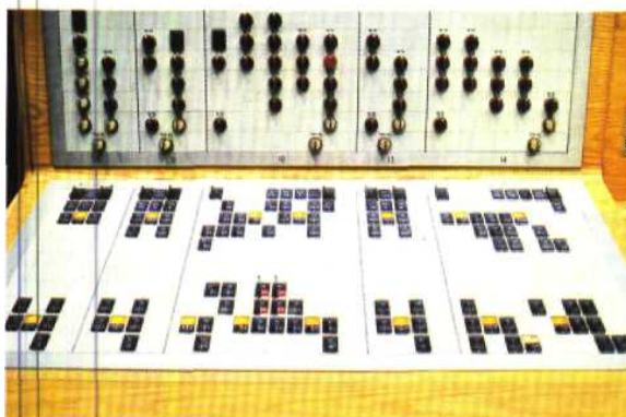
Fig. 19.74 — Table des boutons de commande d'itinéraires utilisée en «mode PRS» sur la LGV-PSE
