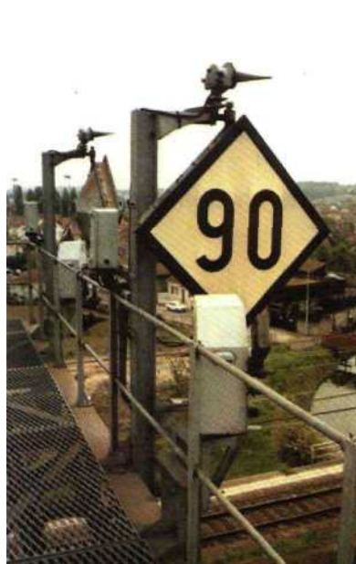
◀ Fig. 5.4 Tableaux indicateurs de vitesse à distance mobiles mécaniques commandés électriquement et complétés par deux voyants blancs clignotant alternativement lorsqu'ils sont présentés, la vitesse-plafond de la ligne étant ici supérieure à 120 km/h. Le premier TIV sur la photo est en position d'ouverture (cible parallèle à la voie). ▶
