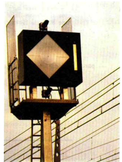
Fig. 1.72 TIV à distance mobile lumineux présenté.
