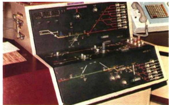
Fig. 16.13 - Autre type de meuble à disposition de l'aiguilleur; celui-ci comporte deux PMV sur les parties inclinées et un PEI disposé horizontalement.
