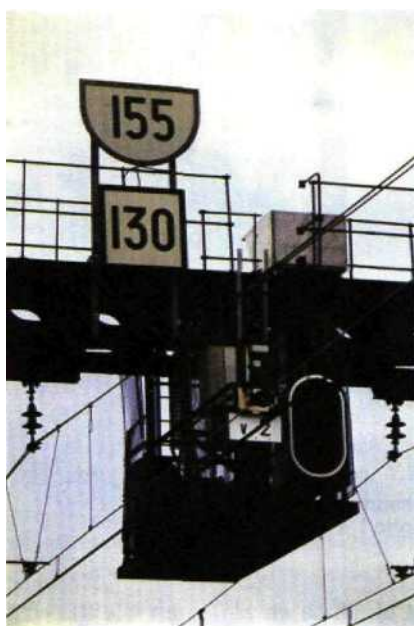
Fig. 1.56 TIV fixe à distance de forme carrée complété d'un TIV fixe à distance du type B, le tout monté sur portique.
