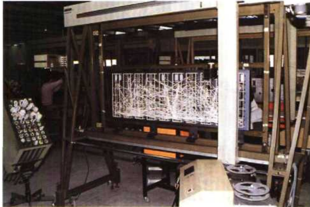
Fig. 14.61 - Vue partielle d'un atelier de câblage mécanisé de platines. A noter sur la partie gauche de la photo le distributeur de fils de câblage coupés à l'avance à la longueur désirée et sur la partie droite le lecteur de bande pilotant le guidage qui permet à la personne chargée du câblage de positionner le «pistolet» à connexions enroulées sur la borne voulue.
