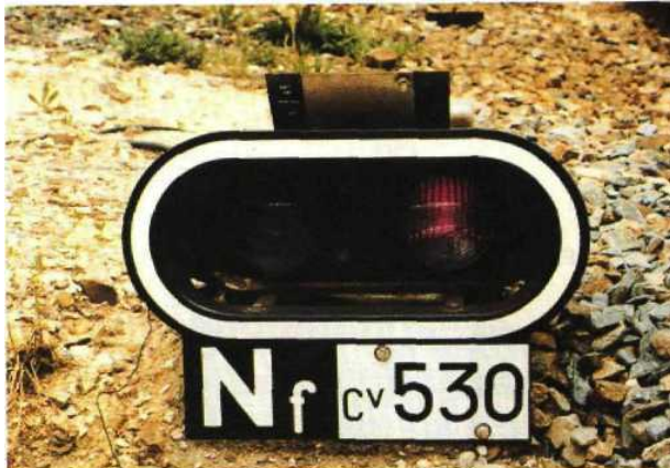
Fig. 1.16 Carré violet de type bas, surélevé dans les zones de montagne particulièrement enneigées.
