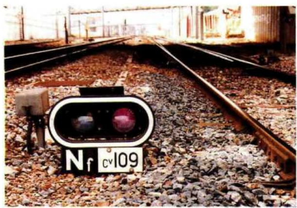
Fig. 1.3 — Signal de type bas installé au ras du sol.
