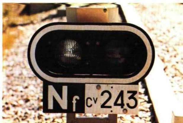
Fig. 1,155 — Carré violet de type bas ouvert présentant un feu blanc de manœuvre.
