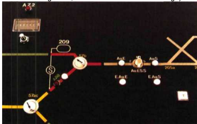
Fig. 16.35 - Lorsque le PMI est directement relié à des voies principales, une manette d'autorisation permet les liaisons (entrées et sorties du PMI) avec le poste de voies principales (PRS, PRG, ...).
