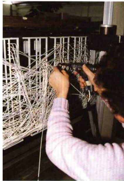
Fig. 14.62 Platine en cours de câblage
