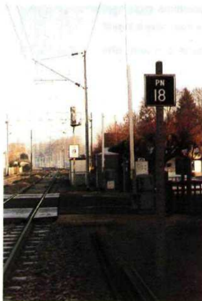
Fig. 1.129 Pancartes repérant la proximité de passages à niveau, avant lesquels le mécanicien doit s'arrêter en application d'instructions, notamment pour les circulations exceptionnelles à contresens.
