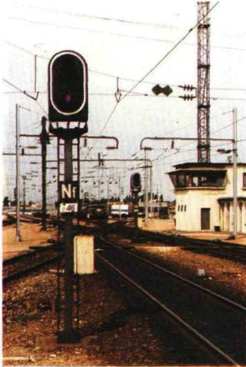
Fig. 1.15 Ensemble de carrés violets de normale installés sur de service.
