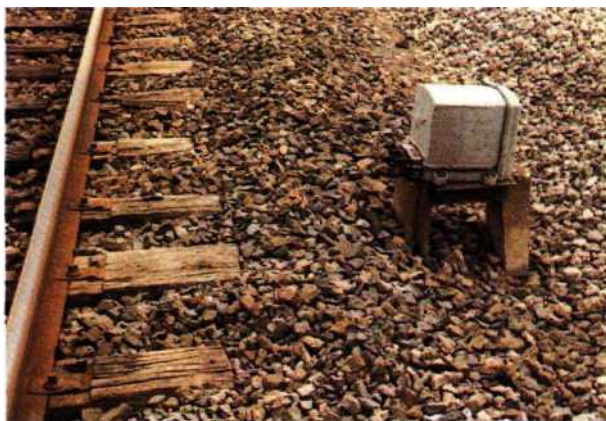
Fig. 1.185 Détonateur électrique installé à la voie.
