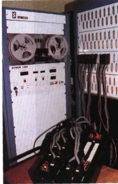
Fig. 14.65 Système informatique servant à tester la réalisation du câblage mécanisé des platines; ici, une platine SI (en bas de la photo) en cours de test.
