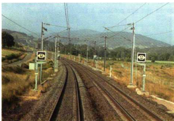
Fig. 1.167 — Signal d'exécution «Coupez courant» fixe.
