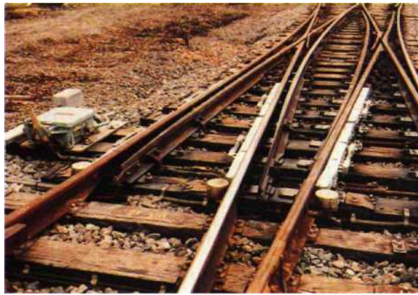
Fig. 4.30 — Traversée jonction double équipée d'une installation de réchauffage au propane.
