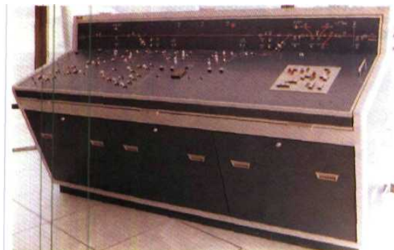
Fig. 16.12 - Outre le PRS dont on aperçoit le TCO sur la partie verticale et la table des boutons sur la partie droite, ce meuble comporte plusieurs postes de chantiers de voies de service, à savoir: un PMV, un PMI et un PEI.
