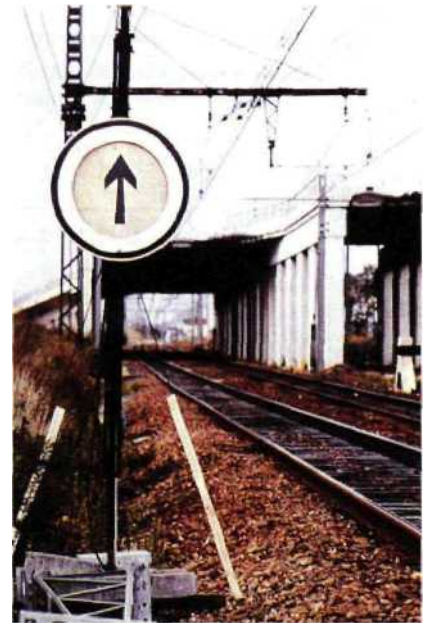
Fig. 1.92 Tableau à flèche verticale indiquant au mécanicien qu'il peut reprendre sa vitesse normale dès que la tête du train a franchi ce tableau
