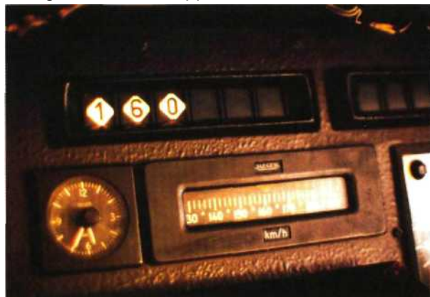
Fig. 19.8 — L'indication «160 sur fond blanc» commande au mécanicien de ne pas dépasser la vitesse de 160 km/h à l'entrée du canton suivant délimité par un repère.
