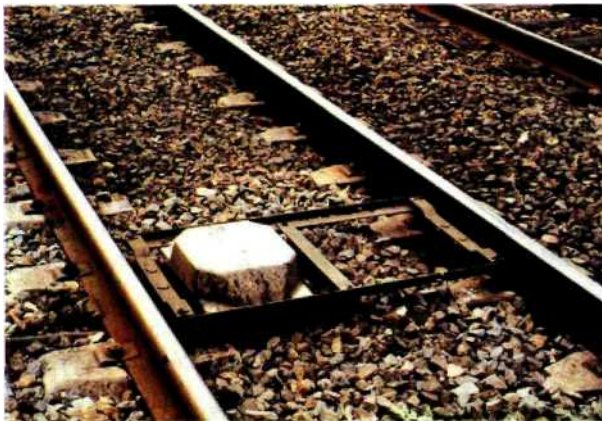
Fig. 1.178 Balise installée sur une ligne équipée de traverses béton.
