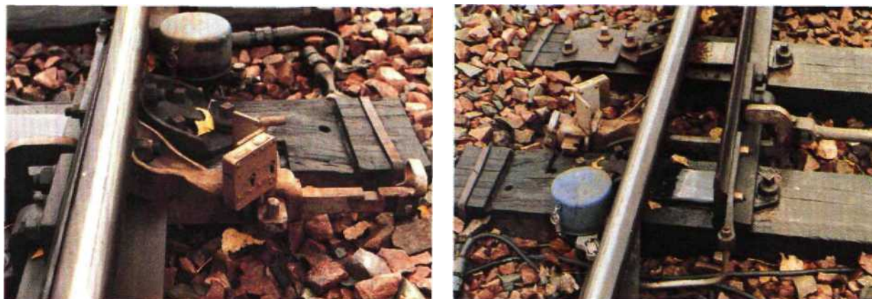
Fig. 4.20 — Griffe d'aiguille montée sur un aiguillage de voie unique temporaire (VUT):
