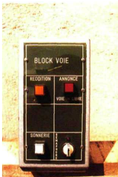
Fig. 8.16 Tableaux de block miniaturisés pour ligne à double voie équipée du BMU: cas du poste Intermédiaire:
