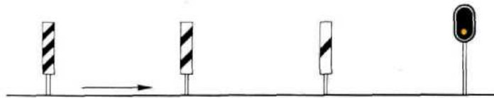
Fig. 1.172 Mirlitons repérant l'approche d'un signal à visibilité réduite.
