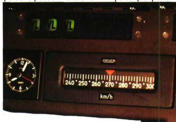
Fig. 19.9 — Sur la ligne TGV Paris-Sud-Est et sur les premières rames affectées à cette ligne, l'indication «VL sur fond vert» autorise le mécanicien à circuler à la vitesse-limite de la ligne à grande vitesse soit 270 km/h.
