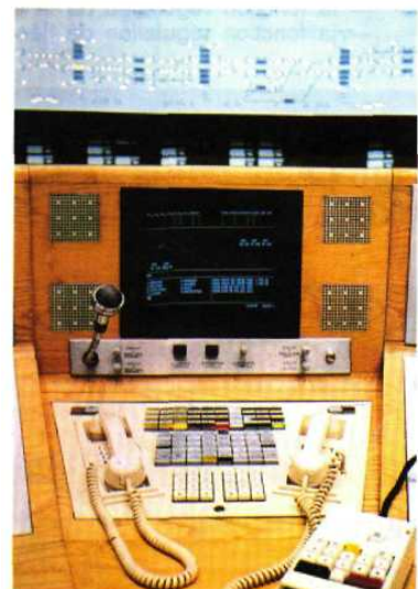
Fig. 19.74 — Table des boutons de commande d'itinéraires utilisée en «mode PRS» sur la LGV-PSE
