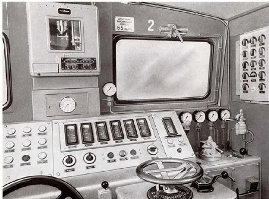
Anordnung der Kontroll- und Bedienungseinrichtungen im Führerstand
