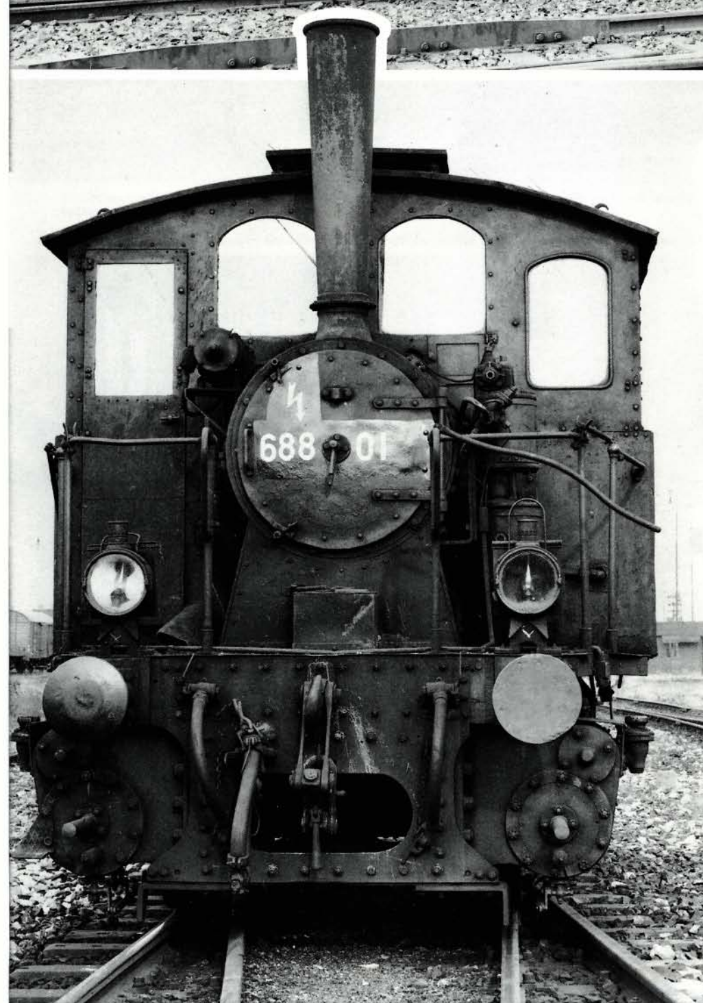
Bild 146: Die 688.01 von vorne. Die weißen Fenster-scheiben, in denen sich entweder der helle Himmel spiegelt, oder die retuschiert wurden, lassen den Eindruck entstehen, als sei die Wand des Führerhauses nur eine Kulisse. Interessant sind auch die damals noch verwendeten Petroleumlaternen. Foto: E. Schmidt, Sammlung Dr. Scheingraber
