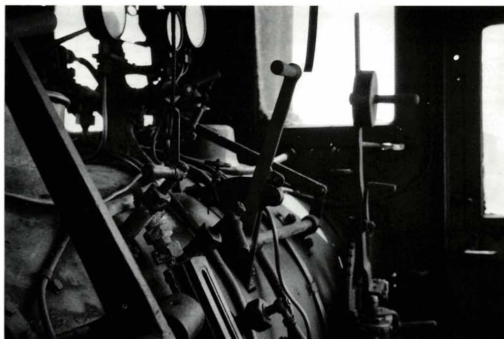
Bild 76: So sieht der Führerstand eines Glaskastens aus. Die Aufnahme entstand am 02.05.1958 im Bw Nördlingen in der 98 308. Foto: U. Monfort
