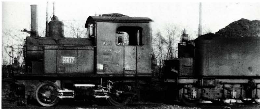
Bild 68: Die bereits ihrer Treibstangen beraubte 4017 ist deutlich kürzer als der neben ihr stehende vierachsige Tender der bayerischen Bauart 2'2' T 18.2.
