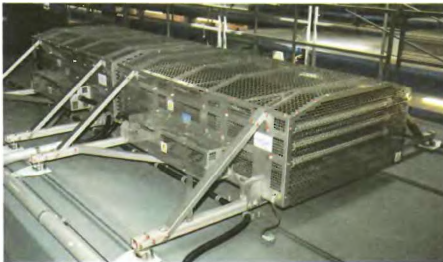
Рис. 4.20. Два блока тормозных сопротивлений, установленных на крыше электропоезда
