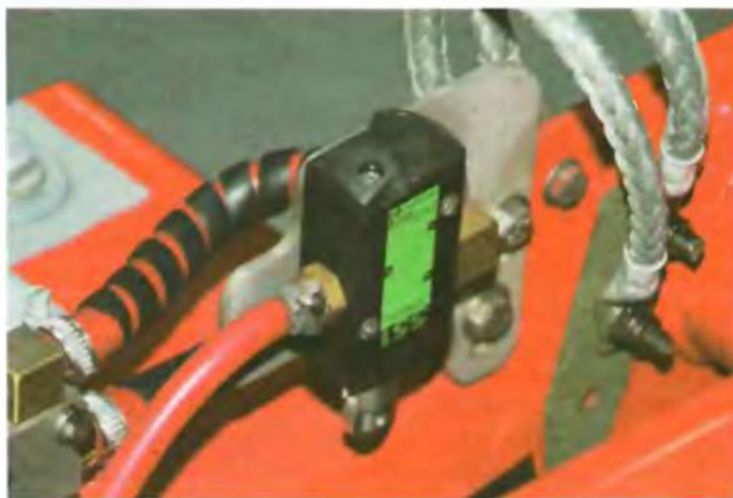
Рис. 4.7. Пневматический выключатель максимальной высоты подъема
