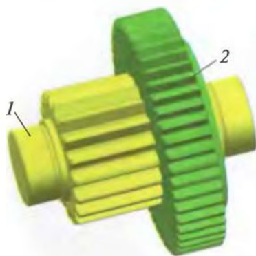
Рис. 2.61. Промежуточный вал: 1 — вал-шестерня; 2 — шестерня
