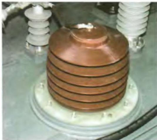
Рис. 4.14. Определитель системы напряжения
