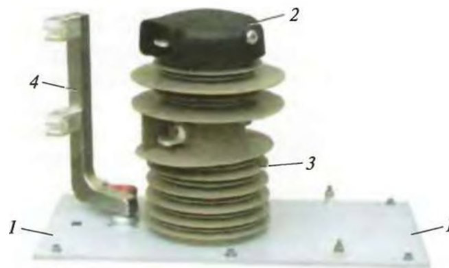
Рис. 4.30. Внешний вид главного выключателя (низковольтная часть не показана): 1 — плита основания; 2 — камера вакуумного выключателя (VST); 3 — изолятор; 4 — заземляющий разъединитель
