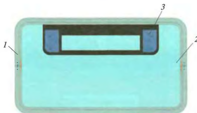
Рис. 2.6. Окно с боковым табло СИП: 1 — каркас; 2 — стеклопакет; 3 — кронштейн бокового табло СИП
