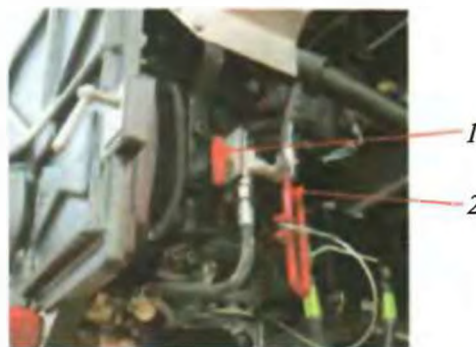
Рис. 10.21. Аварийное устройство расцепления: 1 — пневматический кран; 2 — аварийный трос
