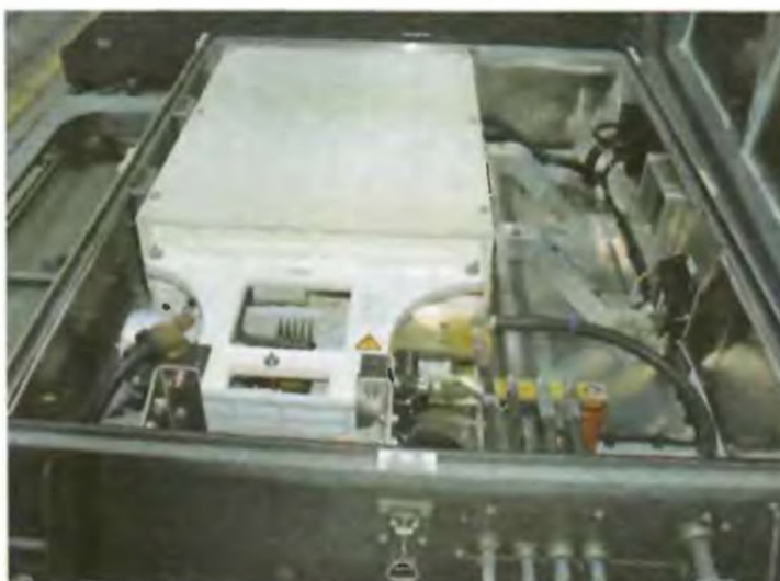
Рис. 4.25. Блок Modbox с открытой верхней крышкой
