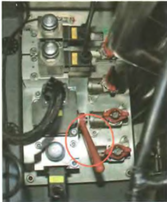
Рис. 10.16. Нижнее положение ручки крана быстродействующего клапана SIFA B40.02
