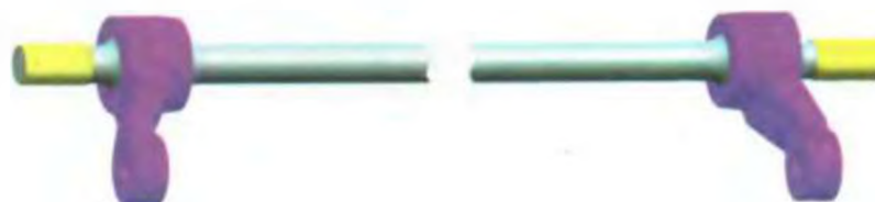
Рис. 2.52. Торсионный вал с опорными втулками и рычагами системы стабилизации
