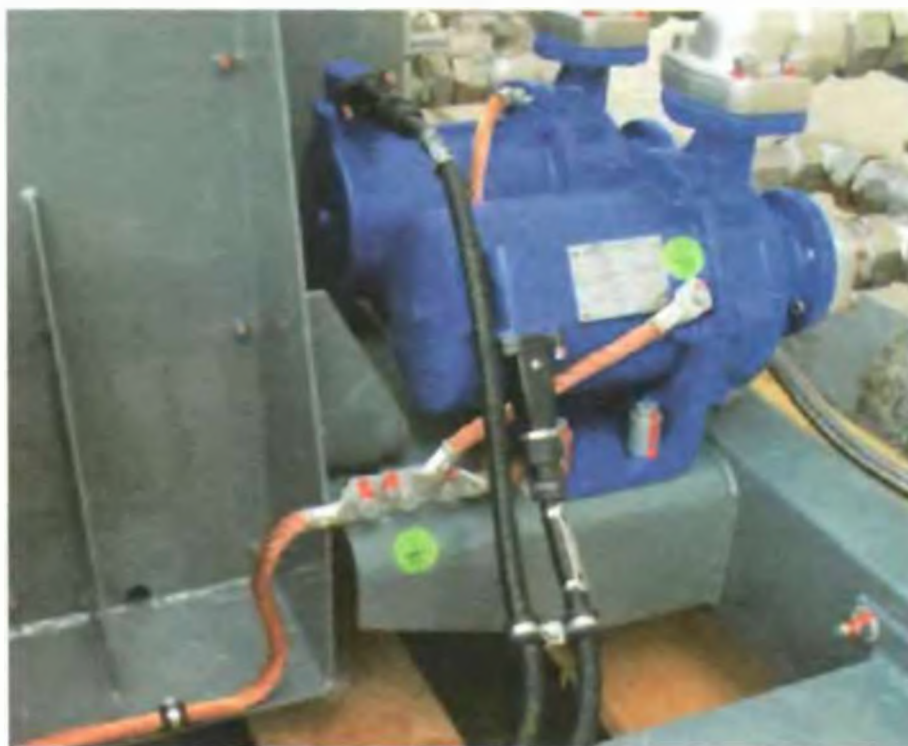
Рис. 3.9. Внешний вид насосов охлаждающей жидкости
