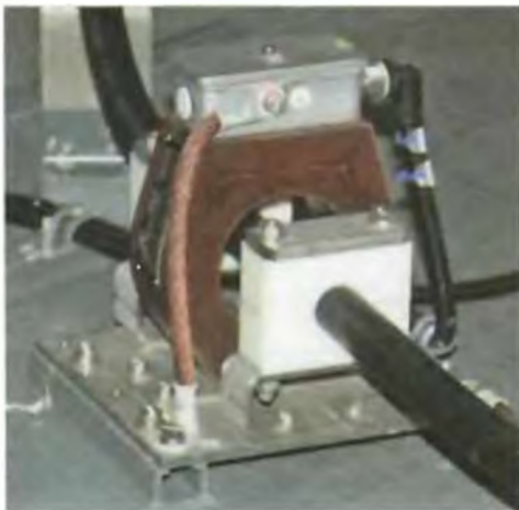
Рис. 4.18. Внешний вид датчика тока на крыше электропоезда
