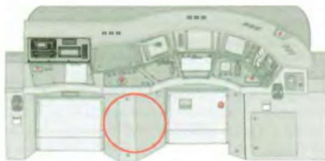
Рис. 10.14. Расположение крана быстродействующего клапана SIFA B40.02
