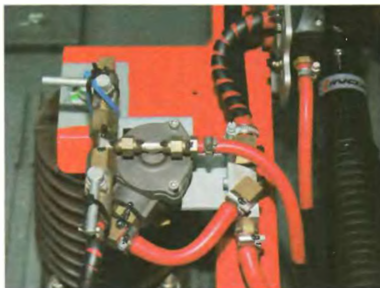
Рис. 4.5. Клапан быстрого опускания токоприемника
