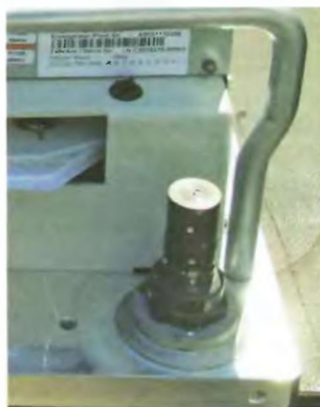
Рис. 5.29. Гидравлический разъем фазового модуля
