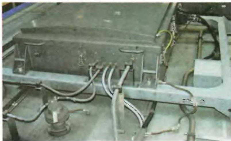
Рис. 4.15. Разрядник постоянного тока
