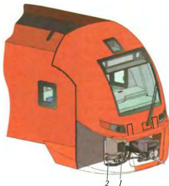
Рис. 2.79. Расположение разобщительных кранов:
