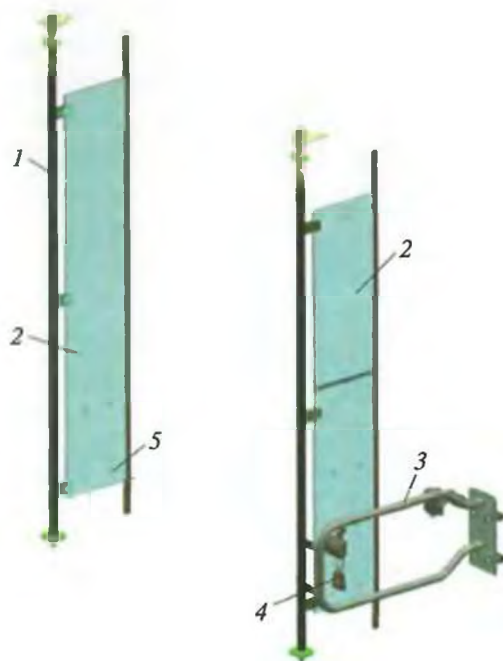
Рис. 2.14. Стеклопанельная перегородка: 1 — поручень; 2 — стеклянная перегородка; 3 — поручень для крепления кресла-коляски; 4 — ремень безопасности; 5 — место установки мусорного контейнера
