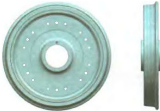
Рис. 2.57. Цельнокатаное колесо
