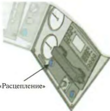
Рис. 10.20. Расположение (а) и внешний вид (б) кнопочного выключателя SB-S01
