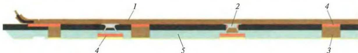
Рис. 2.7. Конструкция пола вагона: 1 — напольная плита; 2 — алюминиевый профиль; 3 — деревянная прокладка; 4 — эластомерное основание; 5 — гидро- и термоизоляция пола
