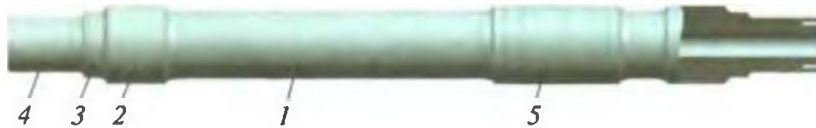
Рис. 2.56. Ось колесной пары моторного вагона:
