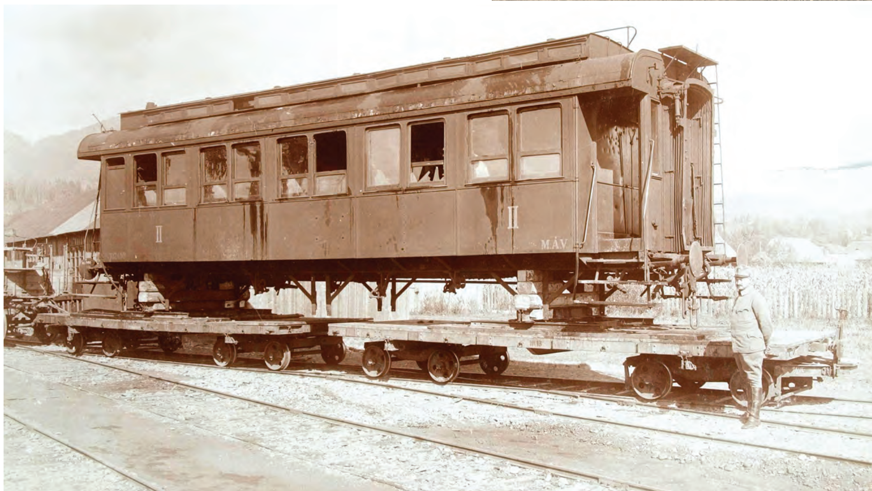
Transportul unui vagon MÁV clasa a II-a, pe două platforme, Nr.13 și Nr.14, a câte 4 osii cu roți mici.
