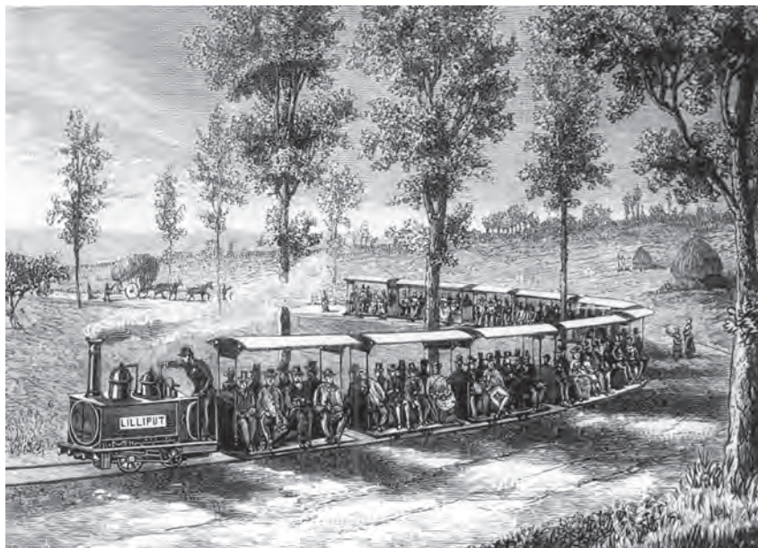
Trenul Decauville al Expoziției Universale de la Paris din 1878 din Grădina Botanică (Jardin d'Acclimation): era remorcat de locomotiva-tender Decauville Nr.1-„LILLIPUT” tip B-n2t (Bourdon-Corpet; nr.de fabricație 242/1878).
