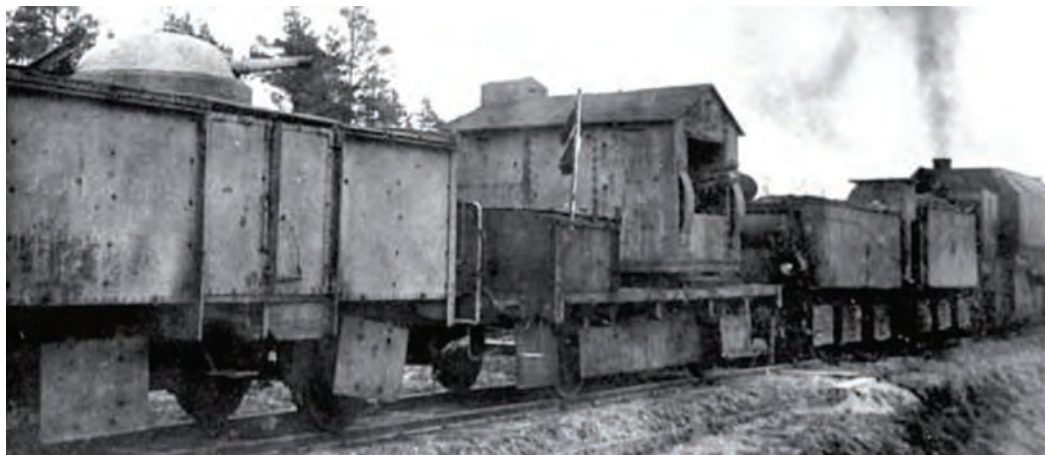
Trenul blindat german PZ Nr.5: era o construcție improvizată din compunerea căruia se observă, de la stânga la dreapta, un vagon blindat prevăzut cu o turelă în care era montat un tun de 53 mm, un vagon platformă cu o cutie „dog-house”, prevăzută cu un tun Putilov de 76,2 mm, un tender blindat pe două osii și o locomotivă-tender blindată din seria pr.T 9 3 tip 1C-n2t.
