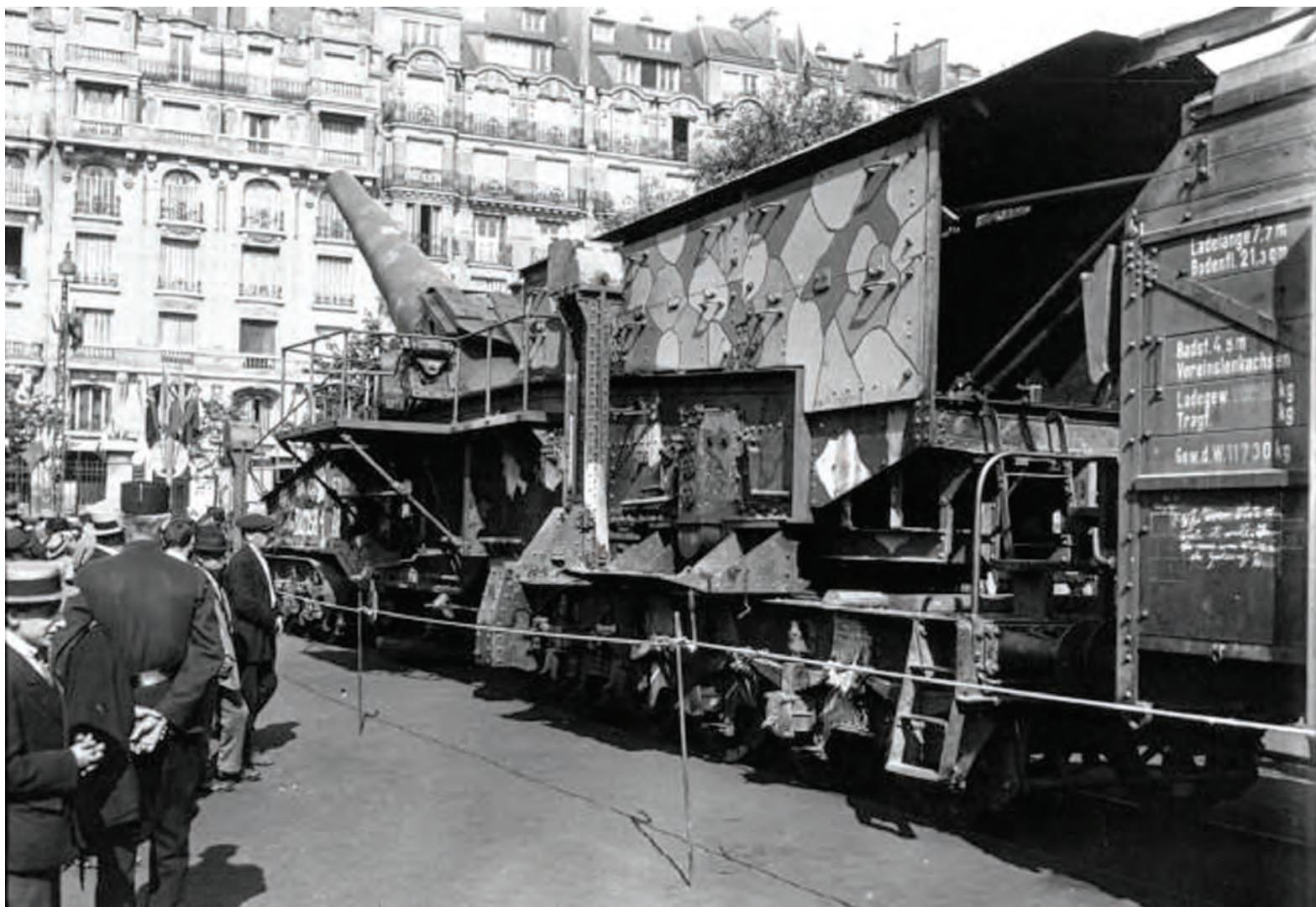
Tunul german 28 cm Kanone Essen 214.112 de 283 mm, capturat de Armata 4 Britanică, în 1918, și expus la 14 iulie 1919, la Paris-Gare du Champ de Mars. Cea mai mare piesă utilizată de germani în timpul Primului Război Mondial, 38 cm S.K. L/45 - „Max” Geschütz de 380 mm, era amplasată pe 18 osii, având o greutate totală de 267,9 tone, o lungime de 31,61 m și o bătaie de 47,5 km.
