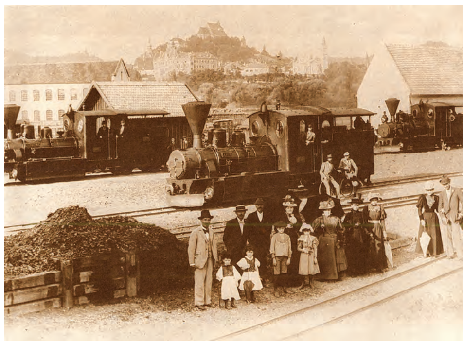
Stația Sighișoara, la 1898, a liniei înguste Sighișoara-Agnita (51 km; dată în exploatare la 17 noiembrie 1898); în stație, figurează primele 3 locomotive ale liniei Sighișoara-Agnita, de tip C-n2 (WrN; nr. de fabricație 3.896/1896-3.898/1896), care au purtat numerele și numele de 1-„APOR”, 2-„ZENT ÁGOTA” și 3-„SEGESVÁR” și care au fost înseriate MÁV 388.001-003. Locomotivele MÁV 388.001 și MÁV 388.003 au fost utilizate în Serbia, ca locomotive k.u.k. HB și, după război, au fost încadrate în Iugoslavia, în seria JDŽ 182.001-002. Locomotiva MÁV/CFR 388.002 a fost preluată, după Primul Război Mondial, de CFR, și a fost utilizată pe linia Sighișoara-Sibiu până la 1 iunie 1965.
