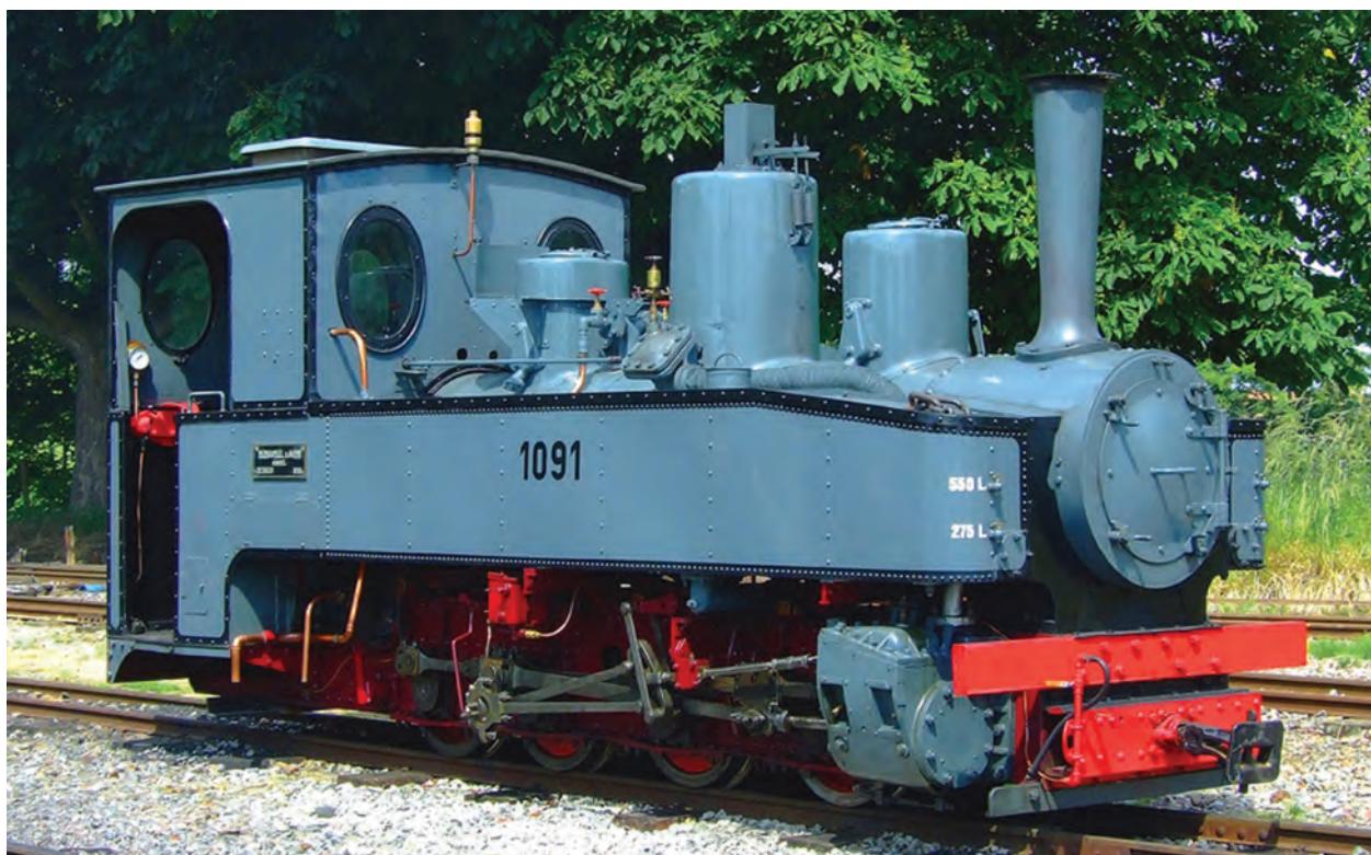
Locomotiva-tender „brigadelok” Deutsche Feldbahn Ersatzpark Berlin Nr.1.091 tip D-n2t (Henschel & Sohn, Kassel; nr.de fabricație 15.968/1918), expusă recondiționată în Anglia, la North Gloucestershire Narrow Gauge Company, Toddington. Dintre locomotivele „brigadelok”, livrate de Henschel în perioada 1916-1918, au fost utilizate pe linii forestiere din România locomotivele k.u.k.HB 662-663, 1.548, 2.345 și 2.566, printre care au figurat CFF 604.101, CFF 604.203 și CFF 604.212.
