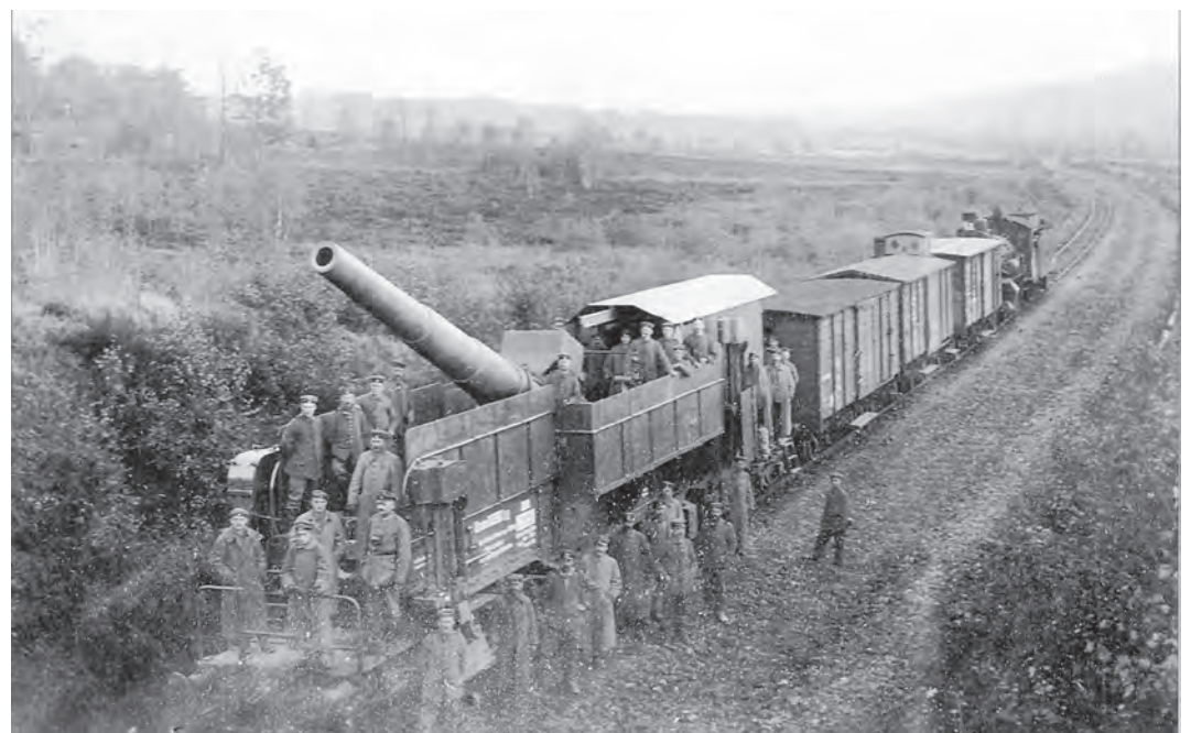
Un tun feroviar german tip 24 cm S.K.L/40 de 238 mm și trenul cu care acesta se deplasa: până la încheierea armistițiului, de la 17 noiembrie 1918, au fost livrate de firma Krupp un număr de 34 unități.
