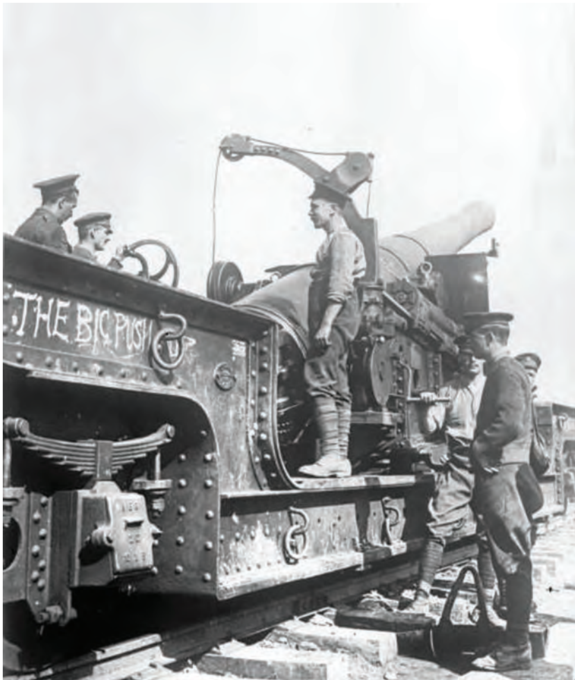
Tunul britanic The Big Pusch de 233,7 mm (BL 9,2 inch Railway Gun Mk III și MKVI), utilizat în septembrie 1916 la Maricourt (Somme). În perioada 1915-1916, 9 tunuri navale britanice de 9,2 inch. au fost montate pe vagoane platformă, pe 4 sau pe 6 osii, de către Armstrong (Elswick Ordnance Company).
