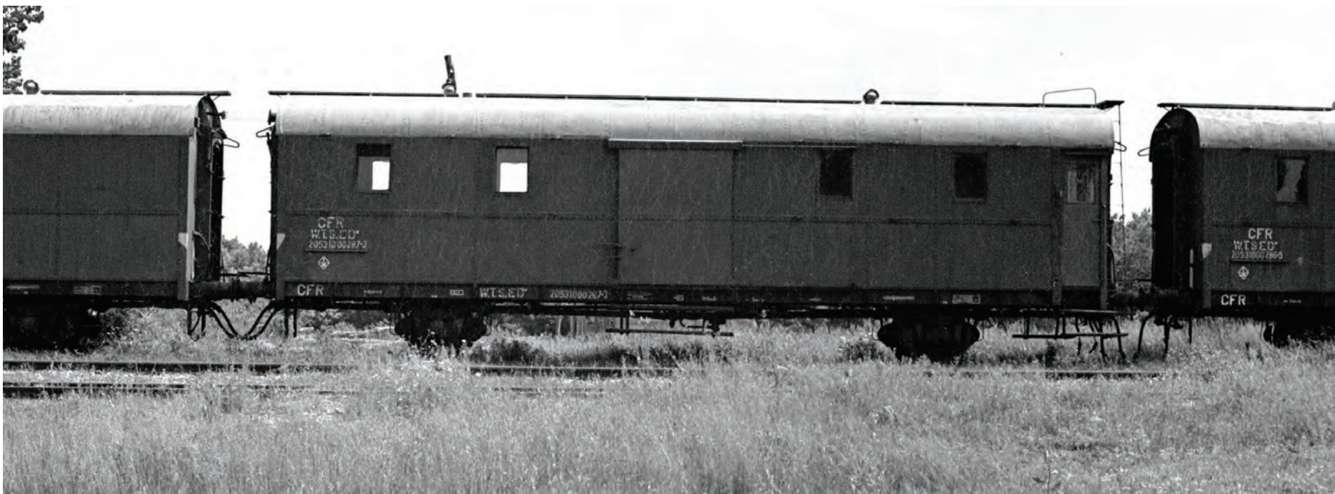
Două vagoane sanitare-uzină electrică, CFR WTSEDW 20 53-1000-287-3 și CFR WTSEDW 20 53-1000-286-5, surprinse, la 1 iunie 1980, în stația Snagov: au fost livrate, în 1933, de ASTRA-Arad și au fost încadrate, inițial, în seria GDDFW208.000. Aveau lungimea peste tampoane de 13.440 mm, ampatamentul de 7.480 mm, tara de 16,32 tone, încărcătura de 14 tone și viteza maximă de 80 km/h..
