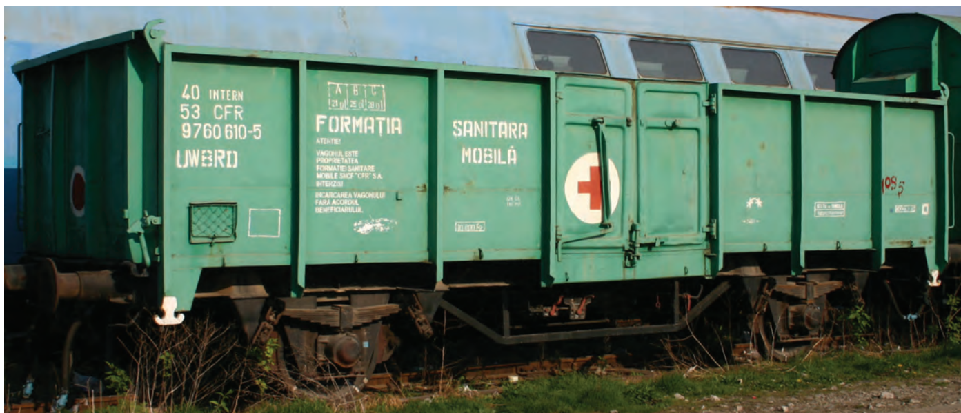
Vagonul CFR UWB RD 40.53-9760-610-5, pe două osii, pentru transportul cărbunilor (CFR Es-x): avea ampatamentul de 5.400 mm, tara de 10,80 tone și capacitatea de încărcare de 21 tone.
