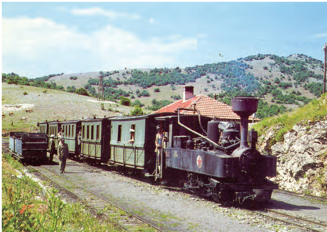
Locomotiva-tender JDŽ 99.4.-104 tip D-n2t (Brigadelok.) remorcând un tren personal, în Macedonia, la 26 iulie 1959, lângă pasul Bukovik (altitudine 1200 m; km 44) pe linia, de ecartament îngust (ec. 600 mm), Gostivar-Ohrid (167 km).
