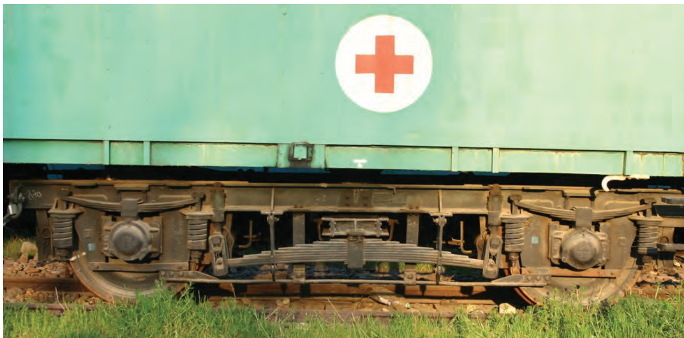
Un boghiu tip Görlitz III ușor (ampatament 3.000 mm) care echipa o parte din vagoanele sanitare CFR de construcție germană, rezultate din amenajarea vagoanelor germane de clasa a III-a pe 4 osii, DR C4ü-36: în anul 1937, firma Westdeutsch Waggonfabrik a livrat 71 de vagoane de clasa a III-a, C4ü-36 Nr.17.140-17.190 și C4ü-36 Nr.10.009-19.028, dintre care câteva au revenit CFR.
