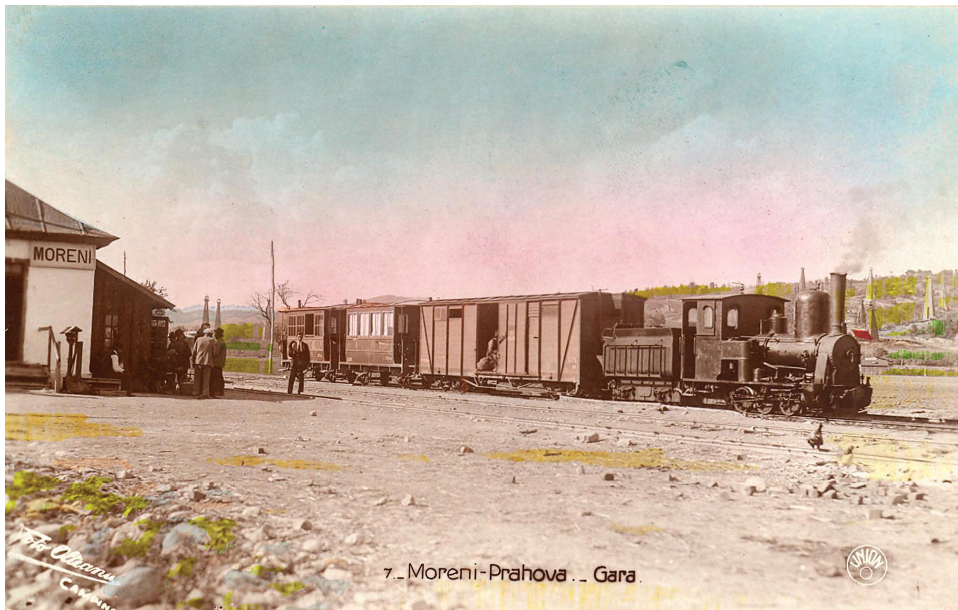
Gara Moreni-Prahova la 1923: un tren mixt al căii ferate înguste, de 750 mm, Băicoi-Moreni (21,5 km), remorcat de locomotiva germană k.u.k. HB Nr.2.658 tip C-n2t + T și având în compunere un vagon de bagaje și mesagerie („Modell 18”) și două mici vagoane de călători de tip salon („Glaswagen”).
