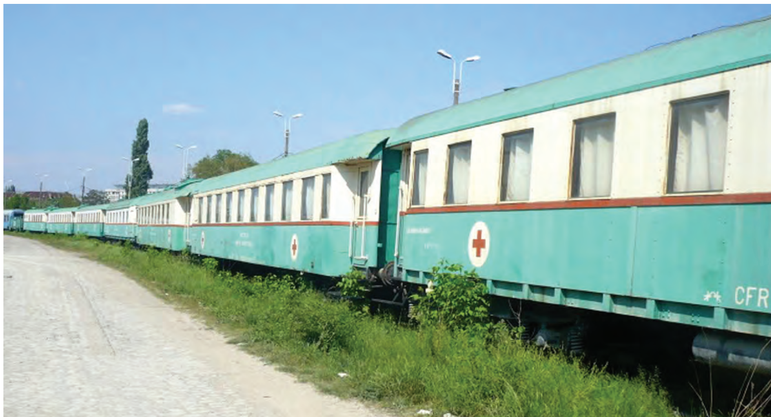
Vedere generală a trenului sanitar CFR, din stația București Basarab, care avea în compunere 10 vagoane sanitare (7 se văd în imagine), pe patru osii, din perioada 1934-1937, echipate cu boghiuri de tip austriac, de tip Görlitz III ușor și de tip Görlitz III greu, precum și un vagon descoperit, pe două osii, pentru transportul cărbunilor.
