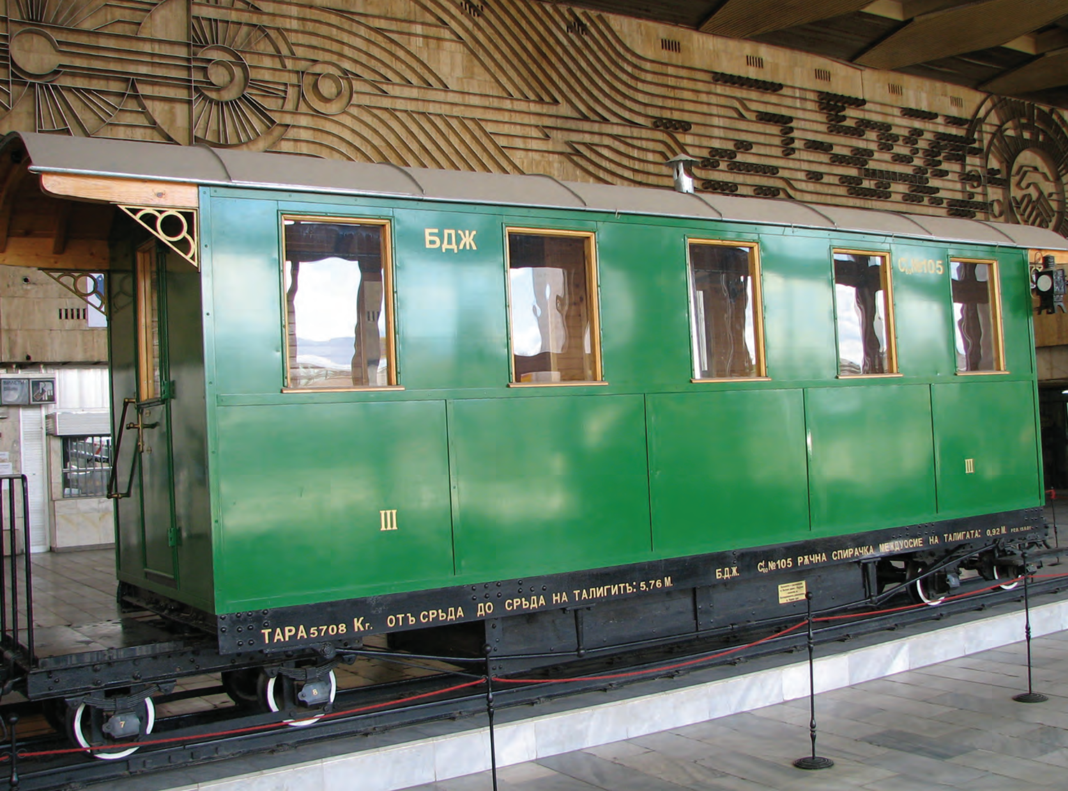
Vagonul BDZ C460 Nr.105 (Smoschewer-Breslau; fabricație 1925), pe patru osii și cu o capacitate de transport de 22 locuri clasa a III-a, care a fost utilizat, în perioada 1925-1960, pe linia îngustă Rila-Mănăstirea Rila (ecartament 600 mm). Vagoane de clasa a III-a asemănătoare au fost utilizate în Primul Război Mondial pentru transportul trupelor bulgare și germane.
