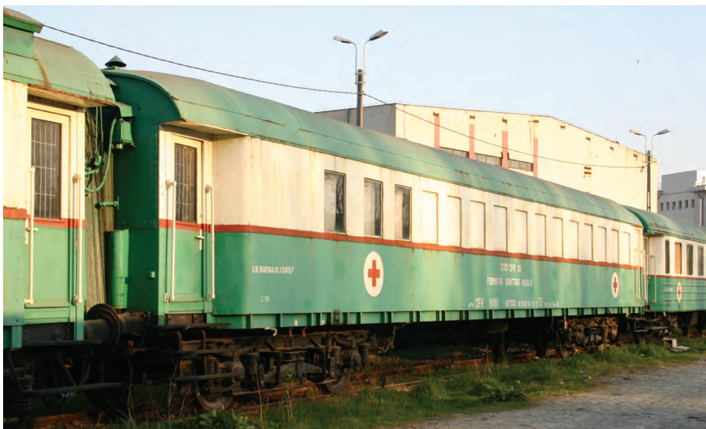
Vagonul sanitar CFR UWTS AE 80.53-9760-103-2, de construcție germană, pe patru osii, cu boghiuri de tip Görlitz III ușor (ampatament 3.000 mm): după reconstrucția din 1966 avea lungimea peste tampoane de 21.860 mm, distanța între axele boghiurilor de 14.060 mm și tara de 44 de tone.
