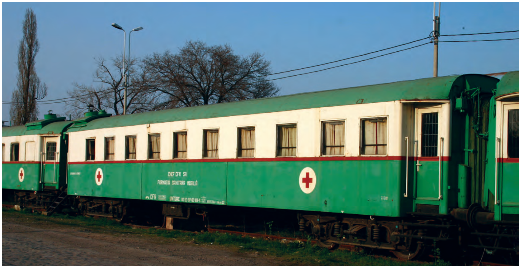
Vedere laterală a vagonului-sanitar CFR UWTSAE 80.53-9760-108-1 pe patru osii, echipat cu boghiuri de tip austriac, cu ampatamentul de 2.500 mm, livrat în 1936 de ASTRA-Arad și reconstruit în 1966 de Uzinele „Grivița Roșie” din București: după reconstrucție, avea lungimea peste tampoane de 21.860 mm și distanța între axele boghiurilor de 14.060 mm..
