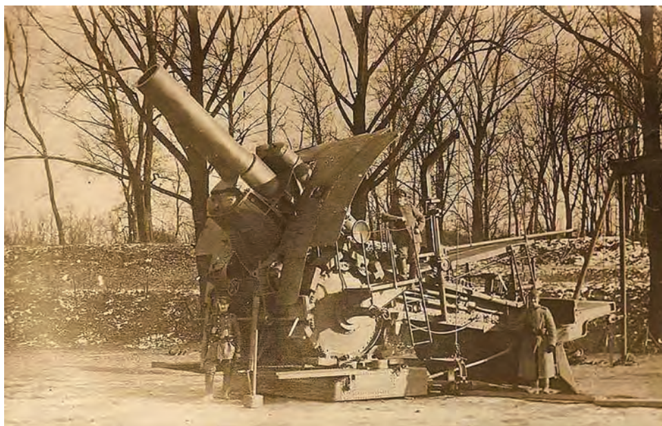
O piesă «Dicke Bertha» prevăzută cu roți cu bandaj tip «șenilă».
