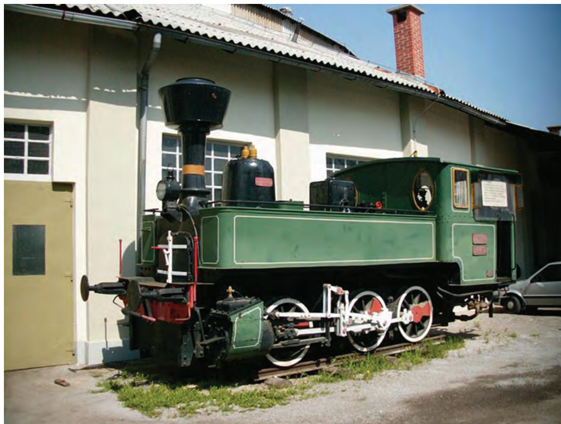
Locomotiva-tender JDŽ/JŽ 150.003 / ex. kkStB 97.69 tip C-n2t (StEG; nr. de fabricație 2.352/1893 ), aflată, astăzi, în patrimoniul Muzeului Căilor Ferate Slovene din Ljubljana.
