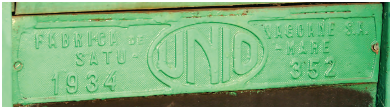
Placa de fabricație a vagonului sanitar CFR UWTSAE 80.53-9760-107-8: „UNIO” Fabrica de Vagoane S.A -Satu Mare Nr.352/1934.
