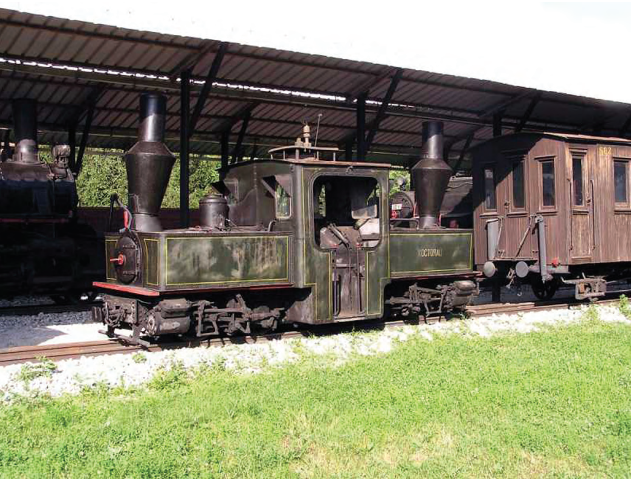
Locomotiva-tender articulată „Péchet-Bourdon” tip B-B-n4t, expusă, astăzi, la Muzeul Căilor Ferate de la Požega (Serbia, la 176 km de Belgrad, pe linia Belgrad-Požega-Podgorica-Bar/580 km).
