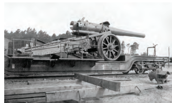
Un tun feroviar german tip 15 cm SK - „Nathan” de 149,1 mm, amplasat pe un vagon platformă pe 4 osii: avea o greutate totală de 55,5 tone și a constituit primul tip de tunuri feroviare germane (Eisenbahngeschütze), fiind livrat, în 21 de unități, în perioada 1914-1918, de firma Krupp.
