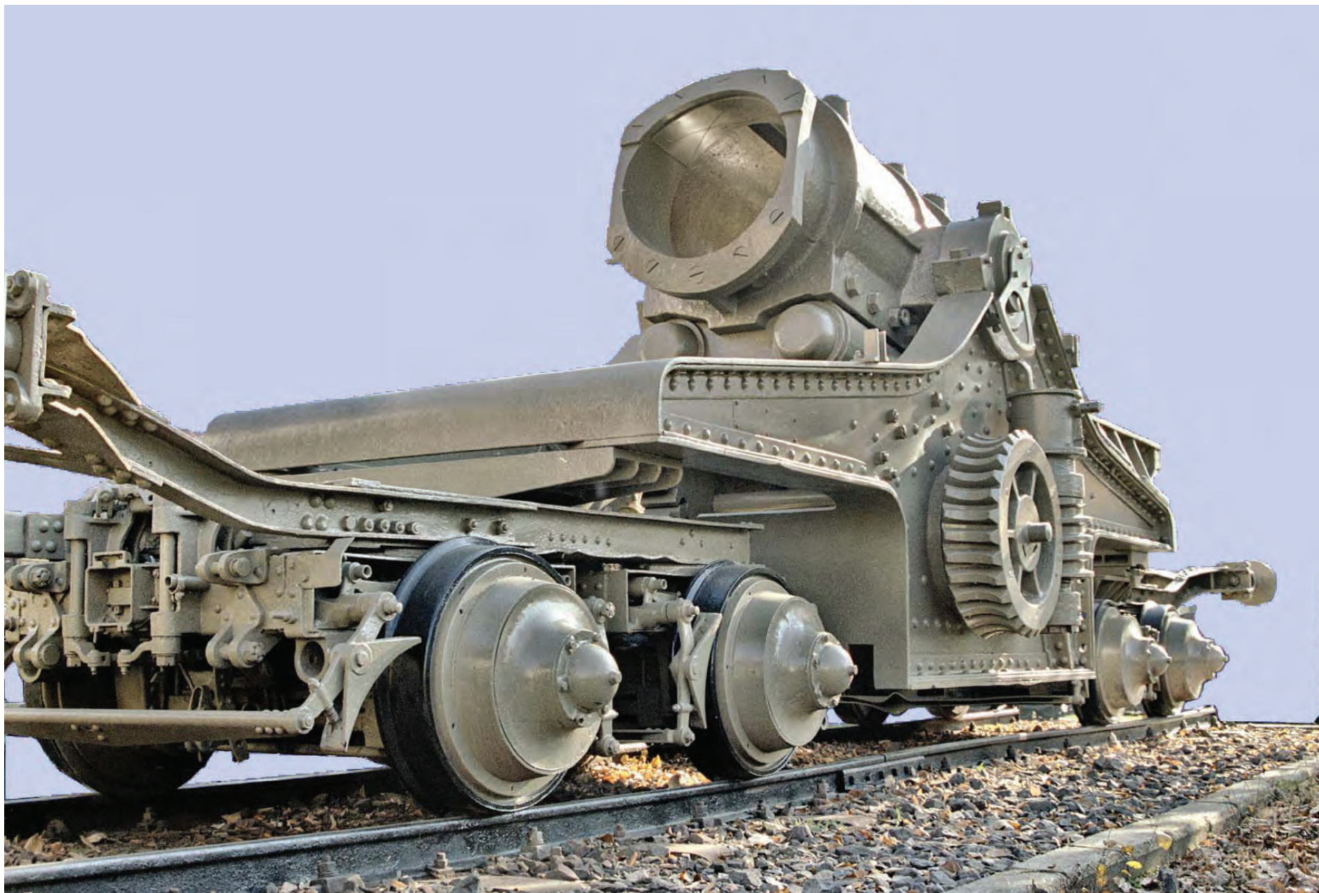
Vagonul port-afet al obuzierului de 420 mm (Nr. 7, fabricație Skoda Werke-Pilsen 1916), expus, astăzi, în cadrul Muzeului Militar Național „Regele Ferdinand I”. Un obuzier de 420 mm avea greutatea de 112,7 tone și pentru a putea fi transportat era împărțit în 6 module pentru transportul pe șosele (țeava, afetul, două părți ale platformei și două părți ale plăcii turnante) și în 4 module pentru transportul pe calea ferată și anume: țeava obuzierului cu închizătorul, de 25,9 tone, afetul cu leagănul, de 23,8 tone, cele două părți, stânga și dreapta, de 32,1 tone și 30,9 tone, ale platformei și plăcii turnante.
