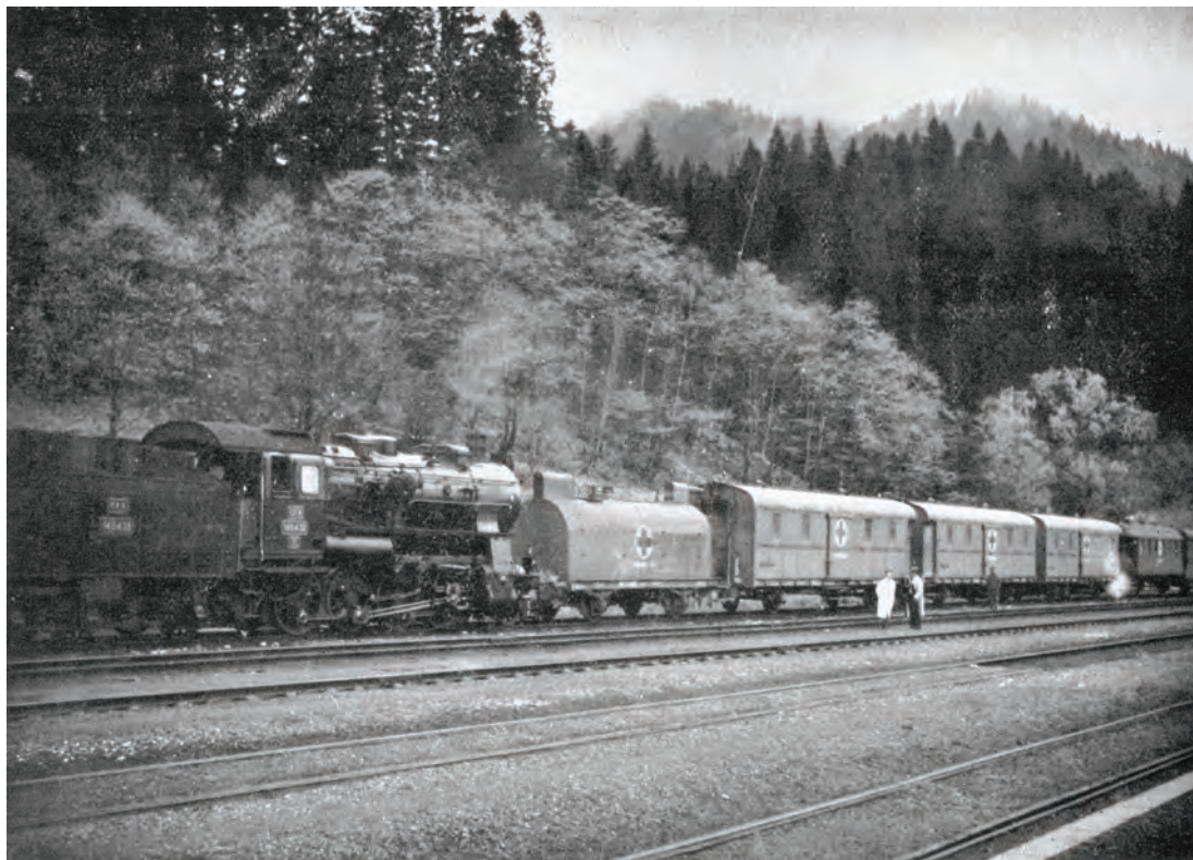
Un tren-baie CFR, surprins în 1939: avea în compunere locomotiva CFR 140. 432 tip 1D-h2 (Henschel & Sohn, Kassel; nr. de fabricație 18.566/1921), după care urmează vagonul cisternă, vagonul-baie, amenajat cu dușuri vagonul-etuvă, vagonul-garderobă și vagonul de dormit cu cabine pentru personalul trenului-baie și instalația electrică.
