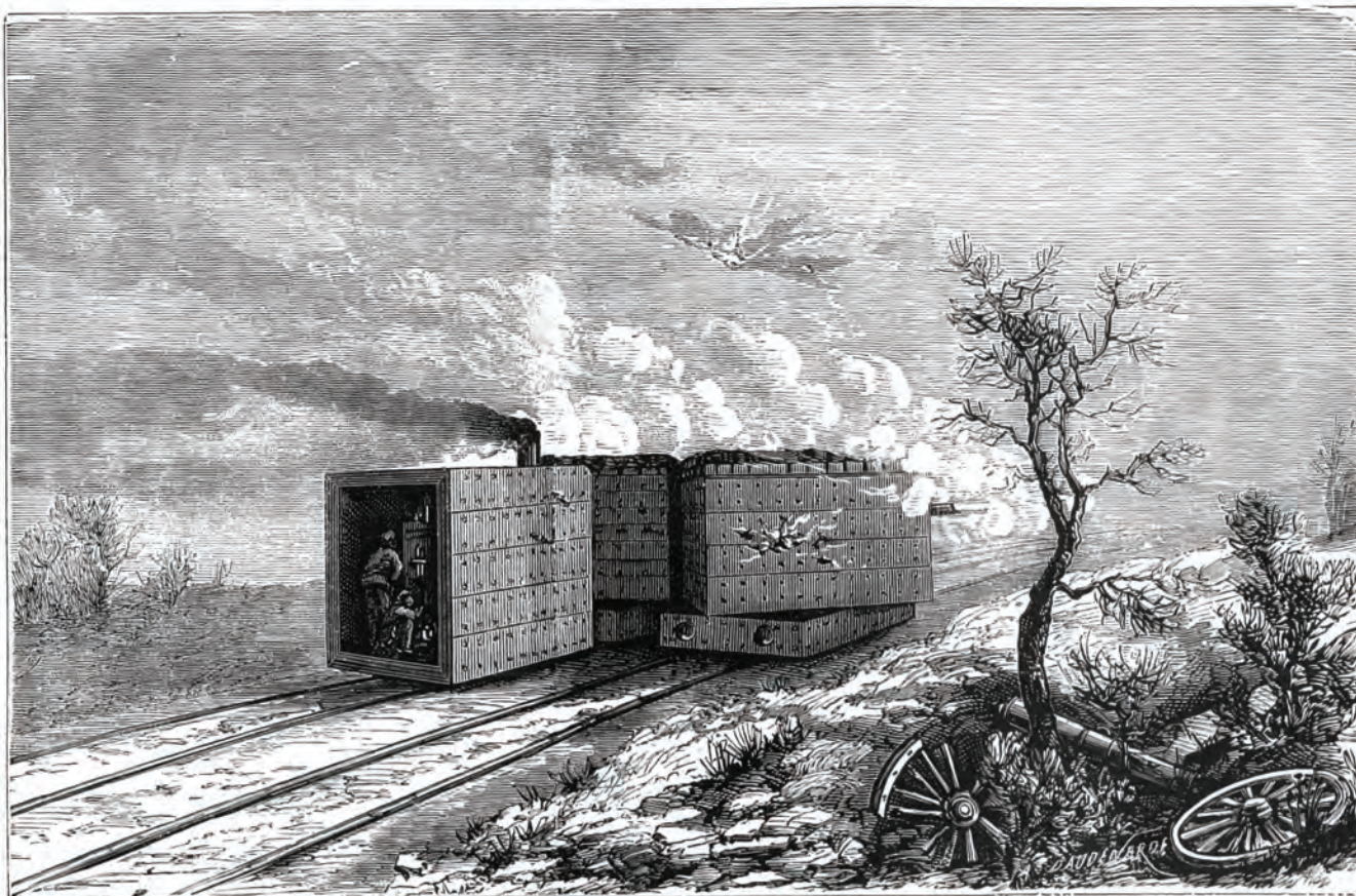
Baterie mobilă franceză, constituită din două vagoane port-tun de 160 mm, legate între ele cu lanțuri, care acționau pe două linii paralele de cale ferată și care a fost utilizată, la sfârșitul anului 1870, la apărarea Parisului și la atacul pozițiilor prusace de la Choisy-le-Roi (la 10,7 km de centrul Parisului). În partea din spate a dispozitivului de artilerie, pe prima linie, se observă locomotiva blindată specială, obținută prin transformarea unei locomobile.
