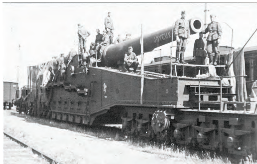
Un tun francez A.L.V.F. de 305 mm („JOYEUX”: tip 305 Mle 06/10), cu o greutate totală de 208 tone și care era dispus pe două boghiuri a câte șase osii. Imaginea datează din anul 1942 când tunul fusese preluat de armata germană, împreună cu alte 20 de unități A.L.V.F. de calibre 305, 320, 340, 370 și 520 mm (unul dintre cele două tunuri gigant Schneider-Le Creusot; fabricație 1918).
