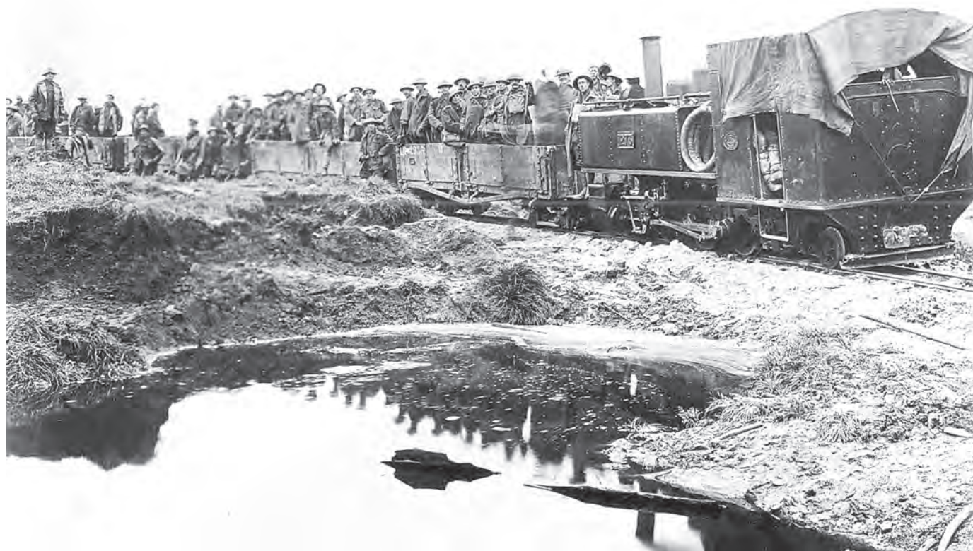
Locomotiva-tender militară Nr.1.273 tip1C1-n2t (ALCO; fabricație 1917) cu un tren cu soldati australieni participanți la bătălia de la Ypres (Flandra de Vest; Belgia ).
