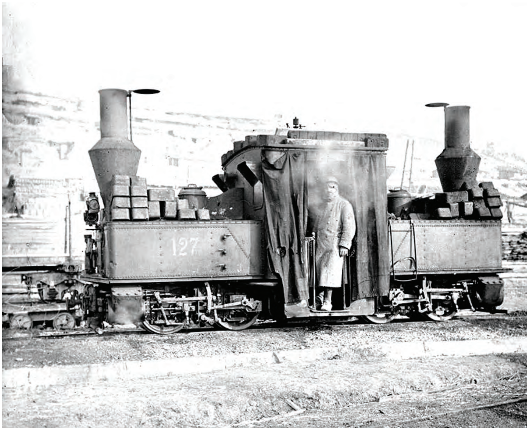
Locomotiva-tender articulată „Péchet-Bourdon” Nr.127 tip B-B-n4t, de construcție americană, surprinsă în ianuarie 1917 la Marson (Marne): se observă perdelele marchizei utilizate pentru mascarea luminozității produse de arderile din focarul central al locomotivei, precum și brichetele mari de cărbune care erau dispuse pe orice spațiu disponibil.
