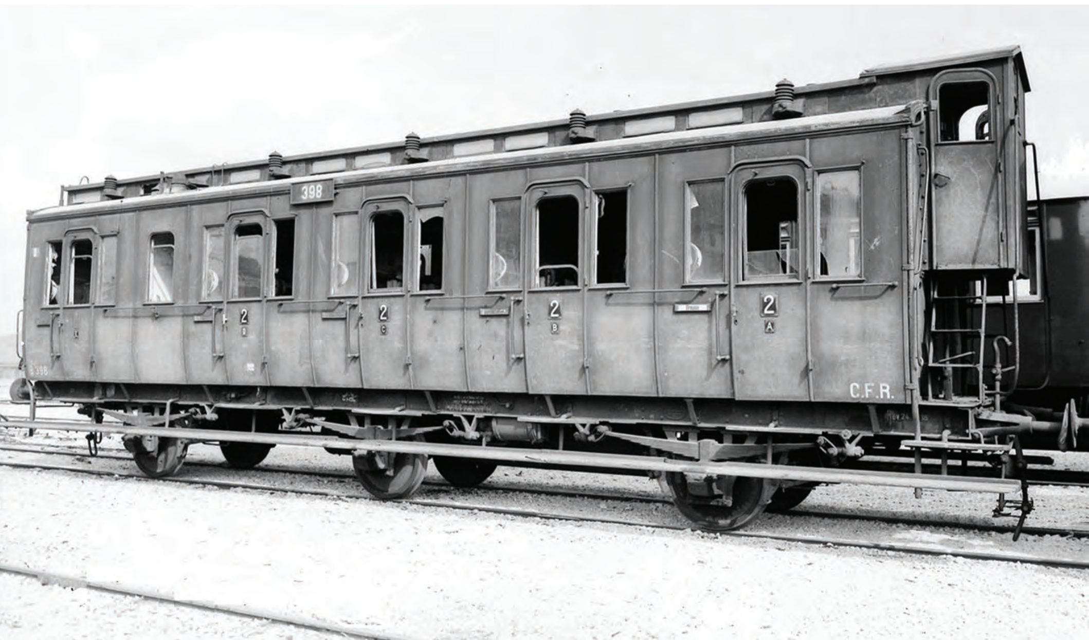
Vagonul de clasa a II-a, pe 3 osii, CFR B 398 (ulterior, înseriat CFR BL 69.256): era un vagon prusac (F.Ringhoffer, fabricație 1907), cu 5 compartimente / 32 de locuri cl. a II-a, cu uși laterale, ampatamentul de 6.500 mm și tara de 20,48 tone. A fost utilizat la transportul trupelor germane, în România, și după Primul Război Mondial a revenit CFR, fiind apoi trimis la reparații la fabrica din Nesselsdorf (astăzi, Koprivnice). A fost repartizat stației Buzău și avea ca, ca atelier de zonă, Atelierele de Reparații Iași.
