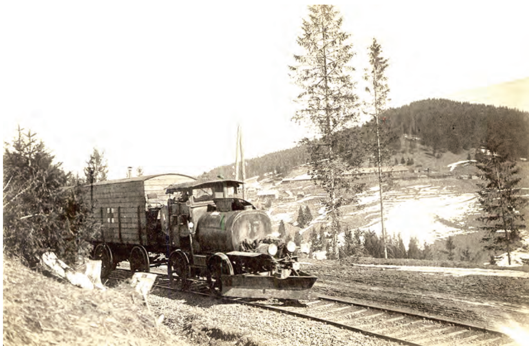
Un tren sanitar al liniei Dornișoara-Tiha Bârgăului, remorcat în primăvara anului 1916 de vagonul-generator tip 1-A / 1914 Nr. 15, prevăzut încă, cu un plug de zăpadă.
