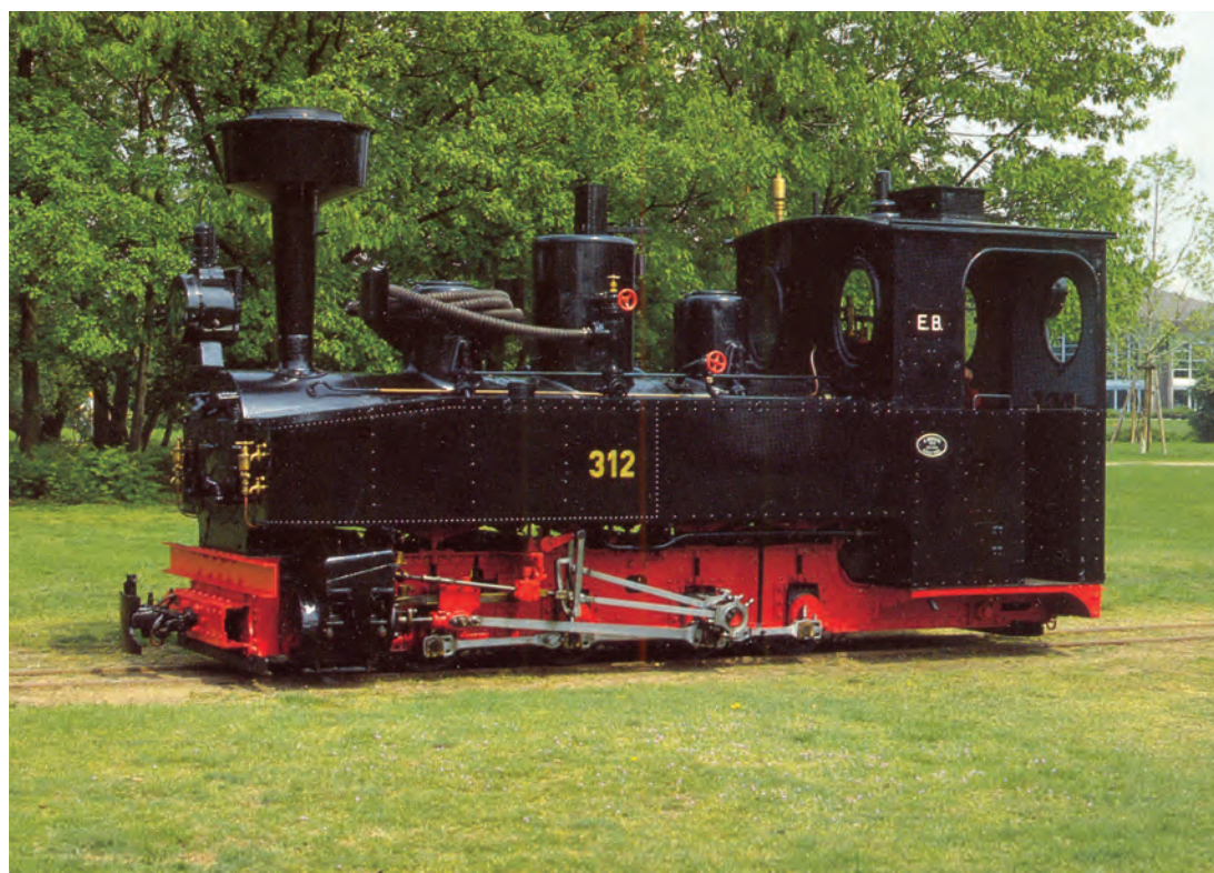
Locomotiva-tender Deutsche Feldbahn Klausdorf Nr.312 tip D-n2t (Borsig; nr.de fabricație 8.936/1914), expus, recondiționată, la Frankfurter Feldbahnmuseum din Frankfurt am Main.
