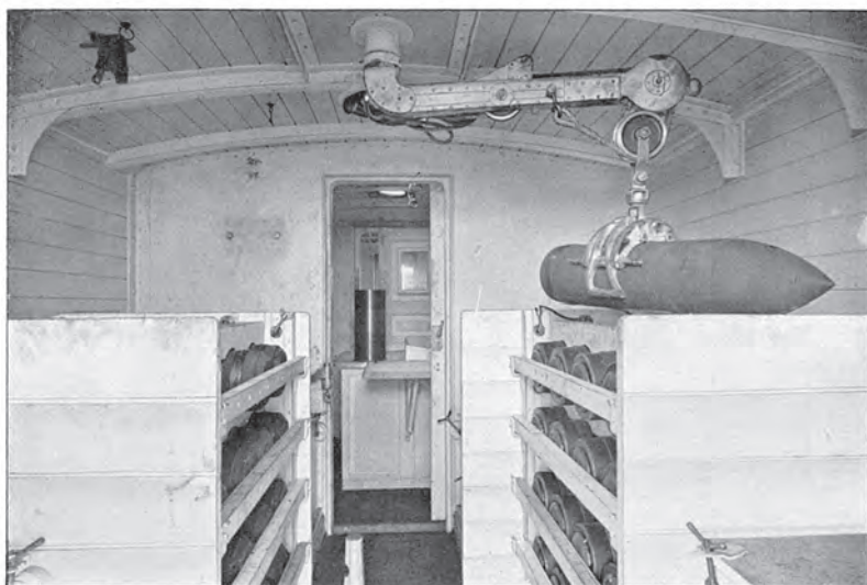
Vedere interioară a vagonului de muniție al bateriei mobile Schneider: se observă modul de manipulare al proiectilelor cu o greutate de 100 kg.
