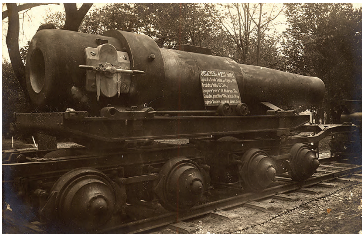
O altă imagine, din 1919, a vagonului port-țeavă al obuzierului, de 420 mm, Nr.7: pe placa de prezentare figurează „Obuzier de 420 mm Skoda, capturat de Armata Română de la unguri în 1919. Lungimea țeavii -6,29 m. Montarea obuzierului durează 25 ore”.
