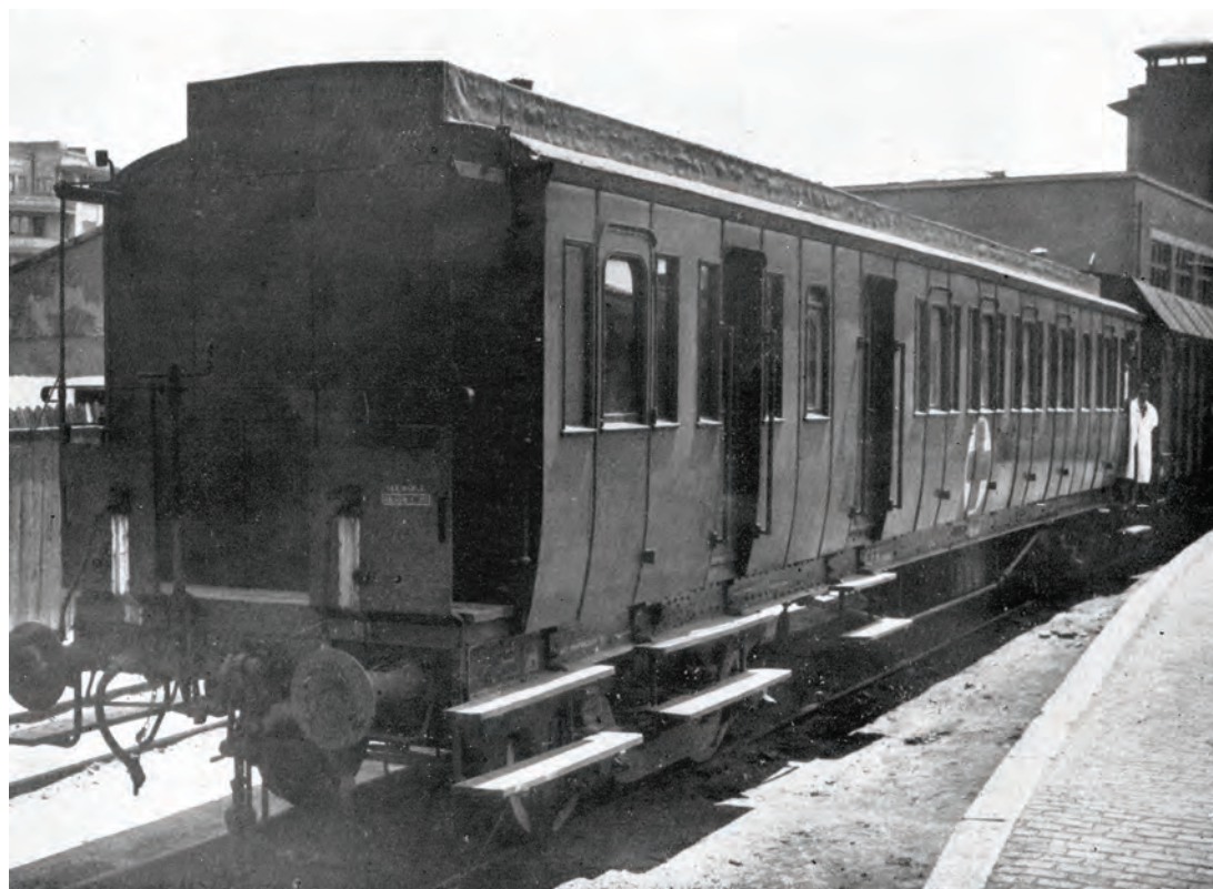
Vagonul sanitar CFR Nr. 212/Nr. 12 surprins în 1940 în București-Gara de Nord: a fost amenajat de Atelierele București-Grivița, prin transformarea unui vagon prusac de călători pe patru osii și uși laterale, intrat în parcul CFR după Primul Război Mondial.
