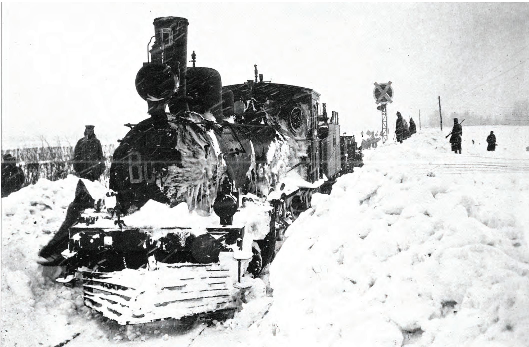
Un tren militar german blocat în nămeți, în dificila iarnă a anilor 1916-1917, pe linia Ploiești-Buzău: era remorcat de o locomotivă cu trei osii cuplare, tip C-n2, din seria CFR 597-680 (fabricație 1890-1893). Pentru a evita blocarea liniilor pe perioada iernii, trupele germane aveau să aducă în România mai multe pluguri de zăpadă în vara anului 1917.
