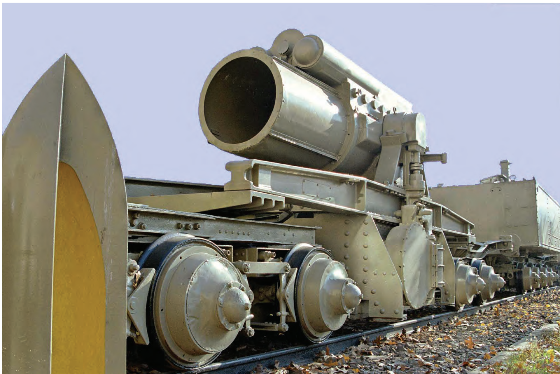
Vagonul port-afet al obuzierului de 380 mm (Nr. 2 GUDRUN, fabricație Skoda Werke-Pilsen 1916), expus, astăzi, în cadrul Muzeului Militar Național „Regele Ferdinand I”. Un obuzier de 380 mm avea greutatea de 81,7 tone și pentru a putea fi transportat era împărțit în 4 module, și anume: țeava obuzierului cu închizătorul, de 20,7 tone, afetul cu leagănul, de 17,6 tone și cele două părți, de 21,2 tone și 22,2 tone, ale chesonului-bază cu placa turnantă.
