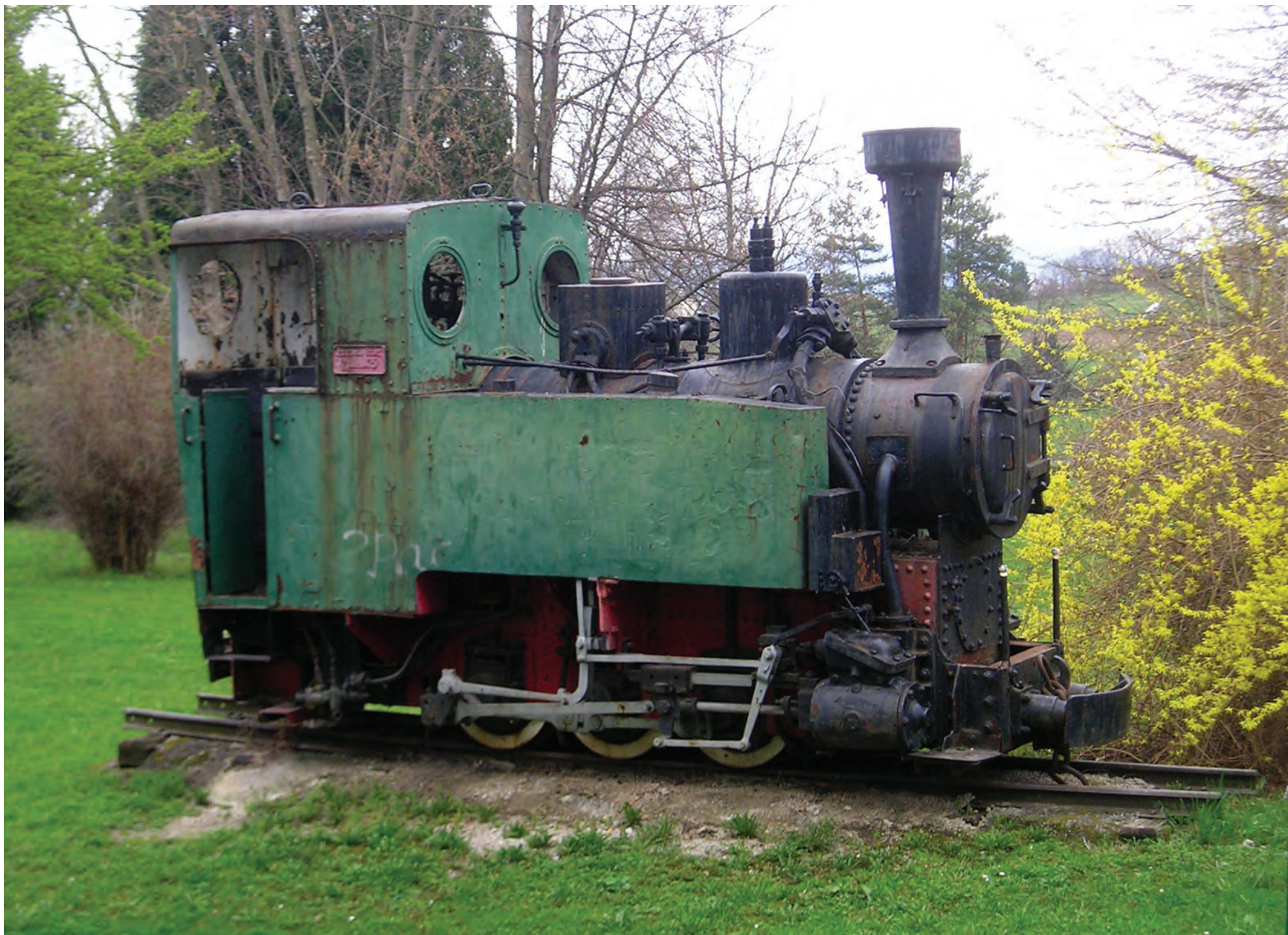
Locomotiva-tender k.u.k.Heeres-Rollbahnen R III c 138 tip C-n2t (ec 600 mm) din seria R III c 131-R III c 155 (WLF, Floridsdorf; nr.de fabricație 2.559/1918-2.584/1918): după Primul Război Mondial, locomotiva R IIIc 138 (WLF, Floridsdorf; nr. de fabricație 2.566/1918) a rămas în Slovenia, fiind utilizată pe linii industriale, iar astăzi este expusă în parcul orașului Štore (Slovenia).
