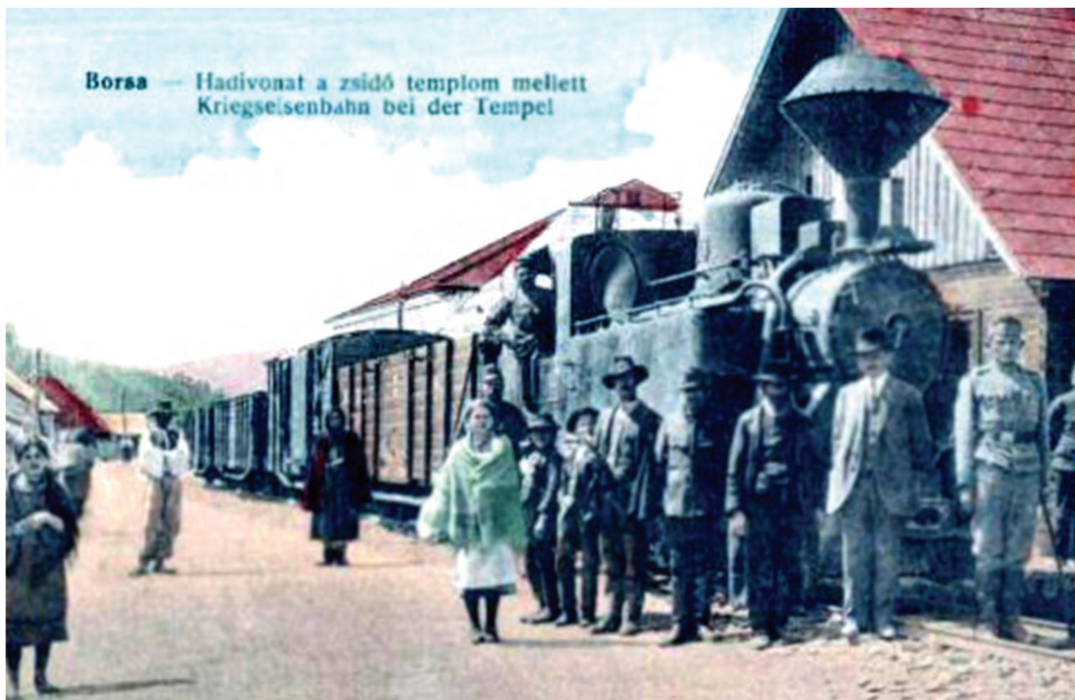
Un tren militar al liniei Prislobbahn (Borșa-Iacoveni), denumită linie de război („Kriegeisenbahn”), remorcat la Borșa, în anul 1916, de o locomotivă-tender tip D-n2t din seria k.u.k. HB IVa 4 4.001-4.021 (Bp/Budapesta; fabricație 1914-1915; ulterior, seria MÁV 492.950).
