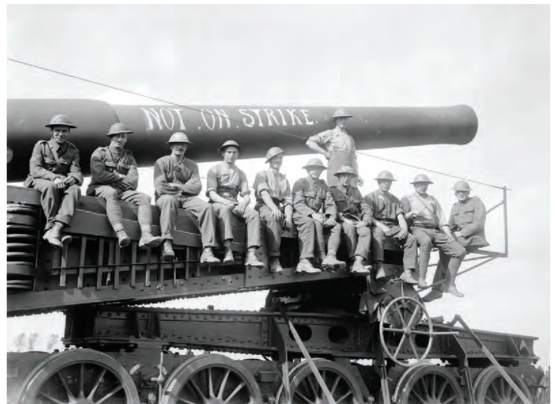
Un tun britanic tip BL 12 inch Railway Gun Mk IX de 304,8 mm, amplasat la 23 august 1917 lângă Ypres (Belgia, Flandra de Vest): pentru realizarea a 4 tunuri feroviare de acest tip s-au utilizat tunuri livrate de Woolwich Arsenal (fabricație 1906), care au fost montate, de Vickers Works și Armstrong (Elswick Ordnance Company), în anul 1915, pe vagoane platformă pe 10 osii.
