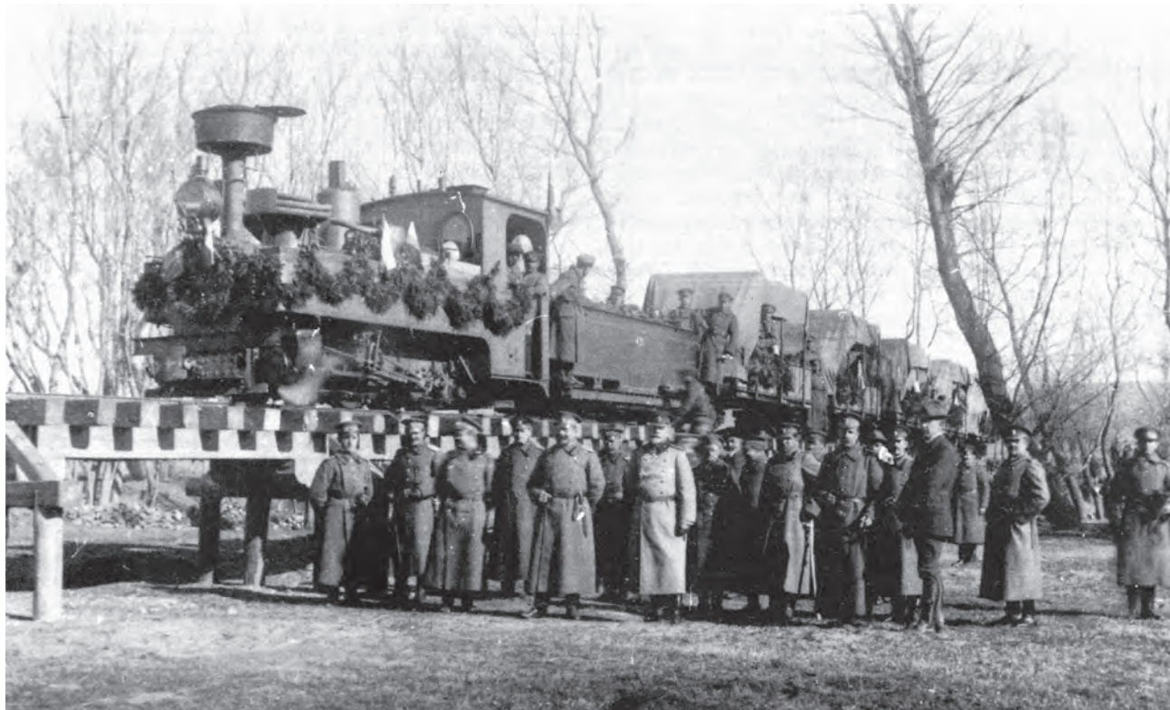
Una dintre primele locomotive-tender tip D-n2t („Brigadelok”), utilizată în timpul Primului Război Mondial pe liniile Decauville din Bulgaria.
