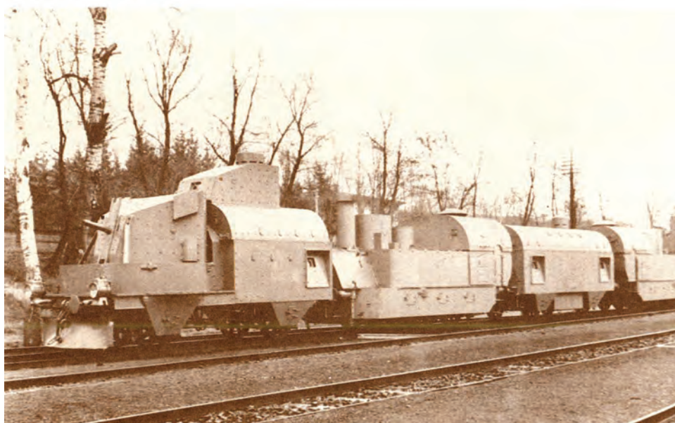
O imagine a trenului blindat austro-ungar Nr. VIII, surprinsă la scurt timp după livrarea acestuia, la 15 februarie 1915, de Atelierele MÁV-Nord. Tracțiunea era asigurată de două locomotive-tender tip C-n2t din seria MÁV 377, și anume de locomotivele MÁV 377.117 (MÁV 5.297, StEG, nr. de fabricație 2.238/1891) și MÁV 377.131.
