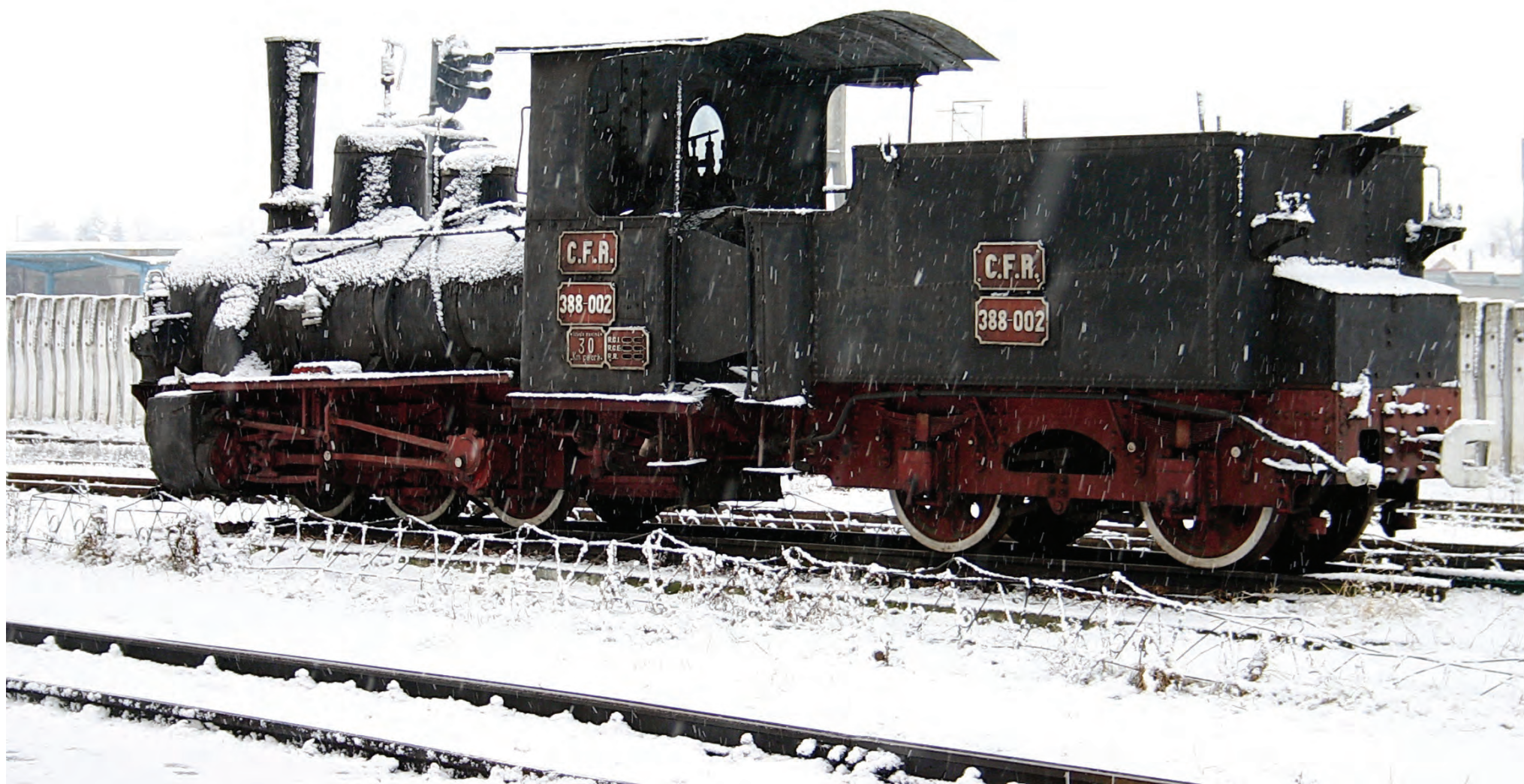
Locomotiva cu tender separat MÁV/CFR 388.002 tip C-n2 (WrN; nr. de fabricație 3.897/1896), de ecartament îngust (760 mm), a liniei Sibiu-Sighișoara (NszSv / Nagyszeben-Segesvári helyi érdekű vasut r.t.; a fost utilizată în perioada 1896-1965 pe linia Sibiu-Sighișoara, iar astăzi este păstrată la sucursala din Sibiu a Muzeului Căilor Ferate Române.
