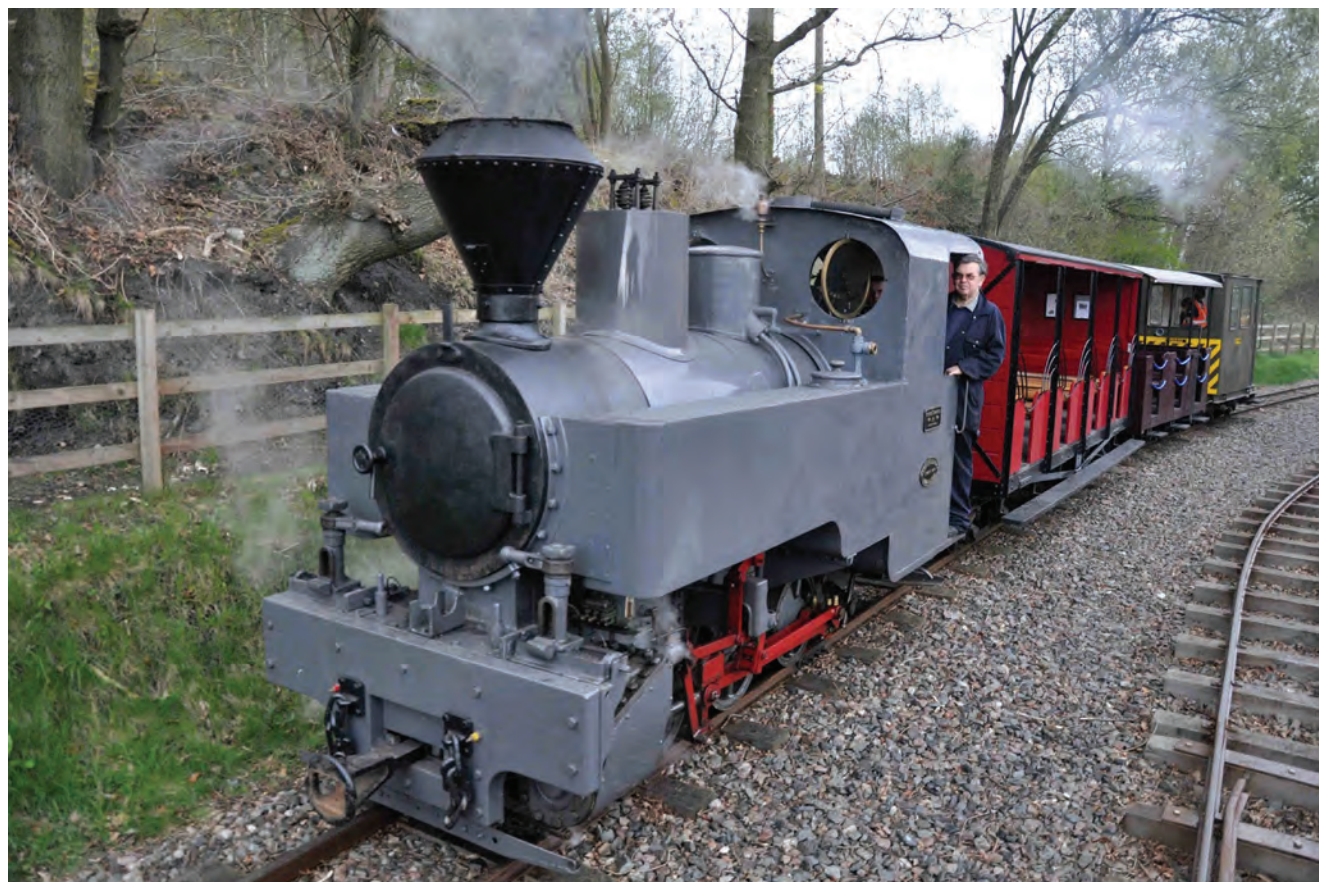
Locomotiva-tender Joffre Class (Kerr-Stuart; nr.de fabricație 3.014/1916), păstrată astăzi pe linia britanică Apedale Valley Light Railway: avea diametrul cilindrilor de 216 mm, cursa pistonului de 279 mm, diametrul roților motoare și cuplare de 600 mm, timbrul cazanului de 12,5 kgf/cm 2 , suprafața grătarului de 0,37 m 2 , suprafața totală de încălzire de 17,54 m 2 , dimensiunile de gabarit de 4.728 x 1.619 x 2.597 mm, greutatea locomotivei nealimentate de 8,3 tf, greutatea locomotivei în serviciu de 10,57 tf. și forța de tracțiune de 1.752 kgf. Putea prelua 12 m 3 de apă și 0,5 tone de cărbune.
