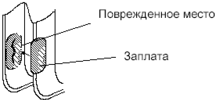
Рисунок 5.8 – Ремонт поврежденного материала кожуха
