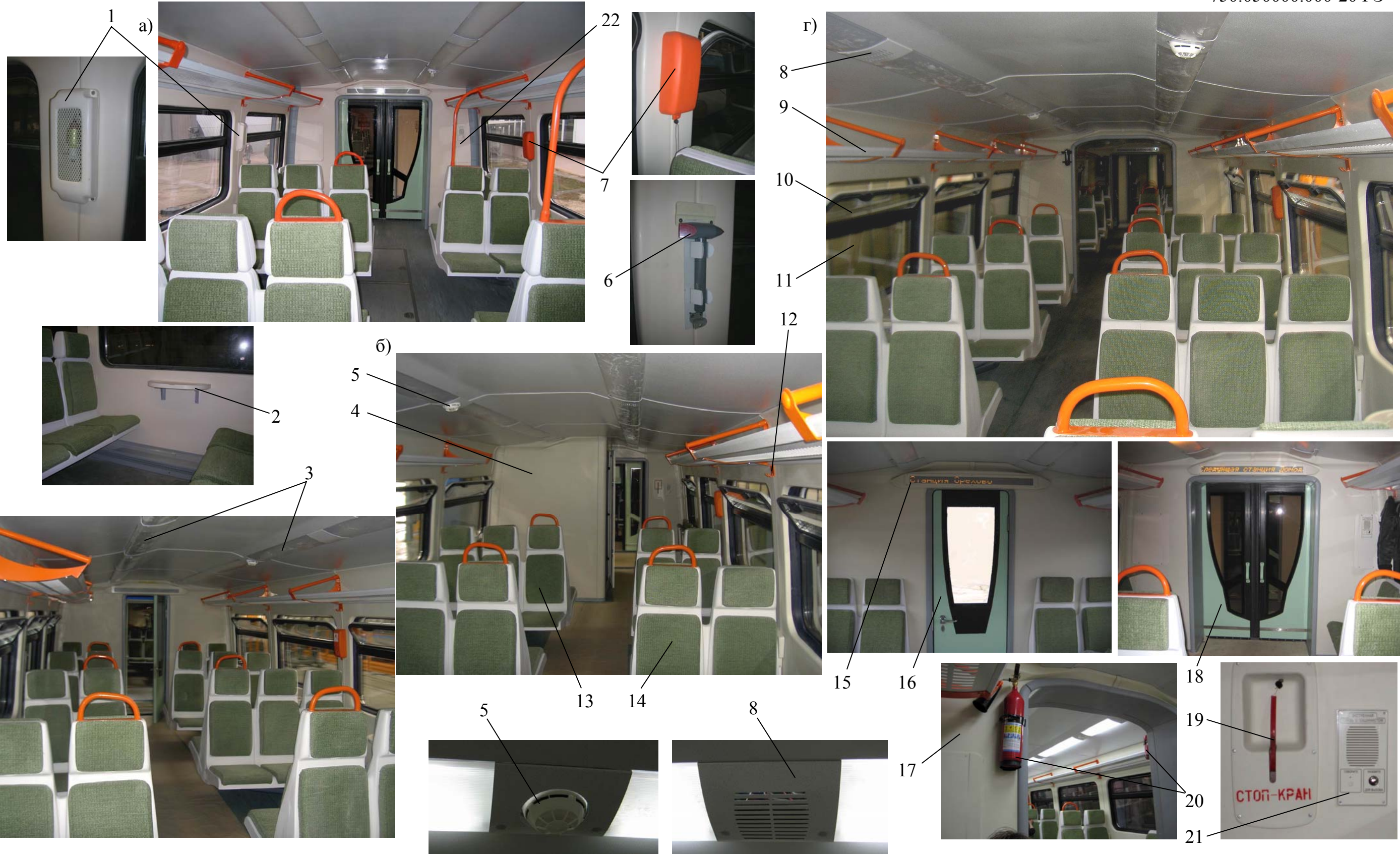
а),б),в) головной вагон; г) прицепной безмоторный вагон 1 – кожух датчика температуры; 2 – столик; 3 – модули световые комплекса «Световая линия»; 4 – санитарный блок; 5 – извещатель (датчик) пожарный комбинированный; 6 – молоток; 7 – кожух молотка; 8 – громкоговоритель; 9 – багажная полка; 10 –форточка; 11 – окно салона (стеклопакет); 12 – крючок для одежды; 13 – трехместное пассажирское кресло; 14 – двухместное пассажирское кресло; 15 – информационное табло; 16 – дверь перехода в другой вагон; 17,22 – средние перегородки; 18 – раздвижные двери; 19 – стоп-кран; 20 – огнетушители; 21 – блок экстренной связи
