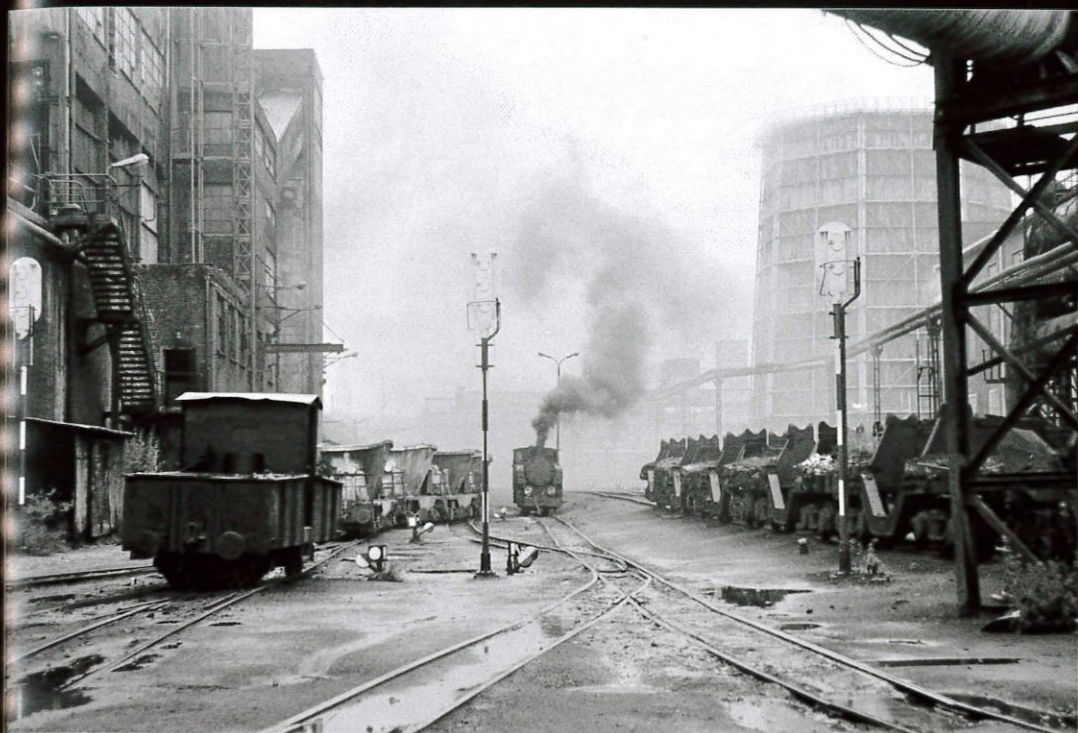
Chorzów. Huta „Kościusko”. Parowóz nr 3 13953 manewruje podczas zestawiania składu z kadzi do płynnego żużlu. 21.06.1991 r.
