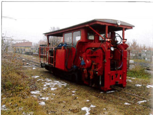
Podbijarka torowa na stacji w Śmiglu. Widoczne haki i kleszcze służące do ustawiania toru. 11.11.2016 r.
