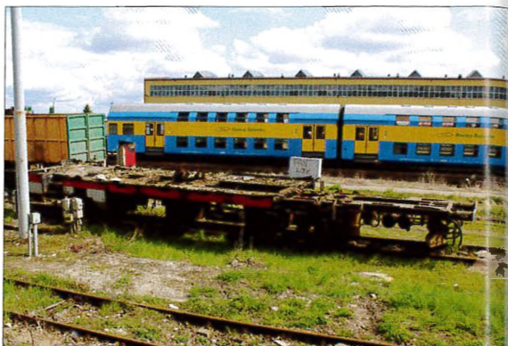
Chojnice. Ciecie szynobusu SA101-003, na zdjęciu ostoja członu silnikowego. 29.04.2017 r.
