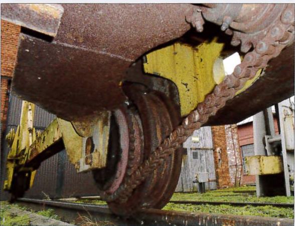
Jeden z dwóch mechanizmów jazdy suwnicy – widok od zewnętrznej strony. 04.02.2016 r.
