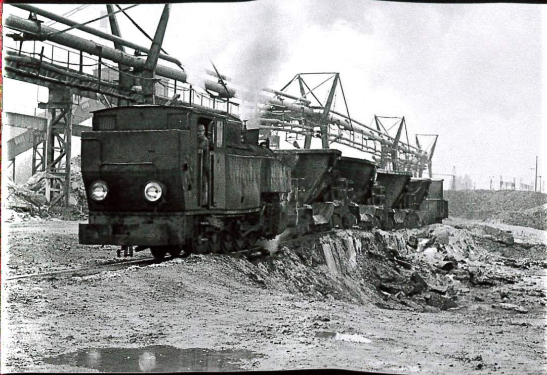
Pociąg z parowozem nr 3 13953 po opróżnieniu kadzi do przewozu płynnego żużla. Huta „Kościszko” w Chorzowie. 21.06.1991 r.
