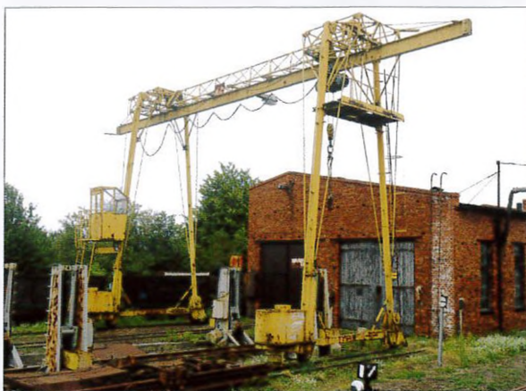
Samomontująca suwnica bramowa na stacji w Śmiglu. 12.07.2015 r.
