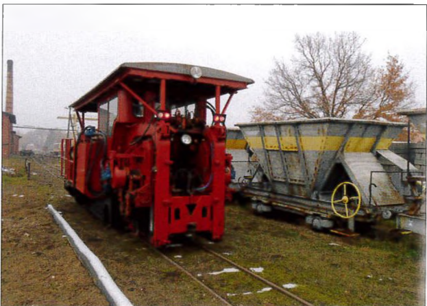
Podbijarka torowa i wagony szutrówki z czeskiej JHMD na stacji w Śmiglu. 11.11.2016 r.
