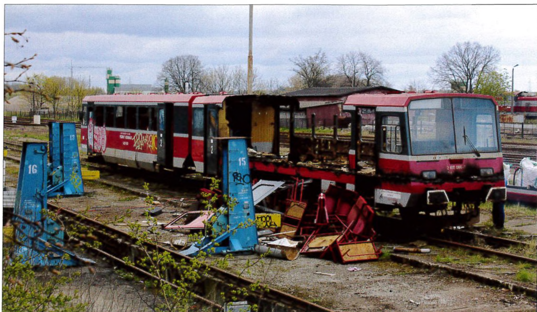
Chojnice. Kasacja szynobusu SA101-003, ciecie członu silnikowego. 29.04.2017 r.
