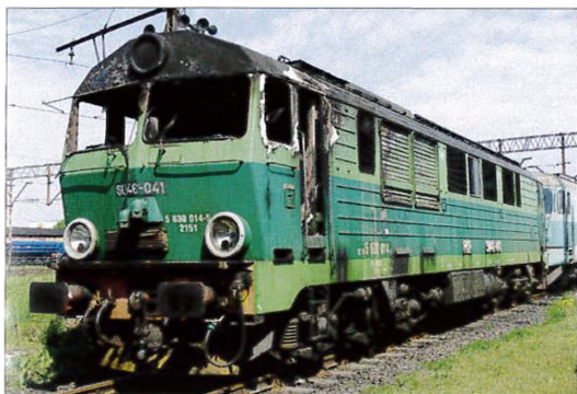
Lokomotywa spalinowa SU46-041 (HCP 303D-313/1977 r.) odstawiona na terenie lokomotywni Leszno po pożarze, na stacji Kąkolewo. 14.05.2017 r.
