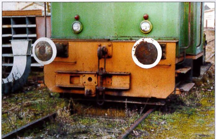
Lokomotywa Ls60-5947 zbliżenie na czołownicę z reliktem spręgu na tor 1000 mm. 13.02.2001 r.
