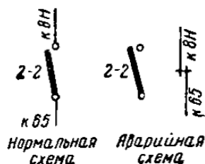
Рис. 74. Схема пересоединений в силовой цепи при повреждении контактора 2-2
