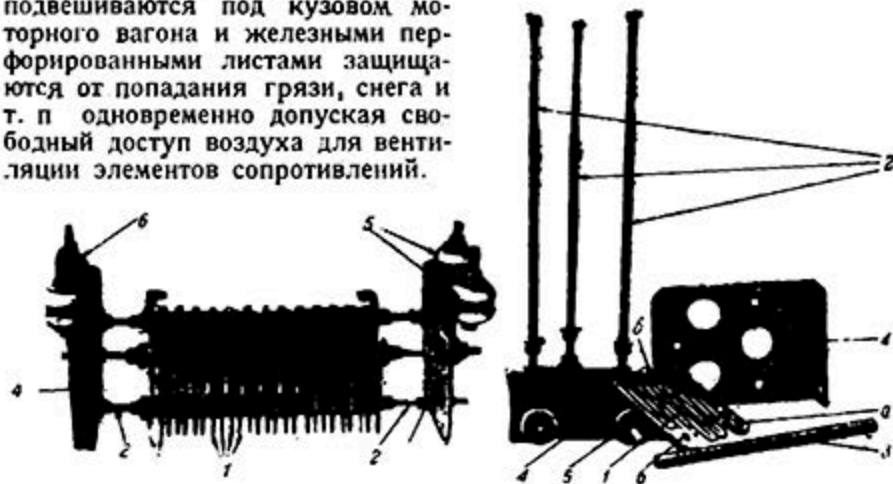
Рис. 42. Пусковые сопротивления СЖ-2Б.
