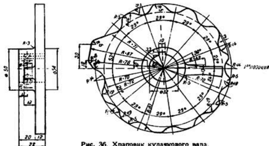
Рис. 36. Храповик кулачкового вала.
