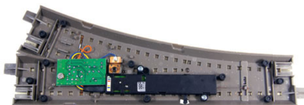
Eine Roco-Geoline-Weiche mit Roco-Antrieb und Decoder
