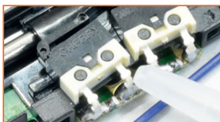
Ein Schleifkontakt und die Mikroschalter im Detail
