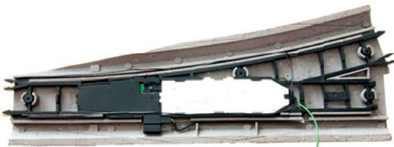
Für die (leider) nur noch aus Altbeständen erhältlichen Rocoline-Weichen mit Bettung entwickelte der Hersteller einen kompakten DCC-Digitalantrieb, der auch auf Lokadressen hört.
