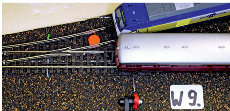
III Abb. 9 Die Trenstellenanordnung beim Weichenherzstück einer Sbf-Ausfahrweiche gewährleistet keine Grenzzeichenfreiheit.
