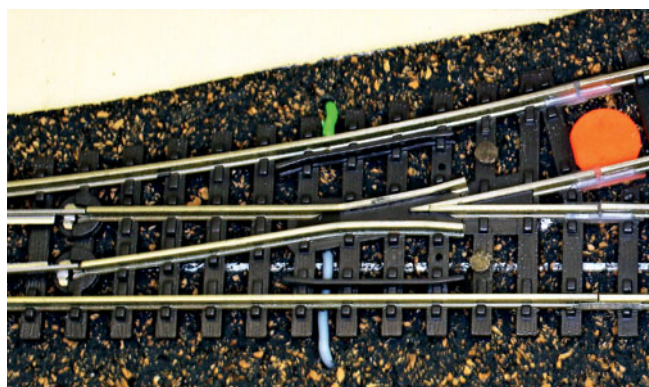
III Abb. 8 Drei Trennstellen bei jeder Sbf-Ausfahrweiche
