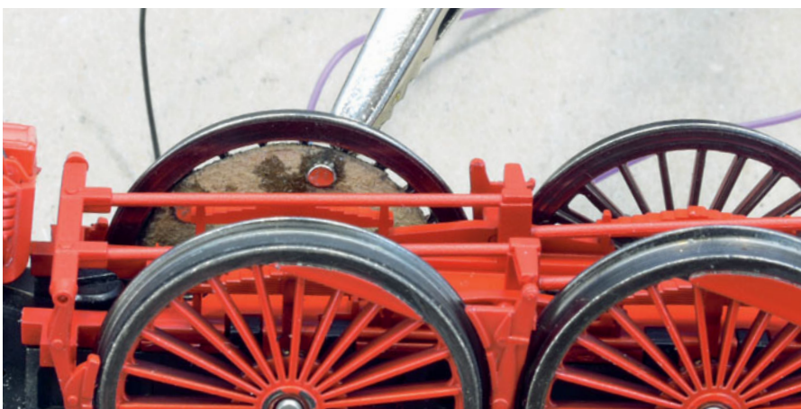
Sind Magnetscheibe und -sensor angebracht, wird das Fahrwerk wieder montiert.
