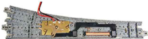
Hier wird das Antriebsprinzip deutlich: Je nach Stromrichtung in der Spule wird entweder der linke oder der rechte Magnet angezogen.
