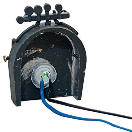
In die Feuertür wird ein Stück transparenter Kunststoff eingesetzt, auf das eine LED geklebt wurde.
