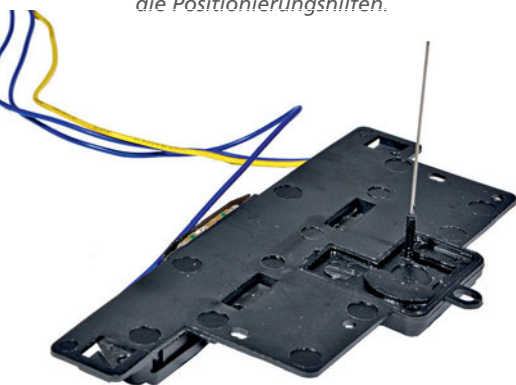
Die fertig zusammengebaute Einheit ist nur einen Millimeter dicker als der eigentliche Doppelspulenantrieb.
