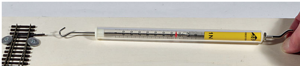
Bei knapp 0,25 N liegt die Weichenzunge der EW 1 sicher an.
