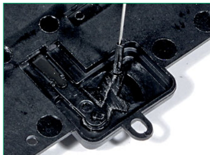
Die Umlenkmechanik verlangt Sorgfalt beim (kleberlosen) Zusammenbau, sonst neigt sie zum Hakeln.
