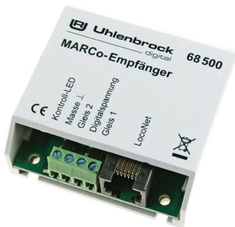
Nach anfänglichem Zögern hat sich auch Uhlenbrock entschlossen, RailCom zu nutzen. Mit den MARCo-Empfängern alleine und auch in Kombination mit den hauseigenen Lissy-IR-Punktmeldern steht lokales Automatisierungspotential zur Verfügung, das über das LocoNet nahezu alle Aspekte einer Anlage steuern kann.
