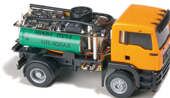
Sehr kompakt wurden bei dem Kehrfahrzeug Akkus und Elektronik samt Ultraschallkapsel untergebracht. Die Drahtschleife ist die Antenne für den Funkverkehr.
