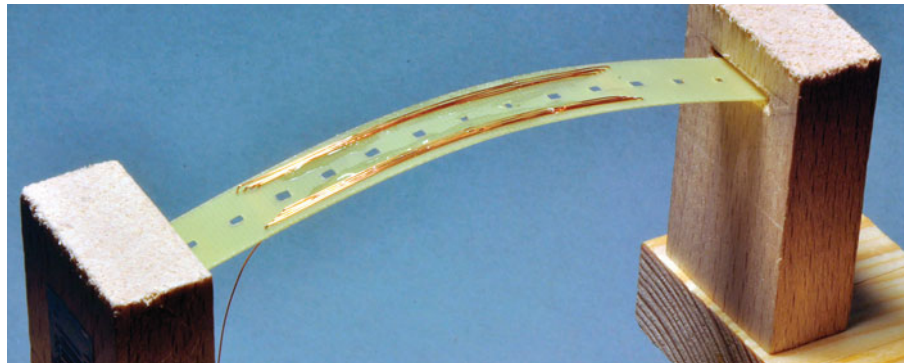
Sind alle Windungen gefädelt, wird die Folienbiegung umgedreht, sodass die Drähte sich parallel spannen. Klebstoff fixiert ihre Lage.
