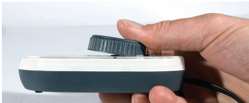
Das Drehrad ist auch ein vier-plus-eins-Wegetaster. Vergleichbares wird in hochwertigen Automobilen als Multi-Eingabeelement, oft Jog Dial genannt, verbaut.
