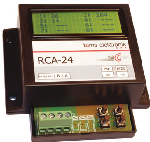
RailCom-Anzeige von Tams für die Überwachung von 24 Gleisabschnitten. Die passenden Detektoren kommen vom gleichen Hersteller und werden per Zweidrahtbus angeschlossen. Das verwendete Protokoll hat Tams unter der Bezeichnung RC-Talk offengelegt.
