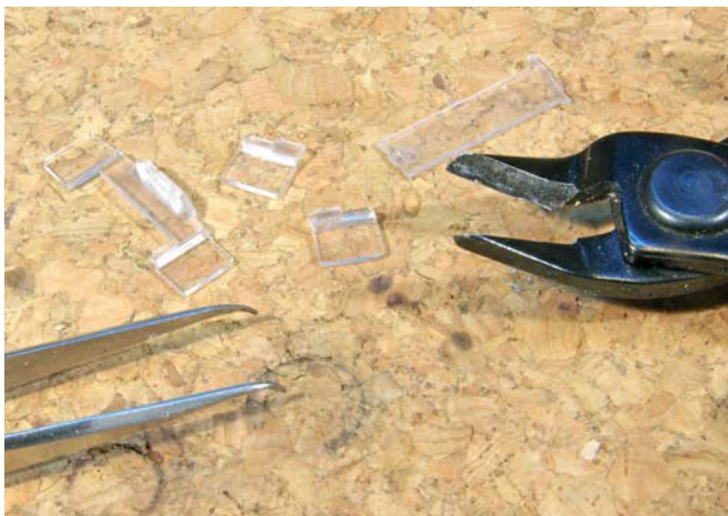
Der Einsatz wird zertrennt. Die Fenster werden einzeln an ihren Platz geklebt.
