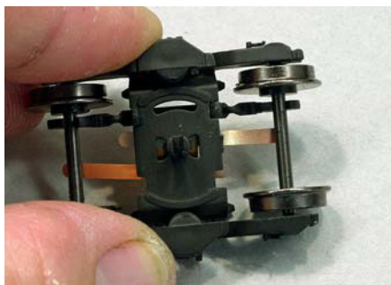
Die Drehgestelle lassen sich einfach ausklipsen, um die Radsatzmaße zu prüfen. Man beachte die Lage der Isolierbuchsen!
