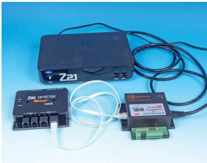
Ein Roco-Detector zusammen mit einem CdB-Modul am ZCAN-Bus einer Z21.
