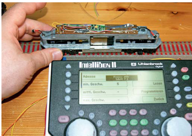
Bevor man das Gehäuse aufsetzt, sollte man eine Probefahrt auf dem Programmiergleis machen. Bei mir war der Anschluss für das Licht vertauscht: In diesem Zustand musste ich nur die Anschlüsse des weißen und des gelben Kabels tauschen.
