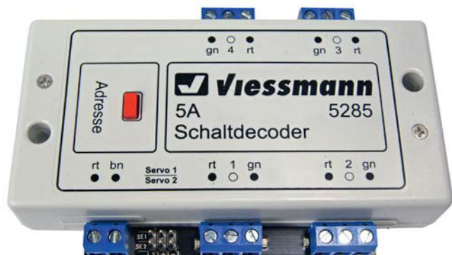
Der Multiprotokoll Decoder 5285 von Viessmann steuert vier Relaisausgänge mit je 5 A und zusätzlich noch zwei Servos an. Außerdem besitzt er einen zuschaltbaren Zufallsgenerator.
