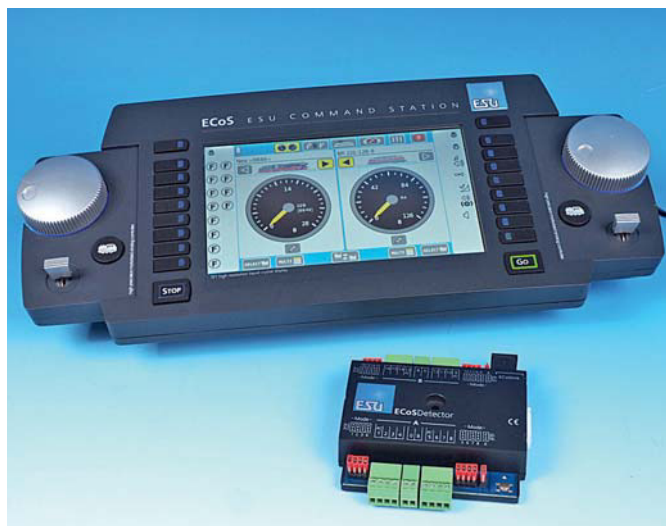
Ein ECoSDetector funktioniert ausschließlich an der ECoS. Der ECoSLink genannte Anschluss ist ein CAN-Bus.
