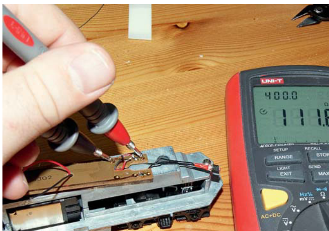
Mit einem Multimeter mit Piepsfunktion kann man schnell den Verlauf der Leiterbahnen auf der Lok-Platine nachvollziehen. Völlig ausreichend ist ein preiswertes Multimeter aus dem Baumarkt
