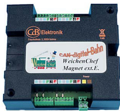
Die „WeichenChefs“ des CAN-digital-Bahn-Projekts für den ZCAN haben externe Eingänge, an die Endschalter angeschlossen werden können, die dann als Sensoren dienen und die echte Schaltstellung erfassen und in den Bus melden.
