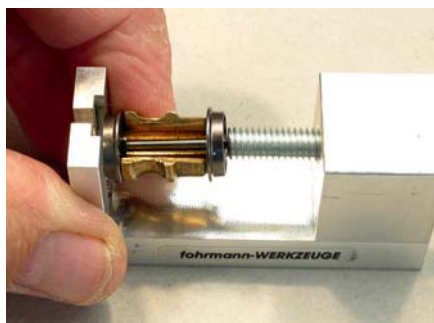
Mit dem Fohrmann-Werkzeug lassen sich Radscheiben präzise aufpressen. Die Lehre sorgt für das richtige Maß.
