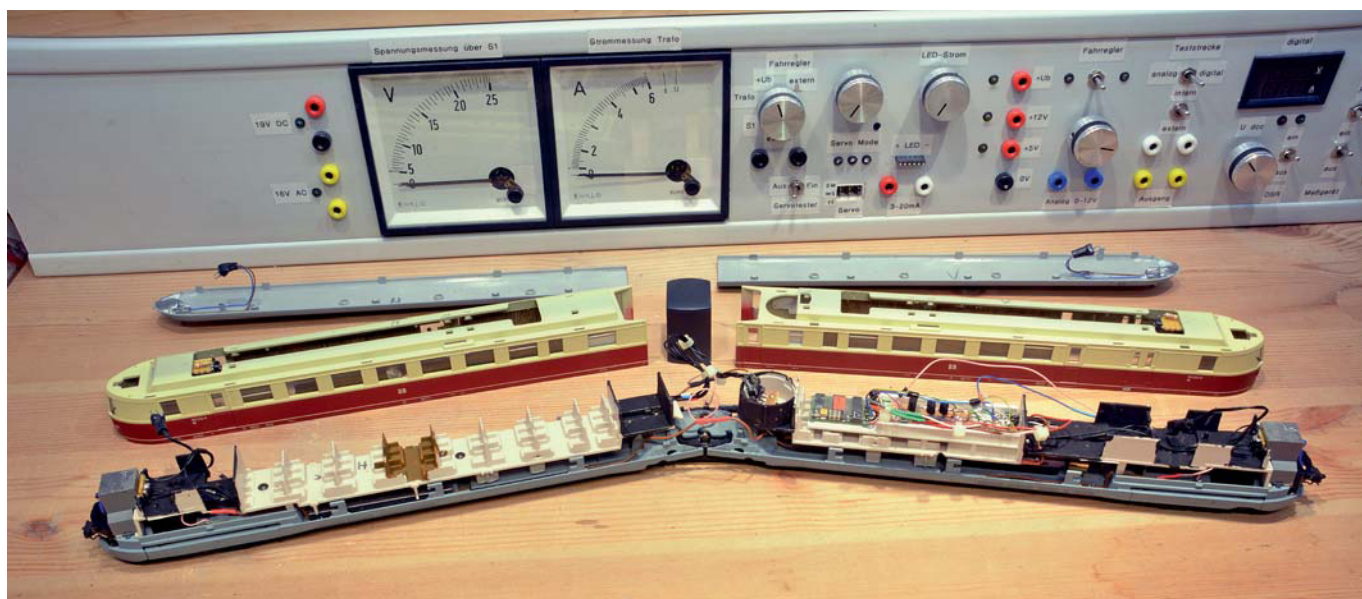
Der Triebwagen bleibt trotz der vielen Kabel weiterhin gut zerlegbar, da mehrere Steckverbindungen eingebaut wurden.
