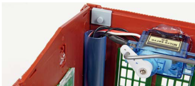
Damit später von außen keine Leitungen zu sehen sind, werden diese im Gebäude sauber verlegt und anschließend durch einen großen Trinkhalm o.Ä. bis in den Untergrund der Modellbahnlandschaft geführt.
