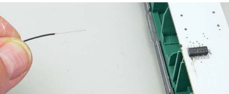
Verzinnnte Litze ist das Mittel der Wahl für die Reparatur.
