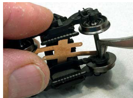
Bevor die Radsätze ausgebaut werden können, ist die Bremsscheibenimitation zu entfernen.
