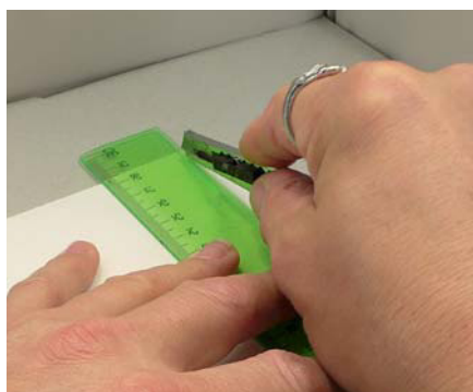
Mit einem scharfen Messer lassen sich Polystyrolplatten gut schneiden: Anritzen und dann über eine Kante brechen
