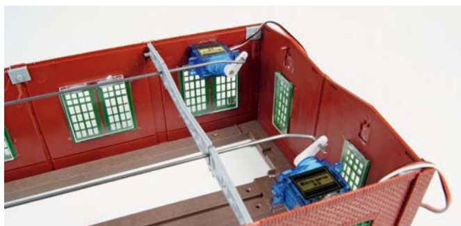
Die montierten Servos ersetzen die bisherige mechanische Betätigung der Tore durch die einfahrende Lokomotive. Die beiden Servos lassen sich an den Seitenwänden auch einfach ankleben.
