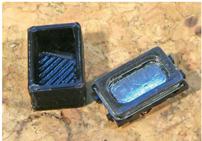
Der kleine Zimo-Lautsprecher überlebensgroß. Die Originalabmessungen sind 8 x 12 mm.
