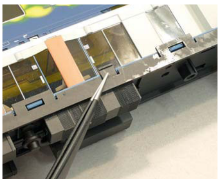
Durch die Verwendung der Fühlerlehre werden die Kunststoffrasten nicht so sehr belastet, dass sie brechen könnten.
