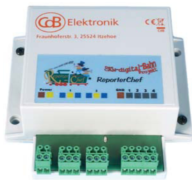
Der ReporterChef des CAN-digital-Bahn Projektes verfügt über zwei Anschlüsse für Weichen mit Rückmeldefunktion und gleichzeitig über vier weitere Rückmeldeeingänge.
