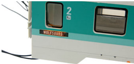
Man muss die LED recht dunkel betreiben, damit das gewünschte Aussehen entsteht.
