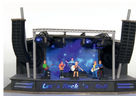
Nach dem Anschluss der Betriebsspannung und bei Musikpausen zeigt eine blaue LED-Grundbeleuchtung in Verbindung mit einem illuminierten Sternenhimmel an der Bühnenrückwand die Betriebsbereitschaft an.
