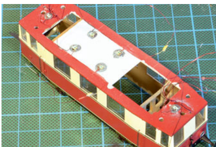
Der VT hat eine Polystyrol-Trägerplatte für die Fahrgastraumbeleuchtung erhalten. Inzwischen sind fast alle LEDs eingebaut.
