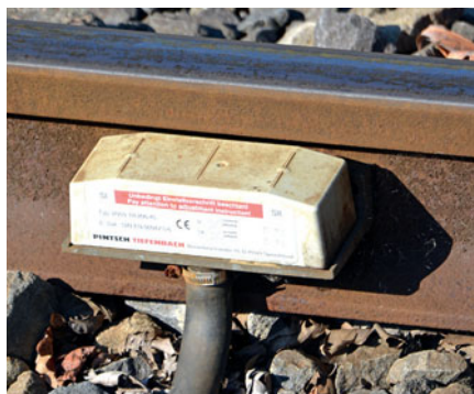
Solche Achszähler werden bei EOWs eingesetzt, um Fahrzeuge zu detektieren.
