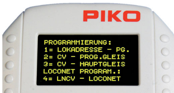
Der SmartController light „kann“ alle nötigen Programmierarten: Lokadresse, CV, POM und sogar die LNCV-Programmierung zur Konfiguration von LocoNet-Geräten.
