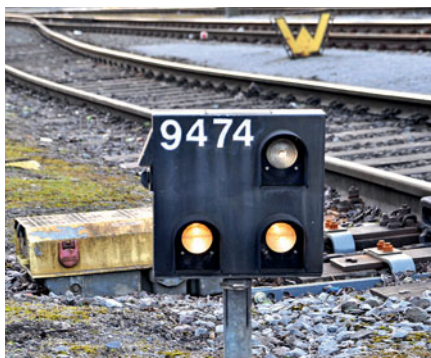
Der Weichenlagemelder mit dem seitlichen kleinen Taster stammt aus der ersten Generation: Auf dem Fabrikschild stehen West-Germany und eine vierstellige Postleitzahl.
