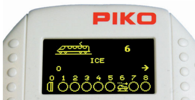
Die Lokauswahl funktioniert ganz einfach: Nach Druck auf die Lok-Taste kann man entweder mit dem Drehregler durch die Lokdatenbank blättern oder alternativ eine Lokadresse über die Tastatur eingeben. Mit der Enter-Taste wird die Lok dann übernommen.
