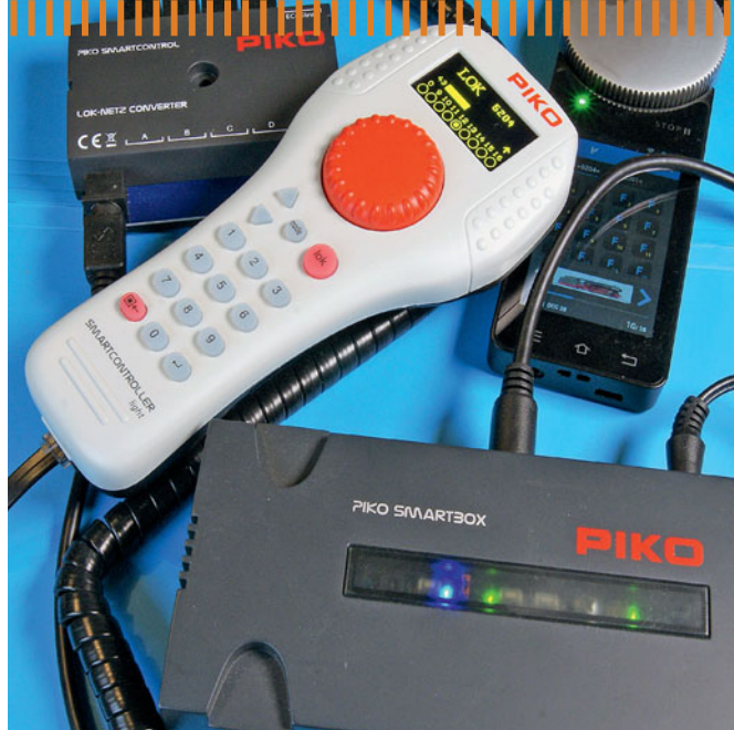
Und ewig lo(c)kt das Netz: Mittels LokNetz-Adapter bilden SmartController, SmartBox und SmartController light ein tolles Team. Am LokNetz-Adapter lassen sich bis zu vier SmartController light direkt anschließen.
