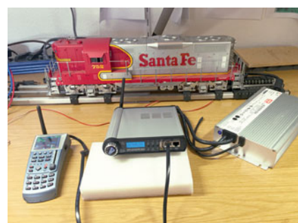
Einstellen und Test einer GP9 auf dem Rollenprüfstand: Der MX32 alle Sonderfunktionen und Sounds der Diesellokomotive an.
