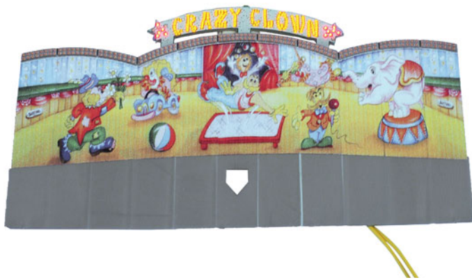
Beim „CRAZY CLOWN“ erhielten die Schrift, die roten Sterne sowie die Oberkante der Rückwand eine LED-Beleuchtung. Hier der erste Ansatz mit 192 gelben plus 2 x 8 roten LEDs.
