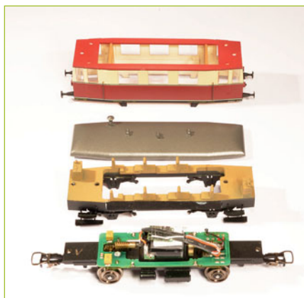
Die Baugruppen des Triebwagens: Gehäuse, Dach, Innenraum, Fahrwerk
