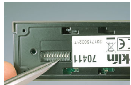
An der Unterseite des Antriebskastens befindet sich ein sogenannter Dip-Schalter („Mäuseklavier“). Hier werden die Betriebsart und gegebenenfalls auch eine Adresse eingestellt.
