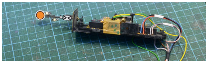
Ein erster Test der LEDs und des Signalantriebs findet statt.
