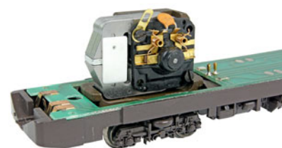
Gereinigt und neu geschmiert steht das Antriebsdrehgestell mit dem neuen Motor für den Einsatz bereit.
