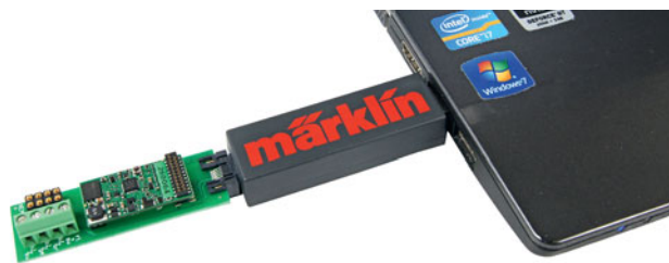
Die werkseigenen Lok- und Sounddecoder von Märklin lassen sich bequem mit dem Decoder-Programmer und dem Märklin-Decoder-Tool mDT3 konfigurieren. Der Anschluss erfolgt am USB-Anschluss des PCs. Der Decoder wird dabei direkt auf den Decoder-Programmer gesteckt.
