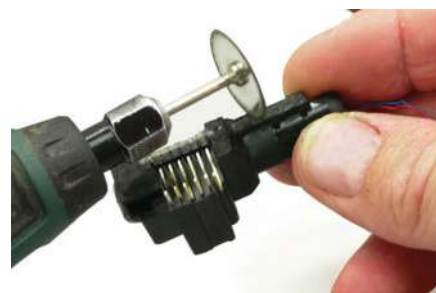
Die entstandene Naht glättet man mit einer Schleifscheibe.
