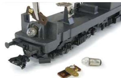
Auch die Lampen werden demontiert
