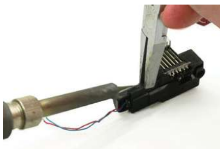
Da sich die Naht zwischen Deckel und Behälter nicht dicht verkleben lässt, schweißt man sie mit einem Lötkolben zu.
