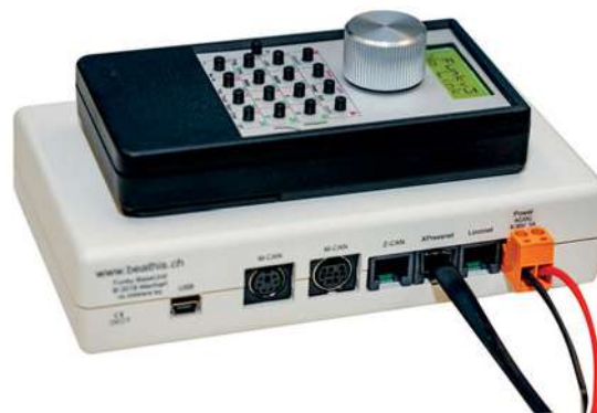
Die Basisstation von vorne und von hinten, jeweils mit draufliegendem Funky-Handregler. Hier erkennt man die Vielfalt der verschiedenen Anschlussmöglichkeiten.
