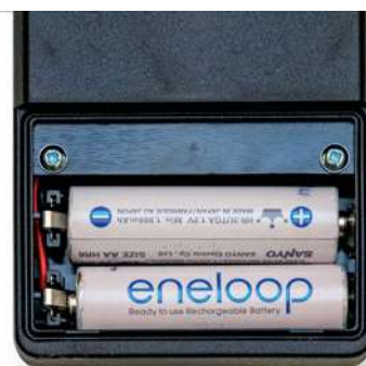
Die Energie des Handreglers stammt aus zwei AA-Zellen, ob dies Batterien oder Akkus sind, ist egal.
