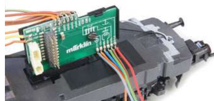
Hier sieht man sehr schön, wie weitgehend die Lampenhalterungen abgesägt wurden. Die Schnittstellenplatine findet ihren Platz dort, wo bisher das Umschaltrelais saß.
