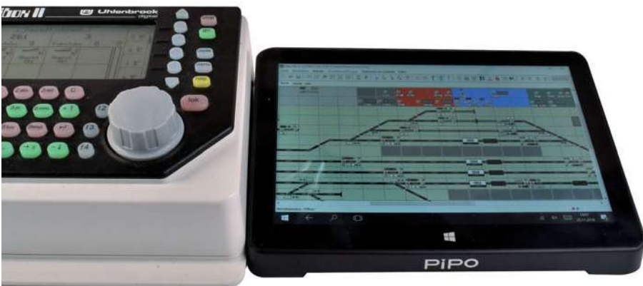
Das Pipó-Tablet neben einer Intellibox. Es sieht aus, als würde die beiden schon immer zusammengehören... Auf dem Tablet läuft ESTWGJ. Die Intellibox ist über USB angeschlossen.
