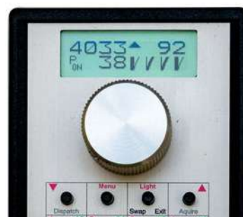
Immer vier Zubehörgeräte sind im gleichzeitigen Zugriff – entsprechend der Vierergruppierung bei den Zubehördigitaladressen. Der jeweilige Schaltzustand wird über die Weichensymbole angezeigt: Der dickere Strich steht für die gewählte Fahrtrichtung, hier also gerade, abweigend, abweigend und gerade.
