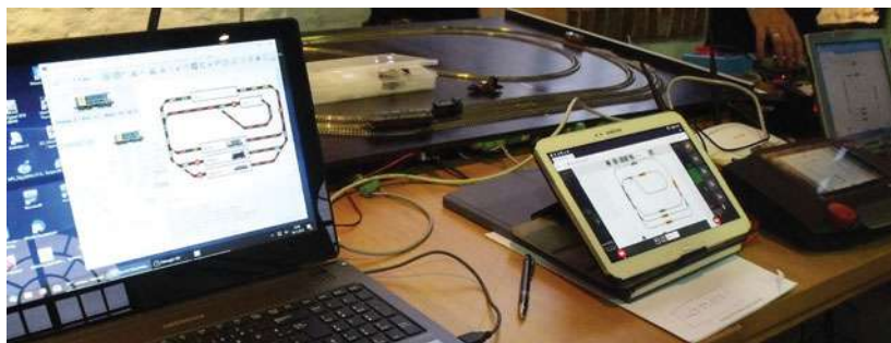
Die Testanlage ist an einer CS3 mit Router-Steuerung über Web-APP per Android-Tablet angeschlossen und ganz rechts Windows-Notebook. Links zusätzlich eingebundenes Modellbahnsteuerprogramm
