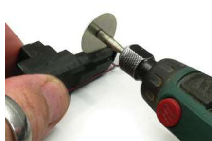
Deckel und Behälter sind vorsichtig zu trennen.
