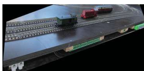
N-Testanlage mit sieben elektrisch isolierten Abschnitten: Bahnhofsgleise unten (1-3), Gleis am oberen Bildrand (4), linke (5) und rechte Weichengruppe (6), Kehrschleife einschließlich. Weiche (7)
