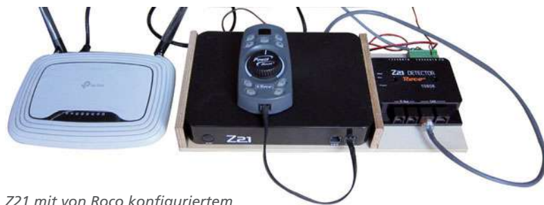
Z21 mit von Roco konfiguriertem TL-WR841N und Roco 10808-Detector und RocoMaus
