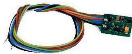
Der Uhlenbrock Funktionsdecoder 73800 war lange Zeit der einzige Decoder mit Binary State-Funktion.
