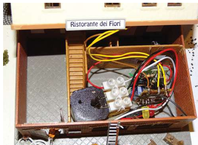
In „Aktion“ dampft das brennende Haus und die LEDs flackern feuerartig wild. In dem runden Döschen ist das Dampföl untergebracht. Durch ein Loch im Deckel zieht der Verdampfer das Öl an. Durch ein anderes Loch wird das Öl mit einer Spritze nachgefüllt.
