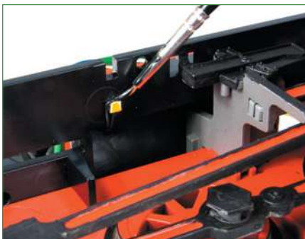
Nachdem die LEDs am Lokrahmen verklebt wurden, werden die Gehäuse noch mit mattschwarzer Farbe behandelt.
