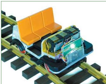
Decoder und Lautsprecher sitzen und auch die losen Kabel sind untergebracht. Der Test auf den Schienen zeigt: Das Frontlicht funktioniert wie es soll.
