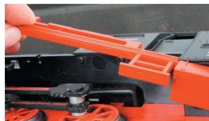
Erst nach Abhebeln der Trittstufe mitsamt der Halterung werden die letzten Befestigungsschrauben zugänglich.
