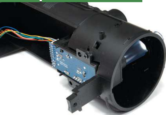
Der Dampfgenerator wird in der Rauchkammer so platziert, dass ein Abstand zum Einsteck-Schornstein entsteht.
