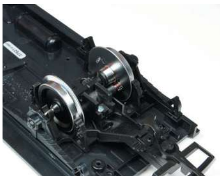
Die drehbar gelagerte Grundplatte ist am Fahrzeugboden montiert, die Anschlusskabel der Radkontakte sind bereits durch den Boden verlegt.
