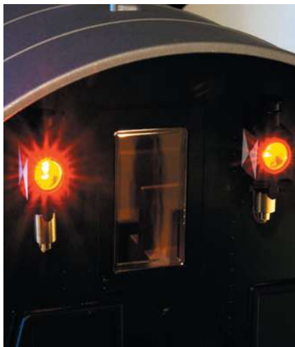
Die Zugschlussbeleuchtung ist besonders im Nachtbetrieb ein nettes Detail. Wer mag, tarnt die blanken Gewindefassungen unter den Laternen noch mit mattschwarzer Farbe.
