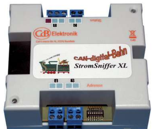
Die Vor-Ort-Einstellung eines StromSniffers XL erfolgt über Dip-Schalter („Mäuseklavier“).
