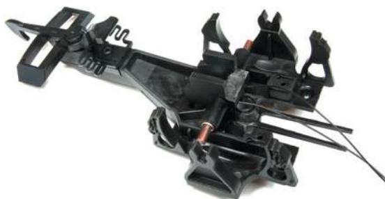
Die fertige Stromabnahme an der Achshaltergrundplatte noch ohne Radsatz
