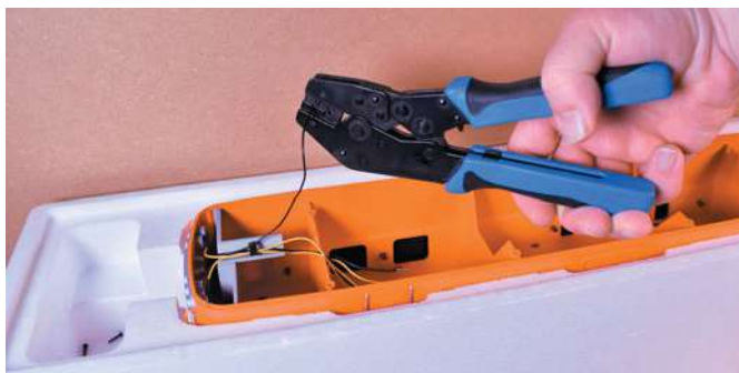
Die Verkabelung der LEDs für das Spitzensignal wird teilweise erneuert. Sehr praktisch ist hierbei, dass man die Verpackung der 218 als Lokliege verwenden kann.
