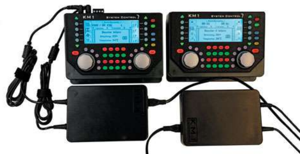
„System Control 7“ nennt KM1 seine OEM-Variante von Uhlenbrocks IB. Die Geräte liefern bis zu 7 A und sind als Booster kaskadierbar.
