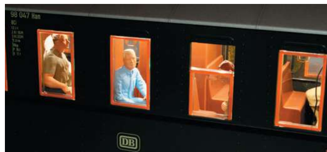
Der beleuchtete Innenraum kommt erst durch die eingesetzten Figuren so richtig zur Geltung. Als kleines Gimmick erhält der WC-Raum eine eigene Beleuchtung mit Zufallsfunktion.
