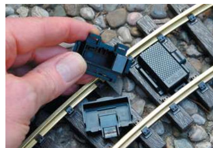
Der Magnet in einem Schaltauslöser ist einseitig angeordnet.
