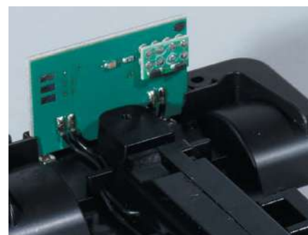
Die drei Pads links sind mit der Schnittstelle verbunden: oben der gemeinsame Rückleiter [+], in der Mitte der Lichtanschluss für Rückwärtsfahrt (F0), unten liegt der Schaltkanal 1 (oft F1). Hier erkennt man auch die noch nicht aufgeschnittenen Ösen, die die Kabel halten.
