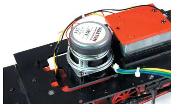
Der ESU Lautsprecher mit 50 mm Durchmesser und einer Impedanz von 8 Ω kommt eigentlich von Visaton und passt exakt zu der Lautsprecheraussparung in der Piko Lokomotive.
