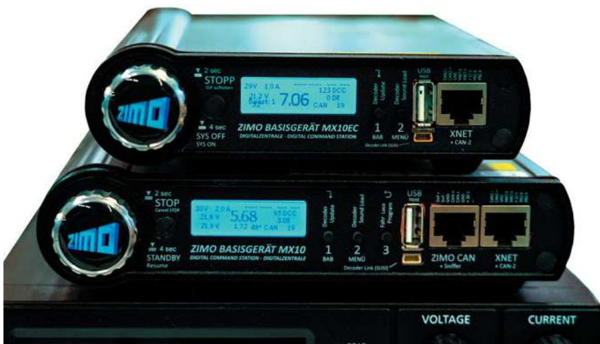
Bei Zimo kommen ähnlich wie bei KM1 komplette Zentralen als Booster zum Einsatz. Die eingebauten Leistungsstufen sind so ausgelegt, dass der Booster-Betrieb möglich ist. Die (oben stehende) MX10EC liefert bis zu 12 A, die MX10 darunter 20 A.
