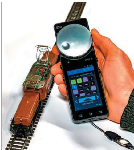
Das Mobile Control II von Esu ist ein Zwit-ter aus Android-Handy und Drehregler.
