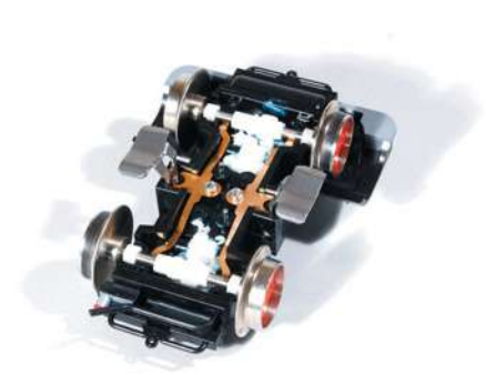
Für alle Neugierigen ein Blick ins Getriebe des Modells. Bei der hier beschriebenen Digitalisierung muss man die Bodenplatte nicht lösen!
