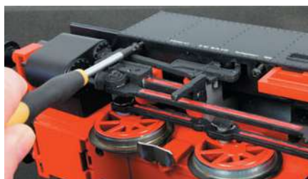
Um die Lokomotive zu zerlegen, sind div. Schrauben an der Fahrzeugunterseite zu lösen. Die einzelnen Gehäuseteile lassen sich anschließend abnehmen.
