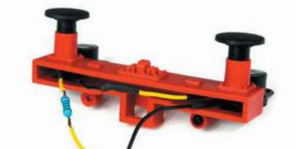
Zum Wechsel vom Analog- zum Digitalbetrieb werden die alten Widerstände und Dioden in den Zuleitungen zu den Lampen entfernt. Die dort werkseitig eingesetzten LEDs schaltet man in Reihe. Ein neuer 2,2-k \Omega -Widerstand, der in der Pufferbohle untergebracht wird, sorgt für die nötige Strombegrenzung.
