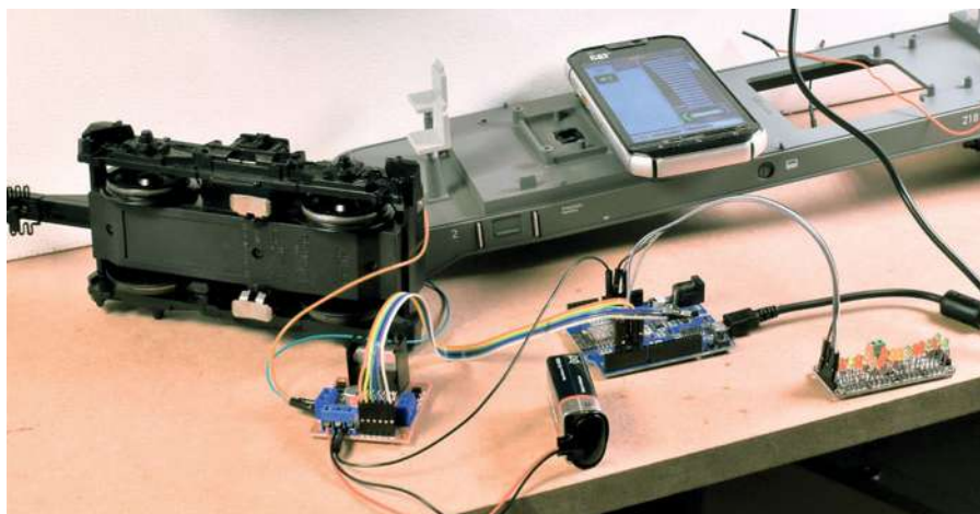
Beim Basteln mit Gartenbahn-Loks wird es schnell voll auf dem Basteltisch. Es läuft gerade ein erster Test mit dem Motor im ausgebauten Drehgestell. Die Verbindung zwischen den einzelnen Komponenten erfolgt mit Jumper-Wires. Sogar der Anschluss des Motors ist mit diesen Kabeln möglich.
