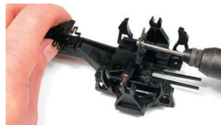
Mit einer Kleinbohrmaschine lässt sich die Aussparung für die Radsatzachse gut aus dem Kontaktträgerblock herauschneiden.
