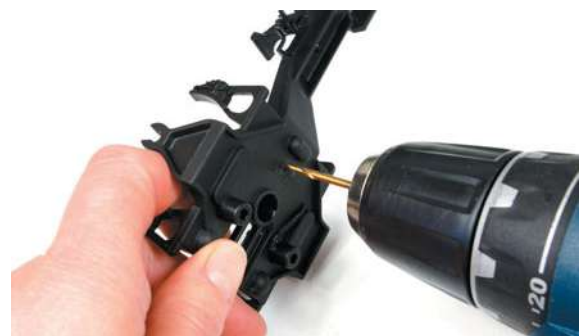
Exakt in der Mitte wird im vorderen Teil der Grundplatte ein 3-mm-Loch gebohrt.
