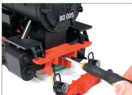
Um die Rauchkammer abnehmen zu können, ist eine Rastnase durch das Loch hinter der Pufferbohle mit einem Schraubendreher leicht nach hinten zu drücken.
