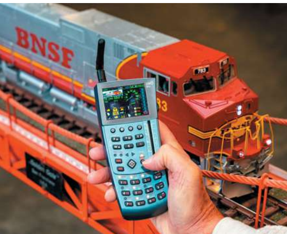
Das MX32FU von Zimo bringt eine abwinkelbare Stummelantenne mit. Für die Übertragung wird das 2,4-GHz-Band genutzt.
