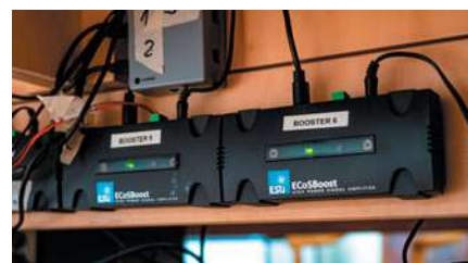
Die 7 A liefernden EcoBoost von ESU sind einfach kaskadierbar.
