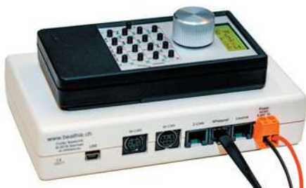
Die Funkverbindung beruht auf dem DECT-Standard, mit dem zuhause schnurlose Telefone betrieben werden.
