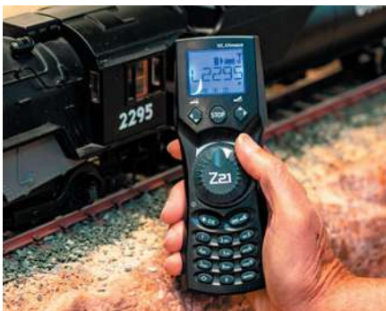
Die WLAN-Maus von Roco hat das Gehäuse mit den früheren MultiMäusen gemein. Sie nutzt, wie der Name schon sagt, handelsübliches WLAN.
