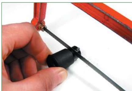
Der Schornstein wird gekürzt und von unten zur späteren Aufnahme des Silikon-schlauchs vorsichtig aufgebohrt.
