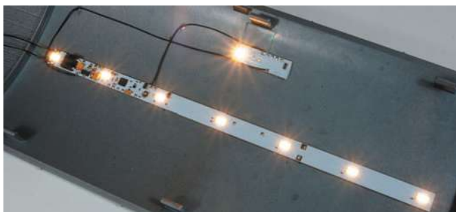
Die Montage der Wageninnenbeleuchtung erfolgt mit doppelseitigem Klebeband.
