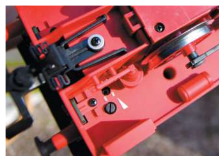
Der Lautstärkereger und der Schalter für die Führerstandsbeleuchtung sind von unten zugänglich.
