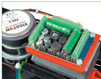
Der Decoder findet seinen Platz auf der gekürzten Grundplatte oberhalb des Gewichtes.
