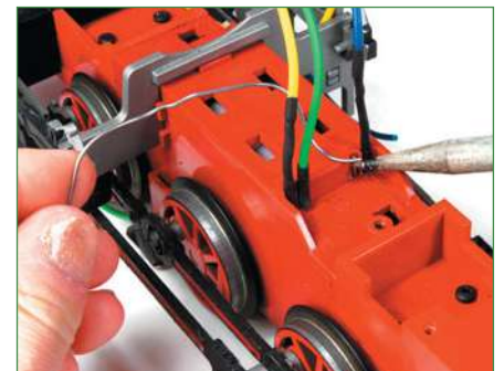
Wer späteren Kontaktproblemen vorbeugen möchte, lötet neue Kabel für Motor und Stromabnahme an.
