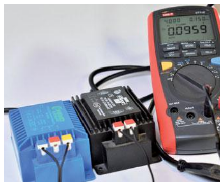
Auf dem linken und dem mittleren Bild sind zwei Trafos mit Spielzeugtransformator-Kennzeichnung sekundärseitig miteinander verbunden. Mit dem Messgerät ist am offenen Steckerende keine Spannung feststellbar. Ganz rechts dann der Versuchsaufbau mit einem Spielzeugtransformator und einem Sicherheitstransformator. Hier liegt am offenen Ende eine gefährliche Spannung von 233 V an.
