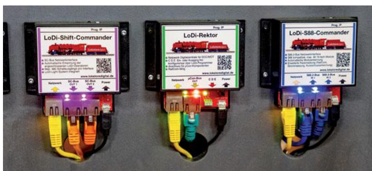
Der Hersteller empfiehlt, für die verschiedenen Aufgabenbereiche der Anlagenverkabelung unterschiedliche Kabelfarben einzusetzen.
