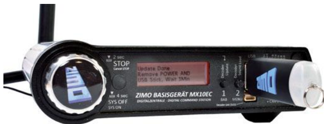
Zimo rüstet regelmäßig neue Funktionen per Update nach. Solche erfolgen bei der MX10EC ganz einfach per USB-Stick.
