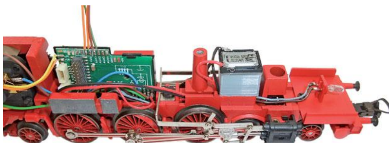
Lautsprecher LS1511 mit Schallkapsel auf Rahmen verklebt
