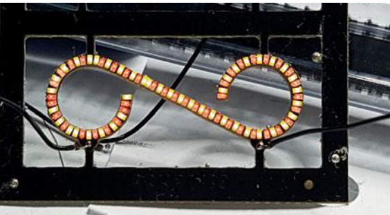
Bestückt man die LEDs abwechselnd mit zwei Leuchtfarben und dreht dabei auch jedes Mal Anode und Kathode um, erhält man eine Girlande, die in der einen Stromrichtung in der einen Farbe leuchtet, in der anderen Stromrichtung in der anderen Farbe. Polt man schnell genug um, scheinen beide Farben mit ungefähr halber Helligkeit zu leuchten.
