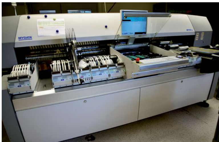
Herzstück der Produktion bei Bühler Elektronik ist der Bestückungsautomat. Auf der linken Seite sind die Rollen mit den einzelnen Bauteilen zu sehen. Die Bauteile werden vom Automaten an die richtige Stelle auf die Platine gesetzt. Dabei werden sie vermessen und Bauteile mit verbogenen Anschlüssen aussortiert. Nach dem Bestücken erfolgt noch eine weitere Kontrolle, bevor die Platinen in einen speziellen Ofen zum Löten wandern.
