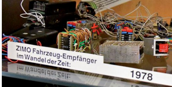
Die ersten Zimo-Decoder von 1978 waren 45 x 28 x 20 mm groß.
