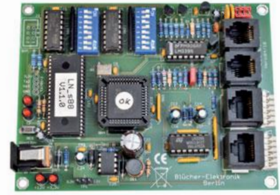
Der LN-s88-Converter kann an s88 und s88-N-Anschlüsse angeschlossen werden. Auf der LocoNet-Seite lassen sich Blüchers Gleisbesetzmelder und solche von Uhlenbrock betreiben.
