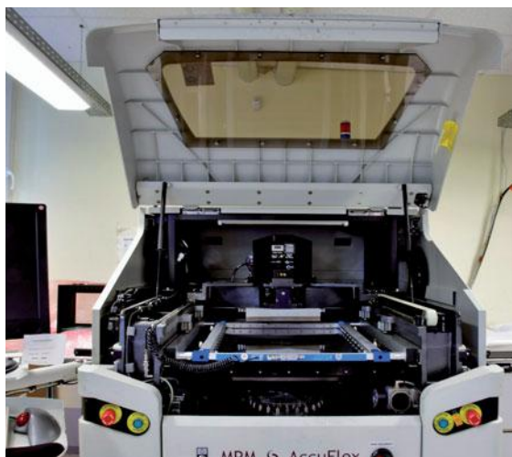
Ein Schablonendrucker verteilt die Lötpaste auf den Platinen an die richtigen Stellen. Das muss natürlich immer vor der Bestückung geschehen und ist insbesondere bei sehr kleinen Bauteilen eine Wissenschaft für sich.
