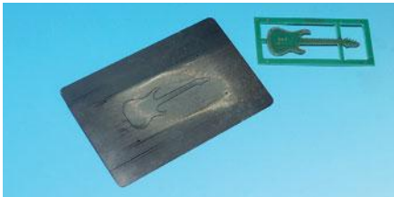
Zum präzisen Auftragen der Lötpaste fertigen die Platinenhersteller auch spezielle Schablonen, durch deren Löcher die Paste platzierungsgenau aufgerakelt werden kann. Auf der Platine bleibt ein exakt dosierter Lötpastenauftrag, der die aufzulegenden SMD-Bauteile ein wenig festklebt.
