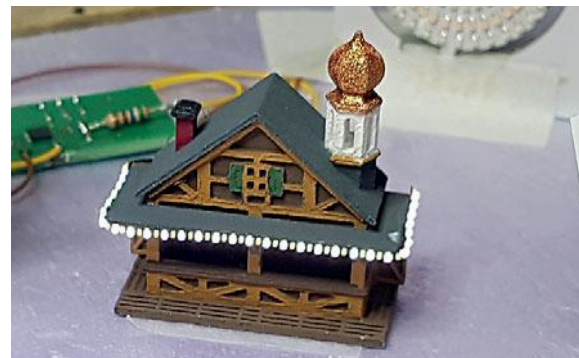
80 LEDs der Baugröße 0201 in einer selbstgemachten flexiblen Lichterkette beleuchten eine Weihnachtsbude im Z-Maßstab. Die Bude wurde von pericous in einem 3D-Druckverfahren gefertigt.
