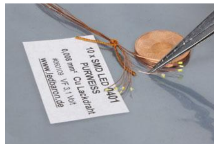
Winzige fertig bedrahtete 0401-LEDs mit der Leuchtfarbe „purweiß“ sollen es sein.
