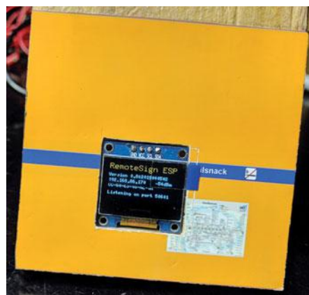
Der Sitz der Anzeige wird geprüft, bevor die neue Wandverkleidung gedruckt wird. Diese wird eine zur Bildschirmgröße passende Öffnung haben.
