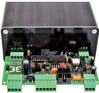
Lenz-Aufsatz: Das Booster-Powermanagement-Modul ist so konstruiert, dass es einfach hinten auf einen Lenz-Booster aufgesteckt werden kann. Das aktuelle Modell passt bei LV102 und LV103.
