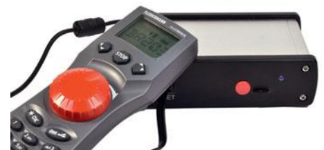
Als Handregler können Multimäuse an der Zentrale verwendet werden. Leider funktionieren im Moment Lenz-Handregler noch nicht.
