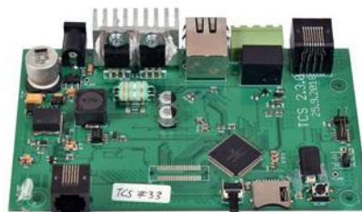
Aufgeschraubt und reingeschaut: Augenscheinlich habe ich die Zentrale mit der Nummer 33 erwischt. Der große NXP-Prozessor bietet Leistungsreserven.
