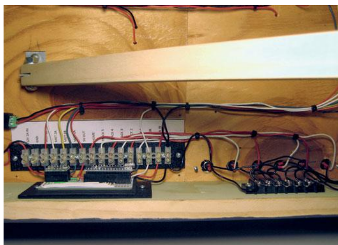
Blick von unten: Der gesamte elektronische Aufbau passt genau hinter die vordere Rahmenwange der Anlage. Die Taster und ihre Klemmleiste befinden sich rechts.
