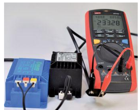
Auf dem linken und dem mittleren Bild sind zwei Trafos mit Spielzeugtransformator-Kennzeichnung sekundärseitig miteinander verbunden. Mit dem Messgerät ist am offenen Steckerende keine Spannung feststellbar. Ganz rechts dann der Versuchsaufbau mit einem Spielzeugtransformator und einem Sicherheitstransformator. Hier liegt am offenen Ende eine gefährliche Spannung von 233 V an.
