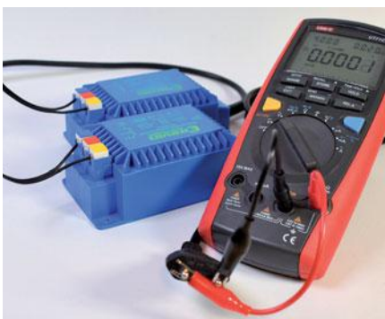
Auf dem linken und dem mittleren Bild sind zwei Trafos mit Spielzeugtransformator-Kennzeichnung sekundärseitig miteinander verbunden. Mit dem Messgerät ist am offenen Steckerende keine Spannung feststellbar. Ganz rechts dann der Versuchsaufbau mit einem Spielzeugtransformator und einem Sicherheitstransformator. Hier liegt am offenen Ende eine gefährliche Spannung von 233 V an.
