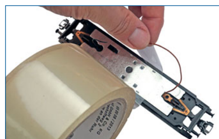
Stromleitende Teile wie das Gewicht zum Beschweren des Wagens werden isoliert. Zusätzlich verbessert dies die Stabilität.
