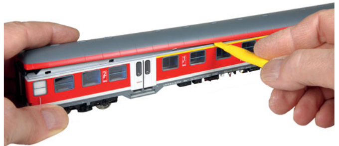
Beim Öffnen der Pullman-Wagen hilft ein Werkzeug aus einem Handy-Reparatursatz. Es ersetzt die sonst arg strapazierten Fingernägel beim Abnehmen des Dachs.
