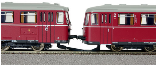
Die Aufhängungen der Kupplungsschächte sind so weich, dass sie sich beim Versuch, die Fahrzeuge auf dem Gleis zusammenzuschieben, verbiegen.
