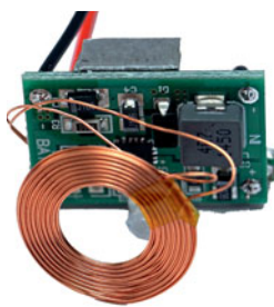
Optional: Wireless Power Transfer, um den Akku ohne Kabel zu laden
