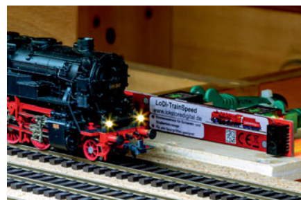
Das automatische Einmessen einer Lok mit dem LoDi-Train-Speed Modul im Schattenbahnhof
