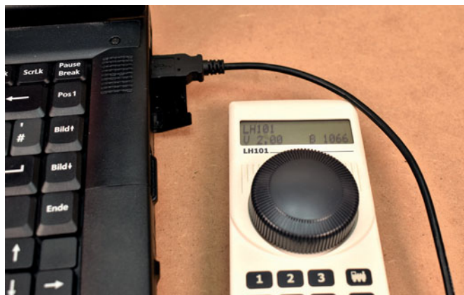
Die Bedienung der Modellzeituhr ist im Lenz-Handregler erst ab der Software-Version 2.00 integriert. Bei Lenz ist ein Update-Kabel erhältlich, mit dem die neue Software bequem zu Hause auf den Handregler aufgespielt werden kann.
