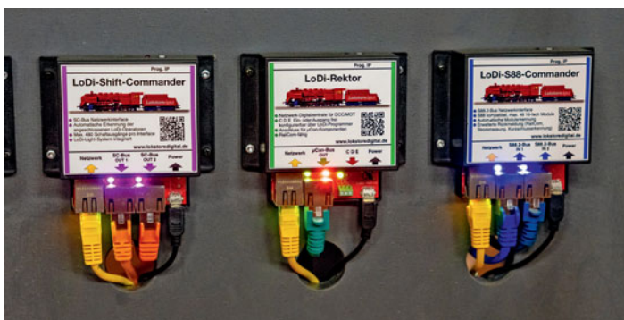
Das eigentliche Herz der Anlagensteuerung: LoDi-Rektor (Digitalzentrale), LoDi-Shift-Commander und LoDi-S88-Commander
