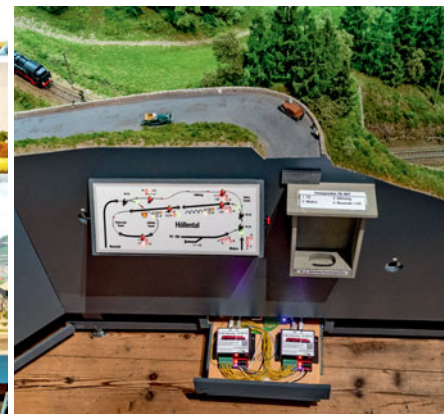
Blick ins Hölleental mit dem zugehörigen Gleisbildstellpult: Zur Wartung herausgezogen ist eine Schublade mit zwei LoDi-Operator-Modulen zur Steuerung der Weichen und Signale vor Ort.
