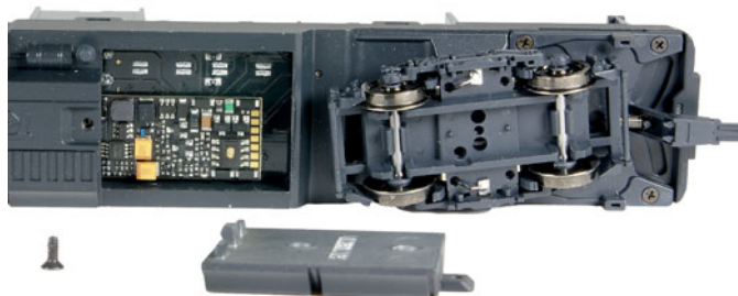
Der Decoder ist in einem von unten gut erreichbaren Fach untergebracht. Bei der Digitalversion sind die analogen Dipschalter fürs Licht nicht bestückt (vier Lötflächenpaare über dem Decoder).
