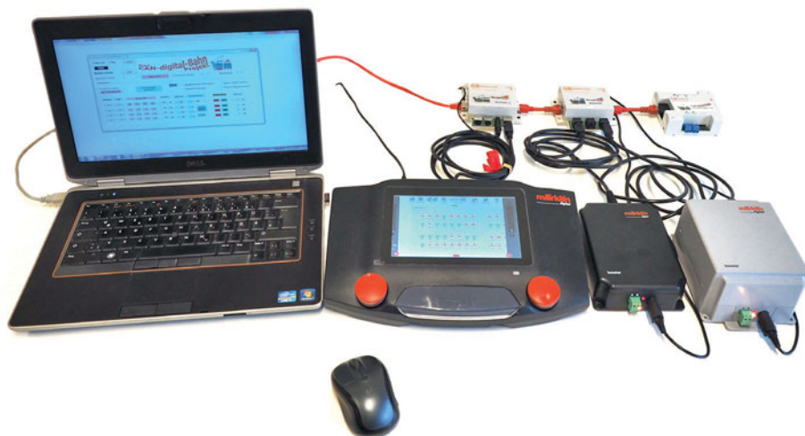
Verschiedene Booster an der Central Station werden über einen StromSnifferXL überwacht.
