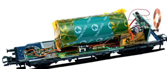
Kompletter Aufbau des Prototypen ohne Chassis mit Isolation der stromführenden Teile
