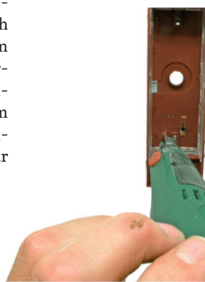
Für die Panto-Betätigungsschnur wird ein kleines Loch ins Dach gebohrt.
