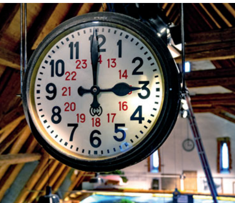
Hoch über der Anlage hängt eine echte Bahnhofsuhr. Diese wird von iTrain über das LoDi-System in einer wählbaren Modellbahn-Zeit angesteuert.
