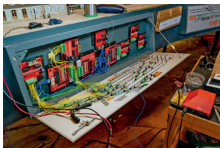
Ein aufgeklapptes Gleisbildstellpult. Hier sieht man sehr schön die Verbindung der Taster, Schalter und LEDs mit den LoDi-Operator-Bausteinen.
