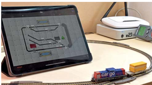
Die Verwendung einer z21start mit WLAN-Package erweitert die Möglichkeiten der Anlage enorm. Es ist schon hier möglich, die neue Version der Z21-App zu nutzen und ein Gleisbildstellpult zu konfigurieren. Die multiMaus kann problemlos weiterverwendet werden.
