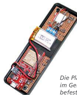
Die bestückte und verkabelte Platine ist fertig zum Einbau in das Gehäuse.
