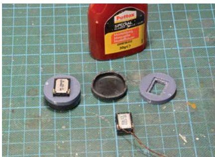
Die Lautsprecher erhalten große 23-mm-Resonanzkörper.
