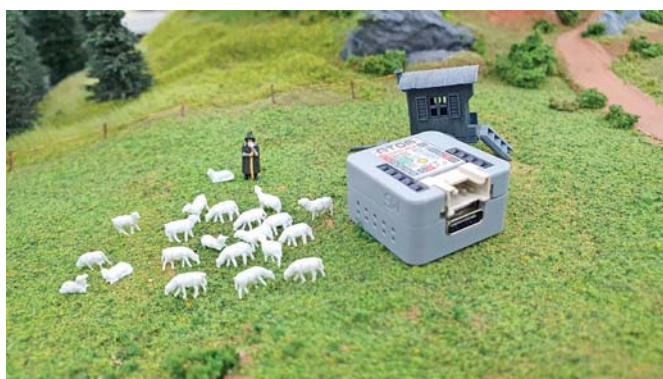
Schäfer Friedrichsen staunt nicht schlecht: soll der Kasten etwa seinen Schäferwagen ersetzen? Aus dieser Perspektive sind der Grove-Anschluss (I2C-Bus) oben und die USB-C-Buchse gut zu sehen.
