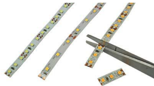
Die selbstklebenden LED-Streifen können je nach Typ alle 2,5 cm oder 5 cm getrennt werden.
