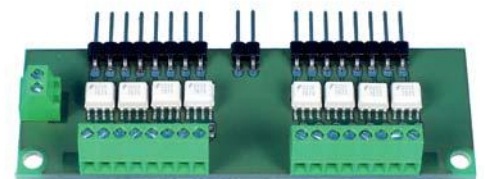
Eine galvanische Trennung wurde beim GleisReporter Basic mithilfe einer Vorschaltplatine mit Optokopplern erreicht.
