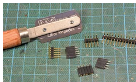
Die Pins und die Buchsen trennt man mit der feinen Säge von JLC Libor Kopecek (alternativ mit der Roco-Feinsäge).
