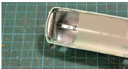
Zur Vermeidung von Fremdeinstrahlungen werden die Lichtleiter silbern lackiert.
