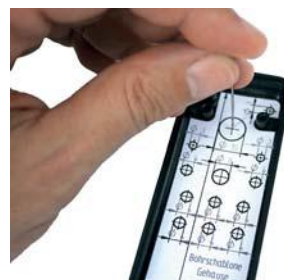
Die Bohrungen werden anhand der Schablone vorbereitet.
