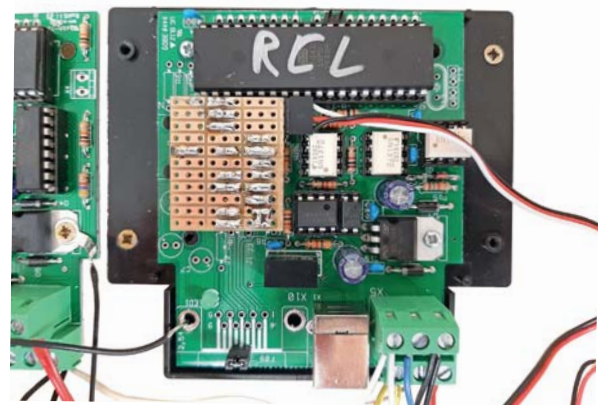
Auf der Oberseite des RC-Link wird eine Hilfsplatine mit einem Leitungstreiber-IC eingesteckt.
