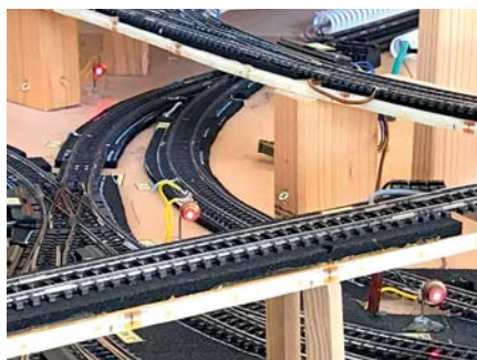
Die drei Laser der Triple-Laser-Architektur, die das große zusammenhängende Weichenfeld mit drei parallelen Strahlen überwachen.
