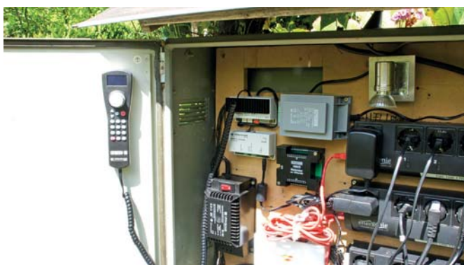
Die elektrischen Komponenten für die Steuerung und die Stromversorgung sind in einem witterungsbeständigen Anschlusskasten untergebracht.
