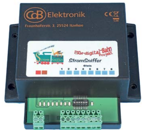
Der schon länger erhältliche StromSniffer für den ZCAN ist ein einfacher Strommelder für den CAN-Bus.
