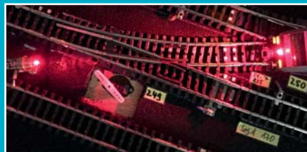
Ein Laser macht's möglich: Weichenstraßen auf Belegung überwachen
