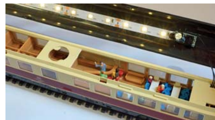
Hier ist eine Vorschaltplatine direkt am LED-Streifen angelötet. Alternativ ist die Montage mit Kabeln möglich.
