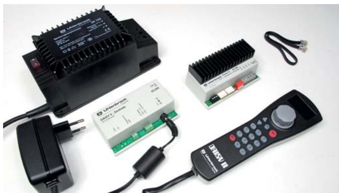
Uhlenbrock Daisy II und Power 8 übernehmen die Digitalversorgung der Gartenanlage. Der Handregler ist in dieser Ausbaustufe noch kabelgebunden.
