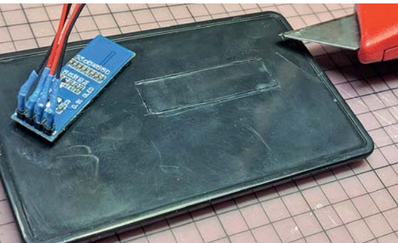
Das Display ist ein „Arduino 0.91 OLED-Display“ mit dem Controller SSD1306. Angesteuert wird es per I2C.
