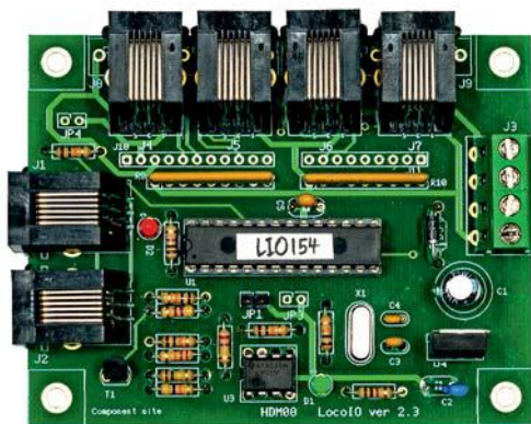
LocoIO ist ein Kernmodul in Hans Deloofs LocoNet-Angebot. Es bietet 16 I/O-Kanäle, die recht frei konfigurierbar sind und passende Nachrichten im LocoNet auswerten und einspeisen. Was wann wie zu schalten bzw. zu melden ist, wird per Konfigurationssoftware am Bildschirm festgelegt.
