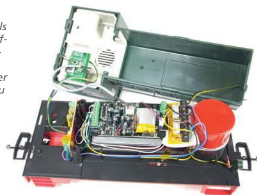
Im Inneren enden die Reed-Schalter-Anschlusskabel an einer dreipoligen Schraubklemme auf der Hauptplatine.
