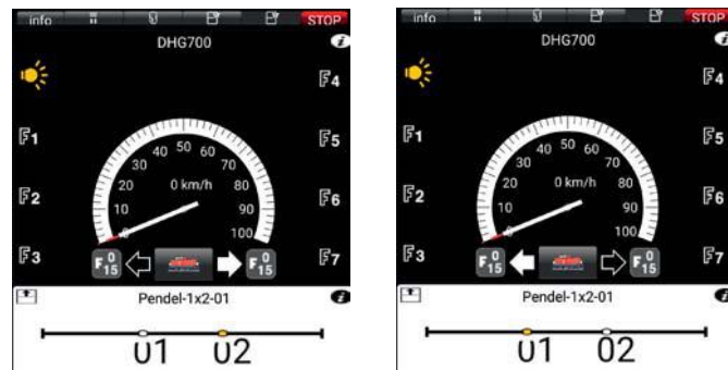
Im linken Bild ist Kontakt 02 ausgelöst. Die Lok hat (am rechten Pendelende) angehalten, aber noch nicht umgeschaltet. Im zweiten Bild ist Kontakt 01 „ein“. Die Lok hält (vor dem linken Prellbock).
