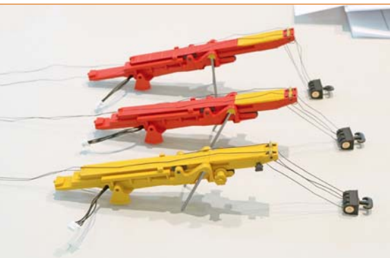
Drei fertige Teleskoparme von einem Vorserien-Montagetest. Hier fallen die Kabel auf, die die Verbindung zu internen Stellungssensoren herstellen.
