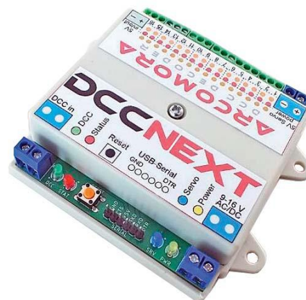
Eine Integrationsstufe weiter geht DCC-Next: Hier sind ein Arduino-Prozessor und die Elemente des DCC-Shields auf einer Platine zusammengefasst. Letztlich ist das DCCNext ein frei programmierbarer Zubehördecoder.
