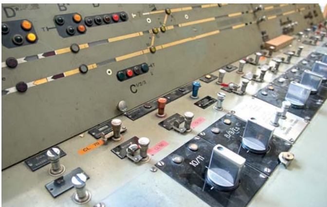
Original-Schalterstellwerk einreihig Bauart Integra [Bilten, BAL]
