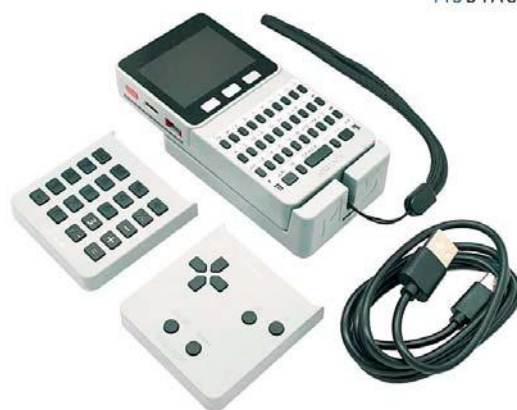
Die Hardwareplattform M5Stack Faces mit drei wechselbaren Faces und Ladeschale
