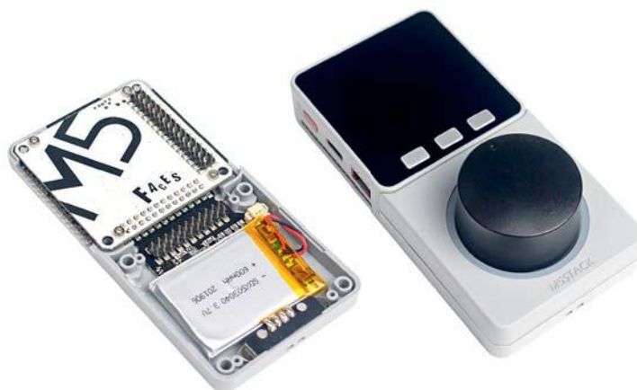
Für die Faces-Variante abgewandelte Bodenplatte mit Akku (links) und mit Encoder-Face komplettierte M5Faces-Kombination (rechts) als Handregler
