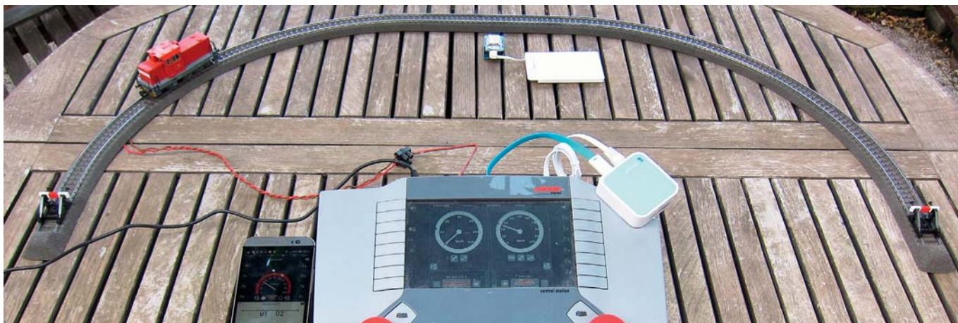
CS2 mit angeschlossenem Router und Pendelstrecke: Nur das Stromkabel verlässt den Tisch. Das Smartphone mit der Märklin-MainStation-APP und der Wemos D1 in der Schienenmitte sind drahtlos über den kleinen WLAN-Router mit der CS2 verbunden. Gesteuert wird die Lok (und ggf. auch Weichen) ganz klassisch über das Kabel zum Gleis.
