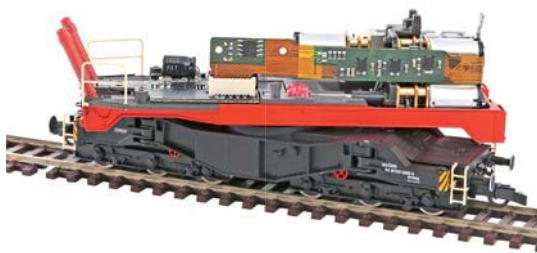
Die gegenüberliegende Seite wird von einer Teilflexplatine dominiert, die gleichzeitig Bauteilträger und elektrische Verbindung ist.
