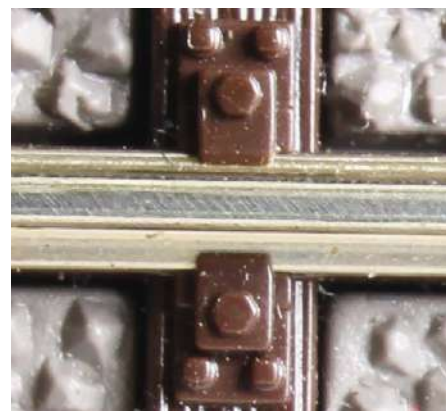
Hier war der MU-Schienenreinigungswagen mit rotierender Polierscheibe unterwegs. Man erkennt eine leichte, über Kreuz laufende Satinierung. Die Oberfläche ist deutlich weniger belastet.
