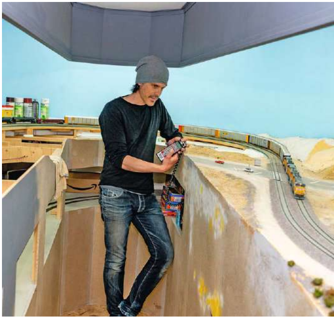
Dieser FREMO-Bahnhof wird mit einer Kombination aus Erbert-Stellpult-Elementen und der Software ESWTGJ bedient. Zur Steuerung der Fahrzeuge kommen LocoNet-Handregler an einer gesonderten Digitalzentrale zum Einsatz.
