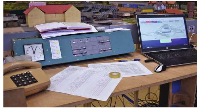
Dieser FREMO-Bahnhof wird mit einer Kombination aus Erbert-Stellpult-Elementen und der Software ESWTGJ bedient. Zur Steuerung der Fahrzeuge kommen LocoNet-Handregler an einer gesonderten Digitalzentrale zum Einsatz.
