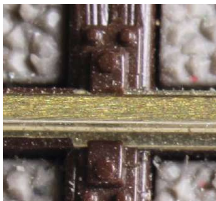
Auch beim handgeführten Schleifklotz entstehen Riefen, nun sind sie zusätzlich leicht schräg zur Schiene. Abrieb und flache Oberfläche ähneln dem Ergebnis mit dem Schleifklotzwagen.
