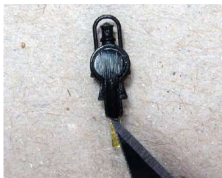
Mit einem spitzen Werkzeug lässt sich die rückseitige Abdeckung der Lokplatine abhebeln und ...
