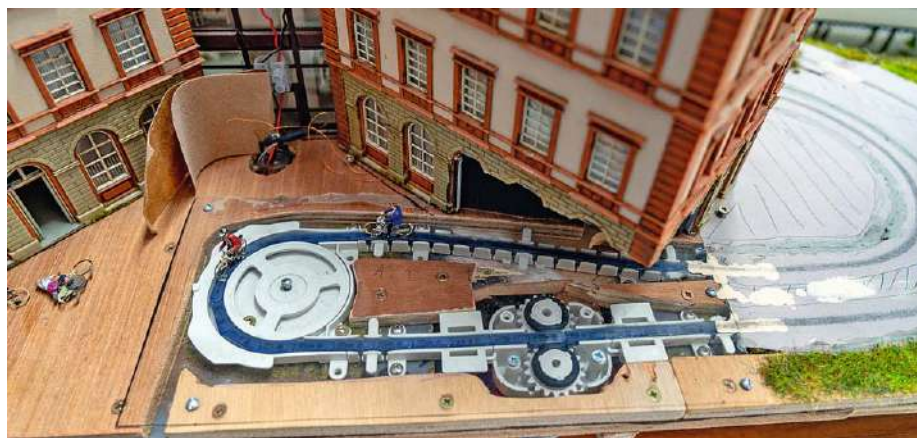
Besonderes Highlight sind Fahrradfahrer, die ihre Runden strampelnd im Stadtpark drehen. Sie werden über ein spezielles Kettensystem der Firma Magnorail unter dem Radweg magnetisch in Bewegung gehalten.
