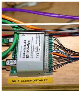
Einige der Littfinski-Rückmelder sind in die LokStoreDigital-Technik integriert worden und bis heute im Einsatz.
