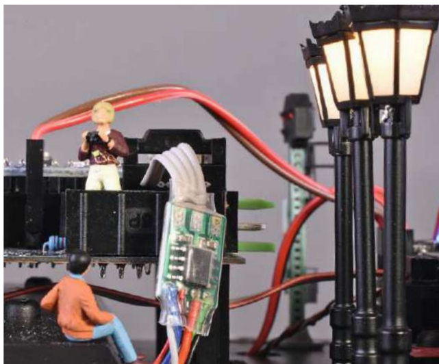
Blitzer-Action. Die Dame mit dem Fotoapparat „blitzt“ in unregelmäßigen Abständen. Die dafür nötige SMD-LED wurde ihr auf den Bauch geklebt und über das dicke Kabel hinter ihrem Kopf mit der Soundplatte verbunden. Die Platine im Vordergrund mit WS2811-Chip steuert den Action-Taster im Grundbrett des Aufbaus.
