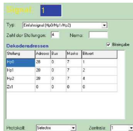
Die Steuerungssoftware ModellStw merkt von den Multiplex-Signalen nichts. Für die Software ist das ein ganz normales Signal.
