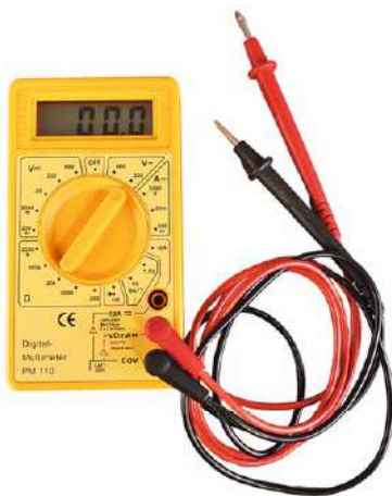
Dieses markenlose Multimeter ist für etwa 10 Euro in vielen Baumärkten erhältlich und zeigt zufällig Digitalspannungen halbwegs korrekt an.
