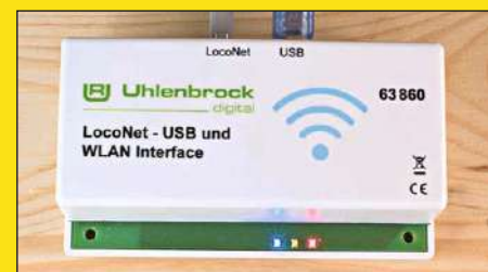
WLAN-Interface: Das kann Uhlenbrocks Adapter für LocoNet
