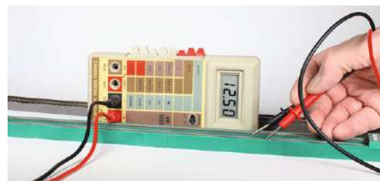
Das Messgerät beweist, dass der Widerstand des Schaumstoffs zu vernachlässigen ist. Auch am speisenden Gleis im Hintergrund sind 12,5 V zu messen.
