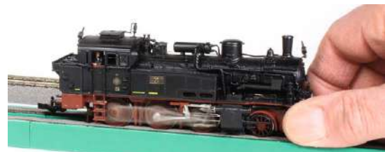
Der Schaumstoff ist weich, die Räder werden poliert und nicht geschliffen.
