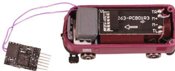
Der Lautsprecher sitzt vorne auf den besten Plätzen. Die sonstige Ausstattung ist bei diesem Pressemuster noch recht spartanisch. Modellbahn Union hat aber inzwischen nachgelegt und liefert die Serienversion mit dem ZIMO-Pufferspeicher TANT16Gurt.
