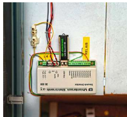
Dieser Sound-Director von Uhlenbrock wird über einen seiner Eingangs-Kontakte von einem LoDi-Operator angesteuert.
