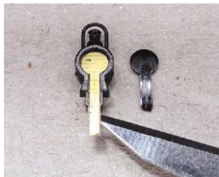
... die Platine samt der LED aus dem Lampengehäuse entfernen. Danach kann die alte gelbe LED abgelötet werden.
