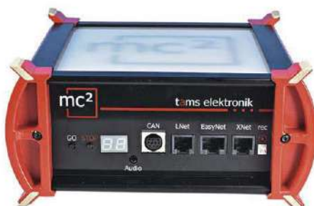
An der mc² von Tams lassen sich Spannung und Strom so einstellen, dass die Zentrale von Z bis 11m geeignet ist.
