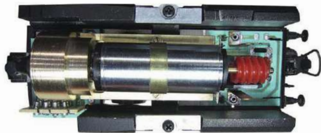
Der neue Faulhaber-Motor ist hier bereits im Tender montiert. Links ist die passend gefertigte Schwungmasse von Fonfara zu sehen. Schnecke und Kardanschale stammen vom Roco-Motor.
