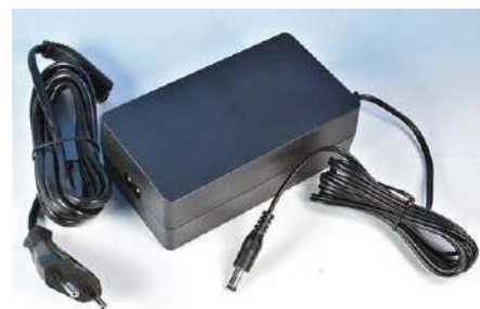
Die Intellibox 2neo bringt gleich das passende Netzteil mit praktischem Hohlstecker-Anschluss mit. Die Gleisspannung wird am Netzteil eingestellt und liegt circa 1 Volt unter der Ausgangsspannung des Netzteils. Foto: Heiko Herholz
