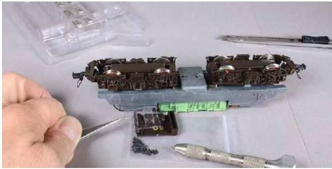
Der Hersteller sieht vor, die tiefgezogenen Halteschalen der Magnete für deren Montage an der Lok zu verwenden. Dazu werden kleine Schrauben und ein 0,9-mm-Bohrer mitgeliefert.
