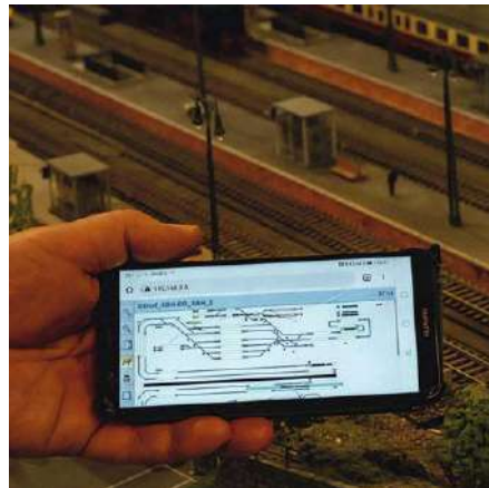
Smarthand ermöglicht es auch mit einem Webbrowser, das Stellwerk von einem beliebigen Smartgerät fernzusteuern.
