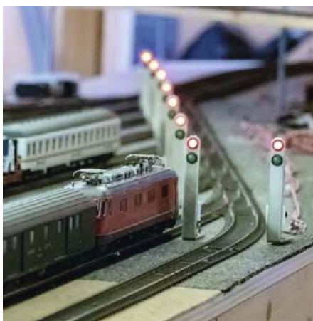
In den Schattenbahnhöfen sind einfache Signale mit LEDs in einem Alu-Winkel eingebaut.
