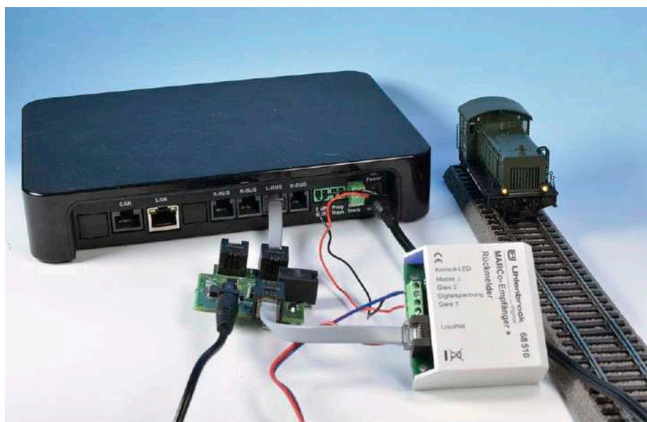
Auch die schwarze Z21 von Roco lässt sich mit dem Tams-Adapter schützen. Wenn man den hier angeschlossenen MARCo-Empfänger auf Übertragungsformat Digitrax einstellt, kann man im Maintenance-Tool und in der Z21-App die RailCom-Meldungen der Decoder sehen.
