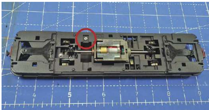
Fleischmann hat einen versteckten Massekontakt vom Fahrwerk zur Platine verbaut.
