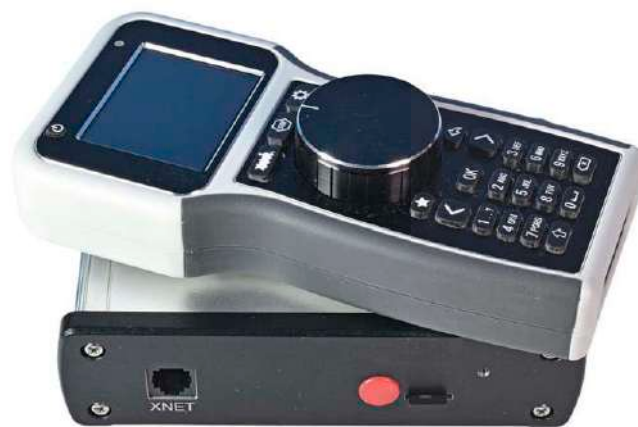
Die Zavavov-Zentrale TCS kann Lokdaten auf einer SD-Karte speichern. Der optionale WLAN-Handregler TCS-RC liegt gut in der Hand und wird über USB aufgeladen.
