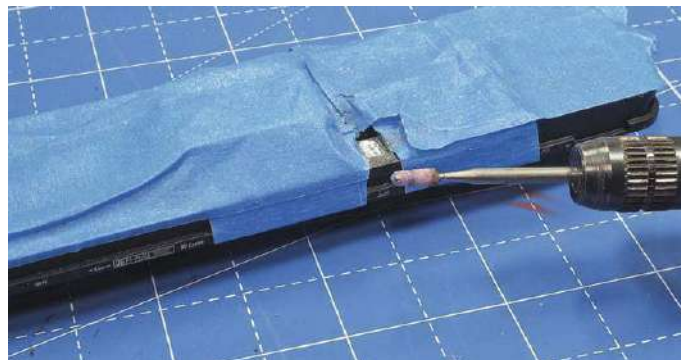
Diesen Massekontakt gilt es mit einem Fräswerkzeug zu entfernen, damit das Fahrwerk potentialfrei wird.
