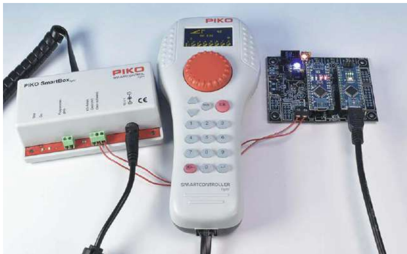
Das Ziel ist erreicht: Mit dem Piko-Handregler kann die hintere LED auf der MobaLedLib-Hauptplatine über die DCC-Adresse 42 geschaltet werden.
