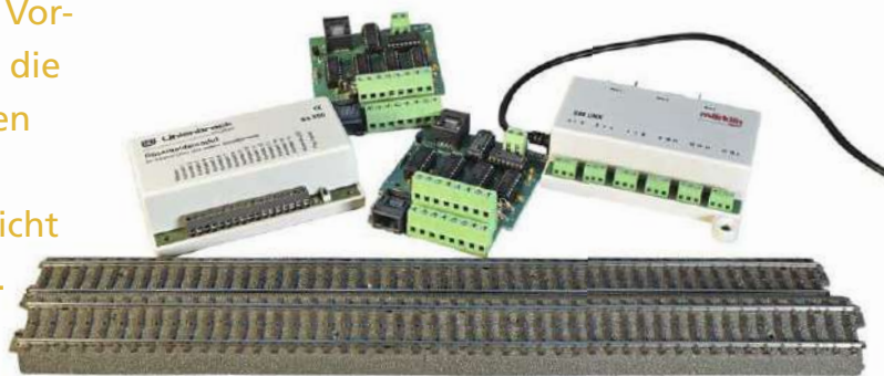
Die Mittelleiter-Gleissysteme von Märklin benötigen nur vergleichsweise einfache Rückmelder zum Erkennen von Gleisbelegungen. Foto und Tabelle: Heiko Herholz
