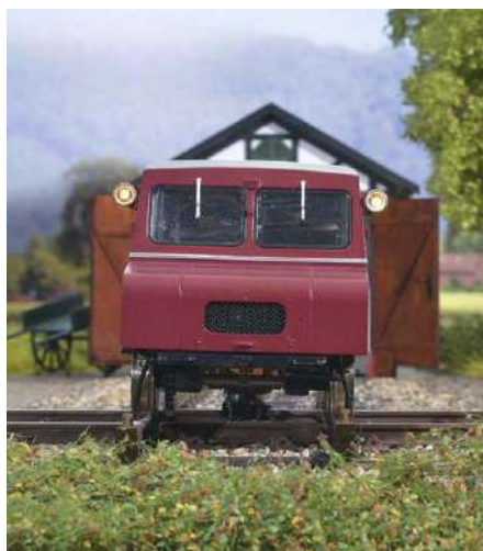
... erreichen später die Radsätze nicht genau das Hauptgleis. Doch zunächst wird der Klv (das „l“ steht für „leicht“, was der Mann an der Kurbel nicht unbedingt genauso sieht) durch Betätigen der Hubmechanik vom Gleis gelöst. Dann kann er langsam herumgedreht werden. Ist das Hauptgleis erreicht, wird das Fahrzeug wieder heruntergekurbelt und senkt sich genau auf die Schienenprofile des Hauptgleises. Schon kann die Dienstfahrt beginnen.
