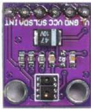
Das Breakout-Board mit dem APDS9930-Sensor trägt noch ein paar zusätzliche Teile. Der eigentliche Sensor ist der IC unten mit den beiden kleinen Öffnungen im Deckel.
