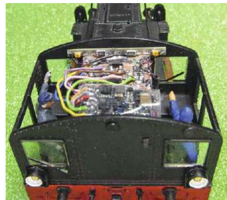
Unter das Dach des Führerhauses kommen der Decoder und die Verteilerplatine mit den Verstärkern für die Funktionsausgänge.
