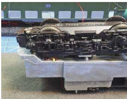
Winzige SMD-LEDs werden zur Nachbildung der Anfahrleuchten am Lokrahmen angebracht.
