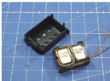
Die Schallkapsel hat Platz für zwei „Zuckerwürfel“-Lautsprecher von Döhler & Haass.
