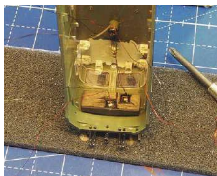
Die LEDs für die Spitzenbeleuchtung habe ich direkt auf die Lichtleiter geklebt.
