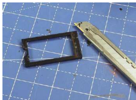
Auf dem Abstandshalter für die Motorhalterung müssen zwei Stege entfernt werden, damit der Gesamtaufbau passt.
