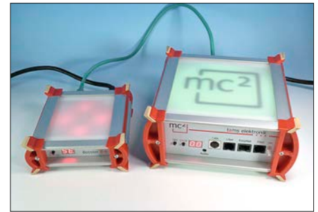
Hier liefert die Digitalzentrale ein Gleissignal, aber der Booster ist ausgeschaltet und gibt daher kein Signal am Gleisanschluss aus.
