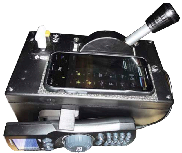
Bei Verwendung eines alternativen Steuergeräts wird die Maus weiterhin als Verbindung vom Pult zur Zentrale benötigt.
