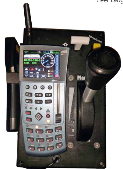
Maus 2 ToGo mit aufgesetztem ZIMO-Regler zur komfortablen Modellbahnsteuerung mit Vorbild-Feeling.
