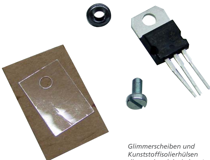
Bei der Montage der Leistungstransistoren auf den Kühlkörpern ist auf strikte elektrische Trennung zu achten. Empfehlenswert ist es, mit einem Widerstandsmessgerät im niedrigen Ohm-Bereich zu prüfen, ob es eine elektrische Verbindung zwischen Kühlkörper und Anschlussfahne des Transistors gibt.
