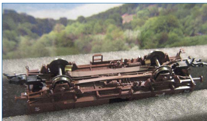
Die Radkontakte sind aus weichem Messingblech entstanden.
