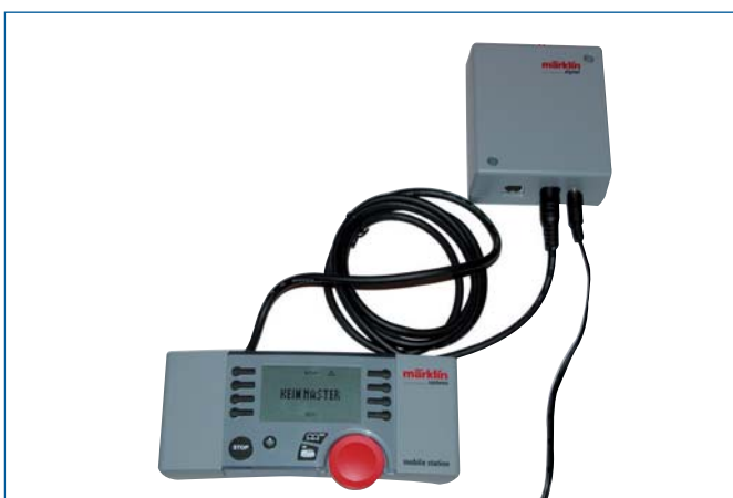
Die zur MS2 zugehörige Gleisbox kann mit der MobileStation der ersten Generation nichts anfangen.
