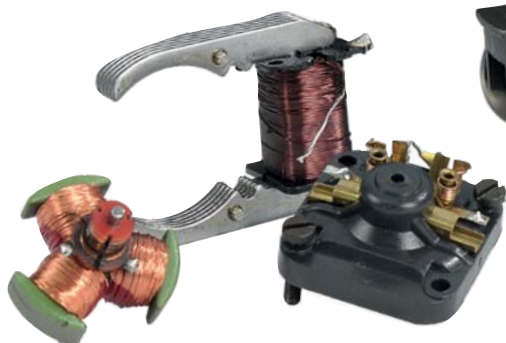
Ein Vergleich der alten und neuen Motorkomponenten zeigt, warum sich die Fahreigenschaften verbessern; der fünfpolige Anker bietet einen deutlich besseren Gleichlauf.
