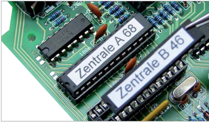
Die beiden PICs sind eindeutig beschriftet. Der als „Zentrale B“ beschriftete kommt in den Sockel neben dem Widerstandsnetzwerk.
