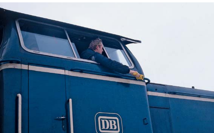
Mit einem Infrarotsender schaltet sich der Lokführer den Weg frei (Marktindersdorf, 25.2.1987).
