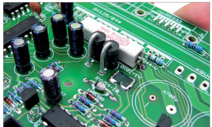
Neben dem Hochlastwiderstand sind zwei große Dioden (MR852) wie gezeigt senkrecht zu montieren.
