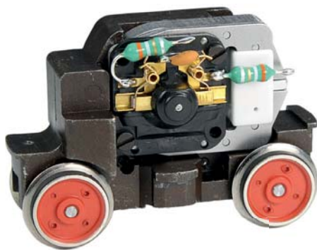
Auf einen Blick wird klar, dass der neue Motor mit Gleichstrom betrieben wird. Die Feldspule ist entfallen, an ihrer Stelle sitzt ein permanenter Stator, der Anschluss eines Decoders erfolgt an die beiden Drosseln, die wie Widerstände aussehen.
