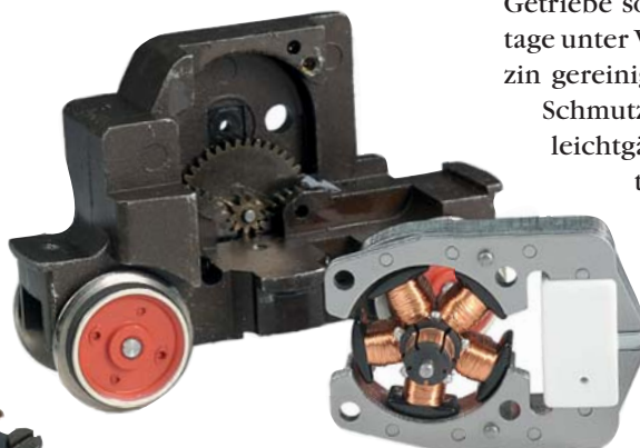
Ein Vergleich der alten und neuen Motorkomponenten zeigt, warum sich die Fahreigenschaften verbessern; der fünfpolige Anker bietet einen deutlich besseren Gleichlauf.
