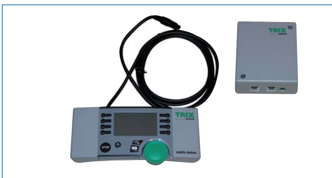
Die Trix-MobileStation der ersten Generation ist eine Insellösung und funktioniert nur an der dafür vorgesehenen Gleisbox.
