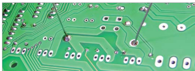
Der Hochleistungswiderstand ist mit Abstand zur Platine einzusetzen. Er ist sowohl von der Bestückungsseite wie auch von der Unterseite der Platine (Bild unten) zu verlöten.
