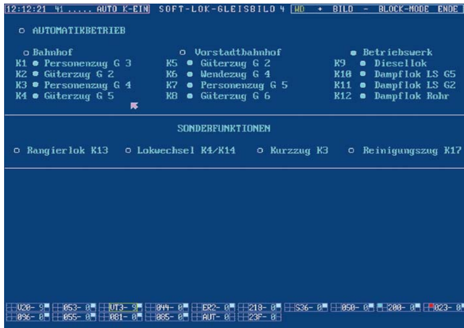
Bildschirmdarstellung mit den eingesetzten Zügen und den Angaben über die Startgleise der Züge. Lok- und Zugläufe werden hier gestartet und gestoppt.
