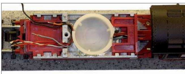
Kabelführung von der Kupplungsdeichsel unter der Schallkapsel hindurch.
