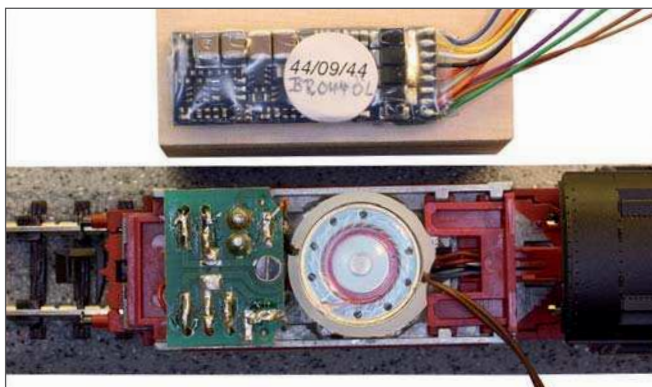
Die verkürzte Schnittstellenplatine dient unverändert als Träger der Tenderbeleuchtung und gleichzeitig ist sie Lötstützpunkt zur Verbindung der Kabel aus dem Tender, der Lok und dem LokSounddecoder.
