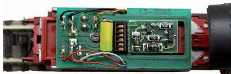
Tender der Analog-Lok Minitrix BR 044, serienmäßig mit Analogstecker in der NEM-Schnittstelle. Das ist die Ausgangsbasis für den Umbau. Man beachte die Kabelfarben!
