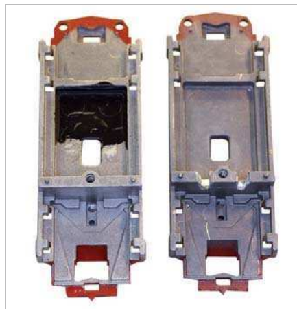
Links das Originalfahrgestell, rechts die geänderte Ausführung mit zwei Schlitten im Quersteg zur Aufnahme von Kabeln.
