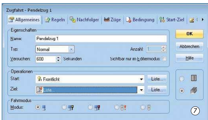
Bild 7 (links): Bei der Pendelzugfahrt 1 fährt der Zug bis zum Stoppmelder im Abstellgleis 10. Damit sind beide Belegtmelder in diesem Block belegt. Um den Stoppmelder wieder frei zu bekommen, soll der Zugverband einige Zentimeter vorziehen und dann den Wagen abkuppeln. Um diesen Ablauf einzurichten, wurde im Register „Allgemein“ bei „Operationen“, „Ziel“, „Liste“ aufgerufen. Es öffnet sich das Fenster „Liste der Operationen“. In ihm sollte zur besseren Übersicht „Zugoperationen“ ausgewählt werden. Durch Auswählen der entsprechenden Operation und Doppelklick oder „Hinzufügen“ werden die gezeigten Möglichkeiten aktiviert. Die erforderliche Operation „Verzögerung“ befindet sich unter „System-Operationen“.
