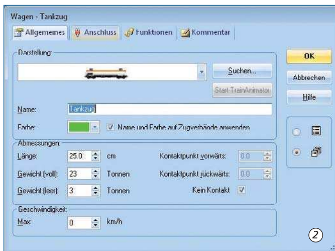
Bild 2: Dieser Wagen kann jetzt durch Doppelklick editiert werden. Eigenschaften wie Gewicht oder zulässige Höchstgeschwindigkeit nehmen Einfluss auf die Steuerung des Zugverbandes. Die Längenangabe ist für den Abgleich mit Gleislängen notwendig, aber auch für das geplante Rangiermanöver. Auch kann ein Name vergeben werden. In unserem Fall erhält der Wagen den Namen „Tankzug“.
