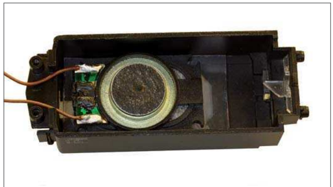
Auch ein Verzicht auf die Schallkapsel schafft nicht genügend Einbauraum für den LokSounddecoder
