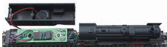
Die BR 52 mit NEM-Schnittstelle. Am eingesteckten Lokdecoder MX 620 N von Zimo erkennt man die vier angelöteten Schnittstellenkabel zum Soundmodul und den im Tendraufbau eingeklebten Lautsprecher. Inzwischen ist der nicht mehr erhältliche Zimo-Decoder durch einen Lenz Silver Mini+ mit SUSI-Schnittstelle ersetzt.
