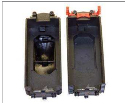
Der linke Tenderaufsatz ist im Unterschied zum rechten zur Aufnahme eines Minitrix-Lautsprechers vorbereitet.
