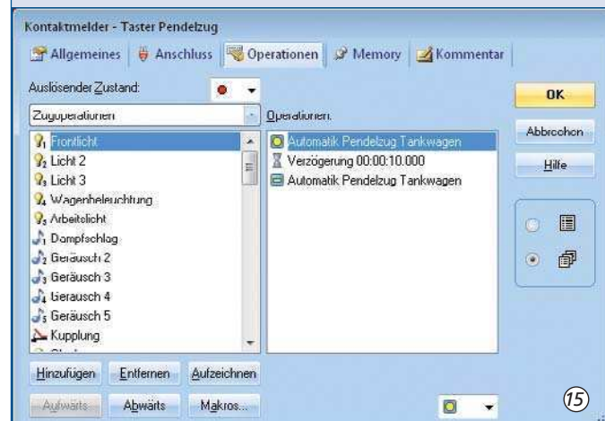
Bild 15: Diese Pendelzugfahrt kann auch als sogenannte Druckknopffaktion durchgeführt werden. Dazu wird ein Taster wie ein Kontakt- oder Belegtmelder an das Rückmeldemodul angeschlossen und diesem Melder dann als Operation das Einschalten des Schalters Automatik Pendelzug zugeordnet. Nach zehn Sekunden wird dieser wieder abgeschaltet. Mit Ausschalten des Automatiktasters ist sichergestellt, dass der Zyklus der vier Zugfahrten nur einmal durchgeführt wird.
