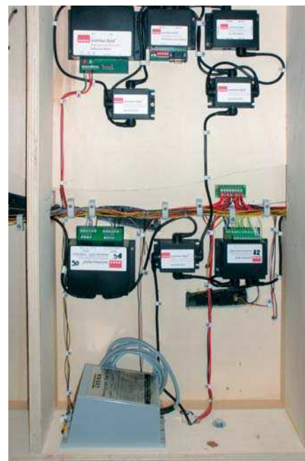
Der mittlere Rahmenblock des vorderen, mittleren Segments beherbergt die Zentrale RMX950 (oben links), daneben das Interface RMX952 (zum Fotozeitpunkt nicht mit dem PC verbunden) und wiederum daneben der Bus-Splitter RMX953. Eine Verteilerplatine SLX823 dient hier der Verteilung des Fahrstroms auf dem Segment und dem Versorgungsbus.
