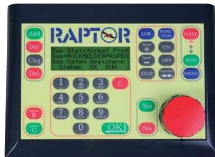
Die Initialisierungsmeldung des Raptors fordert zur Überprüfung der Rückmelder und zur Eingabe verschiedener Systemparameter auf. Rechts oben leuchtet eine rote LED – der Raptor erzeugt noch kein digitales Fahr- oder Schaltsignal.
