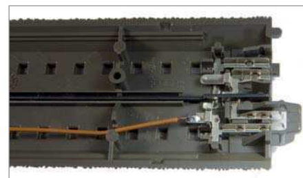
Zur Versorgung des Meldeabschnitts können entweder die Märklin-Kabelschuhe verwendet oder die Litze direkt angelötet werden. Gleiches gilt für den Mittelleiter und die zweite Fahrschiene. Die Litzen werden später durch eine Bohrung im Trassenbrett nach unten geführt.
