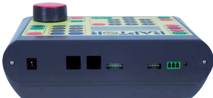
Auf der Rückseite finden sich von links nach rechts die Anschlüsse für die Stromversorgung, zweimal RBus, s88, Märklin- und compatible Booster und CDE-Booster von Lenz. Ganz rechts ein Drehregler zum Einstellen des Anzeigenkontrasts.
