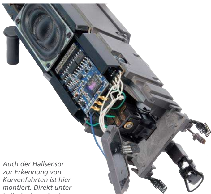
Die Metallbügel zwischen den vorauslaufenden Rädern fungieren als Weichensensor. Sie kontaktieren beim Kreuzen die Schienenköpfe des nicht befahrenen Weichens-trangs.
