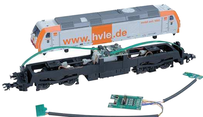
Die Lok, hier das Modell eines Traxx-Diesels BR 285 der hvle, im Originalzustand und die Tauschplatine von Modellbau Schönwitz.
