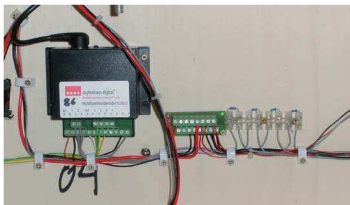
Der Schnappschuss aus der Bauphase zeigt ein Ecksegment des Schattenbahnhofs. Hier wurde ein Multifunktionsdecoder SLX812 eingesetzt, der vier Gleisabschnitte überwachen kann und vier Magnetartikel-, vier Lichtsignalschlüsse oder acht Ein-Aus-Schaltfunktionen in einem Gehäuse vereint.
