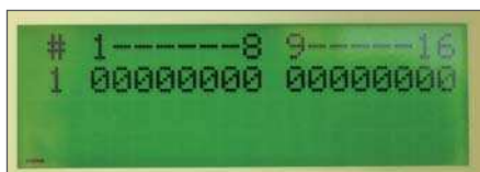
Anzeige zur s88-Abfrage. Aufgerufen ist das erste Modul mit den Meldern 1–16, die alle „nicht aktiv“ gezeigt werden. Bei einer „aktiv“-Meldung würde eine „1“ an der passenden Stelle anstatt einer der vielen Nullen gezeigt.
