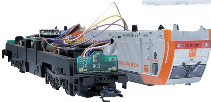
Sind alle zugerüsteten Teile befestigt, bedarf es nur noch eines Decoders passend zur Schnittstelle, dann kann das Lokgehäuse aufgesetzt und verschraubt werden.
