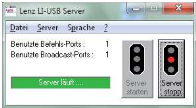
Abbildung 2: Der virtuelle Server von Lenz vereinfacht die Kommunikation zwischen Anwendungsprogramm und Digitalzentrale.
