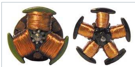
Links 3-Pol-Anker, rechts 5-Pol-Anker. Der 5-Pol-Anker gewährleistet eine größere Laufruhe des Motors, vor allem im unteren Drehzahlbereich. Für das gute oder schlechte Fahrverhalten einer Lok spielen jedoch eher andere Faktoren wie der Zustand des Motors und des Getriebes eine Rolle.
