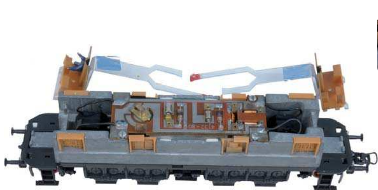
Der rot markierte Bereich der Platine wird herausgeschnitten. So ergibt sich etwas Platz, der später einen Decoder aufnehmen kann.
