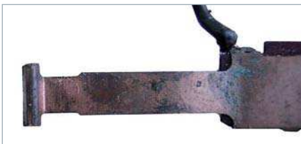
Von außen ist dieser Schaden nicht zu erkennen, Strom und Daten werden jedoch nur unzureichend oder gar nicht übertragen.
