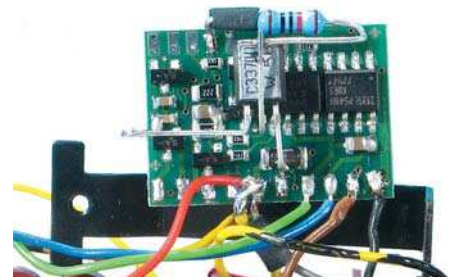
So werden Transistor und Widerstand am Decoder montiert. Am nach links weg-stehenden Pin werden die Telex-Spulen angeschlossen.
