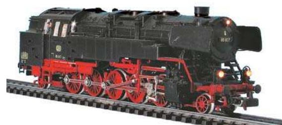
Das Ergebnis der Mühen: Eine feine digitalisierte Lok mit Fernentkuppplung und Führerstandsbeleuchtung.
