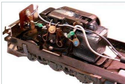
Anstelle der Feldspulen wurde in diesen Motor ein Permanentmagnet eingebaut. Dieser wurde so zu einem Gleichstrommotor, der problemlos über einen lastgeregelten Decoder angesteuert werden kann.
