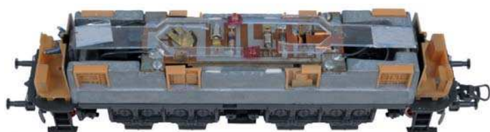
Die Ausgangssituation, beide Lichtleiter lassen sich inklusive Führerstand nach oben entnehmen.
