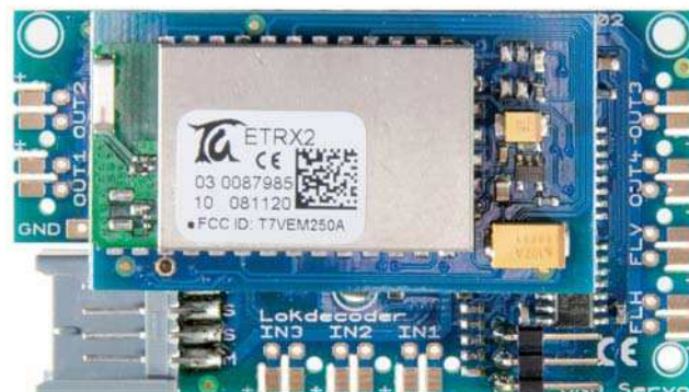
Auf der Unterseite sind die Löt pads für vier Funktionsausgänge, drei Funktionseingänge sowie die getrennten Anschlüsse für Front- und Schlussbeleuchtung zu finden. Die Anschlussmöglichkeit für einen Servoantrieb ist als Stecker ausgeführt.
