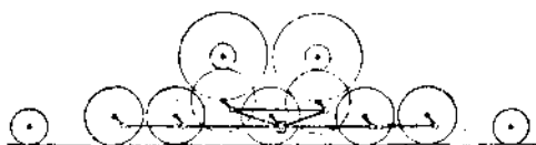
Фиг. 1,81. Передача треугольной рамой с кулисой.
