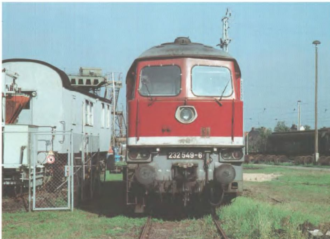
Seddin im Sommer 1994 – 232 549 am »Meßwagen«, einer stationären Belastungsanlage zur Überprüfung und Wartung der elektrischen Lokomotivausrüstung. Foto: Eckart Weber
