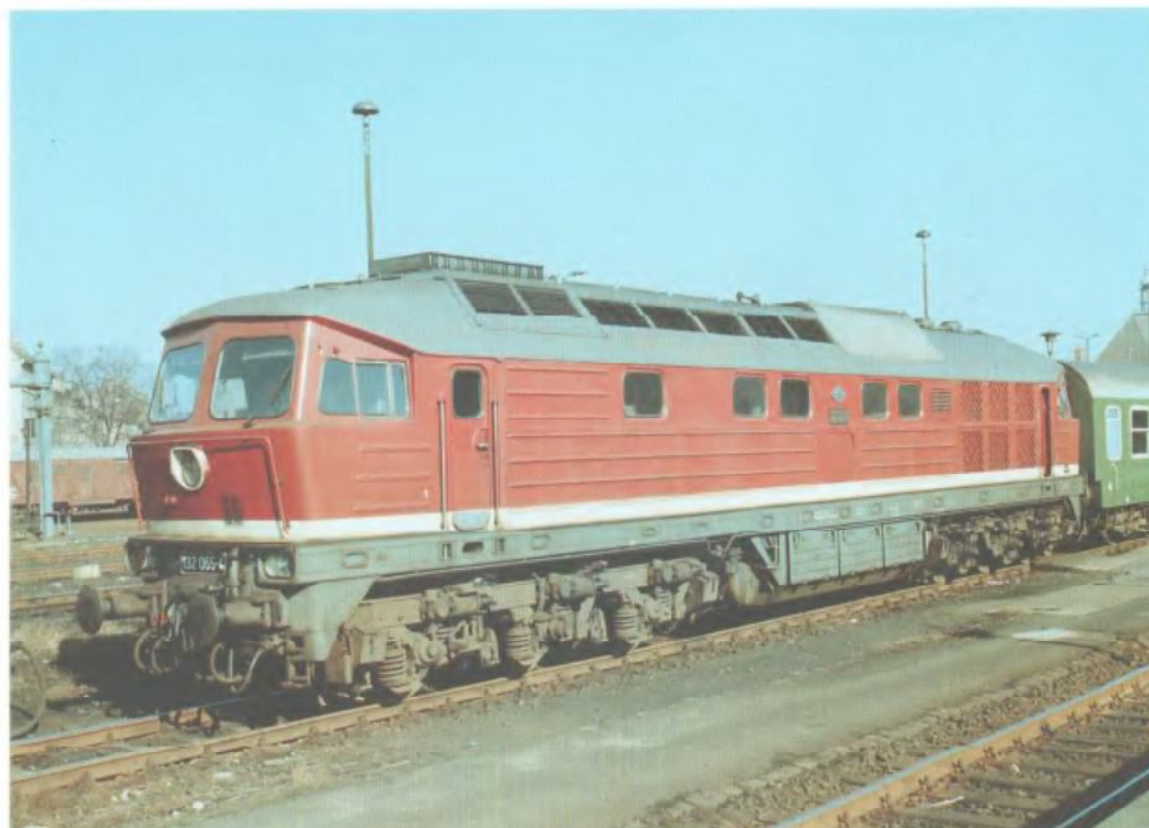
Am 19. März 1988 steht 132 065 mit Reisezug abfahrbereit im Görlitzer Hauptbahnhof. Ab 1973 wurden die Lokomotiven der BR 132 beschafft. Ausgerüstet mit elektrischer Zugheizung waren diese Lokomotiven nun auch im Reiseverkehr freizügig einsetzbar.
