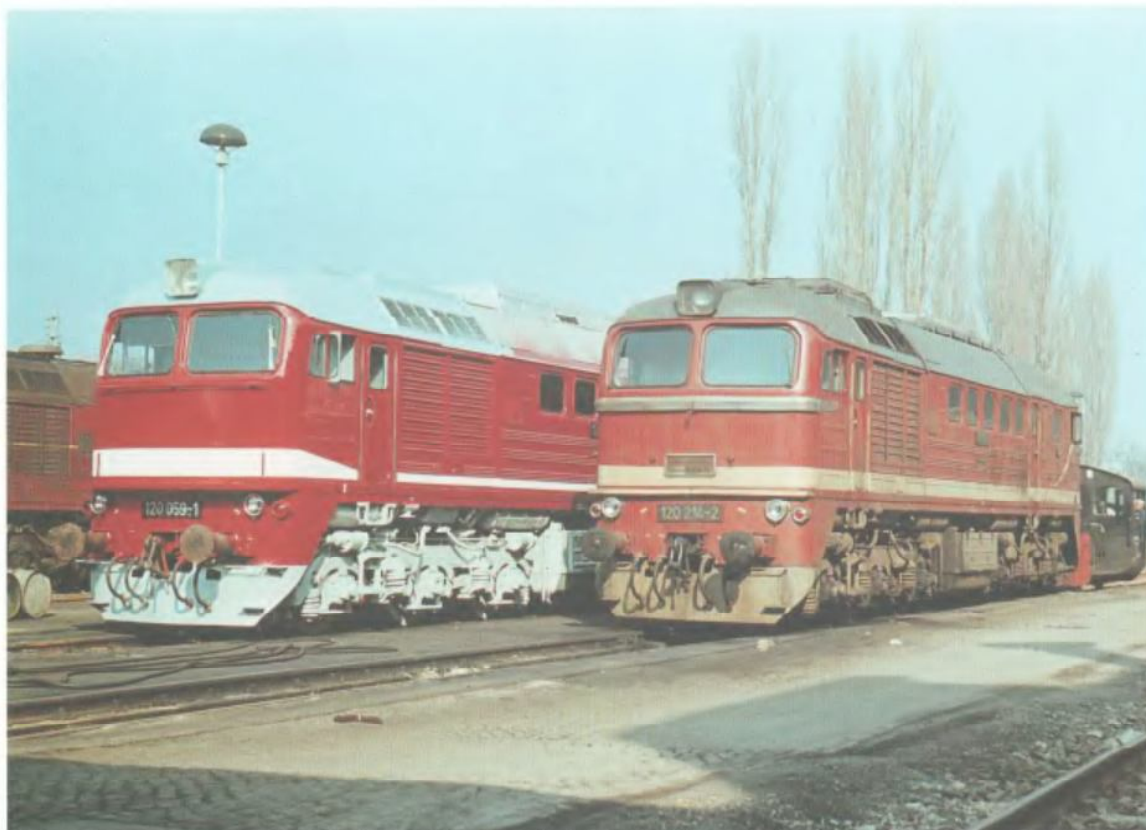
Lackierungsvarianten der BR 120 – zu sehen am 24. März 1982 im Raw Dessau. Der Anstrich der frisch lackierten 120 059 entstand nach neuestem Farbschema der DR (obwohl der schräge Verlauf des Zierstreifens an den Führerhausseiten später entfiel). Die 120 214 besitzt einen Anstrich mit breitem Zierstreifen, der bereits mit der 120 007 im Jahre 1976 eingeführt wurde, um die Lokomotiven optisch an die BR 118 anzupassen.
